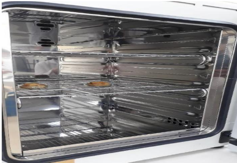
Foto N°13: Determinación del contenido de humedad mediante Estufa.
