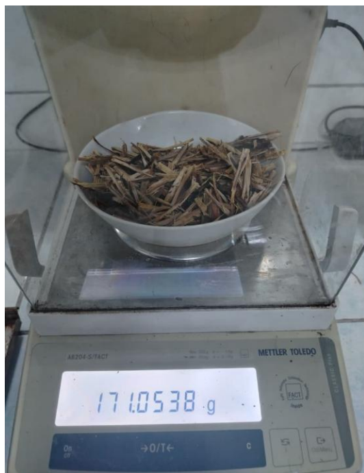
Figura 23. Pesado de celulosa del aliso al 15 % de NaOH antes del blanqueado
