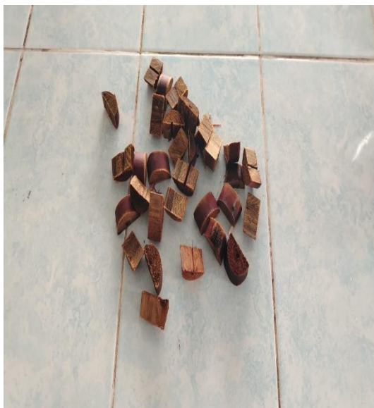
Figura 20. Muestras de saucillo obtenidas después del tratamiento con H 2 O 2 al 15%
