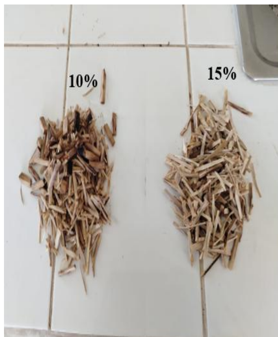
Figura 26. Obtención final de pulpa celulosa de aliso al 10 y 15 %
