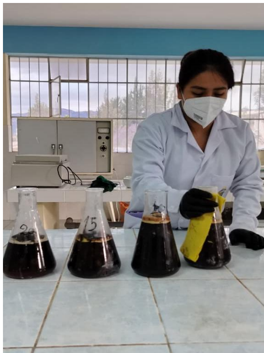
Figura 20. Muestras de saucillo obtenidas después del tratamiento con H 2 O 2 al 15%
