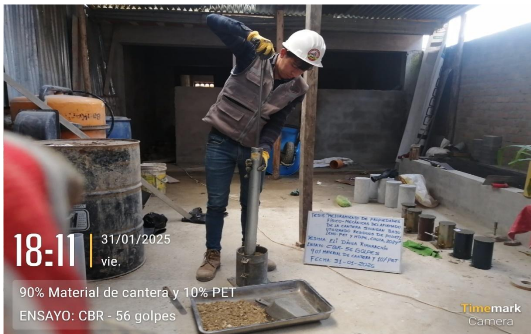
Realización del Ensayo de CBR de Laboratorio – 56 Golpes
