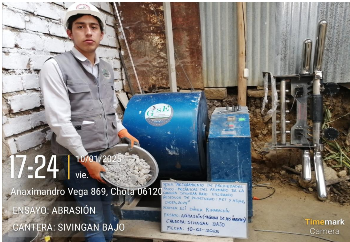
Fotografía 18. Ensayo de Abrasión 90% Material de Cantera y 10% PET
