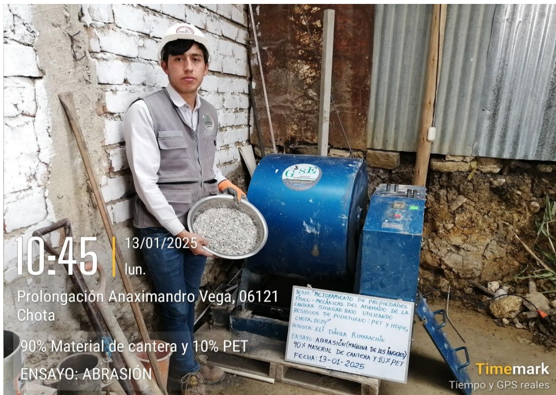
Fotografía 18. Ensayo de Abrasión 90% Material de Cantera y 10% PET
