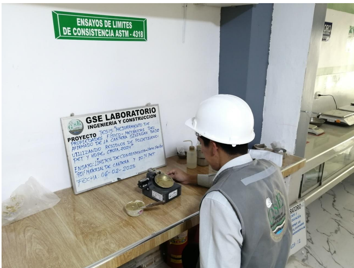
Fotografía 12. Ensayo de Límite de Consistencia: Límite Líquido 90% Material de Cantera y 10% PET
