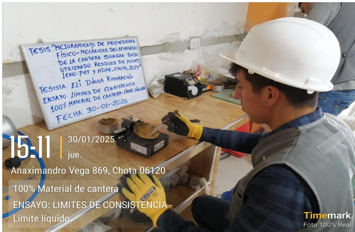
Fotografía 10. Ensayo de Límite de Consistencia: Límite Líquido 95% Material de Cantera y 5% HDPE
