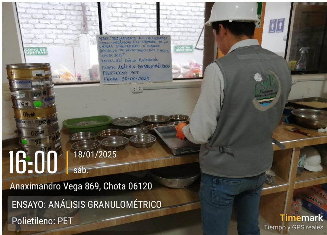
Fotografía 8. Ensayo de Análisis Granulométrico HDPE
