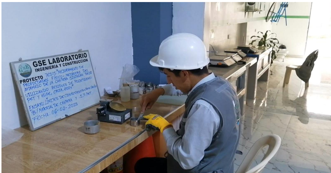
Fotografía 12. Ensayo de Límite de Consistencia: Límite Líquido 90% Material de Cantera y 10% PET
