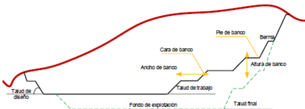
Cantera a Cielo Abierto
