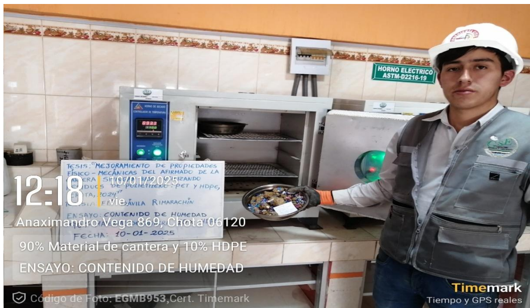
Realización del Ensayo de Contenido de Humedad
