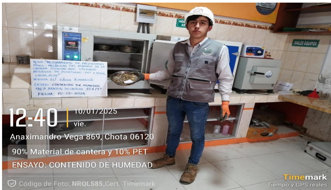
Fotografía 4. Ensayo de Contenido de Humedad 90% Material de Cantera y 10% PET
