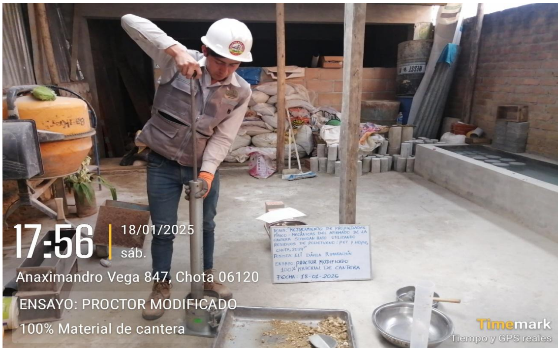
Fotografía 14. Ensayo de Proctor Modificado 100% Material de Cantera
