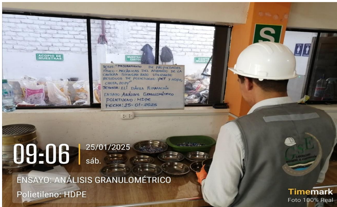
Fotografía 6. Ensayo de Análisis Granulométrico 100% Material de Cantera
