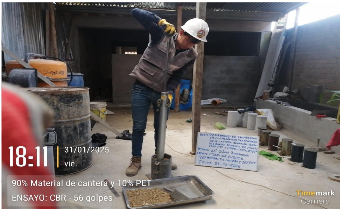
Fotografía 16. Ensayo de CBR - 56 Golpes de 90% Material de Cantera y 10% PET
