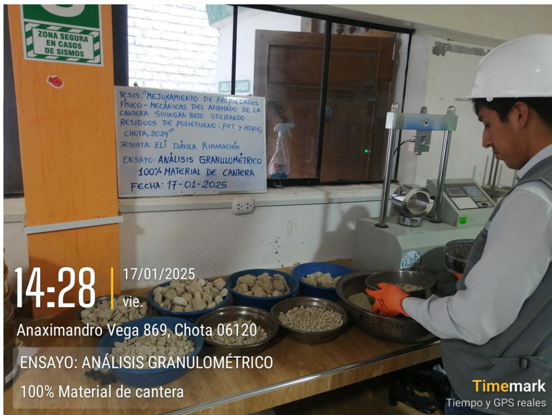
Fotografía 6. Ensayo de Análisis Granulométrico 100% Material de Cantera
