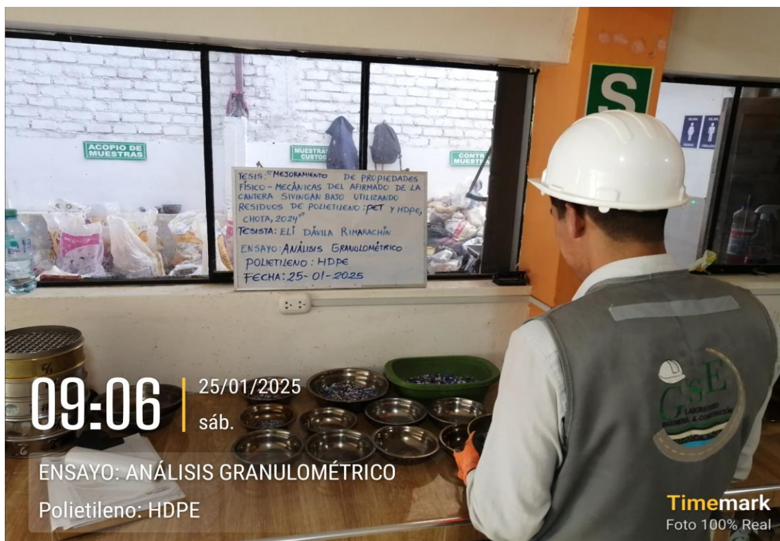
Fotografía 8. Ensayo de Análisis Granulométrico HDPE
