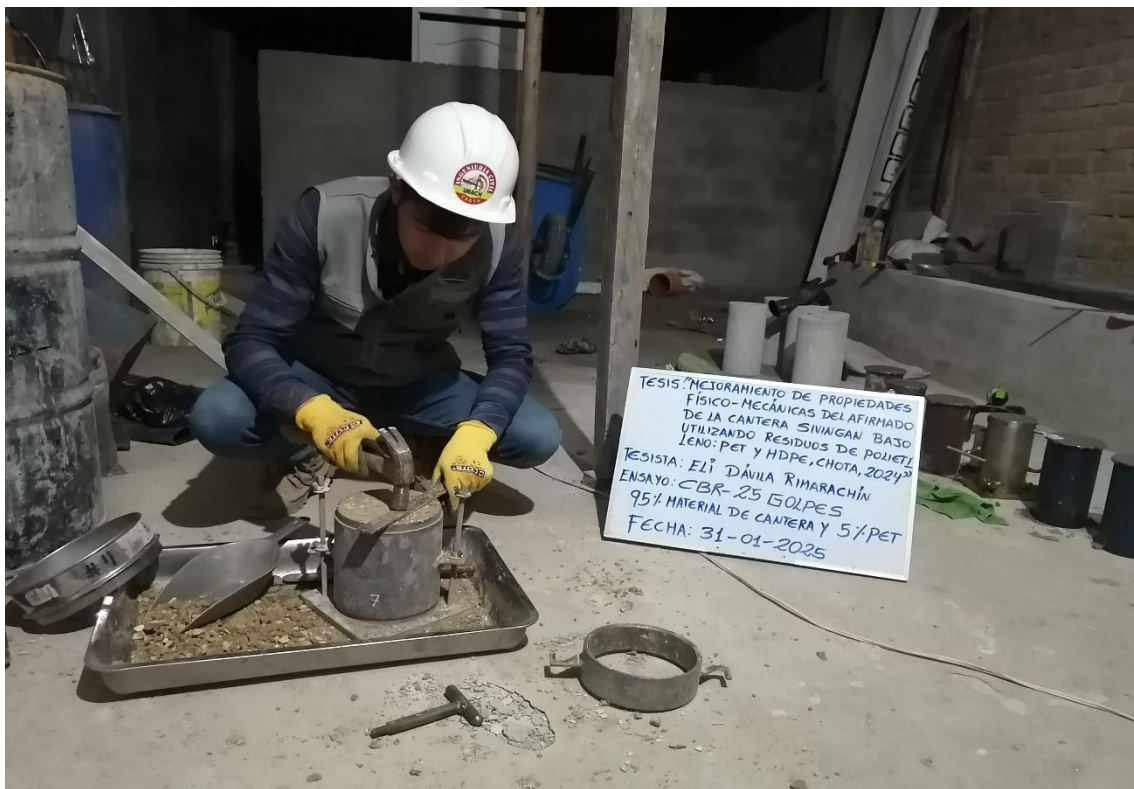
Fotografía 16. Ensayo de CBR - 56 Golpes de 90% Material de Cantera y 10% PET
