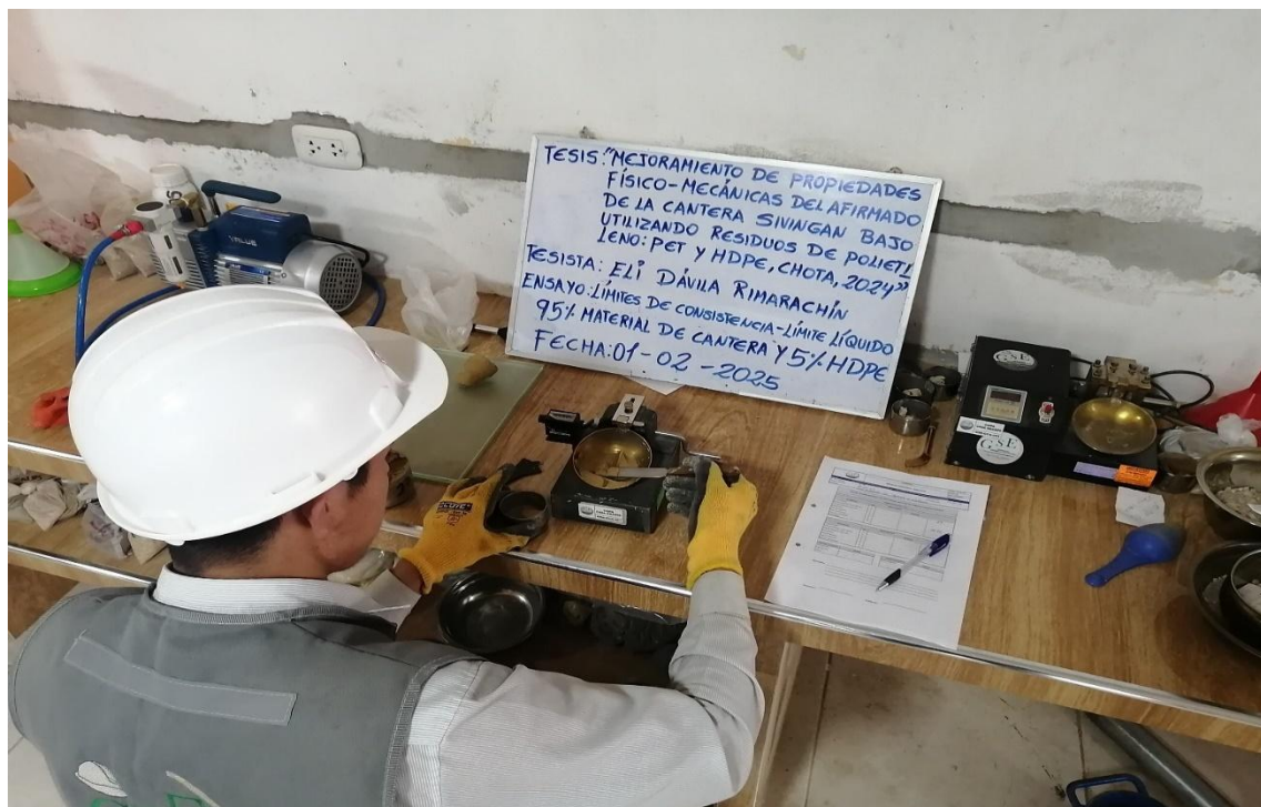
Fotografía 10. Ensayo de Límite de Consistencia: Límite Líquido 95% Material de Cantera y 5% HDPE
