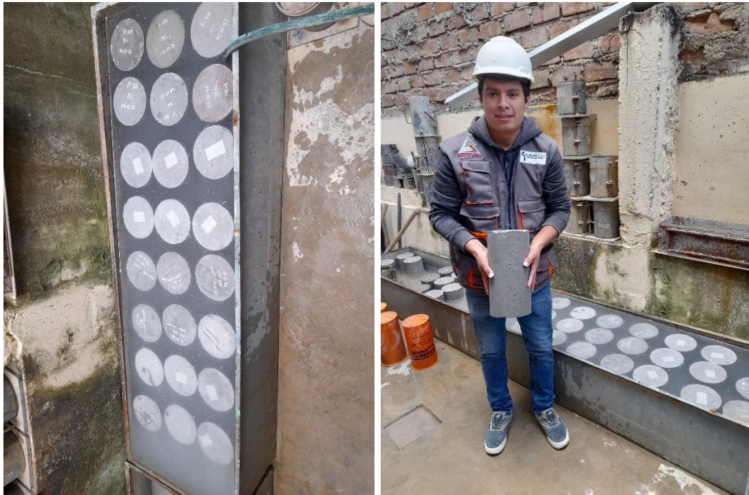
Fotografía 10: Curado de probetas.
