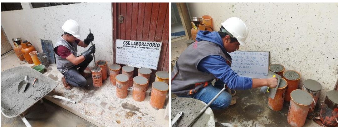
Fotografía 9: Preparación, varillado y enrasado de probetas con los diferentes diseños de mezcla de propuestos.
