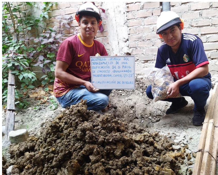
Fotografía 4: Extracción de suelo para determinar el tipo de suelo en el lugar de la vivienda seleccionada.
