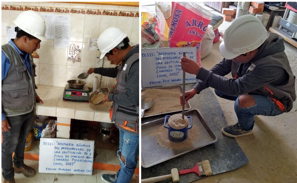
Fotografía 6: Ensayos del agregado fino a utilizar para nuestro diseño de mezcla.
