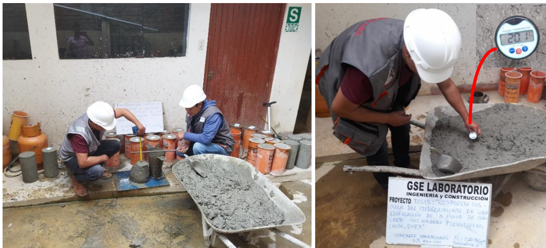
Fotografía 9: Preparación, varillado y enrasado de probetas con los diferentes diseños de mezcla de propuestos.
