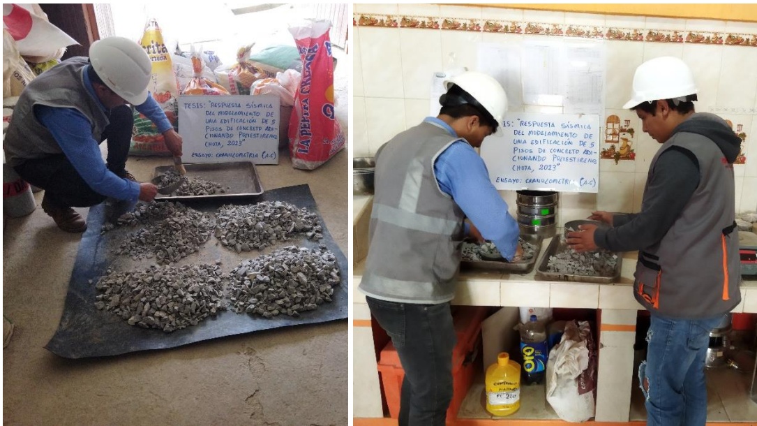
Fotografía 5: Ensayos del agregado grueso a utilizar para nuestro diseño de mezcla.
