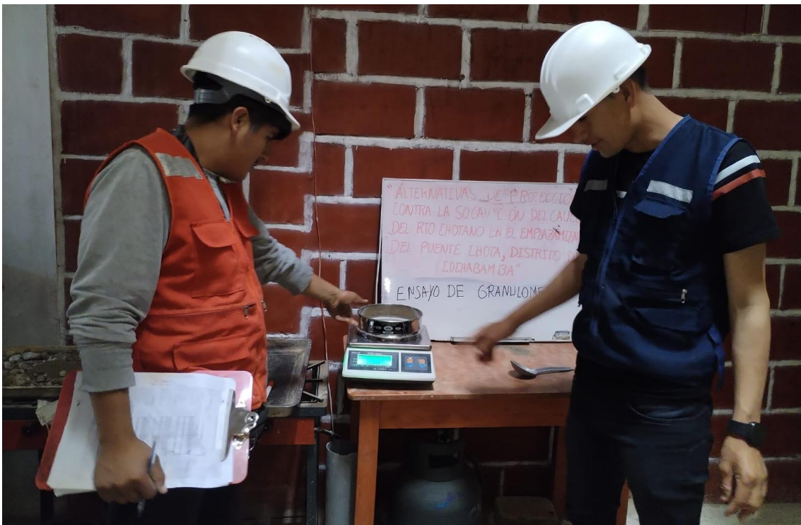
Fotografía 12. Pesado de muestra de suelo retenido en cada tamiz
