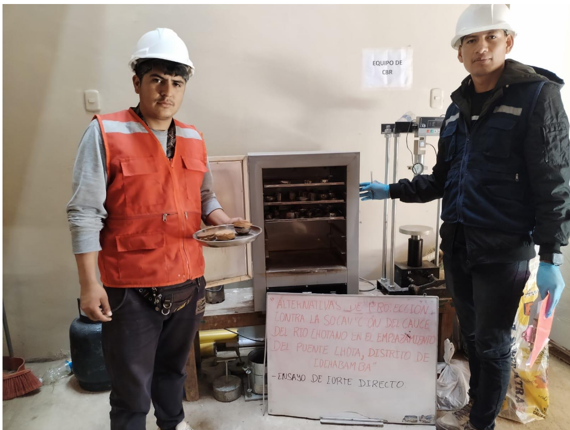
Fotografía 16. Muestras en el horno en el ensayo de corte directo
