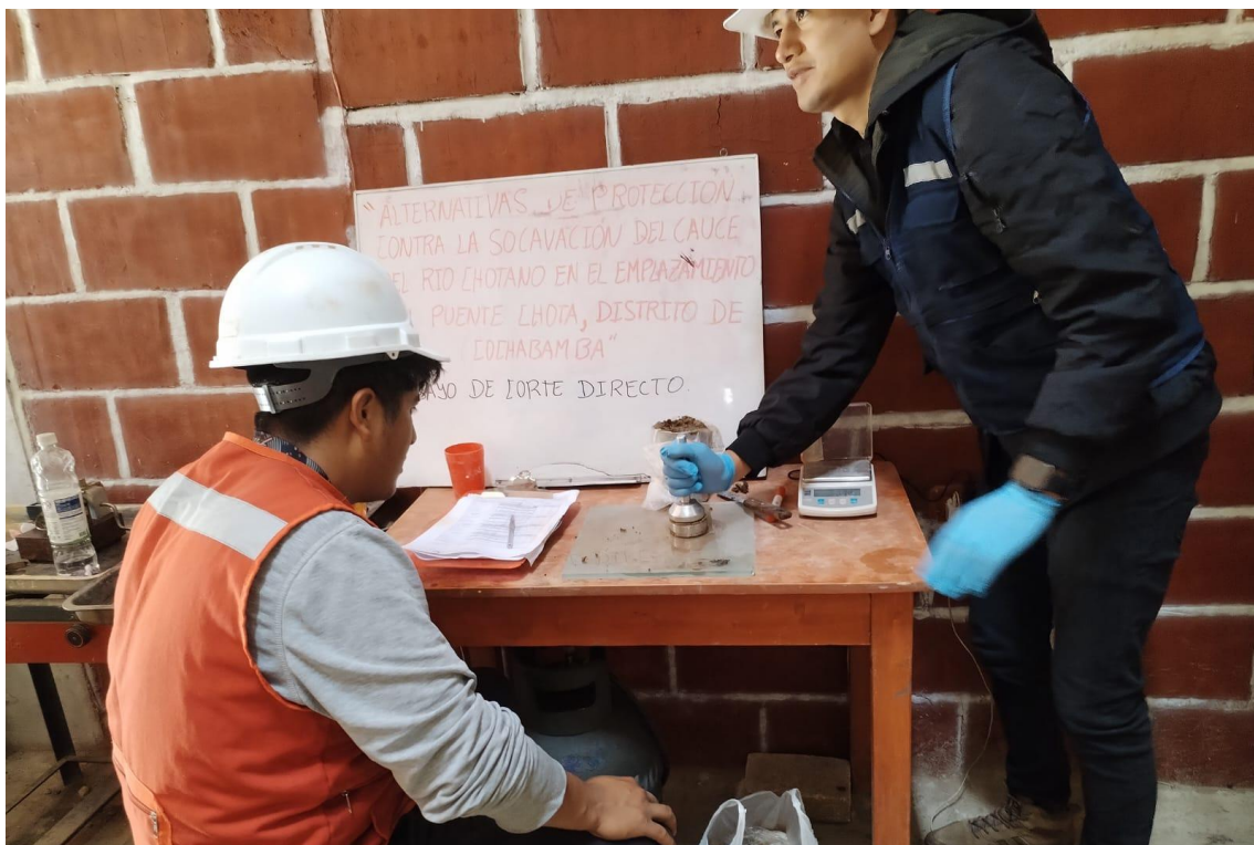
Fotografía 14. Preparación de muestras para el ensayo de corte directo
