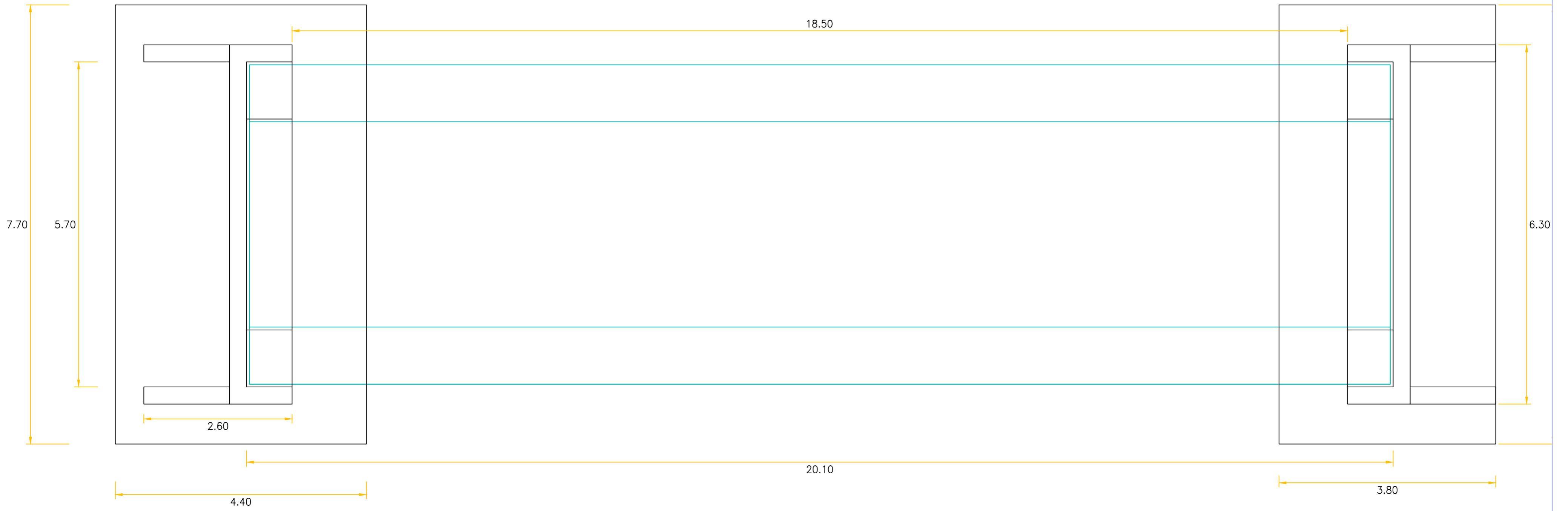
PLANTA TABLERO – ESTRIBOS ESCALA 1:50
