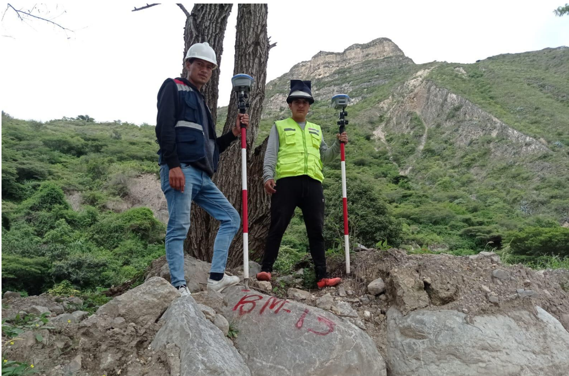
Fotografía 8. Toma de BMS y puntos fijos en el levantamiento topográfico
