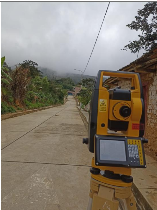
Fotografía 17. Registro altimétrico en vía pavimentada durante condiciones de nubosidad
