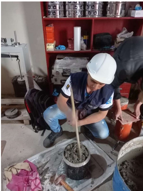
Fotografía 24. Ensayo contenido de aire en la mezcla de concreto: Varillado
