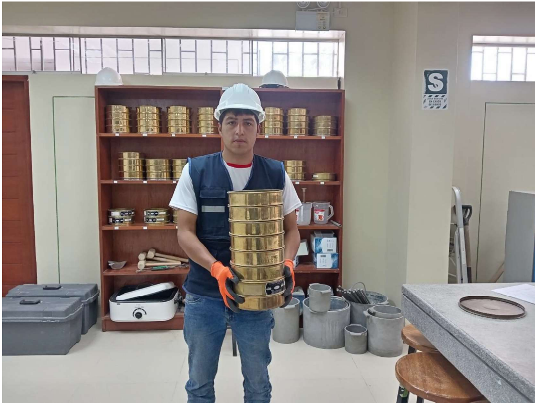
Fotografía 4. Tesistas realizando el ensayo de granulometría agregado fino
