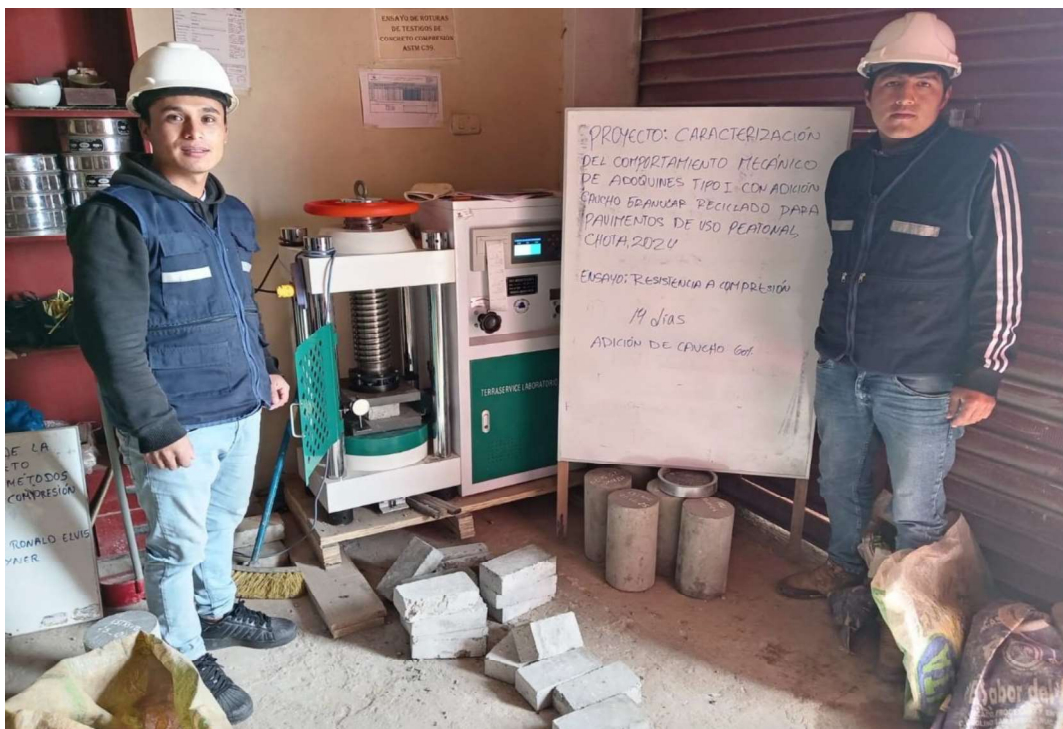
Fotografía 34. Ensayo de Resistencia a la Compresión a los (14 días)
