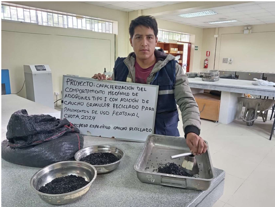
Fotografía 18. Ensayo de peso específico en la muestra de caucho granular
