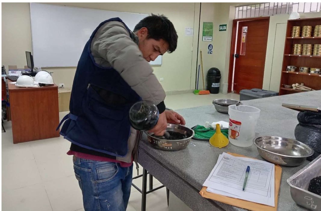
Fotografía 18. Ensayo de peso específico en la muestra de caucho granular
