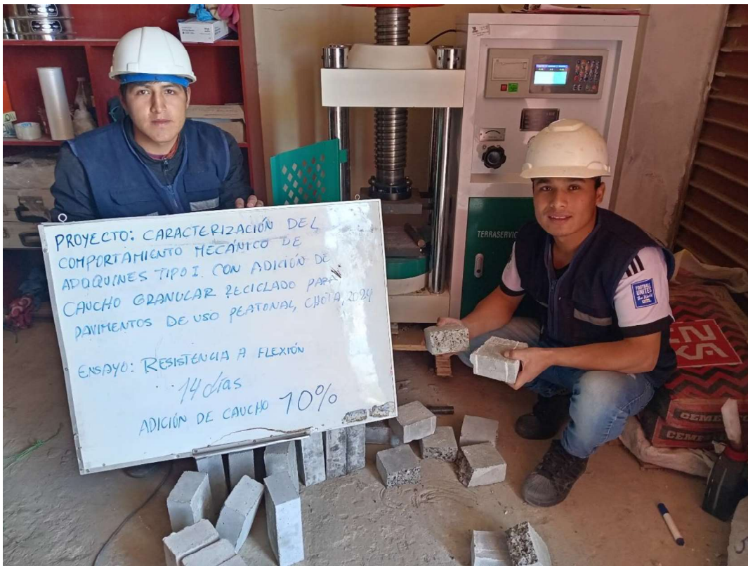
Fotografía 37. Realizando el ensayo a flexión de los adoquines (14 días)
