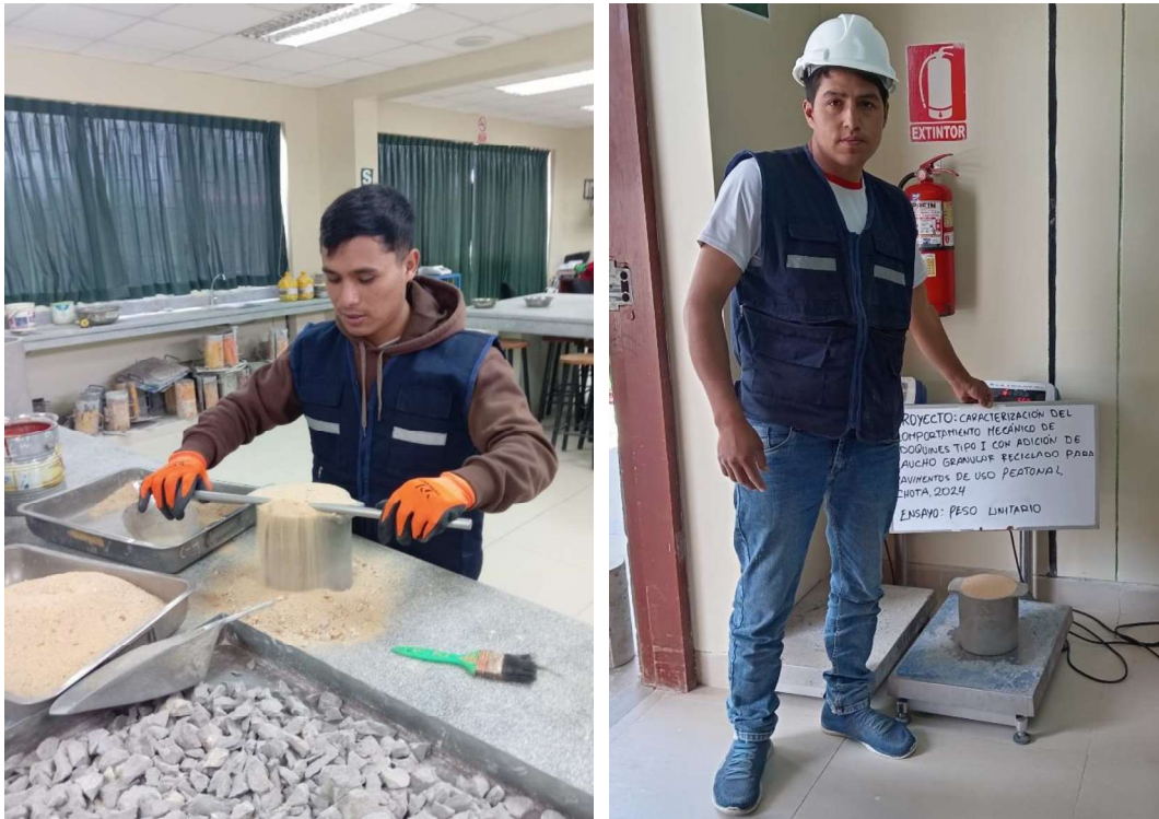
Fotografía 8. Prueba del molde cónico para encontrar la condición de SSS en el agregado fino
