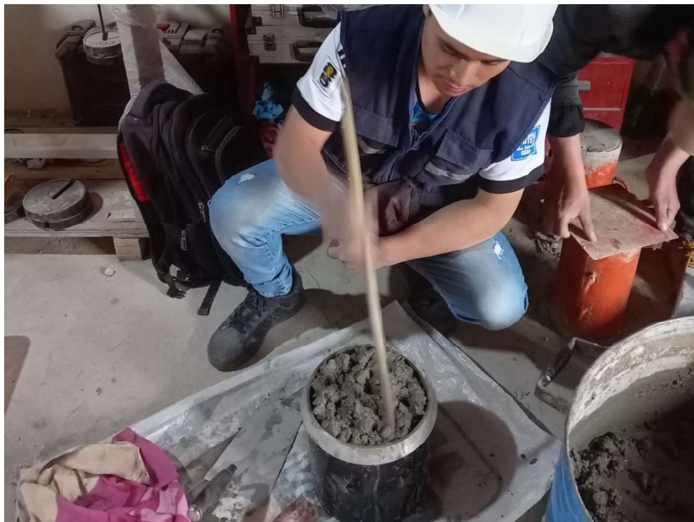
Ensayo de Peso Unitario del Concreto
