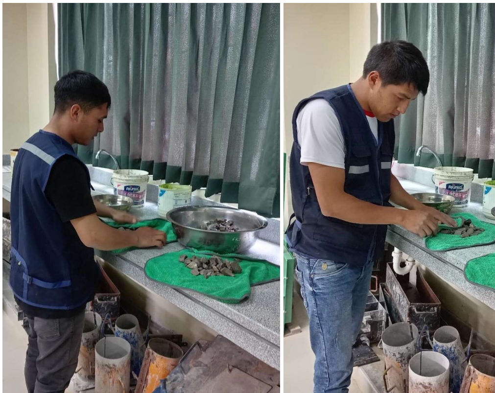
Fotografía 14. Realizando el secado del agregado grueso para el ensayo de peso específico y absorción
