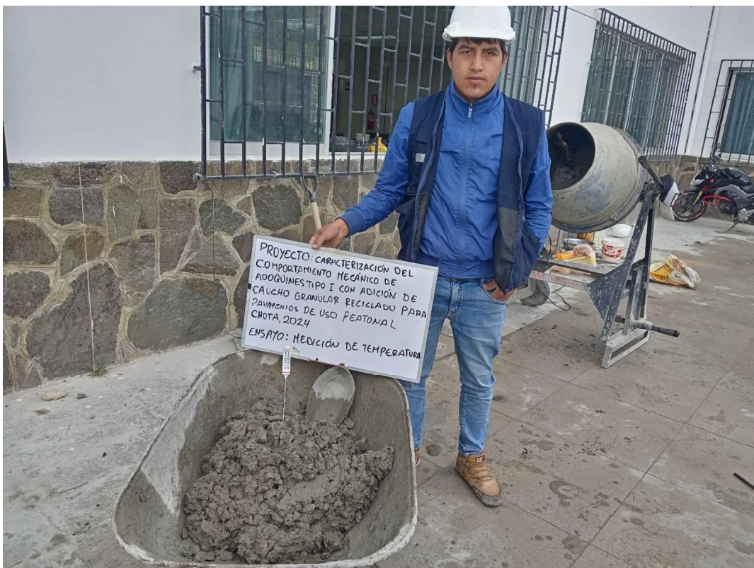
Fotografía 22. Medición de temperatura en la mezcla de concreto
