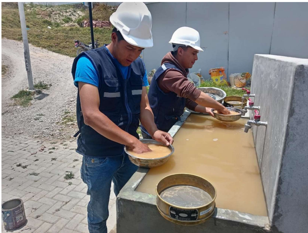
Fotografía 6. Realizando el lavado de la arena en el ensayo de la cantidad de finos que pasa la malla #200
