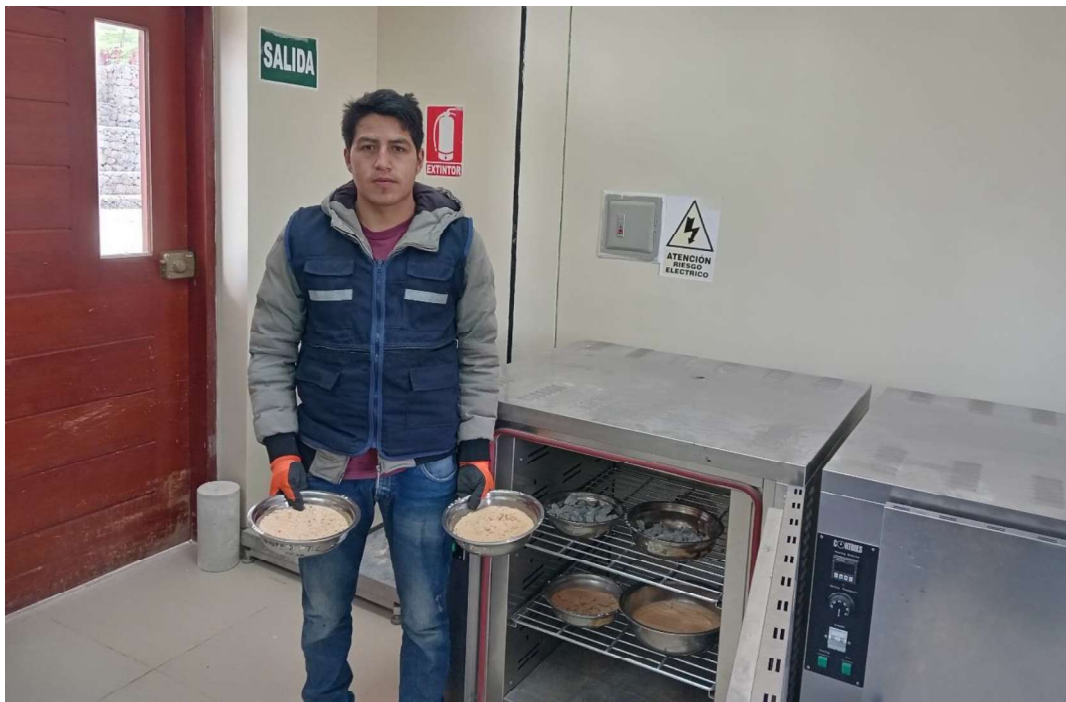
Fotografía 16. Ubicando las muestras en el horno para realizar el respectivo secado
