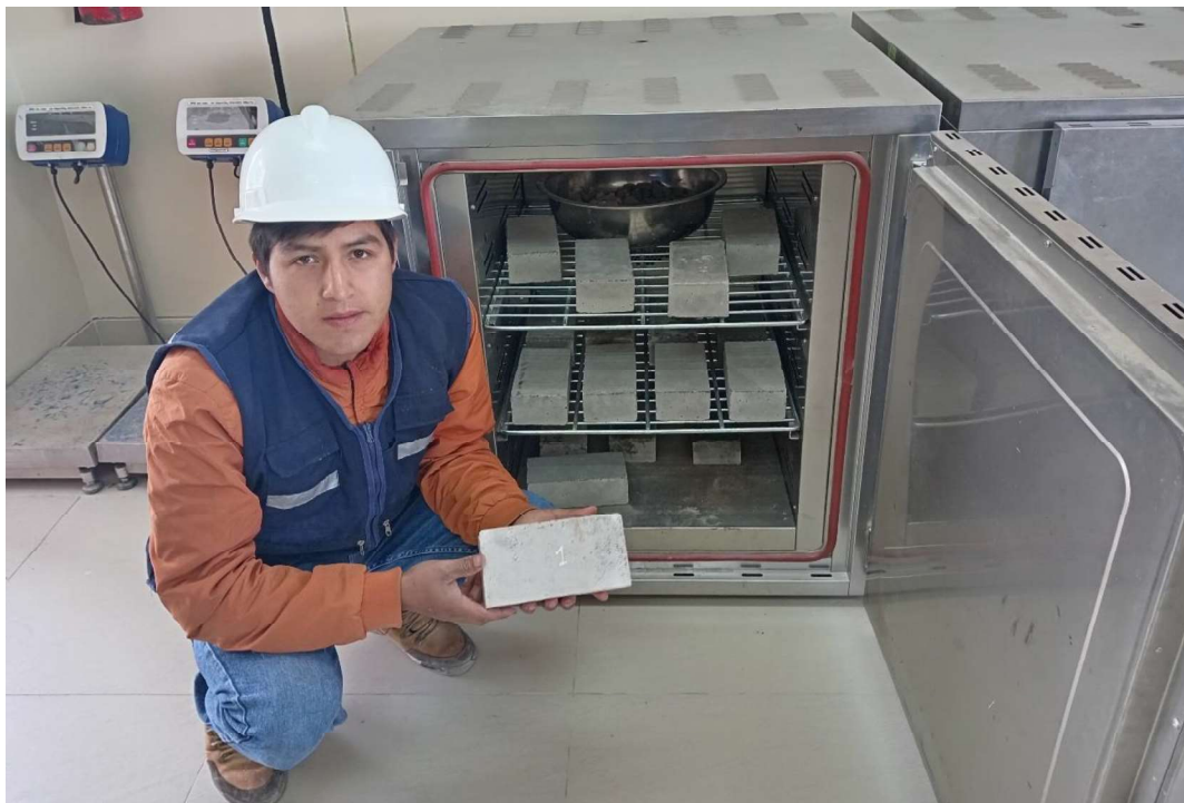
Fotografía 32. Adoquines en el horno para la absorción
