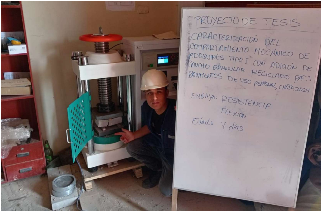
Fotografía 37. Realizando el ensayo a flexión de los adoquines (14 días)
