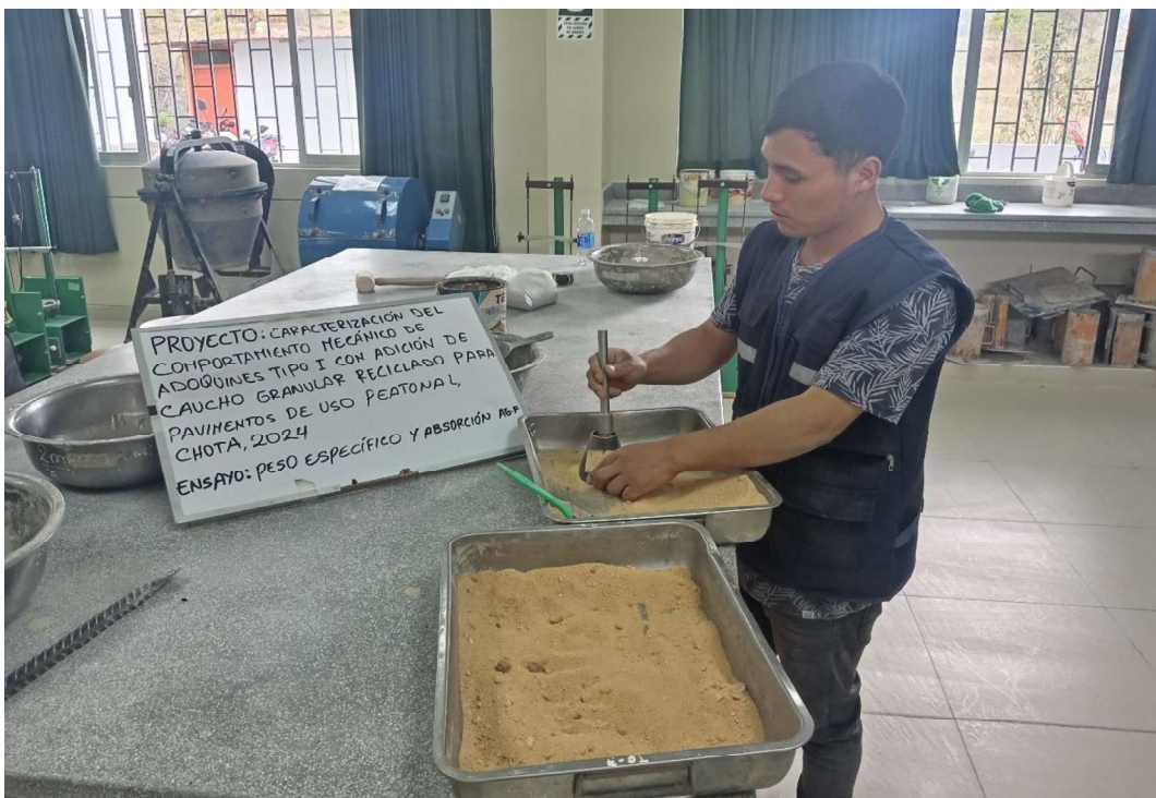
Fotografía 8. Prueba del molde cónico para encontrar la condición de SSS en el agregado fino
