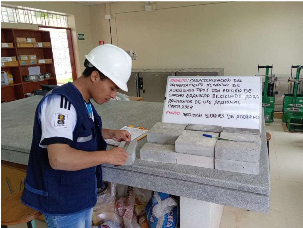
Fotografía 28. Medición de las dimensiones del bloque
