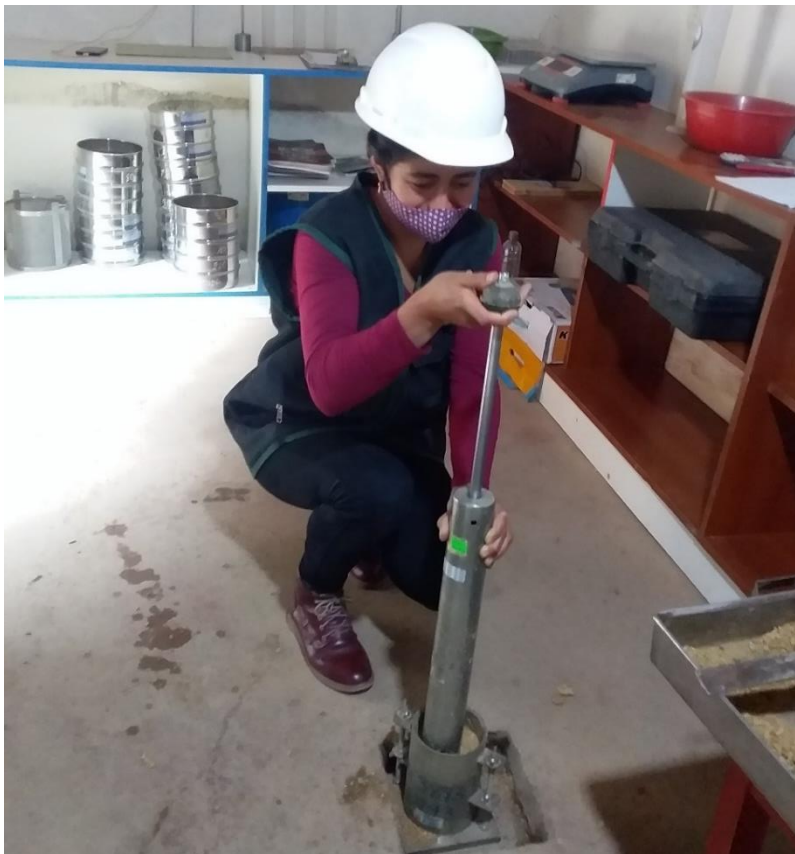
Fotografía 19. Ensayo de CBR
