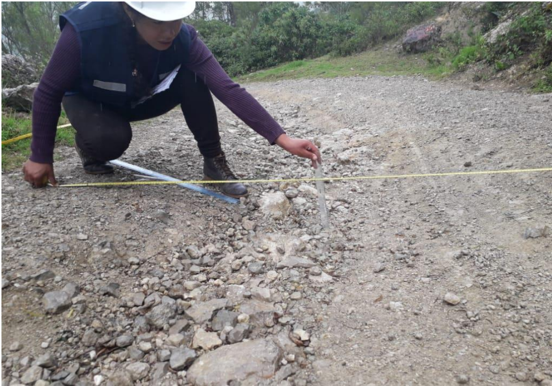
Fotografía 4. Medición de fallas con regla graduada
