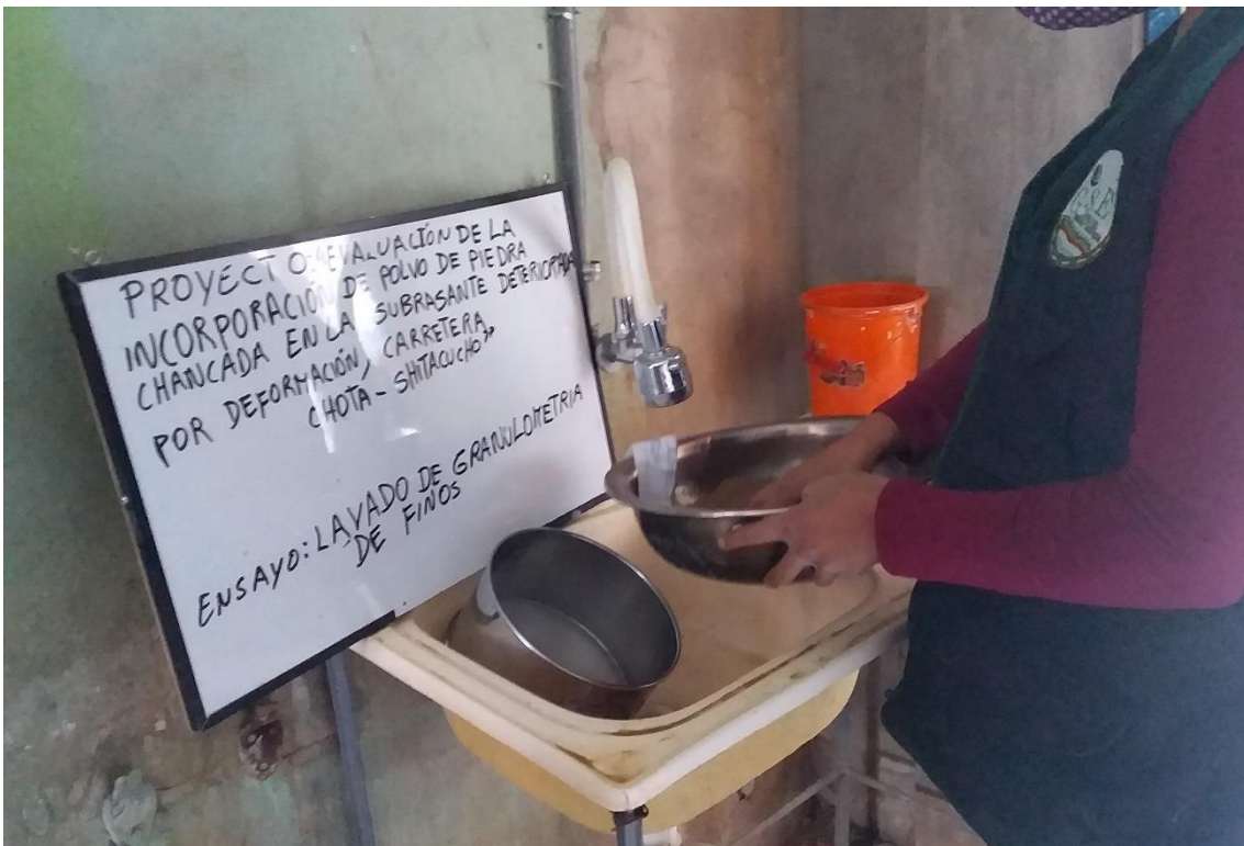
Fotografía 17. Lavado para ensayo granulométrico
