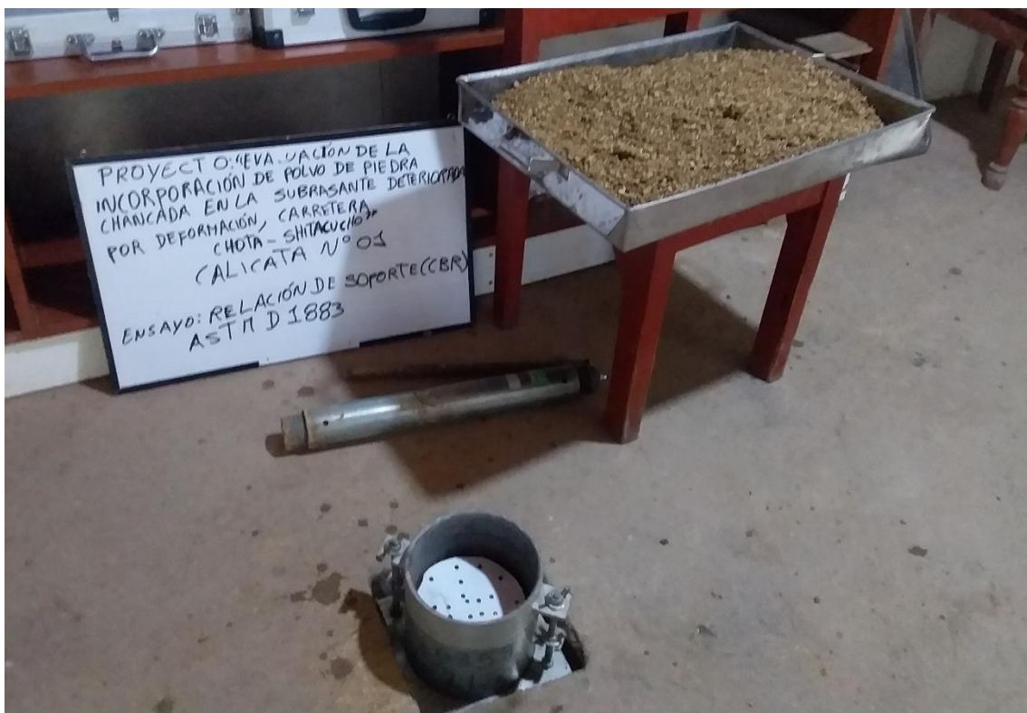
Fotografía 19. Ensayo de CBR
