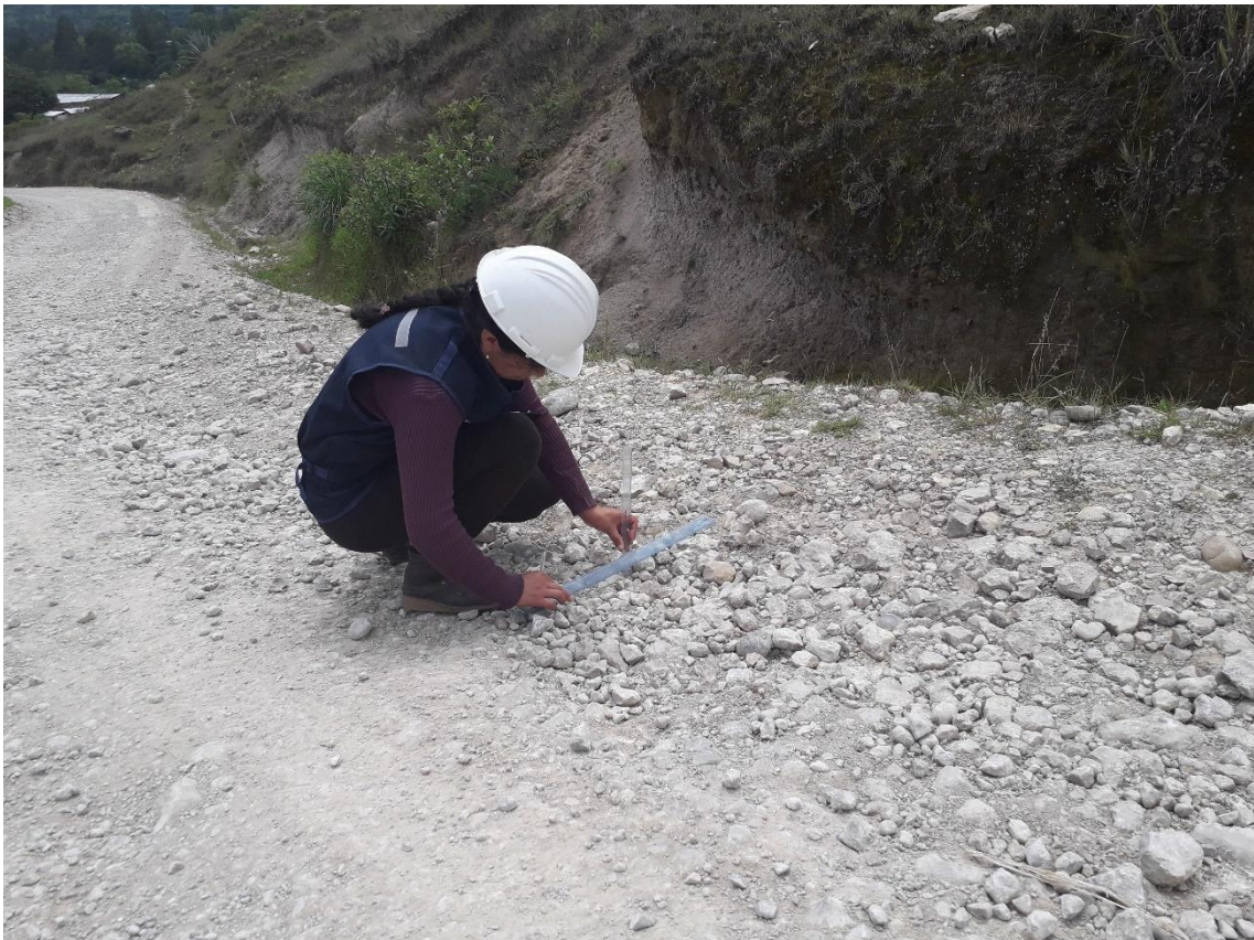
Fotografía 4. Medición de fallas con regla graduada
