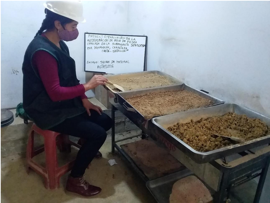
Fotografía 17. Lavado para ensayo granulométrico
