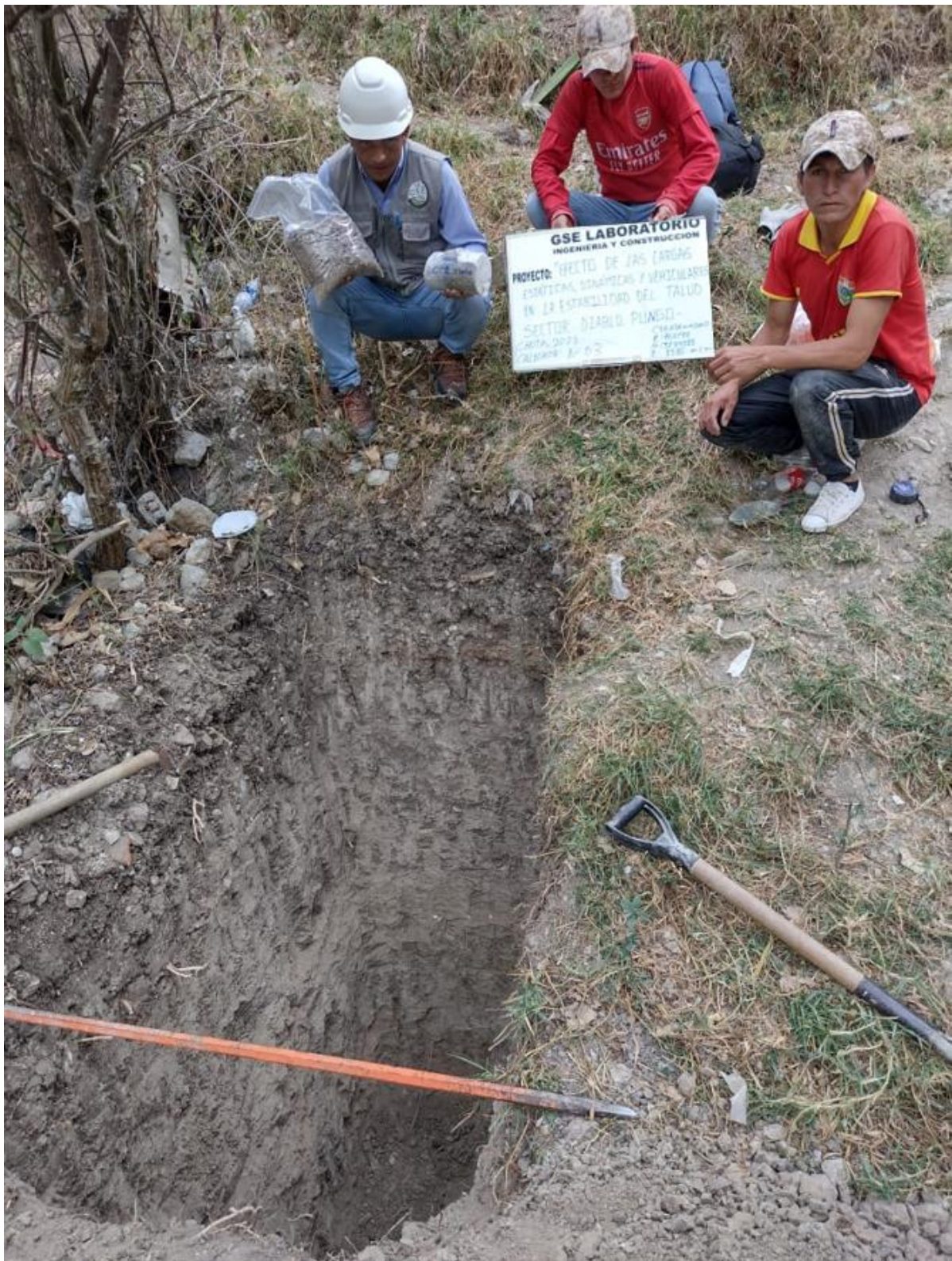
Nota. Obtención de muestra de suelo Calicata 2
