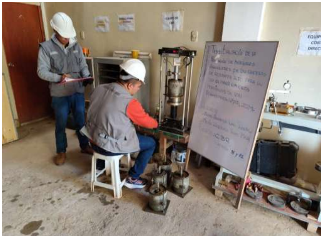
Ensayo de CBR al Material de las Canteras
