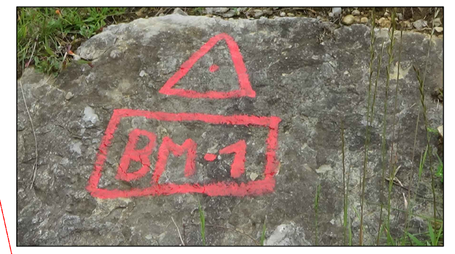
VISTA PANORÁMICA DEL BM N° 01 SOBRE ROCA FIJA
