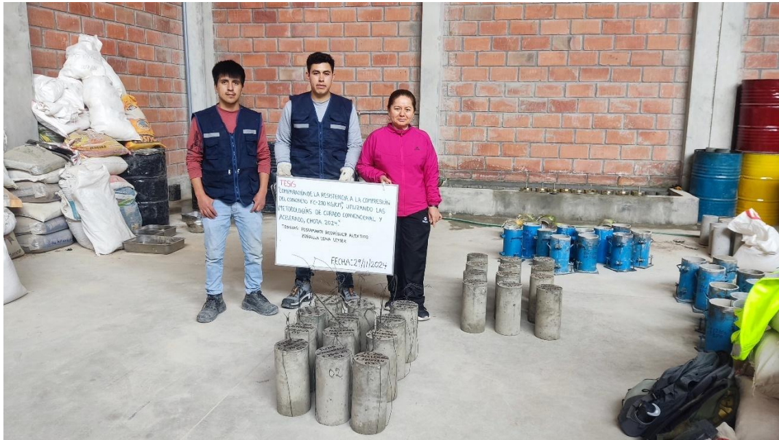
Fotografía 7. Especímenes de concreto para ser curados mediante el método acelerado
