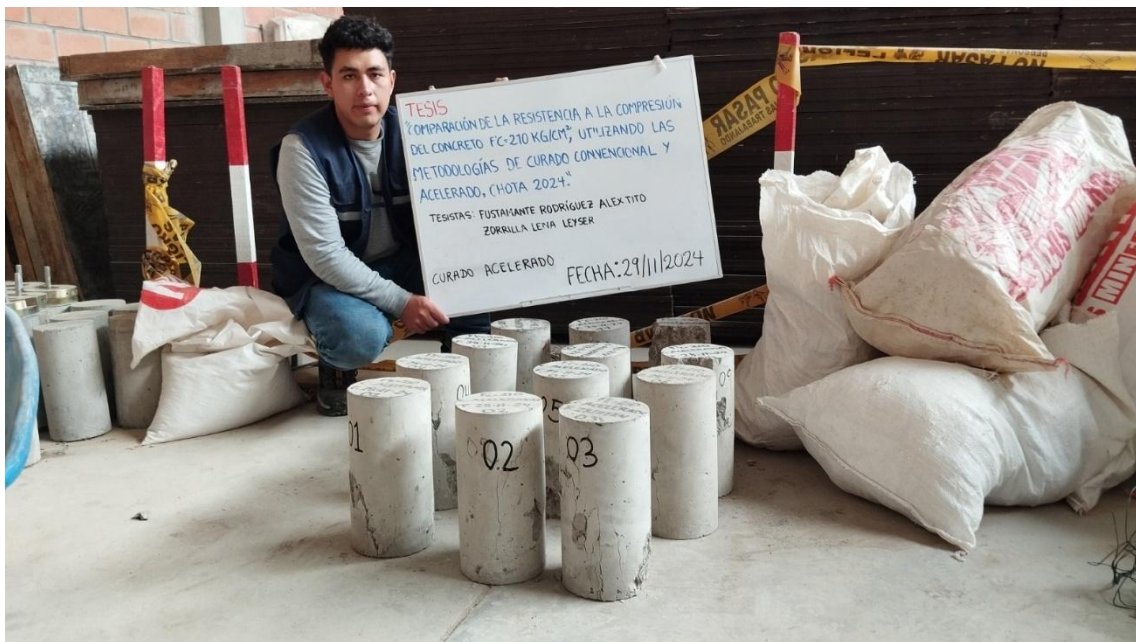
Fotografía 16. Especímenes de concreto con curado acelerado después del ensayo de resistencia a la compresión.
