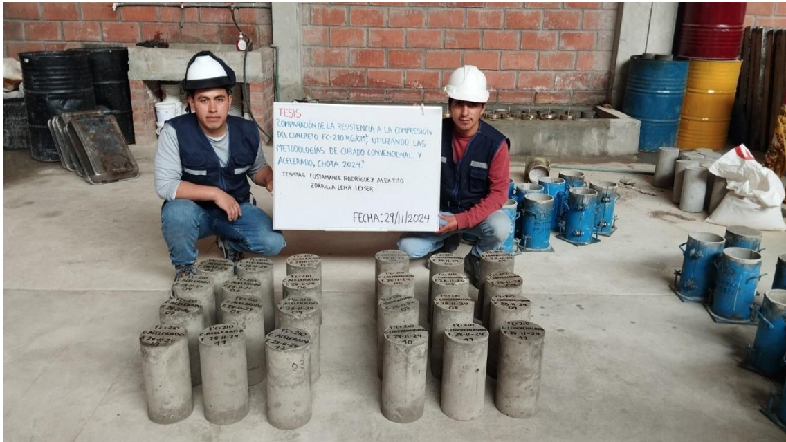
Fotografía 5. Distribución de especímenes de concreto para el curado convencional y acelerado
