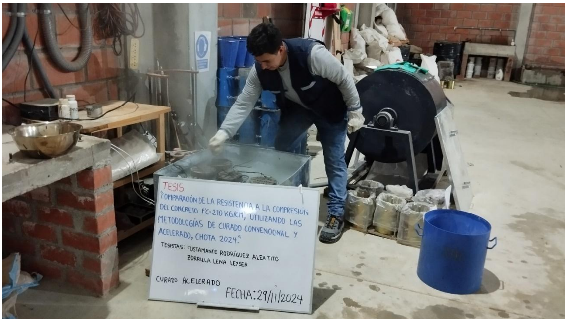
Fotografía 8. Inmersión de especímenes de concreto en tanque de curado acelerado
