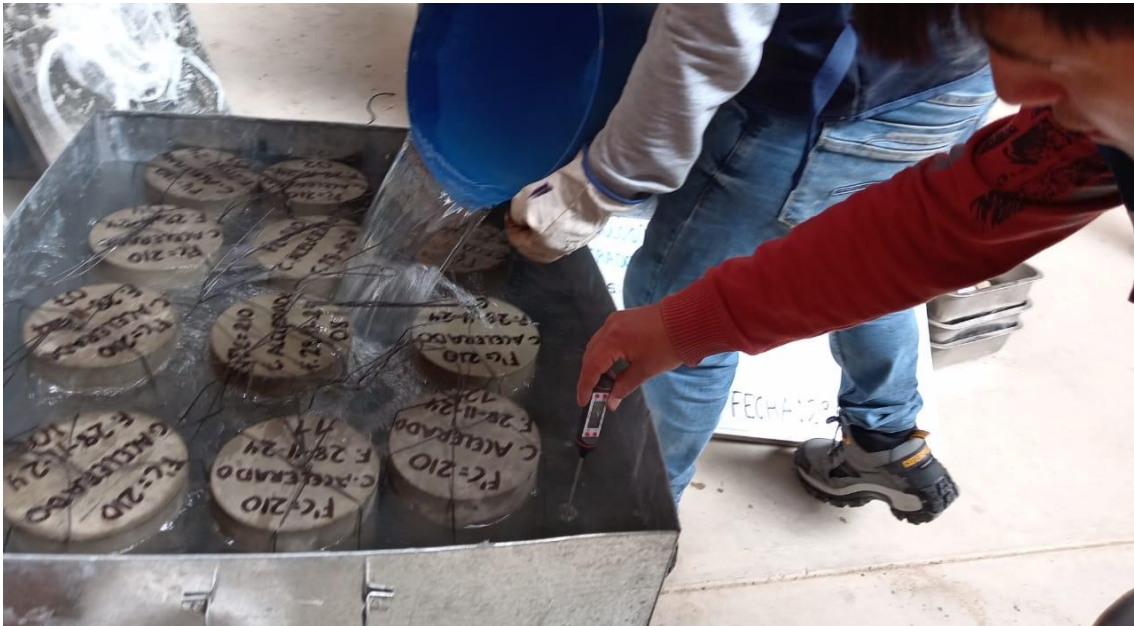
Fotografía 9. Control de temperatura del después de ser introducidos al tanque de curado acelerado
