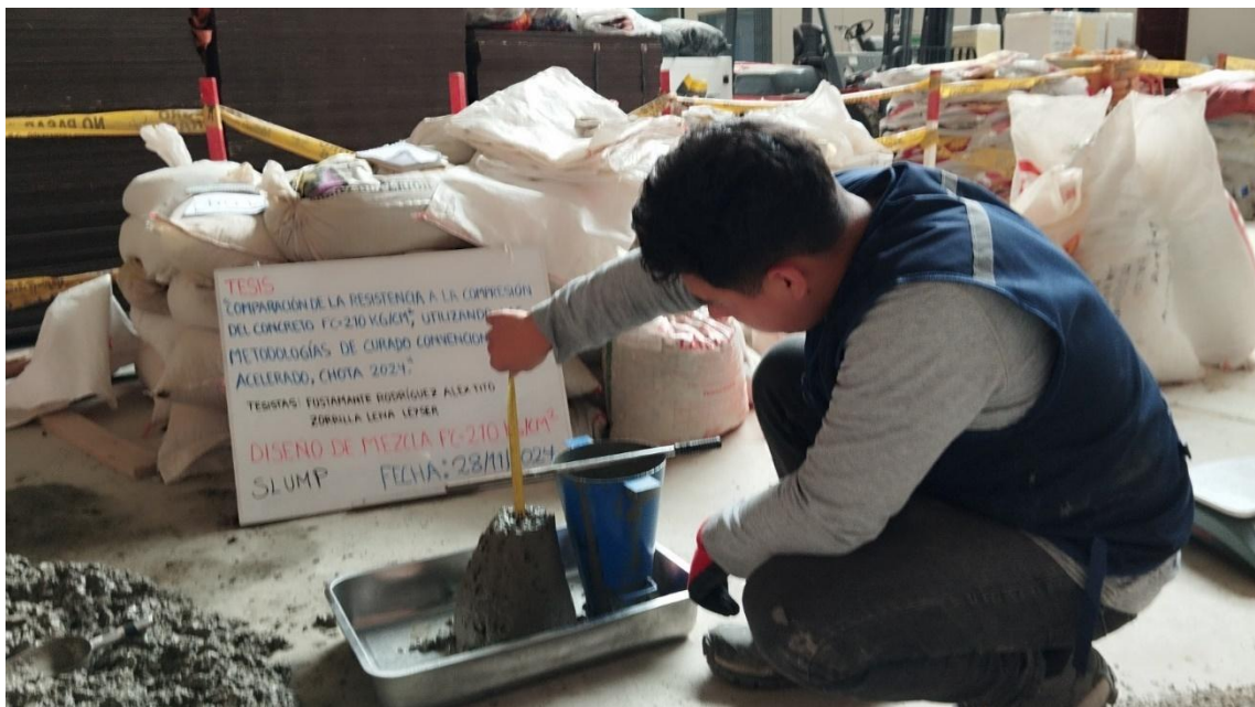
Ensayo de asentamiento del concreto en estado fresco
