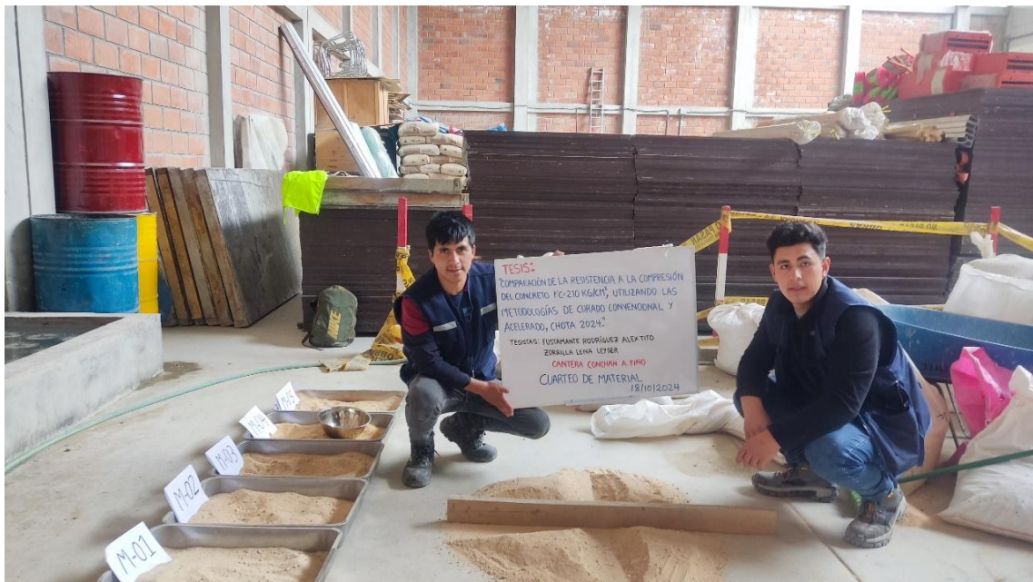
Cuarteo de agregado fino – Cantera Conchán
