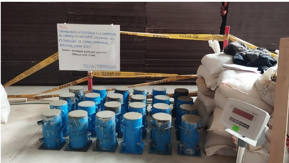
Fotografía 4. Vaciado de concreto en moldes cilíndricos
