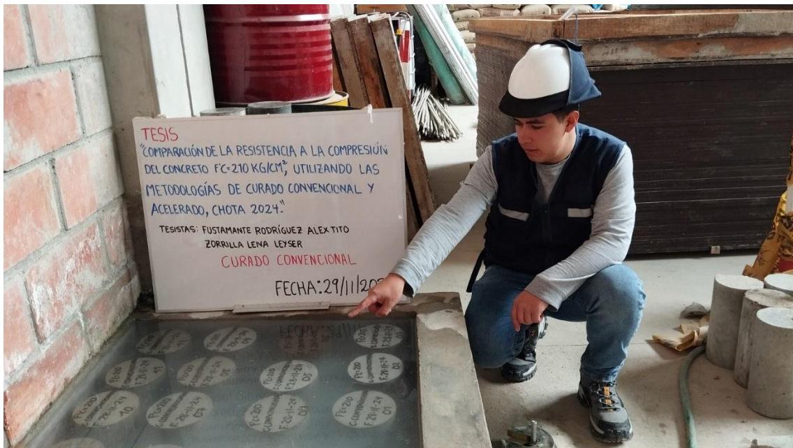
Fotografía 6. Curado convencional del concreto
