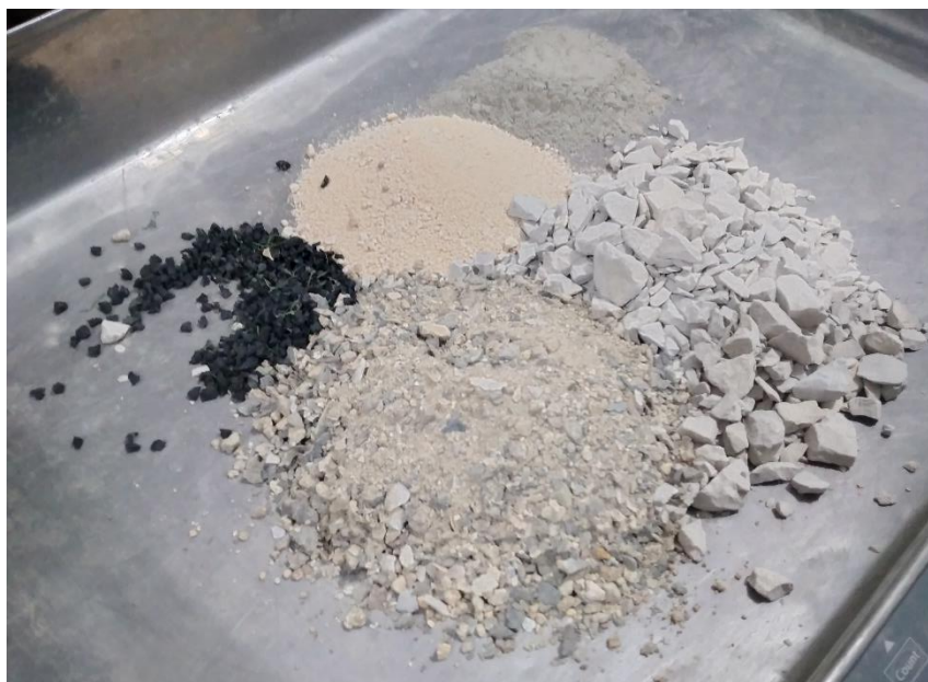
Fotografía 16. Mezcla en porcentaje de los tres agregados y el caucho
