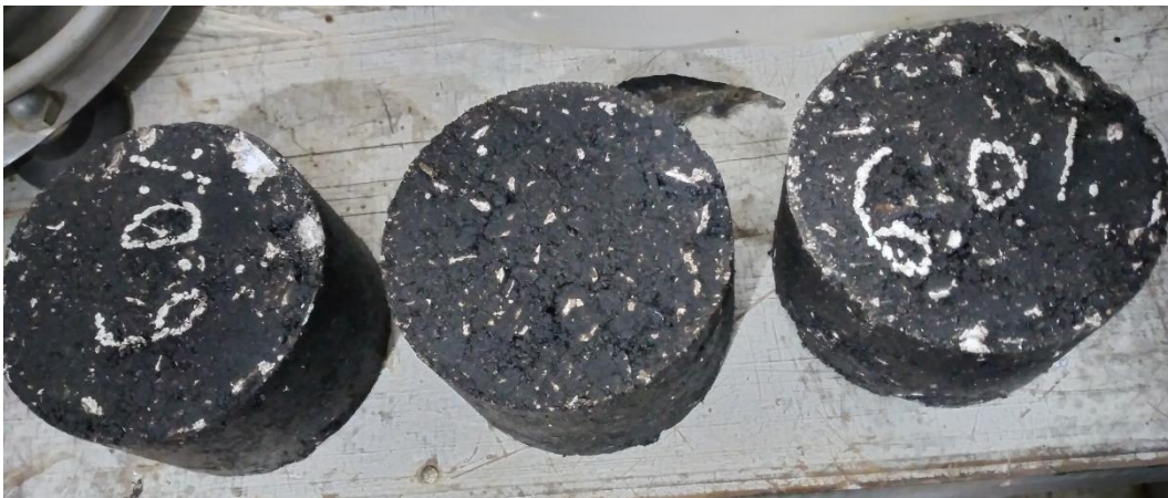
Fotografía 14. Especímenes de mezcla asfáltica convencional en baño maría
