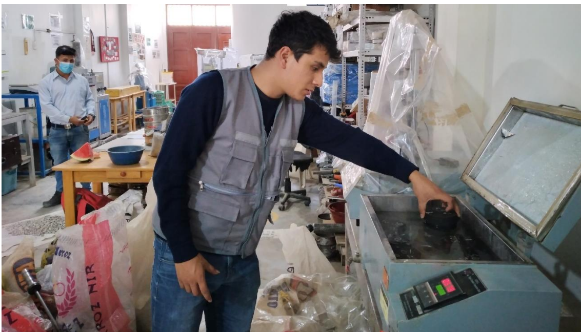
Fotografía 14. Especímenes de mezcla asfáltica convencional en baño maría
