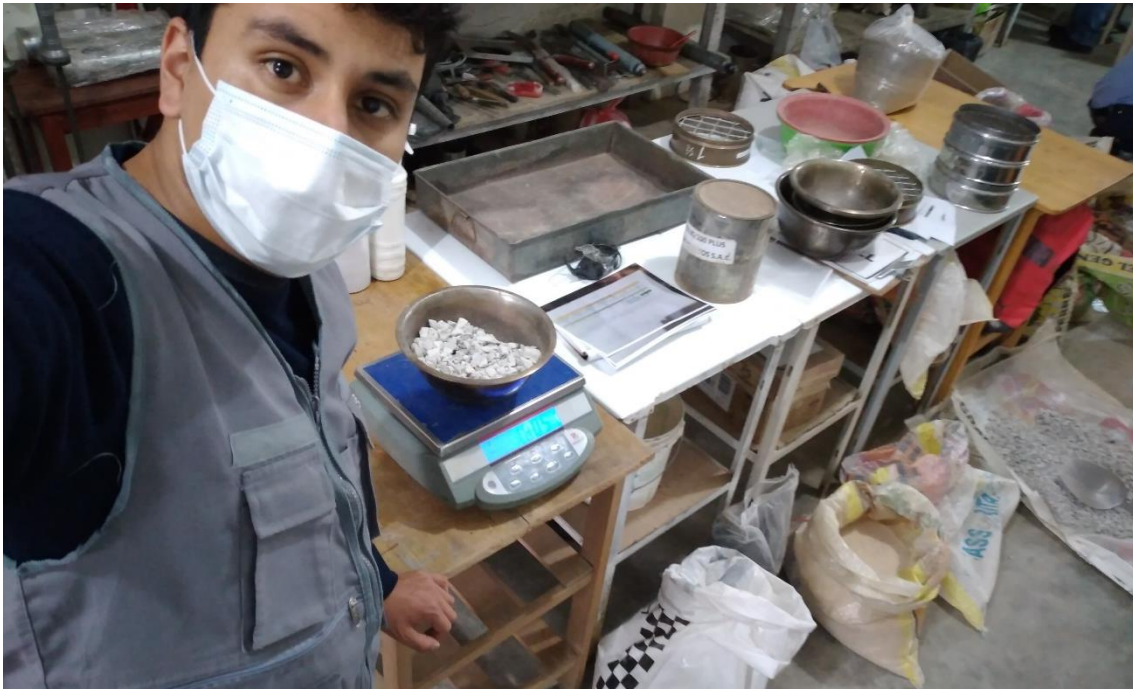
Fotografía 8. Preparación de agregados para elaboración de mezclas asfálticas con diferentes porcentajes de cemento asfáltico
