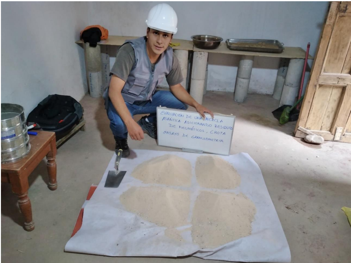
Fotografía 4. Ensayo de granulometría al agregado fino
