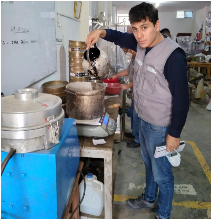
Fotografía 11. Elaboración de la mezcla asfáltica
