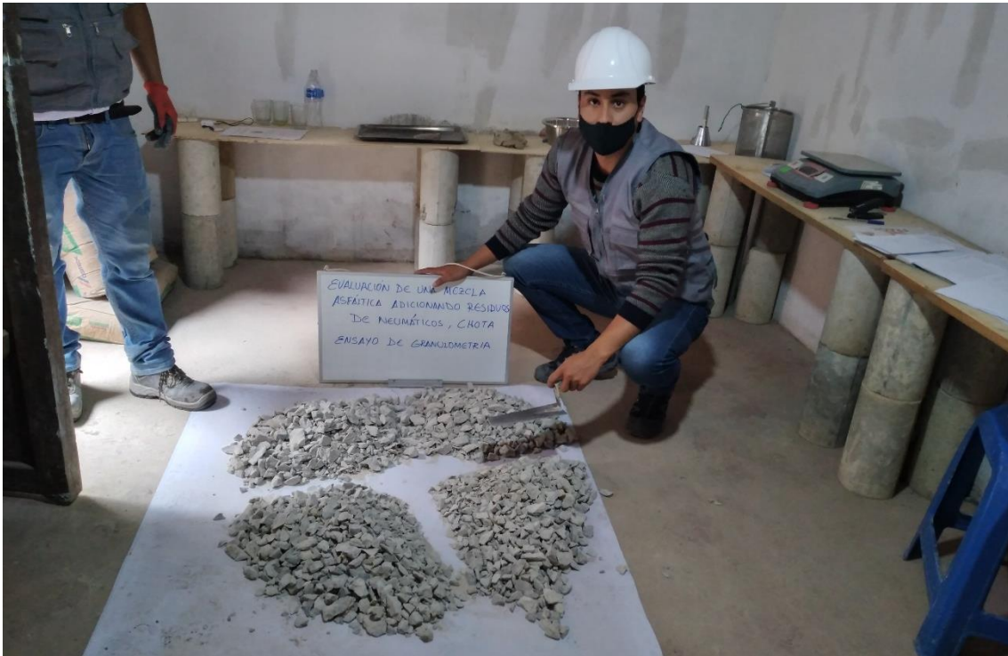
Fotografía 3. Ensayo de granulometría al agregado grueso
