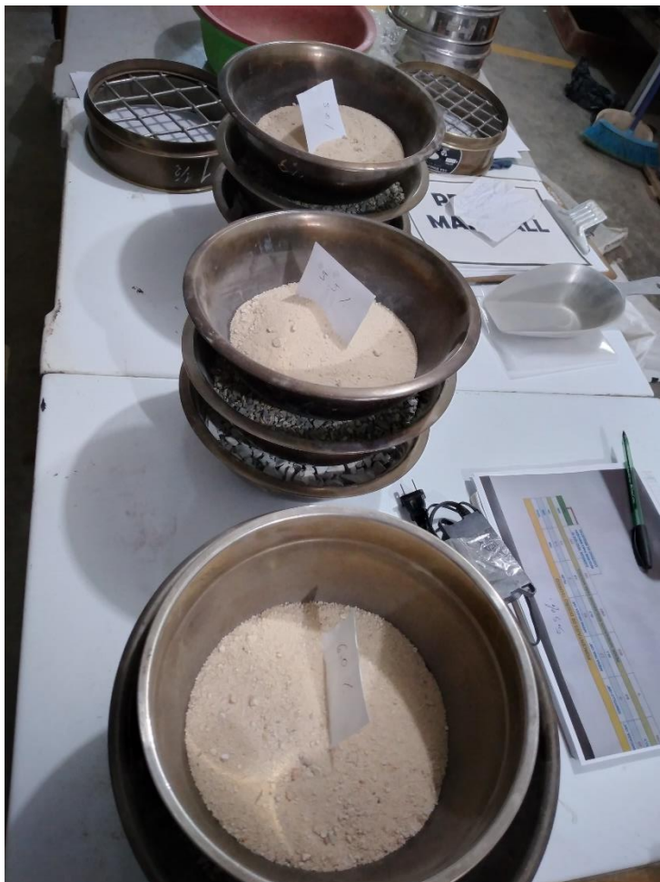
Fotografía 8. Preparación de agregados para elaboración de mezclas asfálticas con diferentes porcentajes de cemento asfáltico
