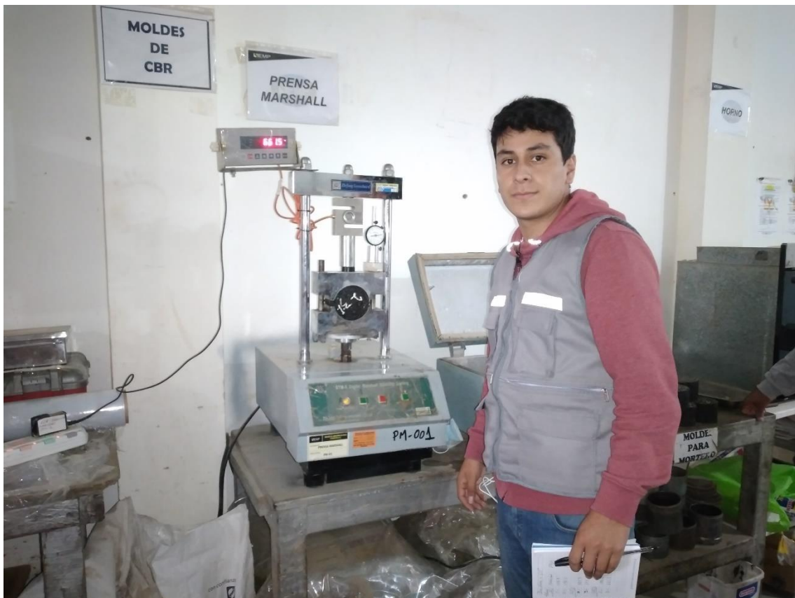
Fotografía 20. Ensayo Marshall en la mezcla asfáltica modificada
