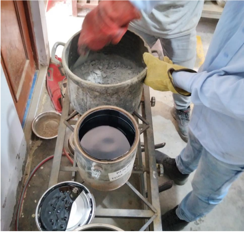
Fotografía 9. Cemento asfáltico para la elaboración de la mezcla
