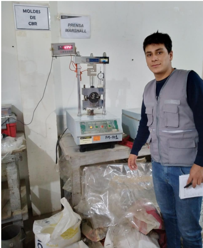
Fotografía 15. Ensayo Marshall en la mezcla asfáltica convencional
