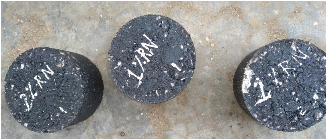
Fotografía 17. Muestras de mezclas asfálticas con diferentes porcentajes de caucho reciclado triturado
