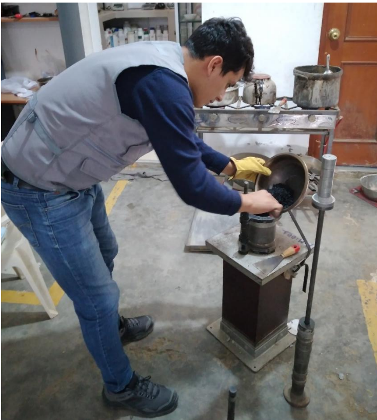
Fotografía 12. Mezcla asfáltica en caliente
