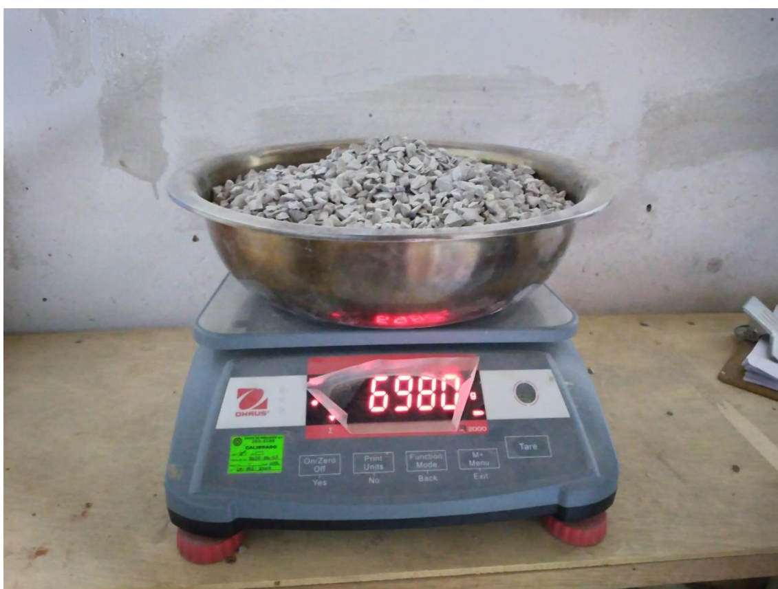
Fotografía 6. Ensayo de caras fracturadas
