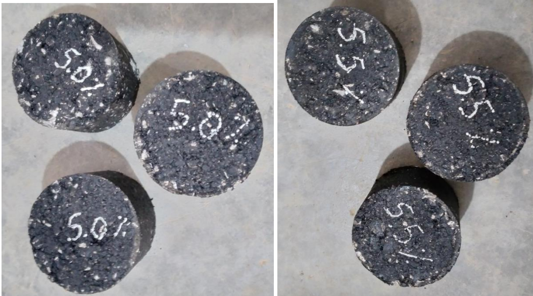
Fotografía 13. Muestras de mezcla asfáltica con diferentes porcentajes de cemento asfáltico
