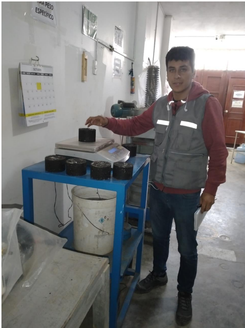
Fotografía 18. Peso unitario de la mezcla asfáltica
