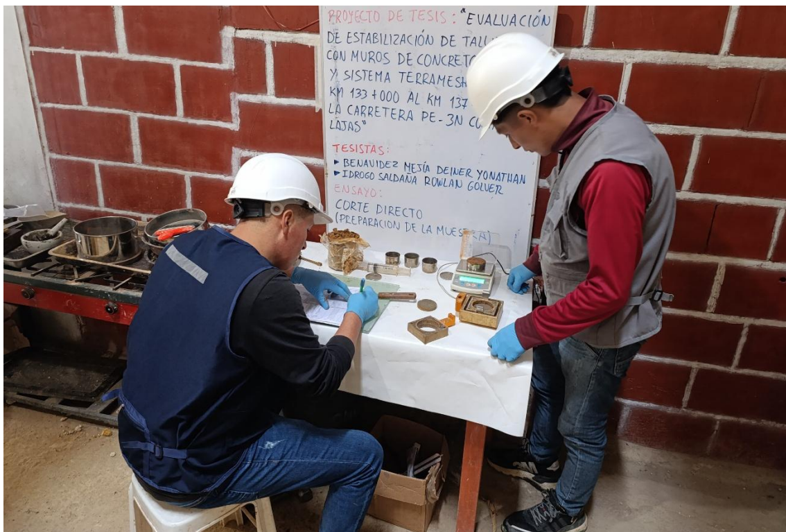
Fotografía 16. Registro de datos de interés para la ejecución del ensayo de corte directo
