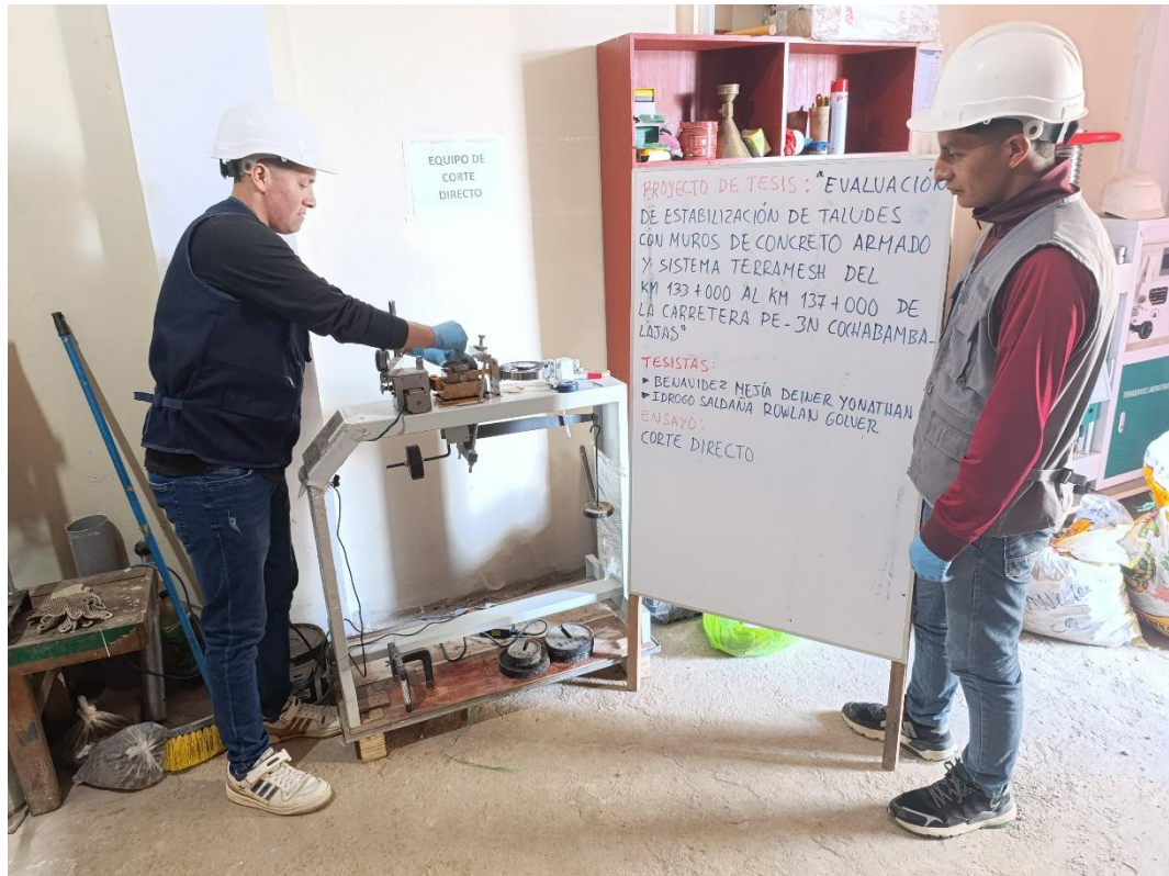
Proceso de Realización del Ensayo de Corte Directo
