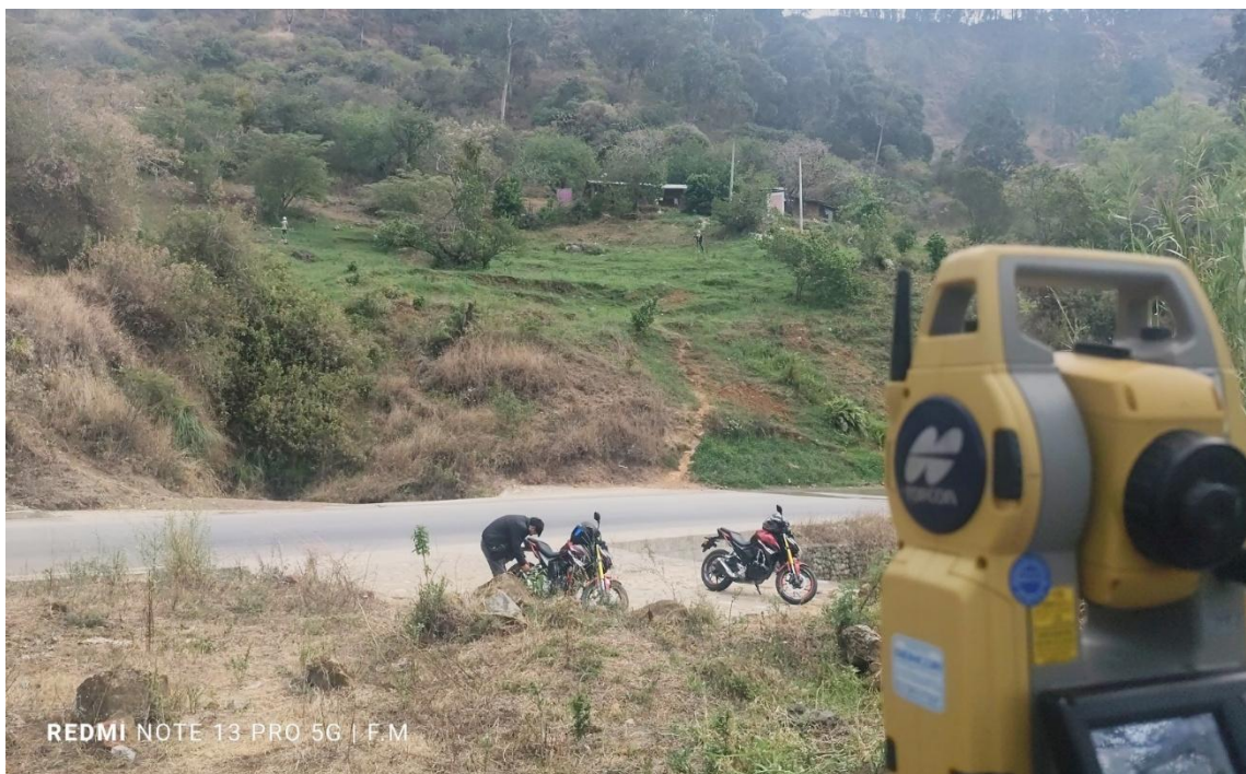
Fotografía 2. Realización del levantamiento topográfico en el talud El Ingenio
