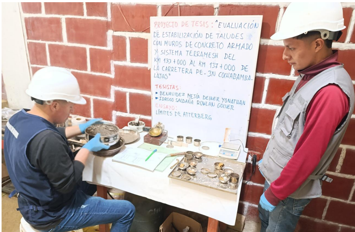
Fotografía 14. Realización del ensayo de límite líquido del suelo
