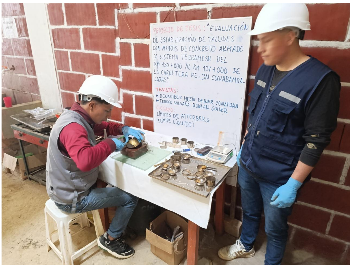
Fotografía 14. Realización del ensayo de límite líquido del suelo
