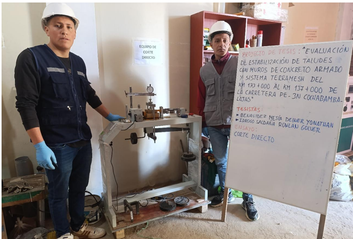
Fotografía 18. Colocación de muestras para el ensayo de corte directo
