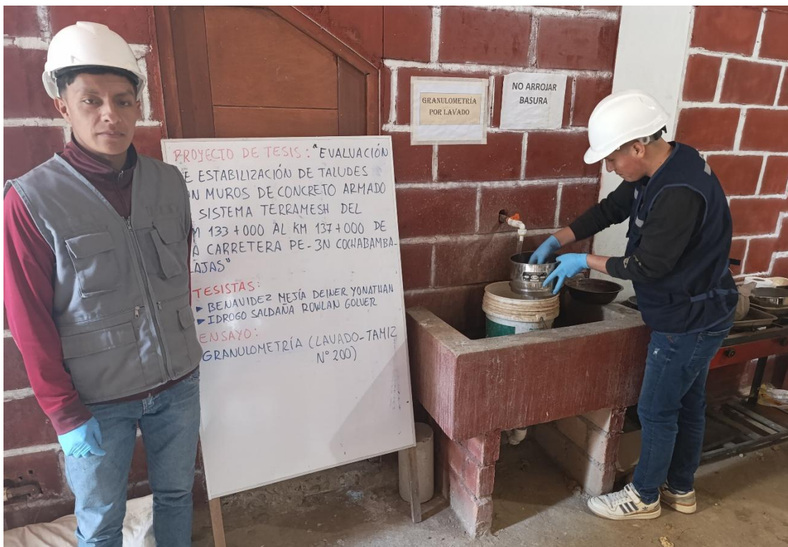
Fotografía 12. Análisis granulométrico en las muestras de suelo
