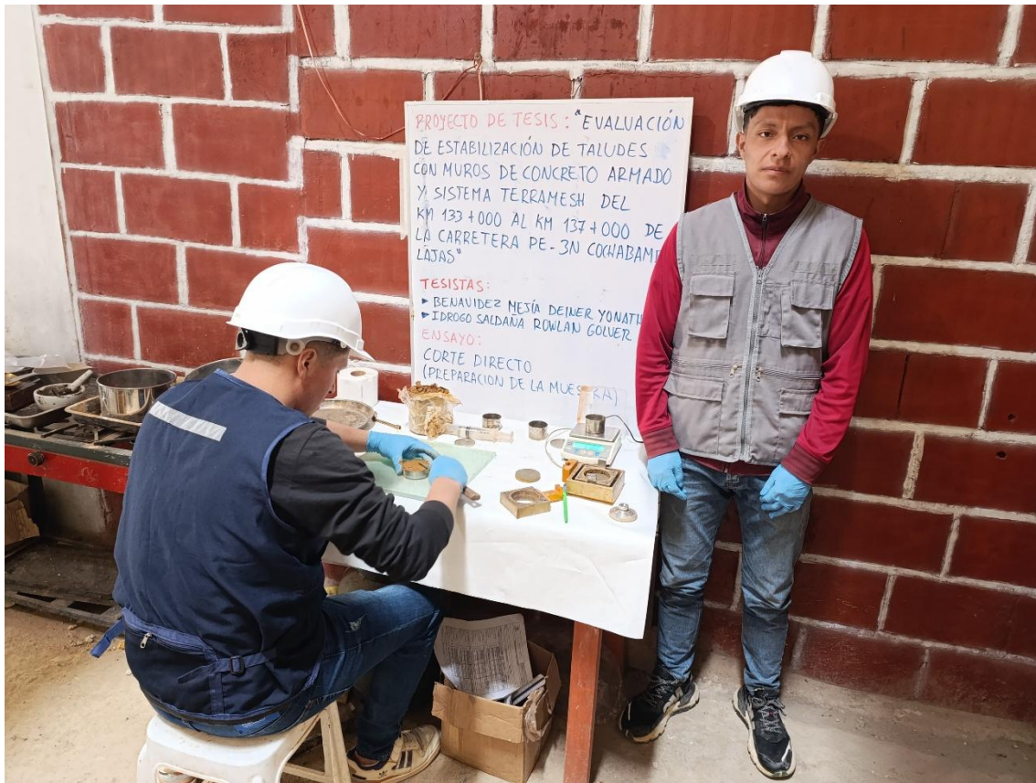
Fotografía 18. Colocación de muestras para el ensayo de corte directo
