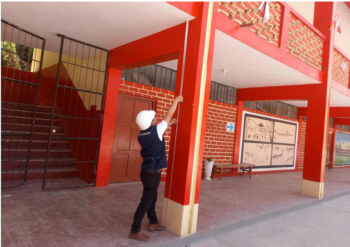
Fotografía 4 Ensayo de Esclerometría en el colegio SCJ
