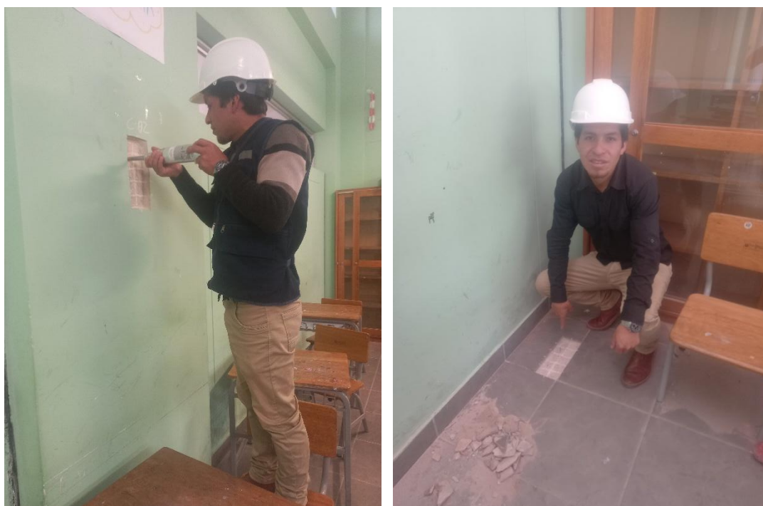
Fotografía 6 Ensayo de esclerometría en el colegio San Juan
