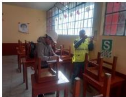
Foto: 02 Señalización del punto de ensayo en columna
