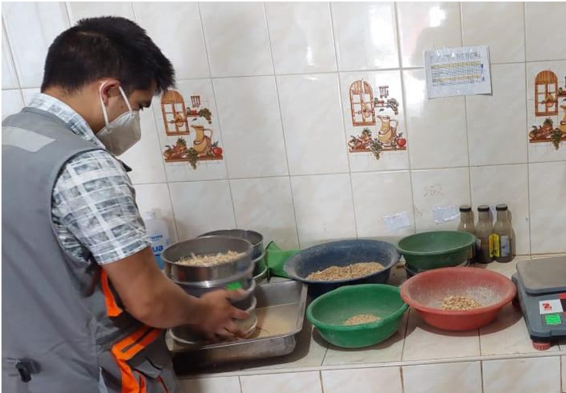
Fotografía 8. Elaboración de la mezcla para la producción de concreto
