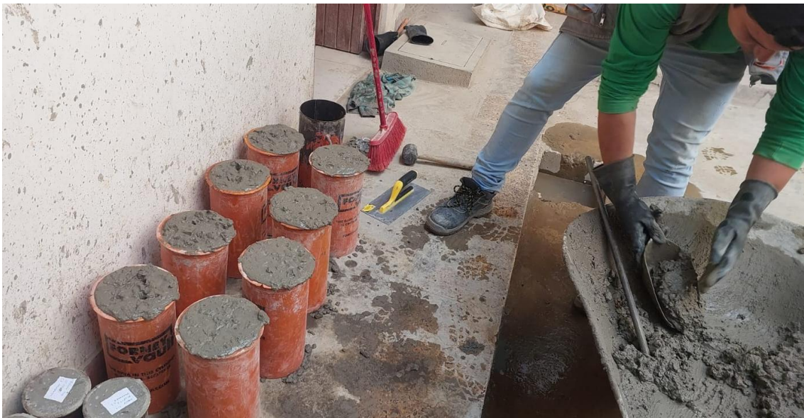
Fotografía 9. Colocación de la mezcla de concreto en los moldes para la elaboración de las probetas
