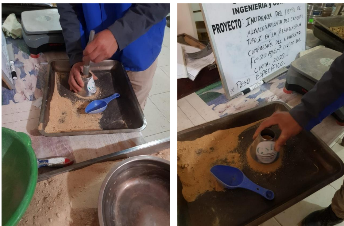
Fotografía 6. Ensayo de peso específico en el agregado fino
