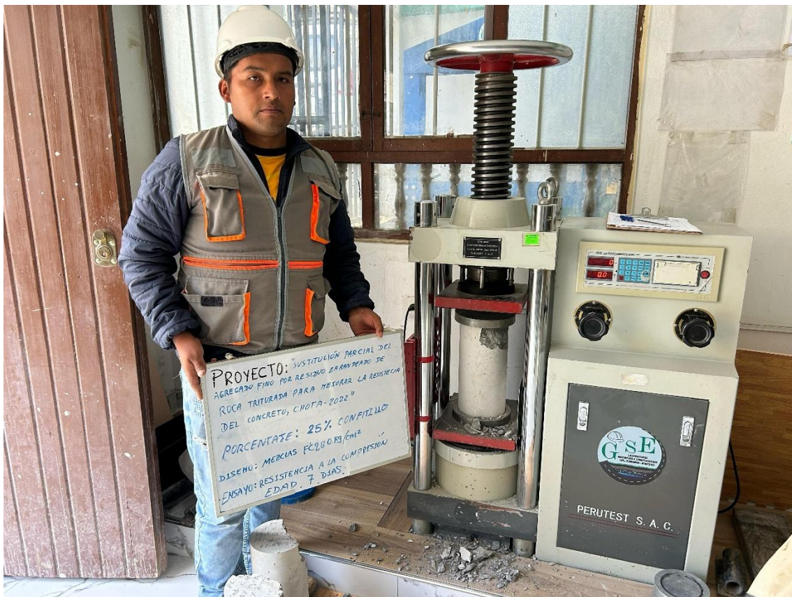
Fotografía 14. Realización del ensayo de resistencia a compresión en probetas de concreto a los 14 días
