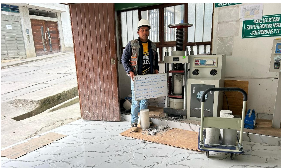
Fotografía 14. Realización del ensayo de resistencia a compresión en probetas de concreto a los 14 días
