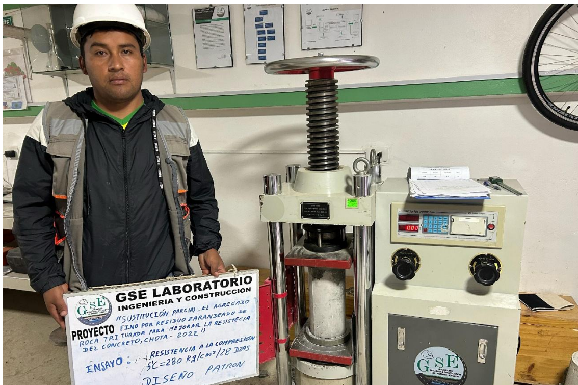
Fotografía 16. Realización del ensayo de resistencia a compresión en probetas de concreto a los 28 días, en especímenes con 50% de residuos zarandeados de roca triturada
