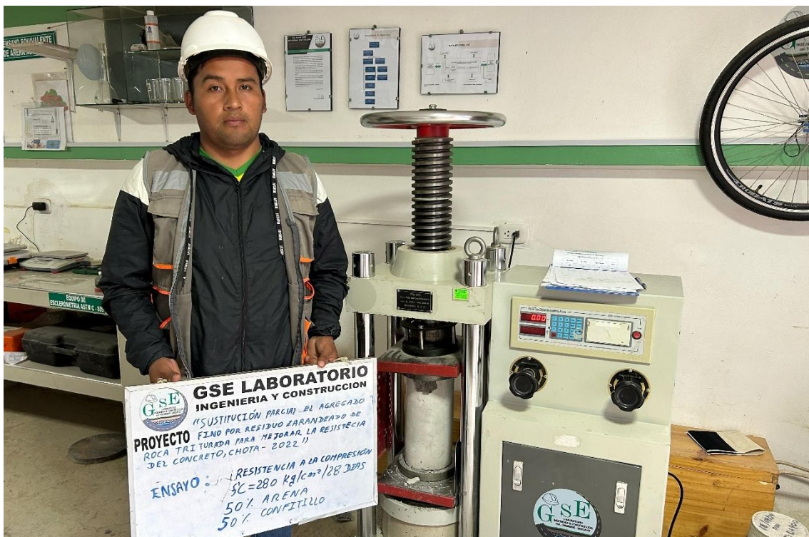
Fotografía 16. Realización del ensayo de resistencia a compresión en probetas de concreto a los 28 días, en especímenes con 50% de residuos zarandeados de roca triturada
