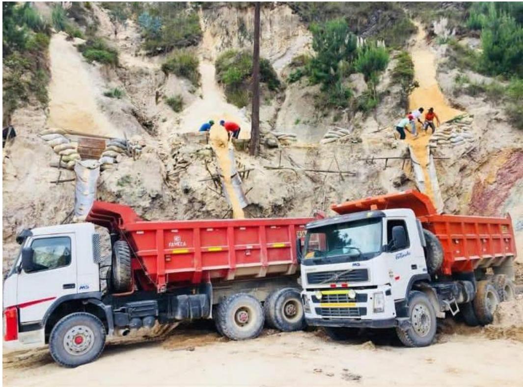
Figura 15 Proceso de Extracción de Agregado Grueso y Residuo Zarandeado de Roca en la Cantera Los Andes de Colpatuapampa
