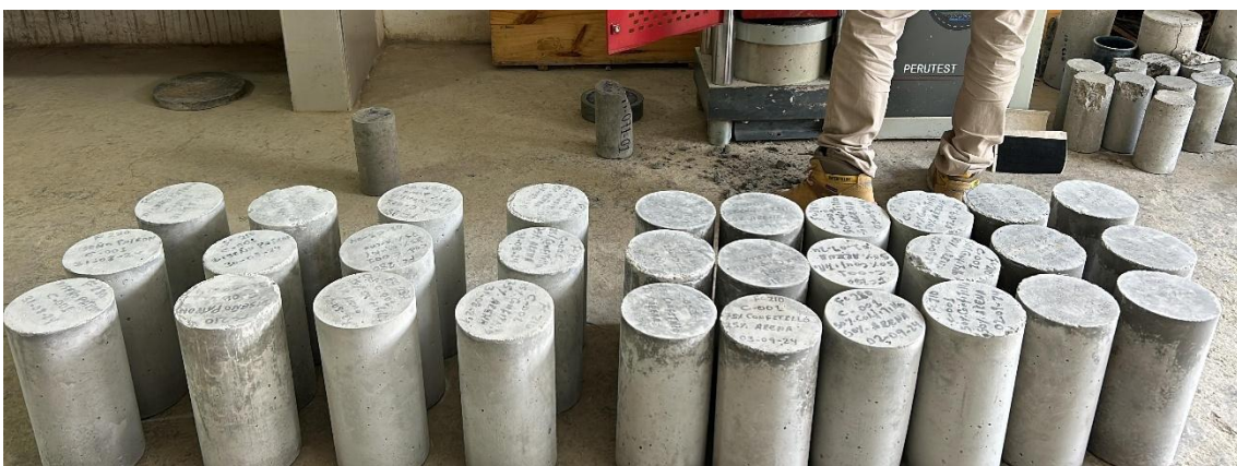
Fotografía 12. Vista de las probetas de concreto en la máquina de compresión para la verificación de su peso y dimensiones previo al ensayo mecánico
