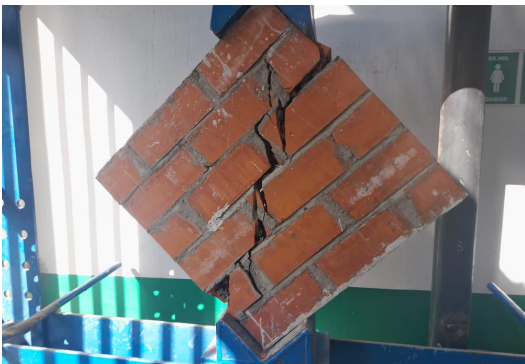
Fotografía 25 Rotura del murete luego del ensayo de corte diagonal en muretes de ladrillo King Kong de 18 huecos asentados con mortero 1:3 cemento: arena
