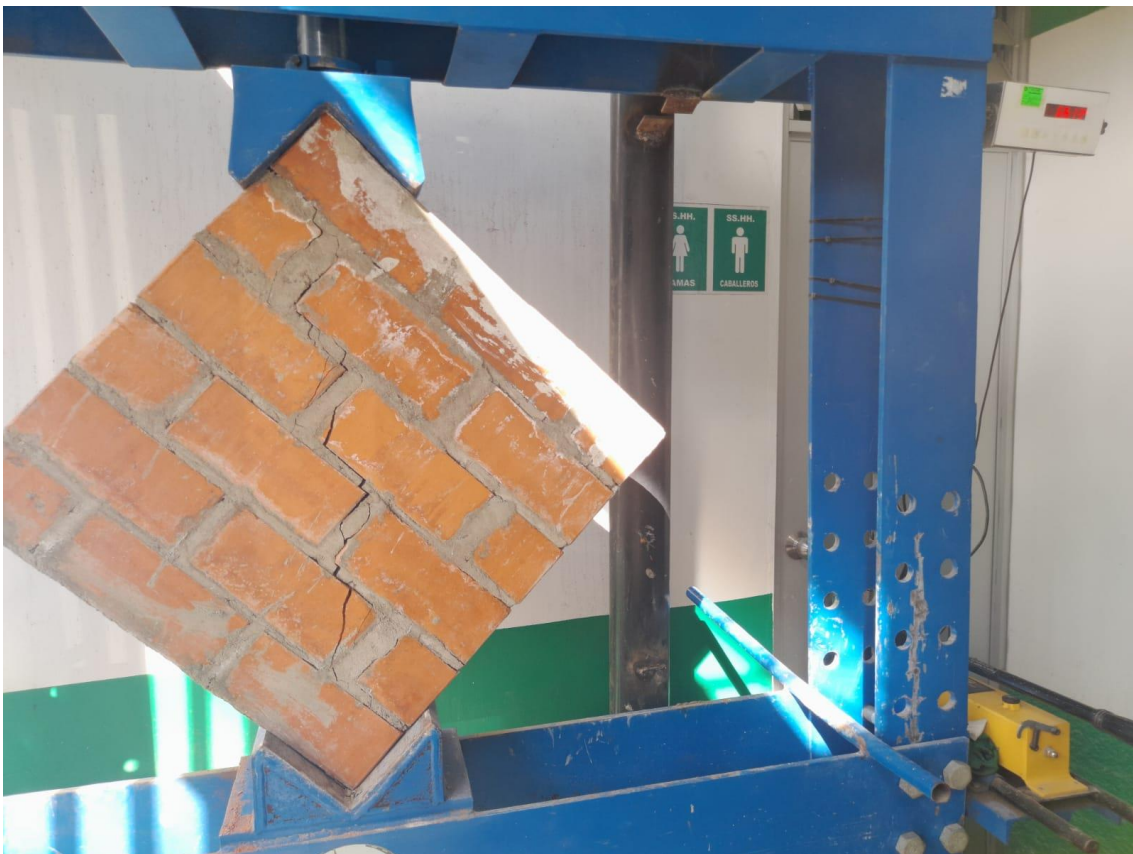
Fotografía 36 Rotura luego del ensayo de corte diagonal en muretes elaborados con ladrillo King Kong de 18 huecos asentados con mortero 1:4 de cemento: filler calizo
