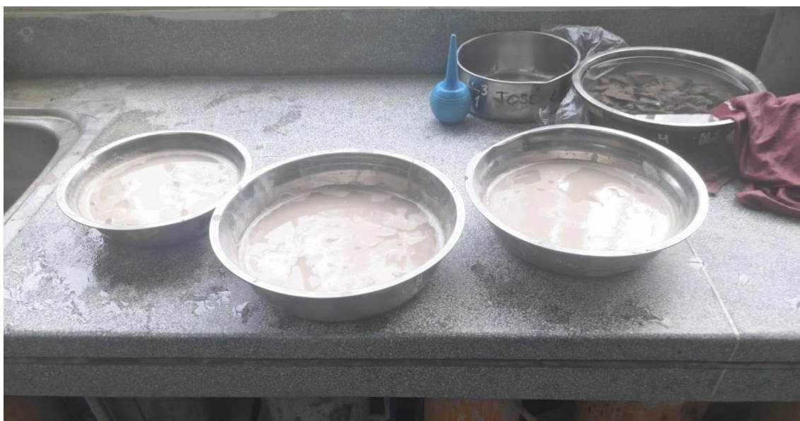
Fotografía 10 Verificación de la condición saturado superficialmente seco durante la realización del ensayo de peso específico del filler calizo
