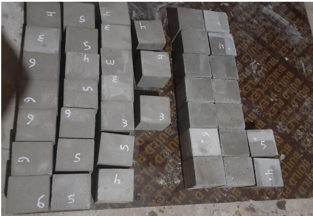
Figura 11 Cubos de Mortero en Proceso de Curado
