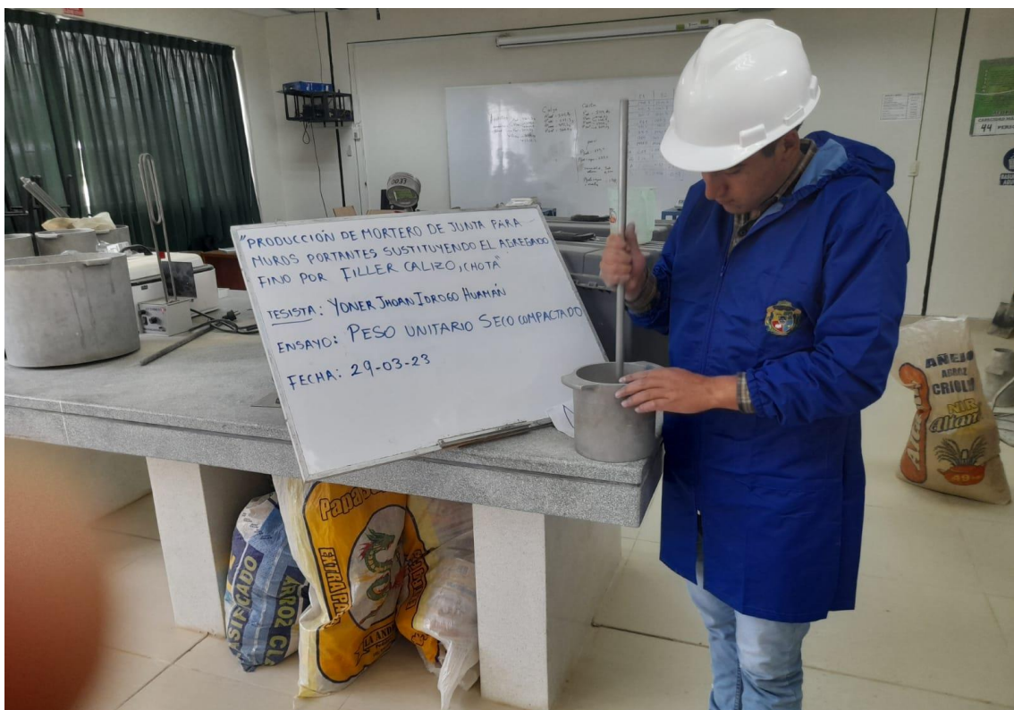
Fotografía 6 Varillado de la muestra de arena de la cantera Conchán para someterlo al ensayo de peso unitario compactado
