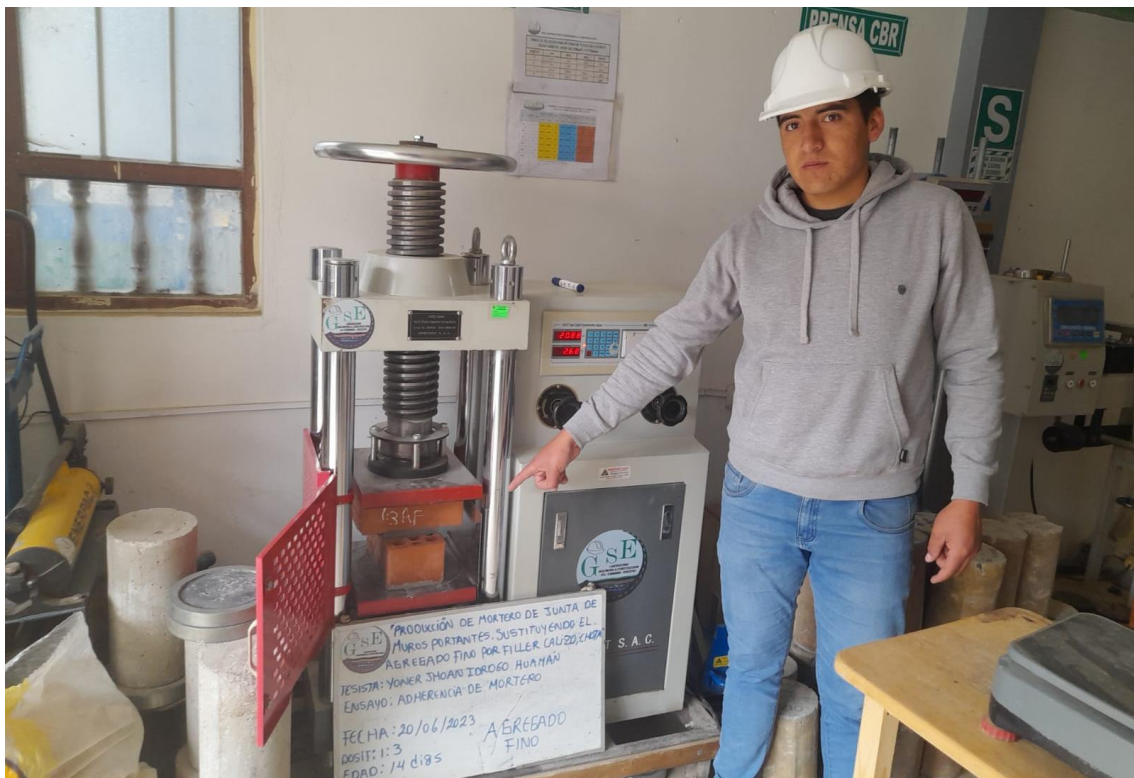
Fotografía 20 Construcción de pilas de ladrillo King Kong de 18 huecos asentado con mortero 1:3 cemento: arena
