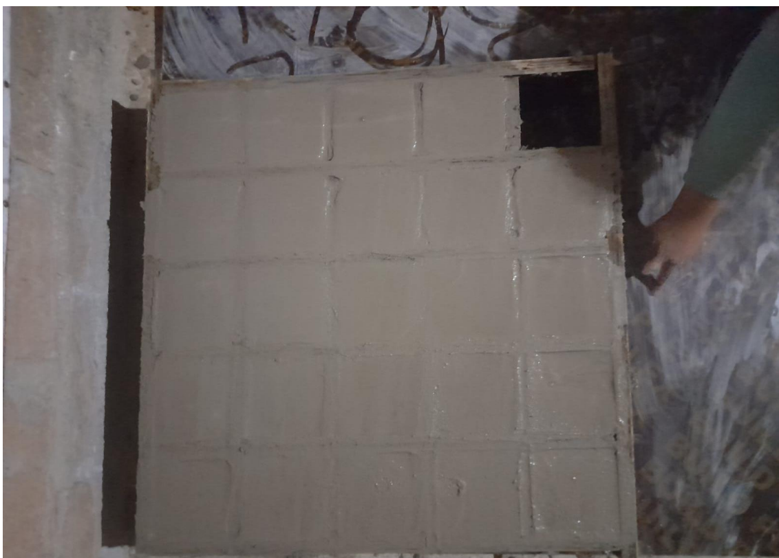
Fotografía 27 Cubos de mortero cemento: filler calizo que se han elaborado para someterlos al ensayo de compresión
