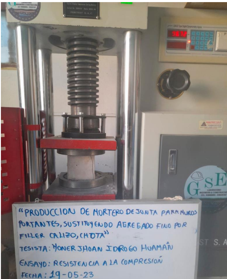
Fotografía 16 Ensayo de resistencia a la compresión en cubos de mortero cemento: arena a los 7, 14 y 28 días de curado
