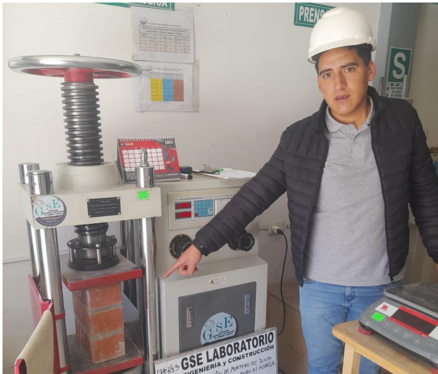
Fotografía 21 Ensayo de resistencia a la compresión axial en pilas de ladrillo asentados con mortero 1:3 cemento: arena
