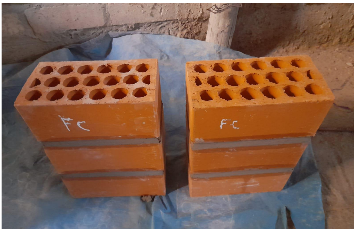
Fotografía 20 Construcción de pilas de ladrillo King Kong de 18 huecos asentado con mortero 1:3 cemento: arena
