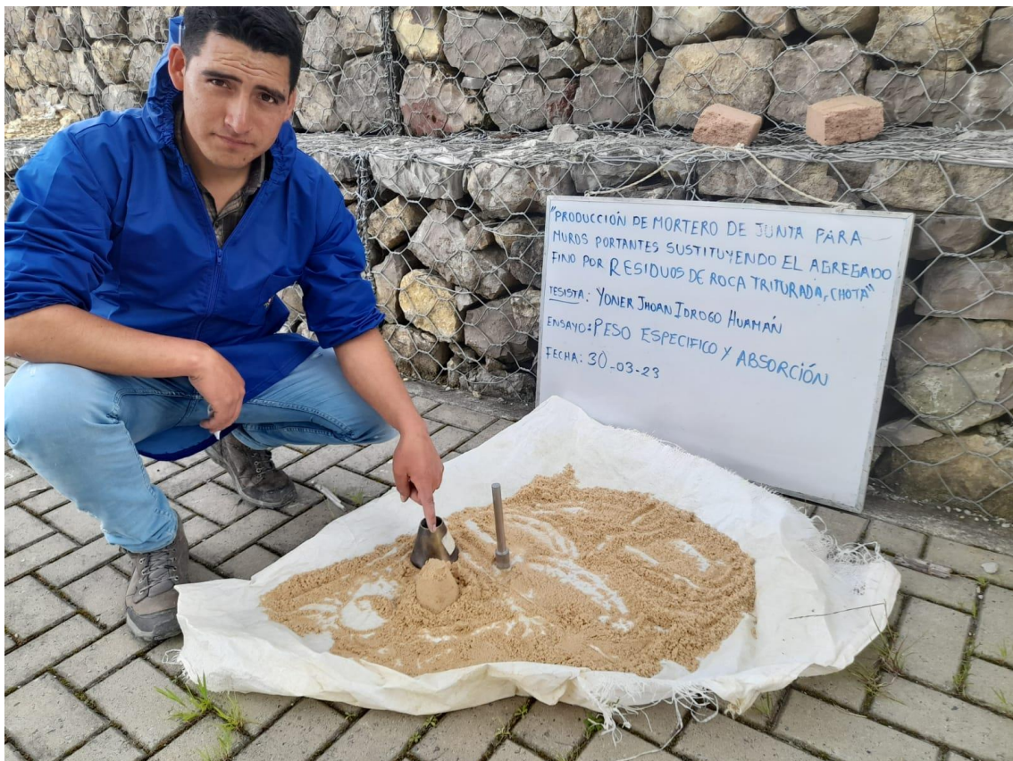
Fotografía 4 Verificación de la condición saturado superficialmente seco durante la realización del ensayo de peso específico de la arena
