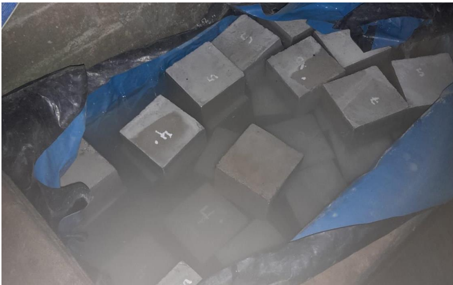
Fotografía 29 Ensayo de resistencia a la compresión en cubos de mortero cemento: filler calizo a los 7, 14 y 28 días
