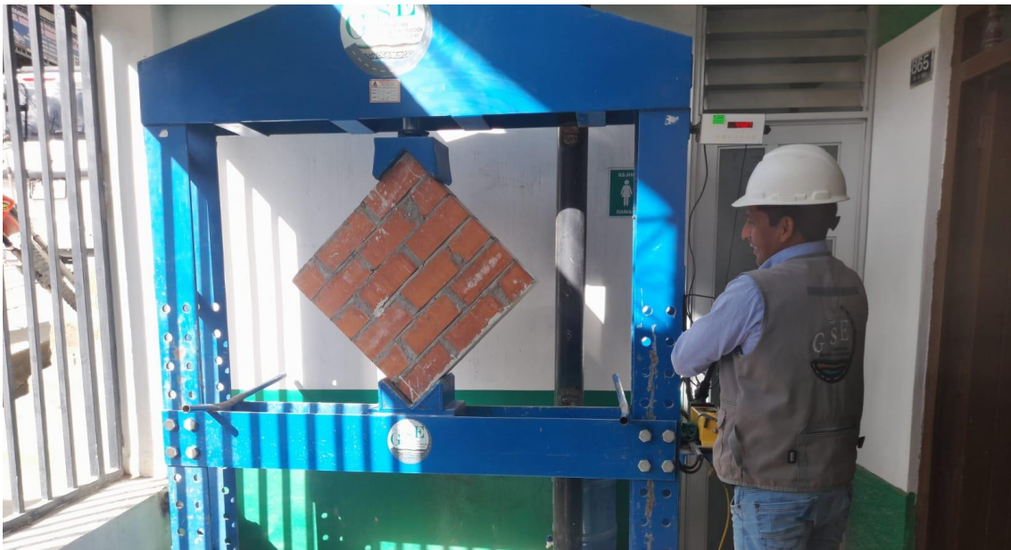
Fotografía 36 Rotura luego del ensayo de corte diagonal en muretes elaborados con ladrillo King Kong de 18 huecos asentados con mortero 1:4 de cemento: filler calizo
