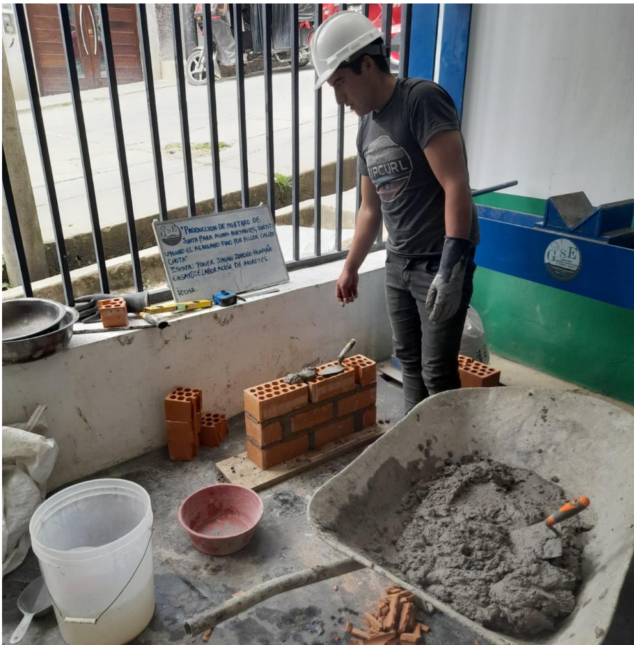
Fotografía 23 Muretes de ladrillo King Kong de 18 huecos asentados con mortero 1:3 cemento: arena
