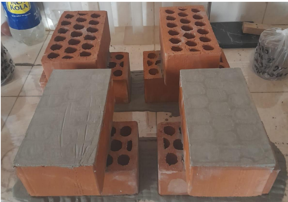
Fotografía 30 Proceso de elaboración y medición de los ladrillos cruzados unidos con mortero cemento: filler calizo
