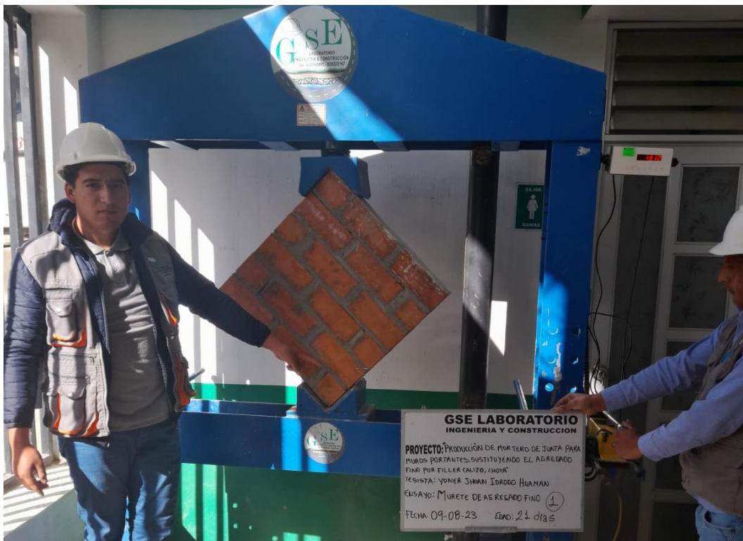
Fotografía 25 Rotura del murete luego del ensayo de corte diagonal en muretes de ladrillo King Kong de 18 huecos asentados con mortero 1:3 cemento: arena
