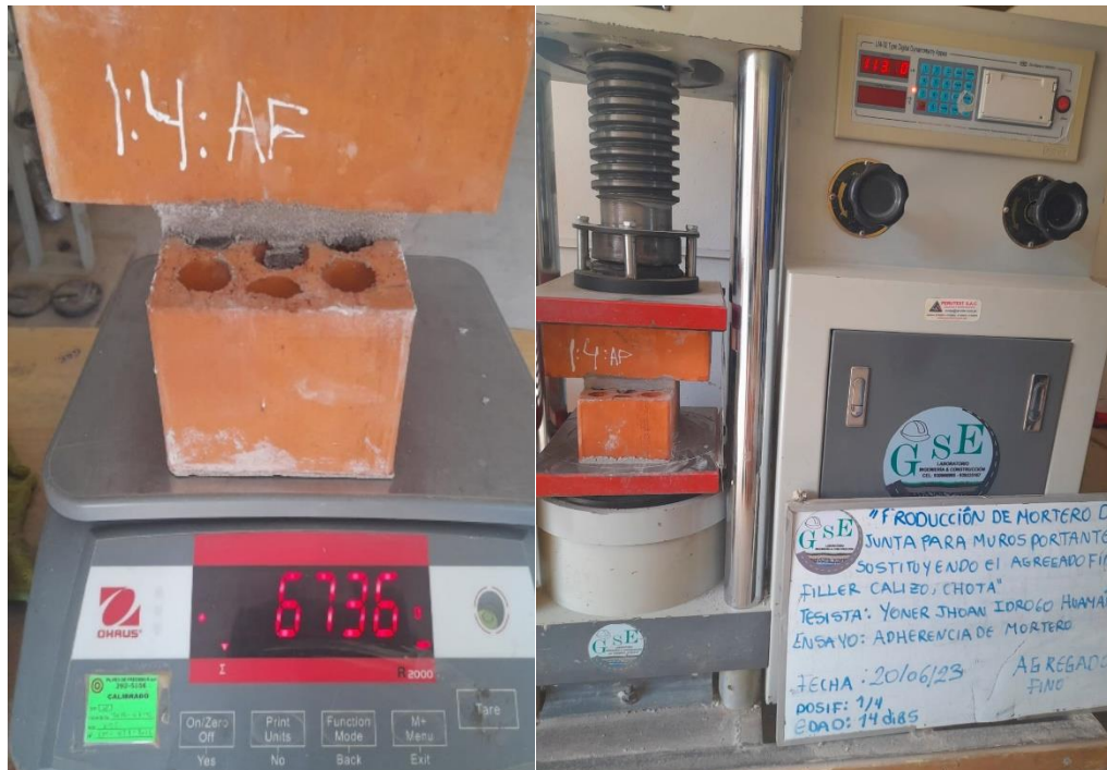
Figura 15 Espécimen de Ladrillos Cruzados Sometido a Ensayo de Adherencia
