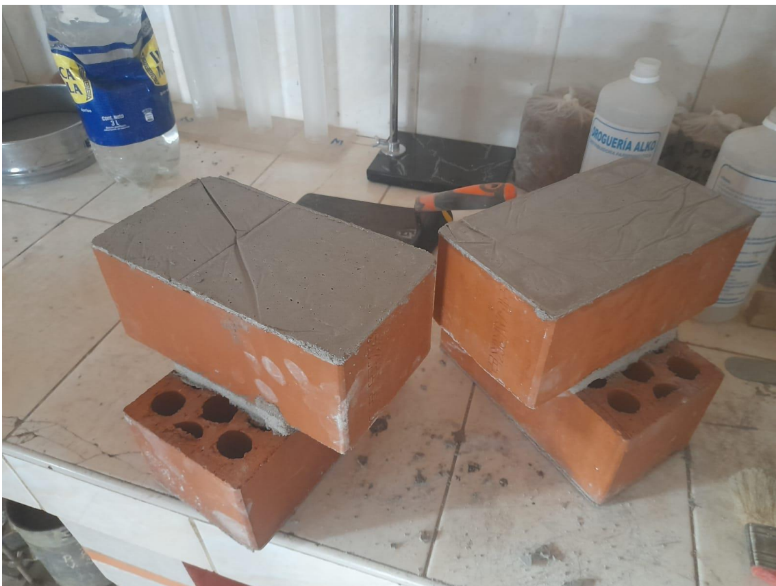
Fotografía 18 Refrentado de los cruces de ladrillos King Kong de 18 huecos asentados con mortero cemento: arena para el ensayo de adherencia por tracción directa
