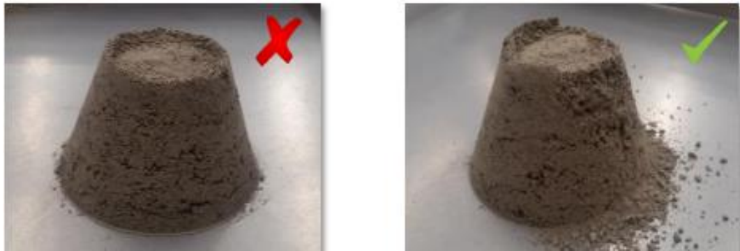
Figura 8 Condición SSS para árido, con poco o nada de material grueso
