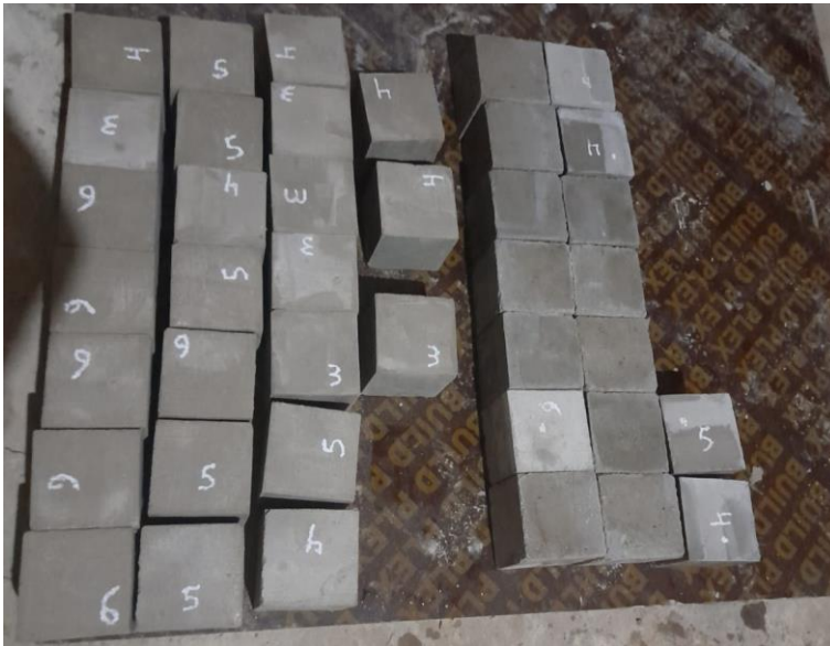
Fotografía 16 Ensayo de resistencia a la compresión en cubos de mortero cemento: arena a los 7, 14 y 28 días de curado
