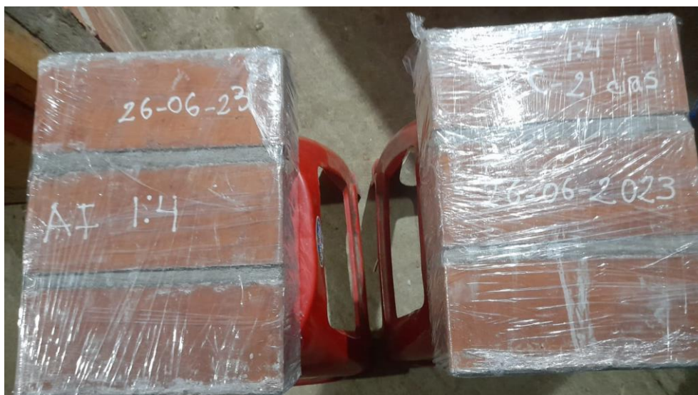
Fotografía 32 Embolsado de las pilas de ladrillo King Kong de 18 huecos asentados con mortero 1:4 de cemento: filler calizo
