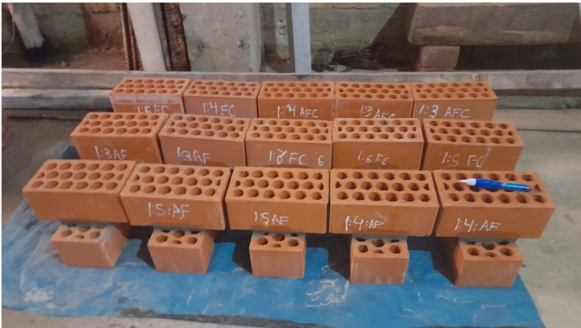
Fotografía 18 Refrentado de los cruces de ladrillos King Kong de 18 huecos asentados con mortero cemento: arena para el ensayo de adherencia por tracción directa
