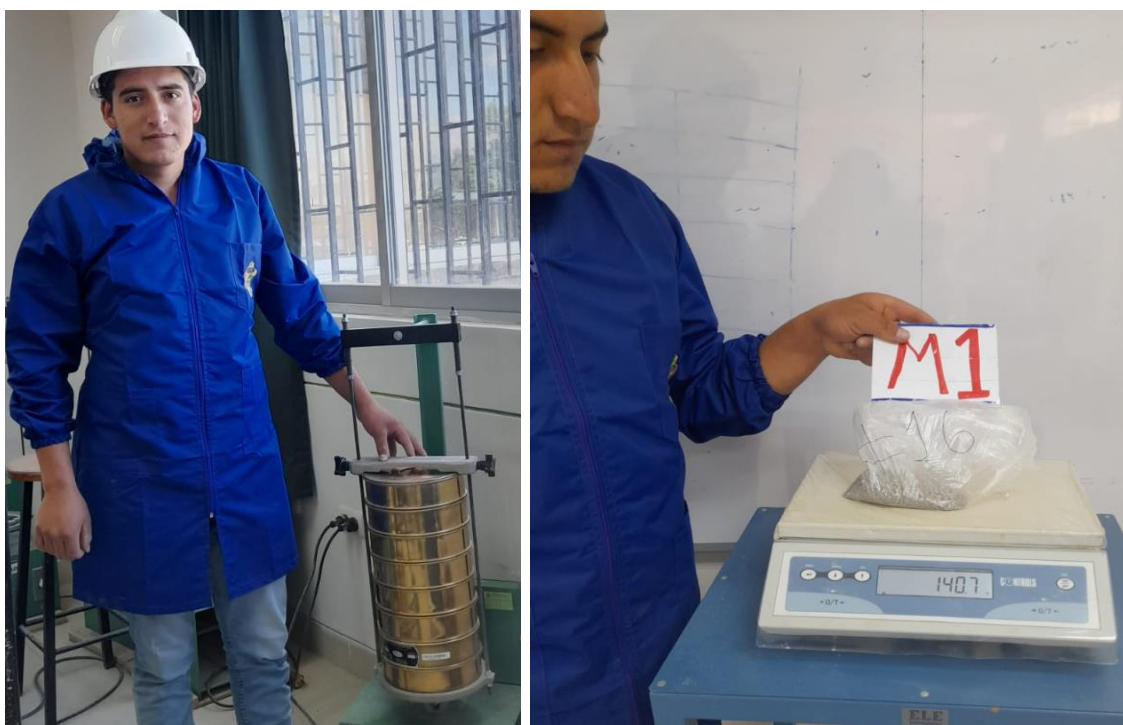
Fotografía 8 Paso del Filler Calizo por la serie de tamices para determinar el huso granulométrico y pesado de los porcentajes de material retenido en cada uno de los tamices
