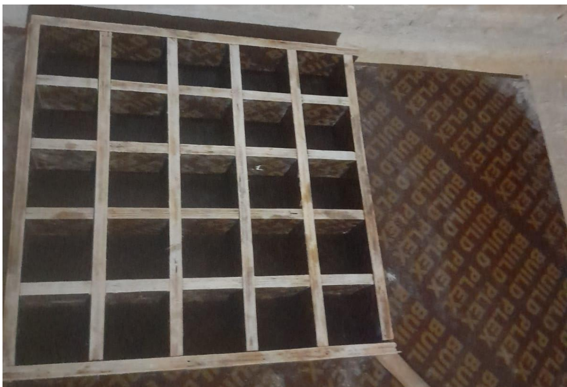
Fotografía 14 Producción de mortero cemento: arena elaborados con dosificaciones 1:3, 1:4, 1:5 y 1:6 para su curado a los 7, 14 y 28 días
