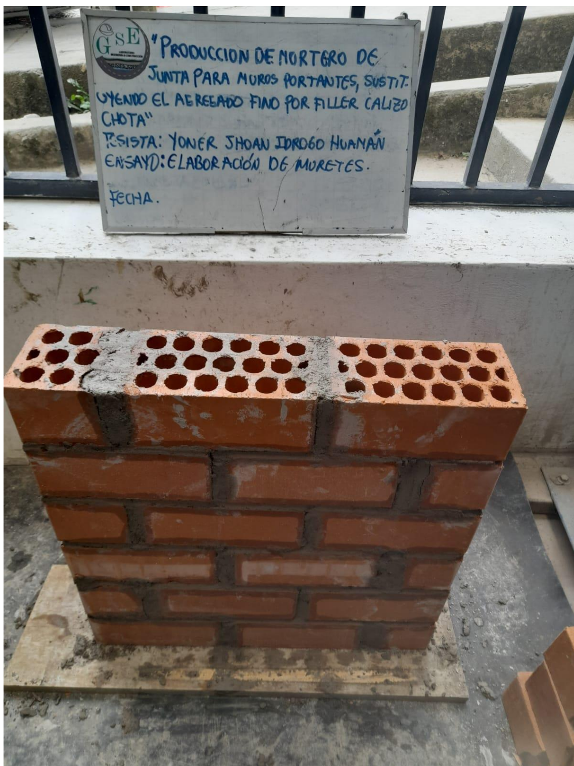
Fotografía 34 Muretes elaborados con ladrillo King Kong de 18 huecos asentados con mortero 1:4 de cemento: filler calizo
