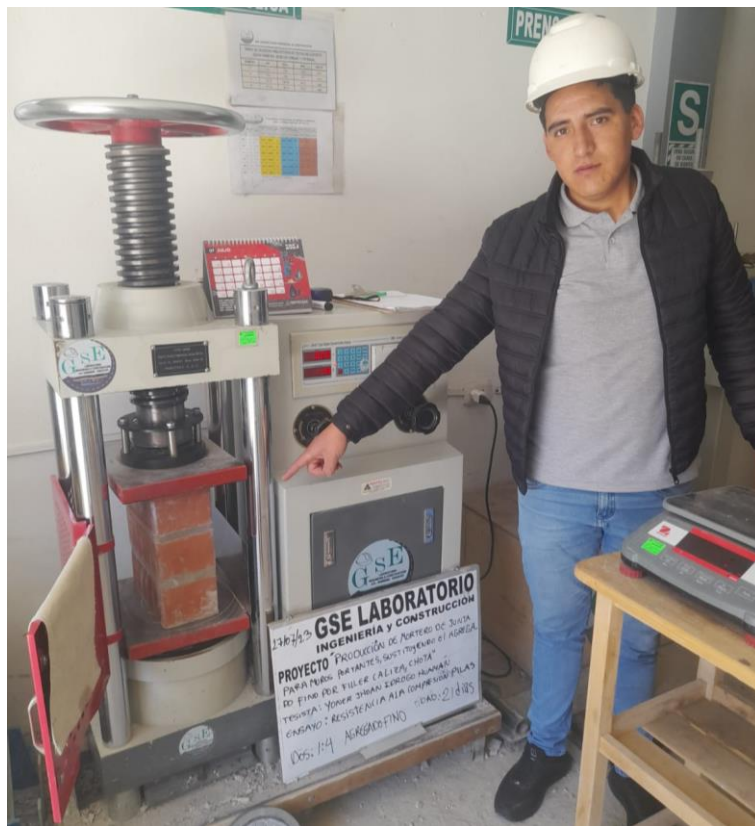
Figura 18 Ensayo en Muretes de Albañilería Asentados con Mortero Cemento:
