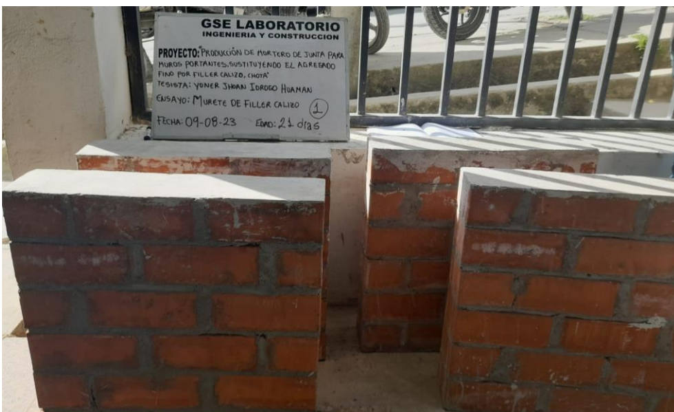
Fotografía 23 Muretes de ladrillo King Kong de 18 huecos asentados con mortero 1:3 cemento: arena
