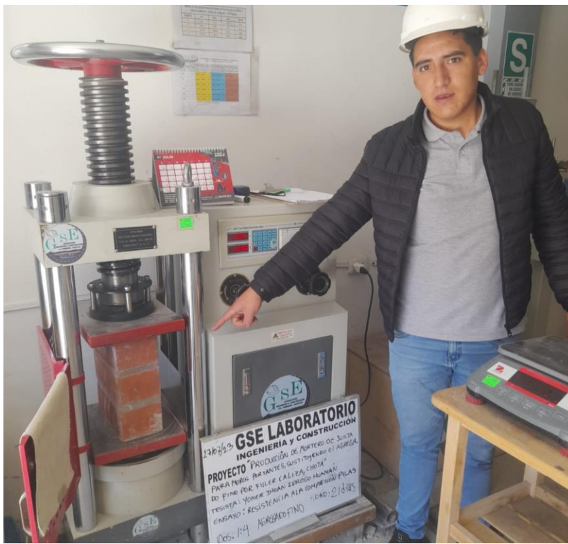
Fotografía 33 Ensayo de resistencia a compresión axial en pilas de ladrillo asentados con mortero 1:4 de cemento: filler calizo
