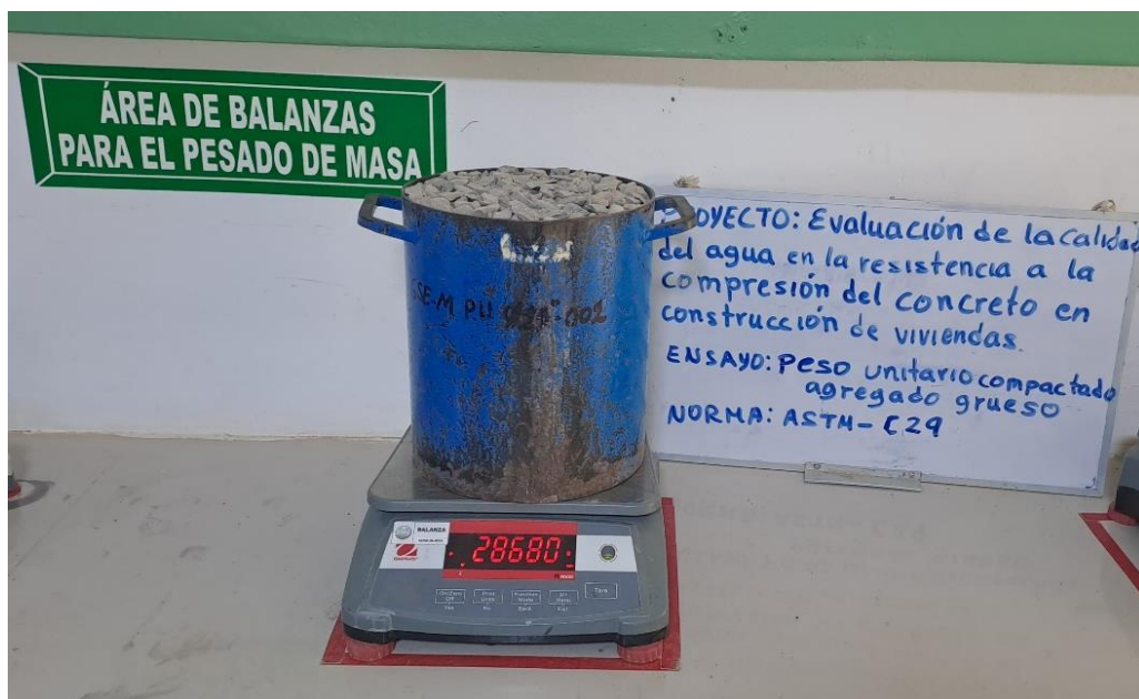
Peso unitario compactado agregado grueso
