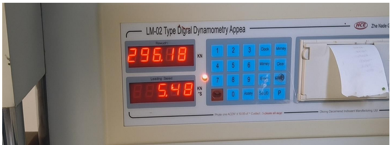
Análisis de resistencia a la compresión del concreto M-01, Campamento a los 7 días
