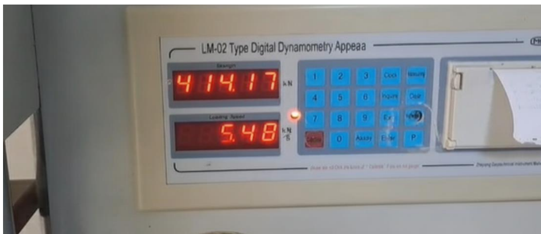
Análisis de resistencia a la compresión del concreto M-06, La Iraca a los 14 días
