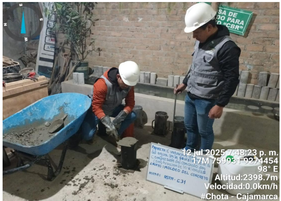
Elaboración de probetas con agua de Chota Ciudad
