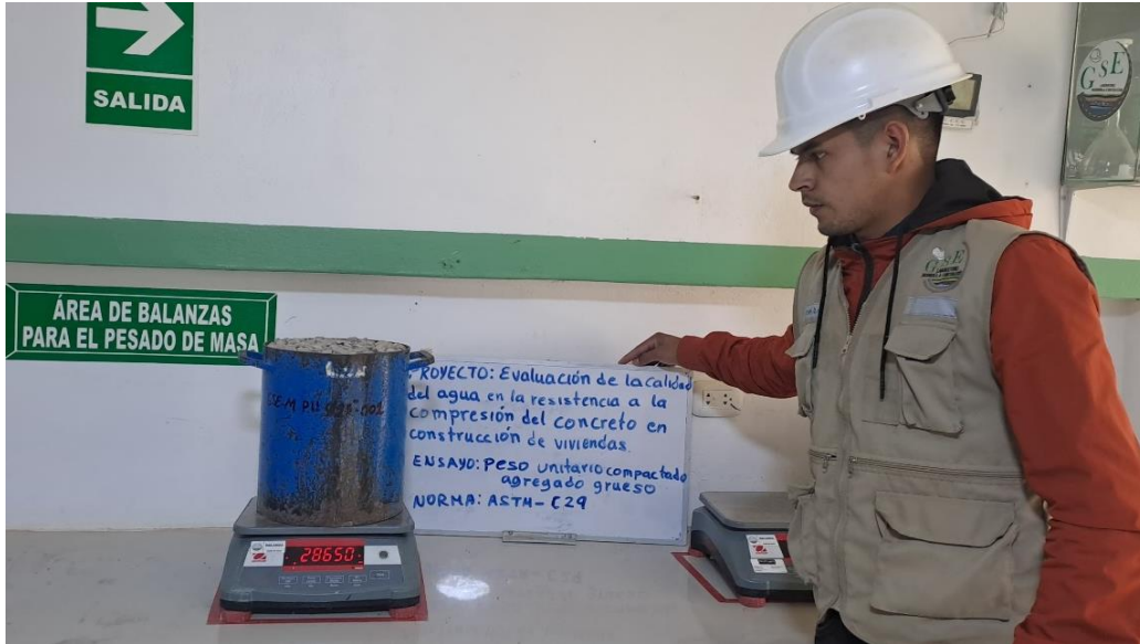
Peso unitario compactado agregado grueso
