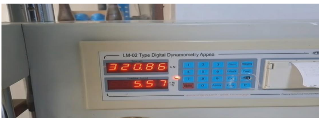
Análisis de resistencia a la compresión del concreto M-09, La Iraca a los 28 días
