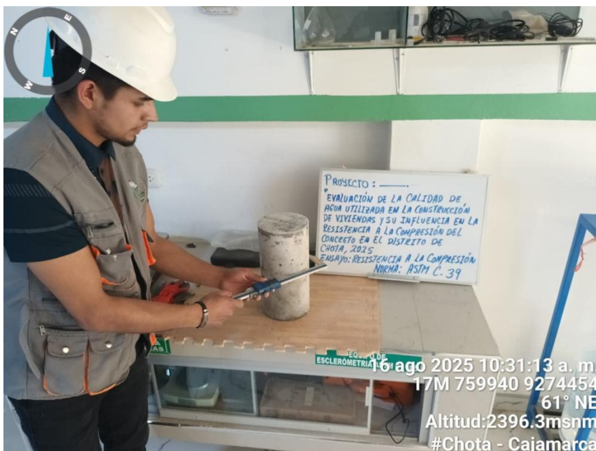
Medición de probetas con vernier
