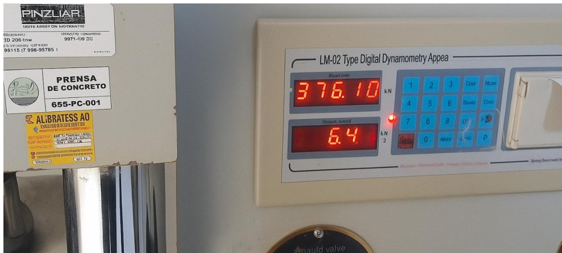
Análisis de resistencia a la compresión del concreto M-09, Campamento a los 28 días
