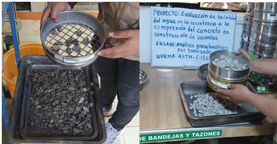
Tamizado del agregado grueso
