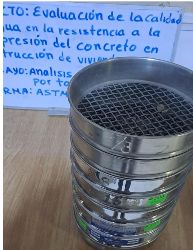
Análisis granulométrico por tamizado
