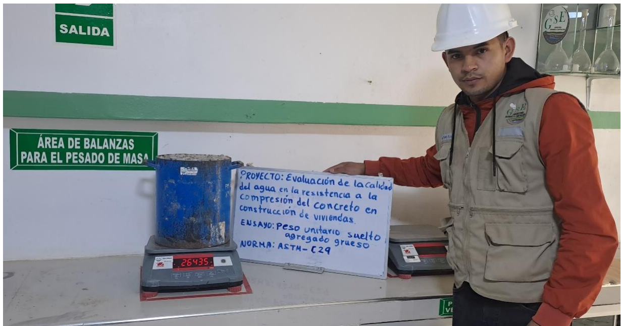
Peso unitario suelto agregado grueso
