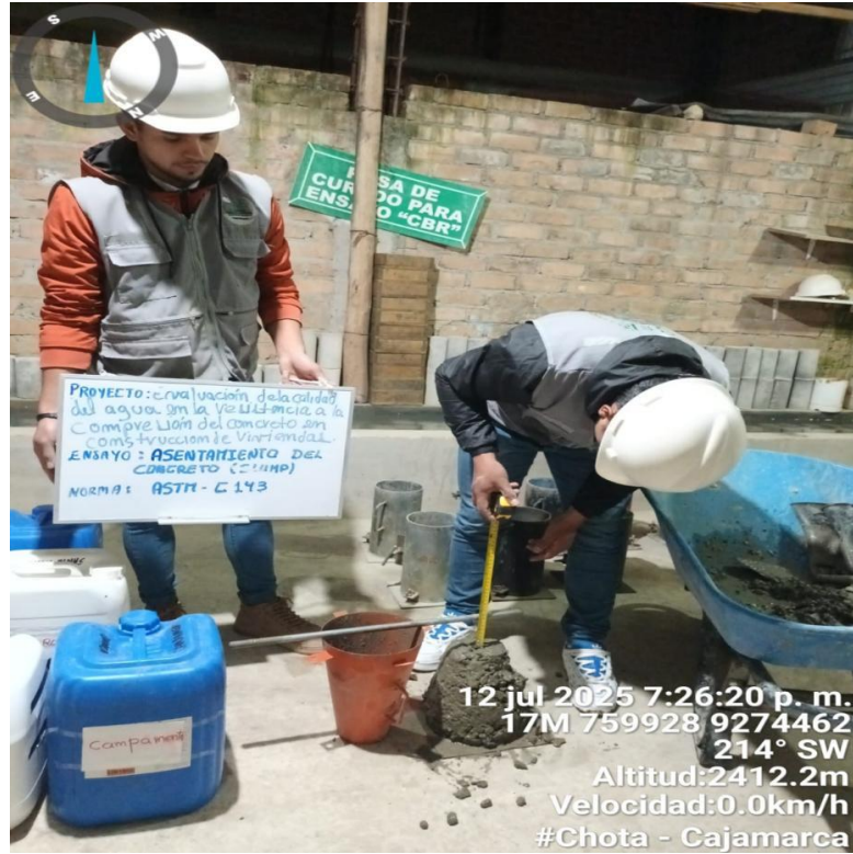
Prueba de slump
