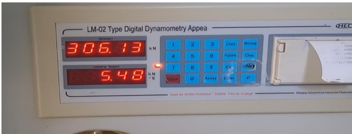
Análisis de resistencia a la compresión del concreto M-03, Pingobamba a los 7 días
