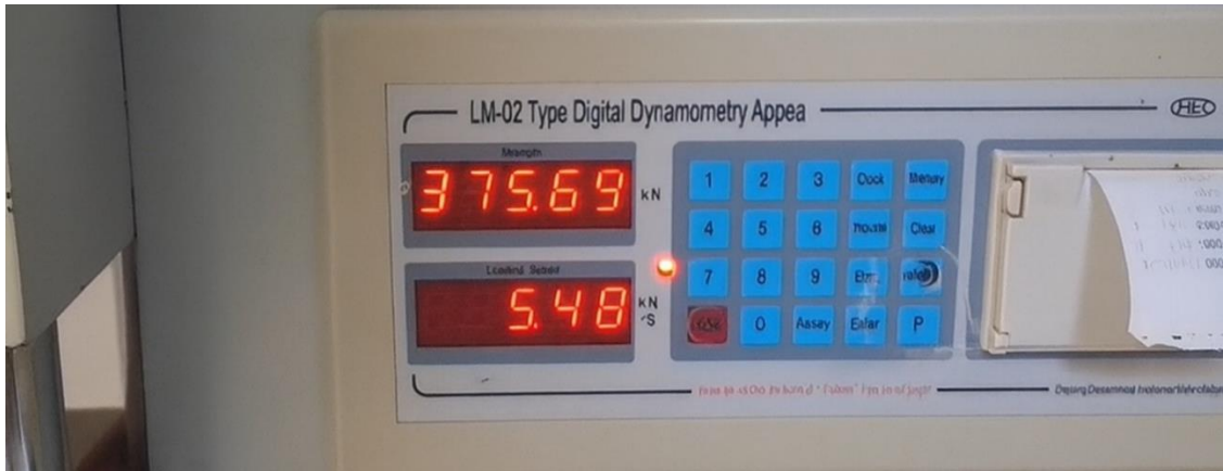
Análisis de resistencia a la compresión del concreto M-04, Pingobamba a los 14 días
