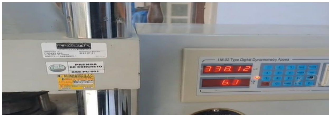
Análisis de resistencia a la compresión del concreto M-05, Chim Chim a los 14 días
