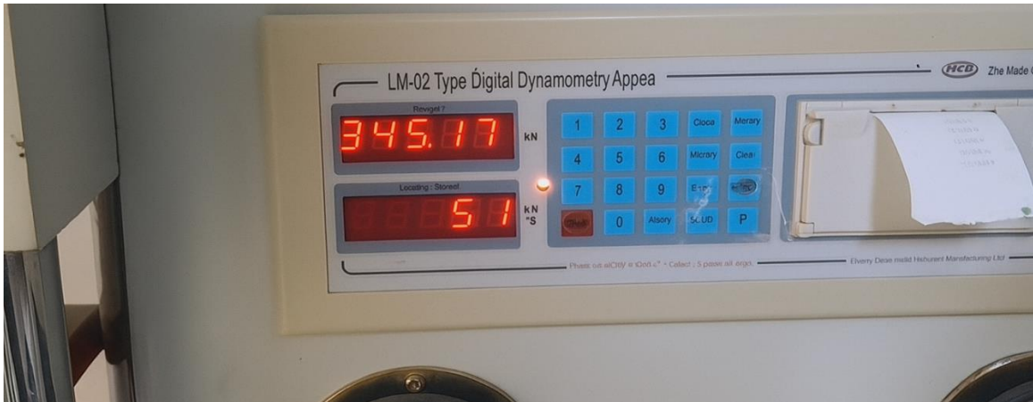
Análisis de resistencia a la compresión del concreto M-04, Campamento a los 14 días
