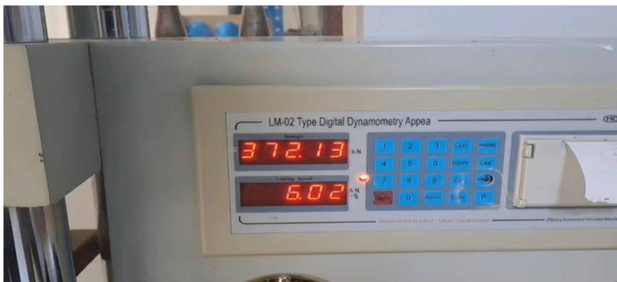
Análisis de resistencia a la compresión del concreto M-09, Chota - Ciudad a los 28 días
