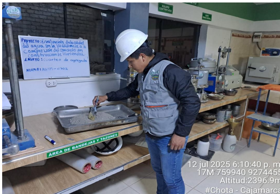
Análisis granulométrico de material de cantera
