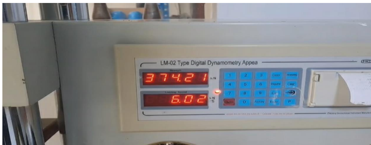
Análisis de resistencia a la compresión del concreto M-09, Chim Chim a los 28 días
