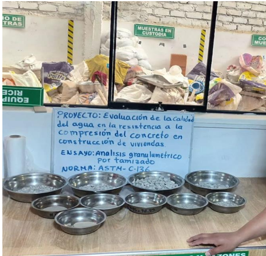
Análisis granulométrico por tamizado
