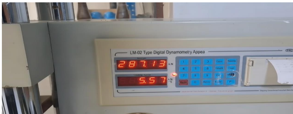
Análisis de resistencia a la compresión del concreto M-03, Chota - Ciudad a los 7 días
