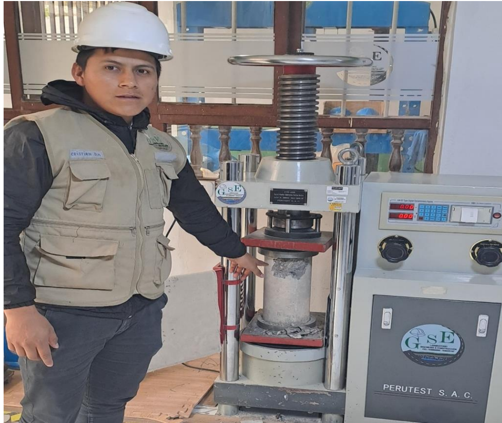
Ensayo de resistencia a la compresión
