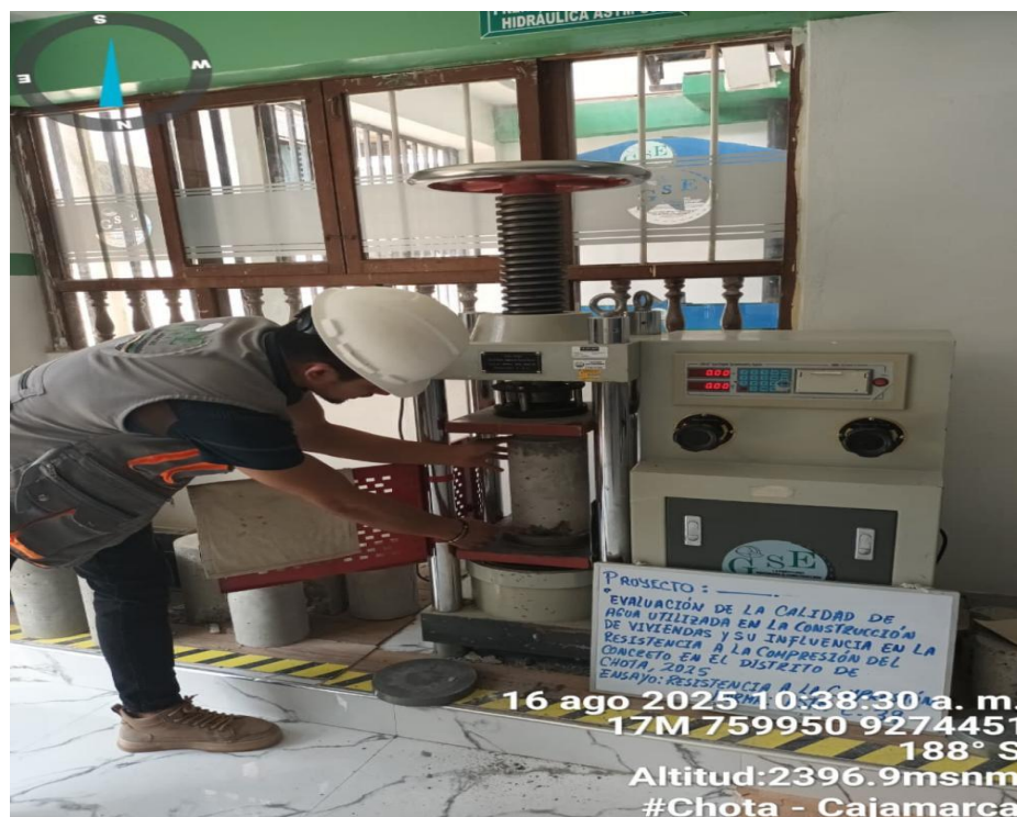
Ensayo de resistencia a la compresión
