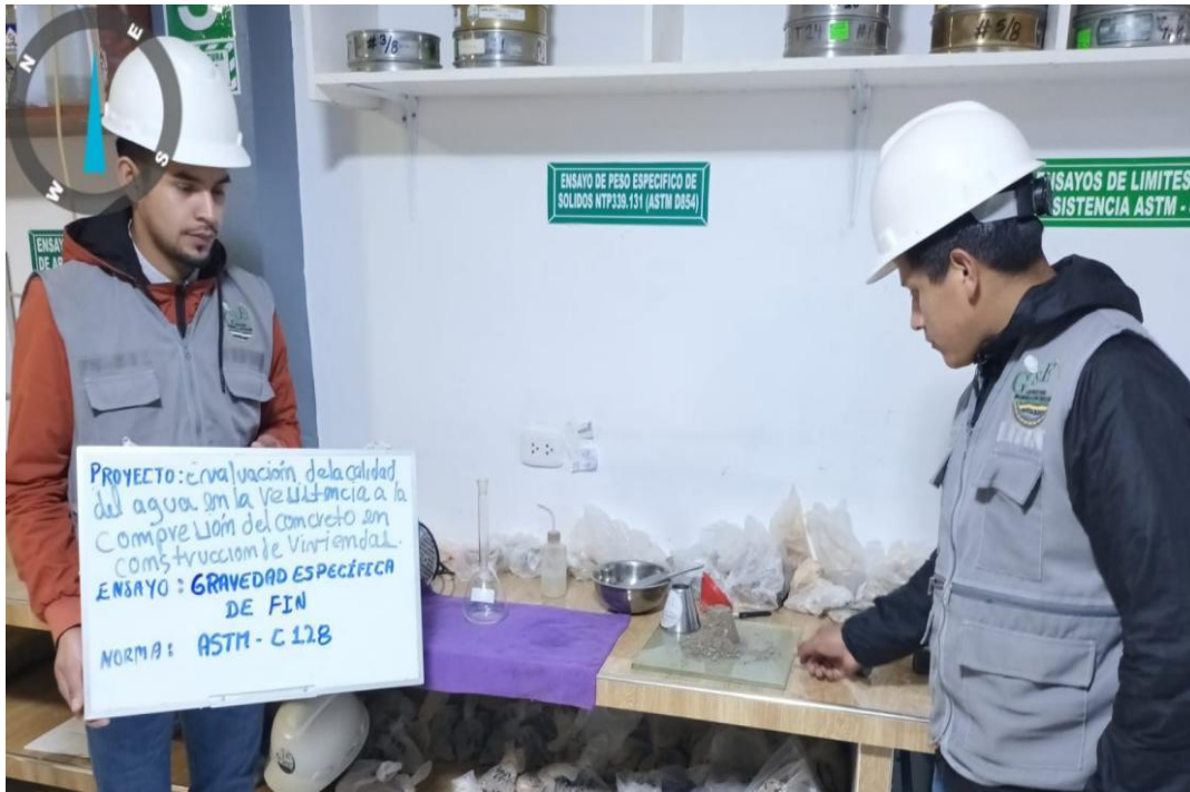
Prueba de gravedad específica - material de cantera
