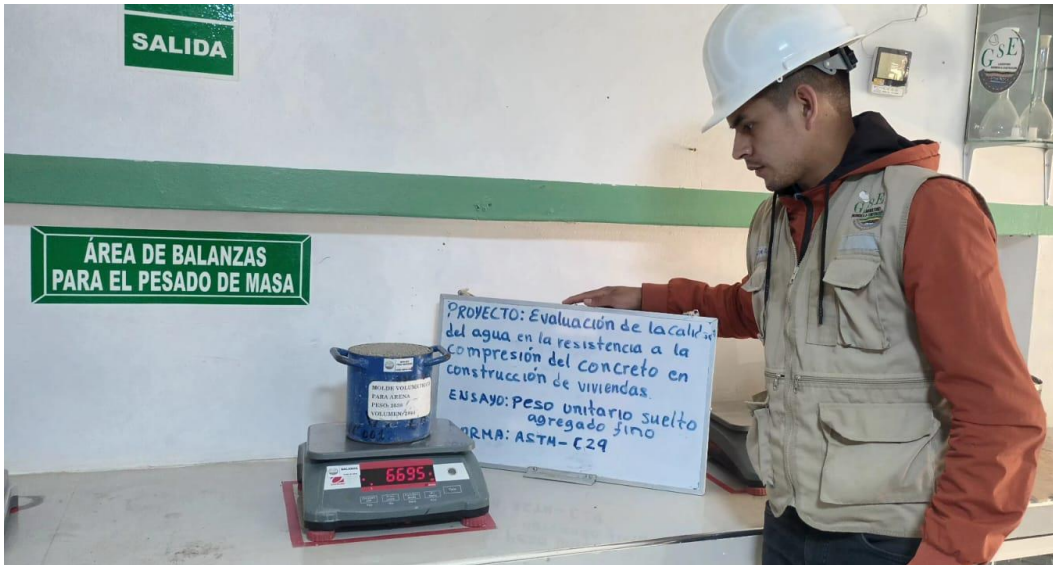
Peso unitario suelto agregado fino
