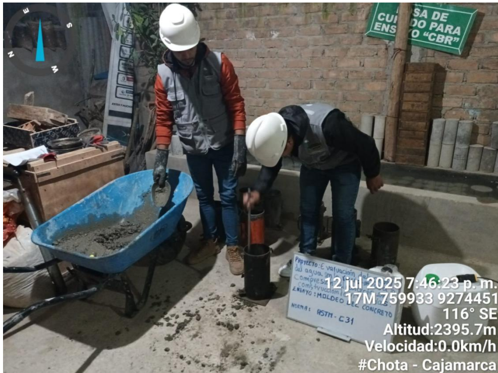
Elaboración de probetas con agua de Chim Chim
