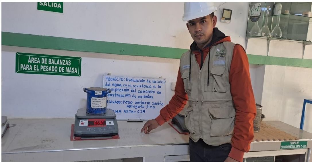
Peso unitario suelto agregado fino
