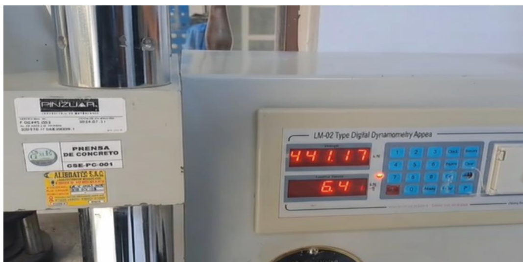
Análisis de resistencia a la compresión del concreto M-09, La Iraca a los 28 días
