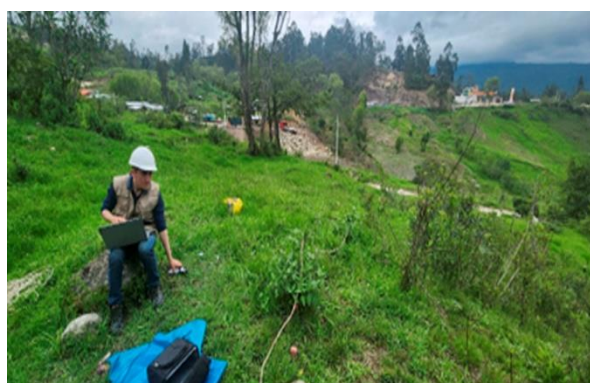
Fotografía N.º 45. Vista de la línea sísmica correspondiente al ensayo LRS-11 y MASW-11.
