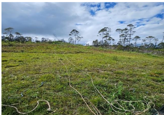
Fotografía N.º 24. Vista de la línea sísmica correspondiente al ensayo LRS-01 y MASW-01.
