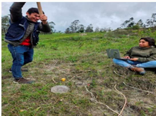
Fotografía N.º 29. Líneas sísmicas correspondiente al ensayo LRS-04, MASW y MASW-2D 01.
