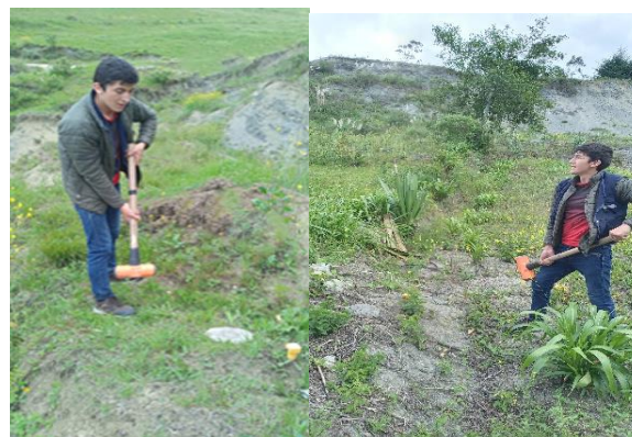
Fotografías N.º 30 y 31. Vista de la línea sísmica correspondiente al ensayo LRS-04, MASW-04 y MASW-2D 01.
