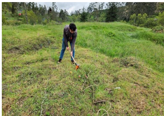
Fotografía N.º 40. Línea sísmica correspondiente al ensayo LRS-09 y MASW-09.
