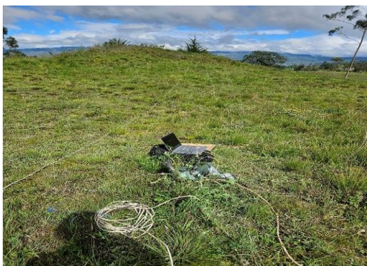
Fotografía N.º 23. Líneas sísmicas correspondiente al ensayo LRS-01 y MASW-01.
