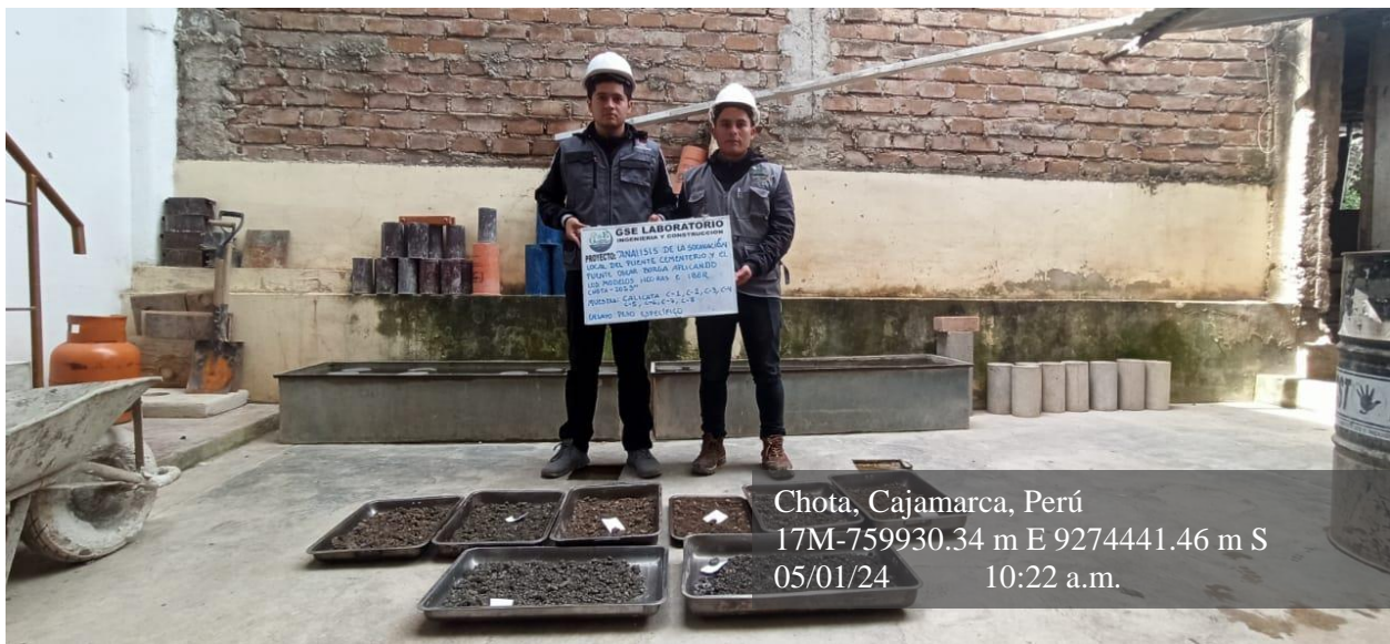
Fotografía 16: Toma de muestras para ensayo de peso específico de cada calicata
