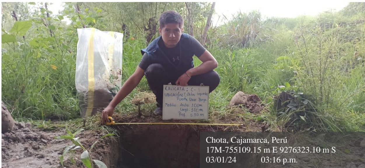
Fotografía 8: Calicata 1 ubicada en estribo izquierdo del puente Oscar Burga
