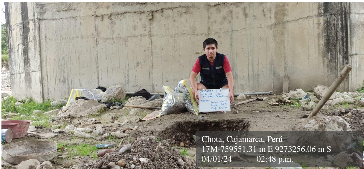
Fotografía 12: Calicata 5 ubicada en el pilar central del puente Cementerio
