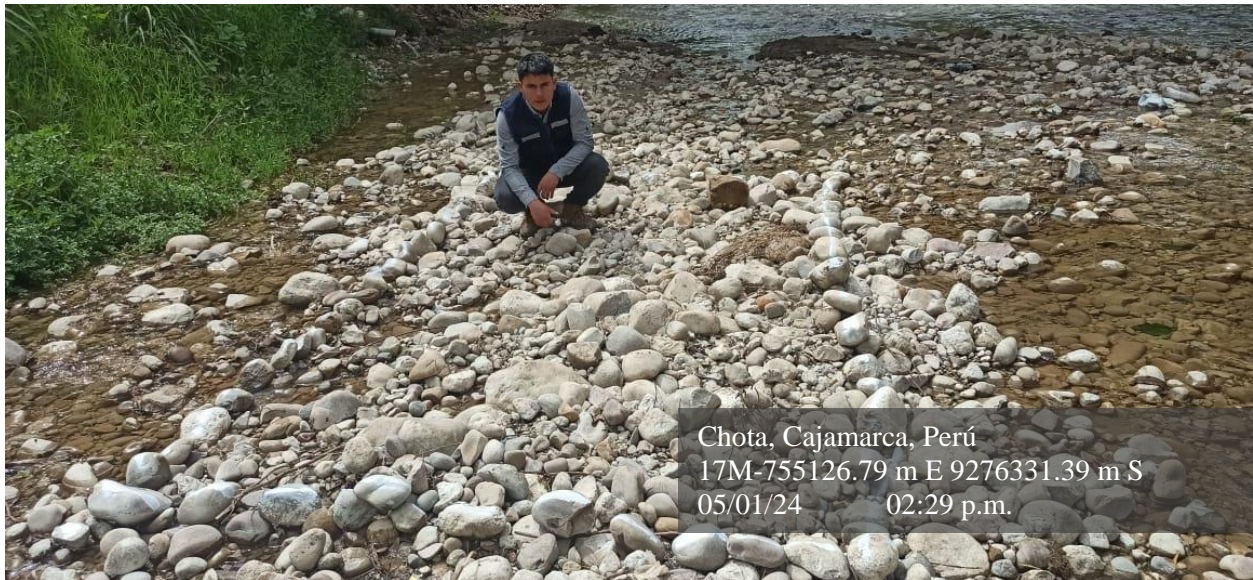
Fotografía 21: Trazado de área para el análisis de partículas superiores a 3” aguas arriba del puente
