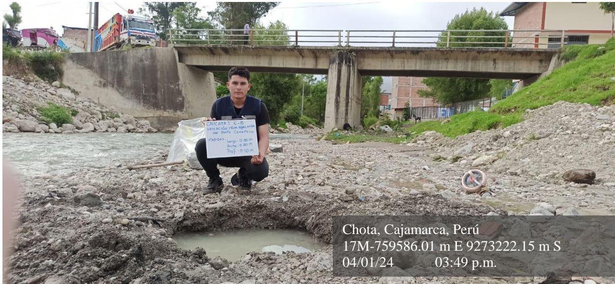
Fotografía 16: Toma de muestras para ensayo de peso específico de cada calicata
