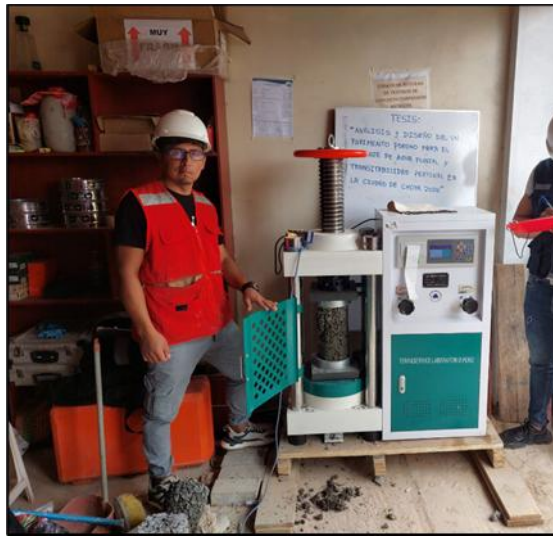
Fotografía 51. Ensayo de compresión de especímenes de concreto poroso a los 28 días
