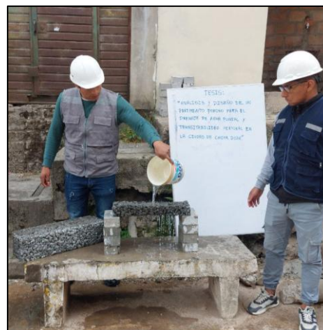
Fotografía 54. Prueba de simulación de lluvia en especímenes de concreto poroso
