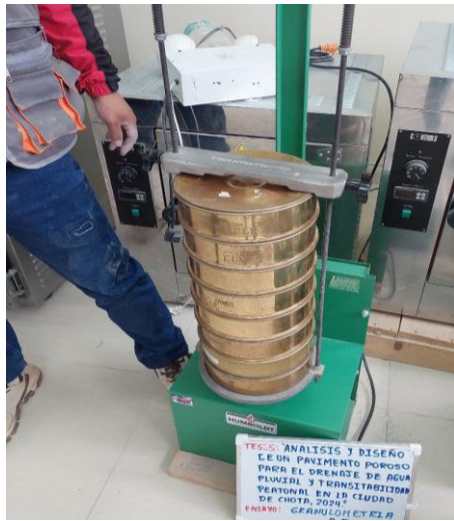
Fotografía 27. Determinamos el peso de la muestra retenida en cada tamiz
