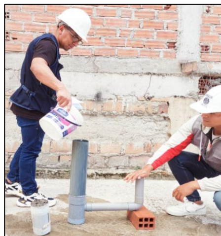
Fotografía 53. Pruebas de permeabilidad de especímenes de concreto poroso
