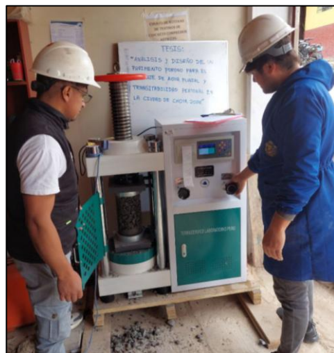
Fotografía 53. Pruebas de permeabilidad de especímenes de concreto poroso
