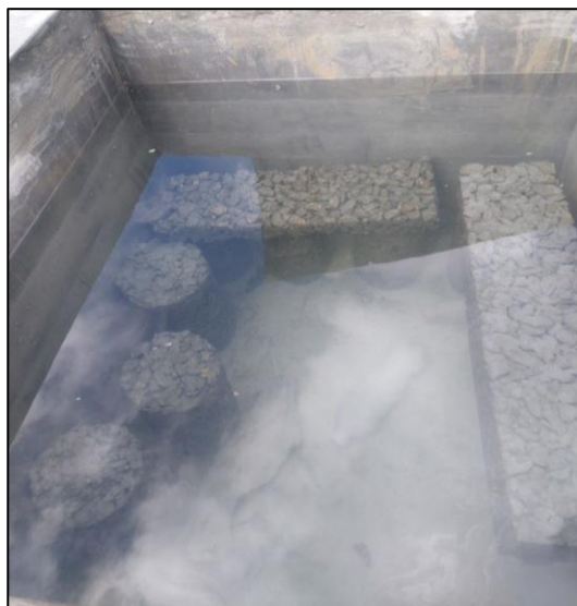
Fotografía 47. Curado de especímenes de concreto poroso
