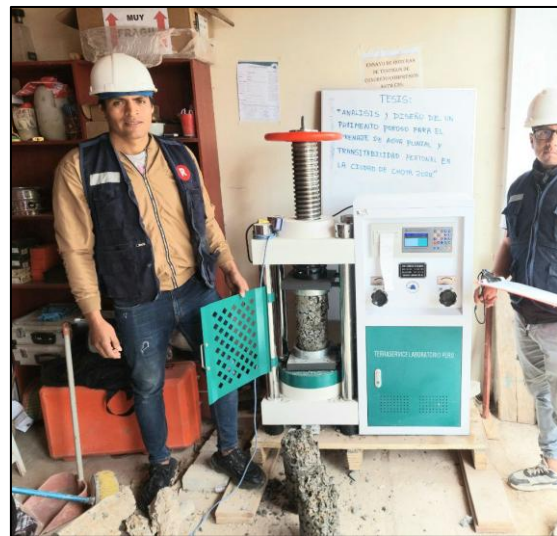
Fotografía 52. Ensayo de flexión de especímenes de concreto poroso
