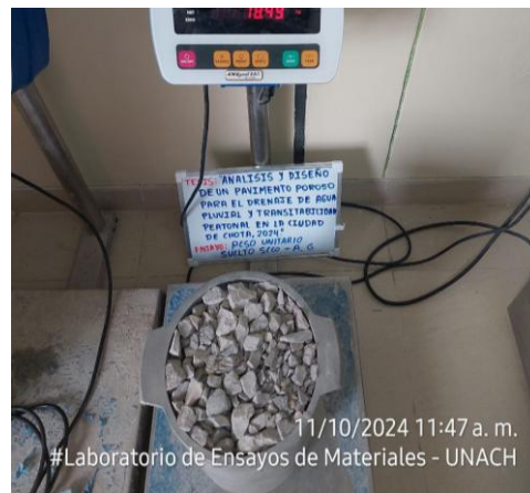
Fotografía 34. Llenamos la tercera parte del recipiente con el agregado, y emparejar la superficie con los dedos. Apisonar la capa de agregado con 25 golpes de la varilla distribuidos uniformemente
