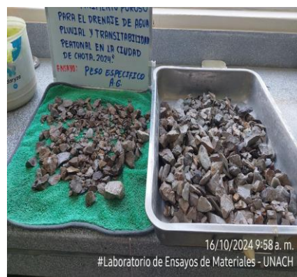
Fotografía 36. Remover la muestra del agua y hacerla rodar sobre un paño grande y absorbente, hasta hacer desaparecer toda película de agua visible
