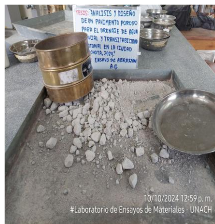
Fotografía 30. Colocar la muestra de ensayo y la carga en la máquina de Los Ángeles, luego descargar el material de la máquina
