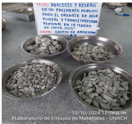
Fotografía 29. Muestra total de 5 kg del peso retenido en las mallas de 1", 3/4", 1/2" y 3/8".
