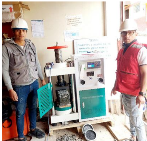
Fotografía 52. Ensayo de flexión de especímenes de concreto poroso
