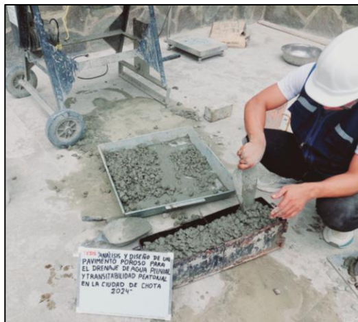
Fotografía 43. Elaboración de los diseños de mezcla del concreto poroso
