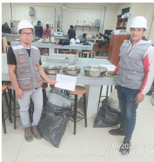
Fotografía 11. Preparación en seco de las muestras de cada estrato tal como se reciben del campo
