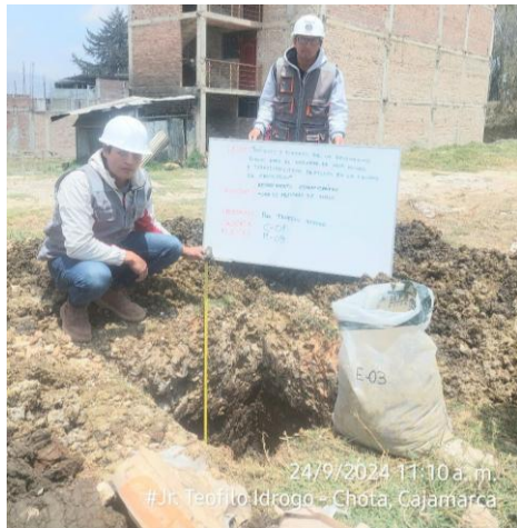
Fotografía 9. Toma de medida de diámetro y profundidad del hoyo
