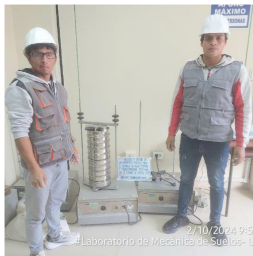
Fotografía 12. Proceso en tamizadora mecánica por un tiempo de diez minutos
