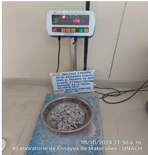
Fotografía 29. Muestra total de 5 kg del peso retenido en las mallas de 1", 3/4", 1/2" y 3/8".
