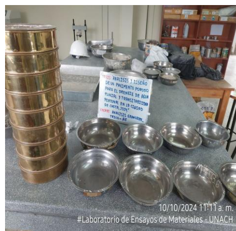
Fotografía 24. Seleccionamos la serie de tamices de tamaños adecuados para cumplir con las especificaciones del material a ensayar.
