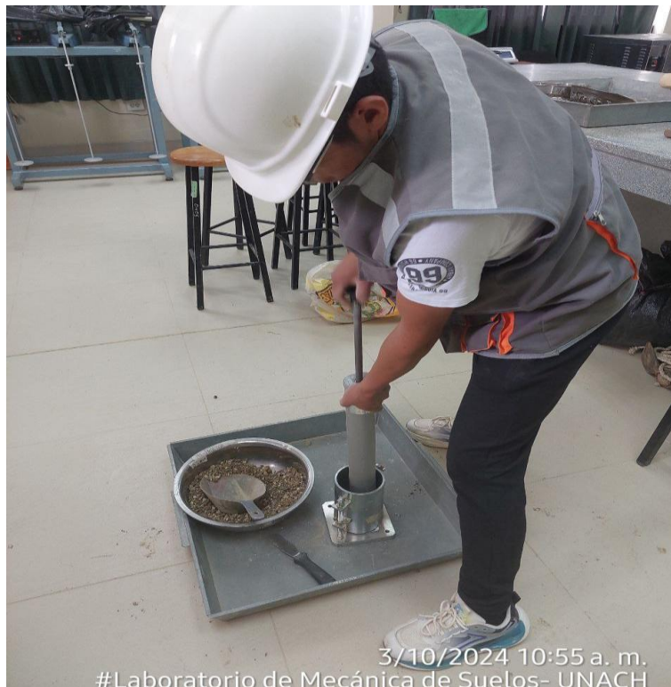
Ensayo de Proctor modificado del suelo
