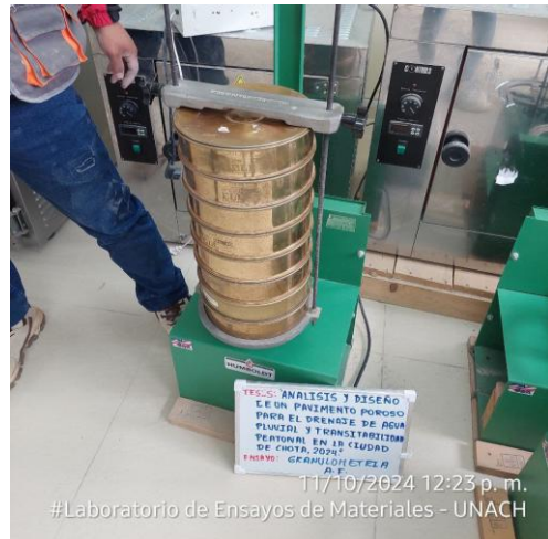
Fotografía 28. Efectuamos el tamizado mecánico, durante un período adecuado.
