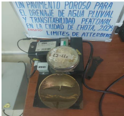
Fotografía 17. Se toman aproximadamente 20 g de la muestra que pase por el tamiz de 426 mm (N° 40) y se amasa con agua destilada
