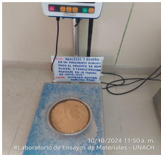
Fotografía 41. Seleccionamos la muestra para el ensayo y tomamos el peso respectivo
