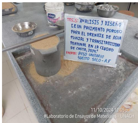
Fotografía 33. Llenamos el recipiente con una cuchara, que descarga el agregado desde una altura no mayor de 50 mm (2"); luego eliminar el agregado sobrante con una regla
