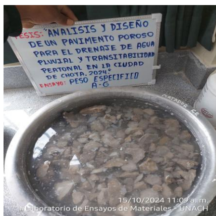
Fotografía 35. Inmediatamente sumergir el agregado en agua a una temperatura ambiente por un período de 24 h
