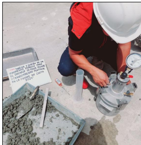
Fotografía 48. Contenido de vacíos concreto poroso
