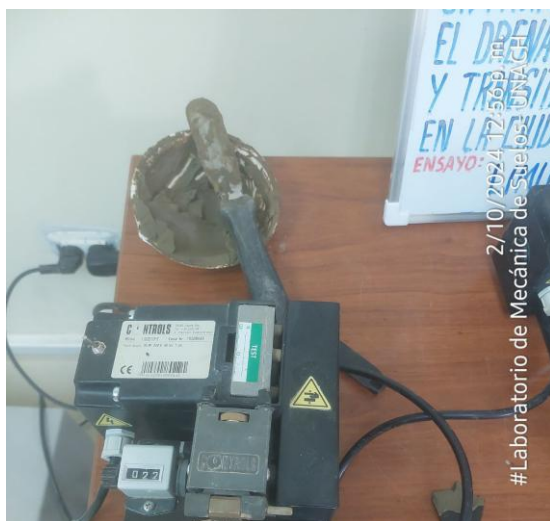
Fotografía 17. Se toman aproximadamente 20 g de la muestra que pase por el tamiz de 426 mm (N° 40) y se amasa con agua destilada
