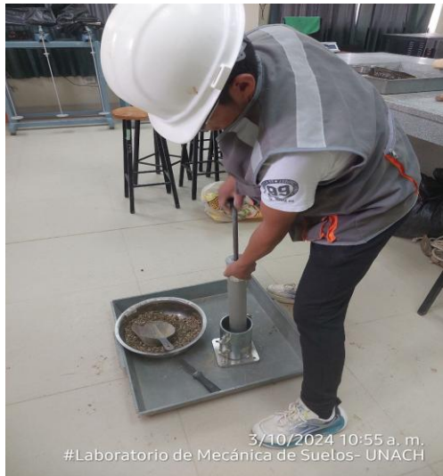
Fotografía 21. Obtenemos una porción de muestra, cortando axialmente por el centro del espécimen compactado para determinar el contenido de agua
