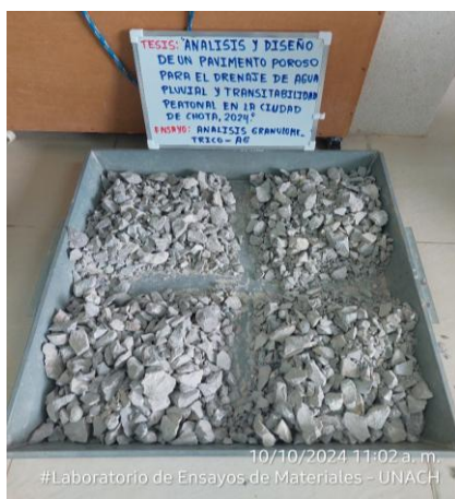
Fotografía 23. Mezclado de la muestra y seleccionamos una parte para el ensayo, por cuarteo manual
