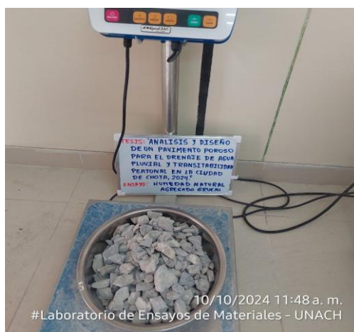
Fotografía 41. Seleccionamos la muestra para el ensayo y tomamos el peso respectivo
