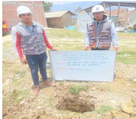
Fotografía 10. Control con el cronometro la descendencia del agua en un intervalo de tiempo
