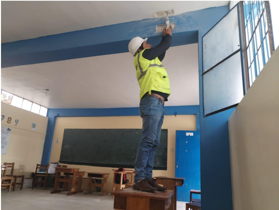
Fotografía 9: Realización del ensayo de esclerometría en las columnas y vigas de los módulos de la I.E.S. Comercio
