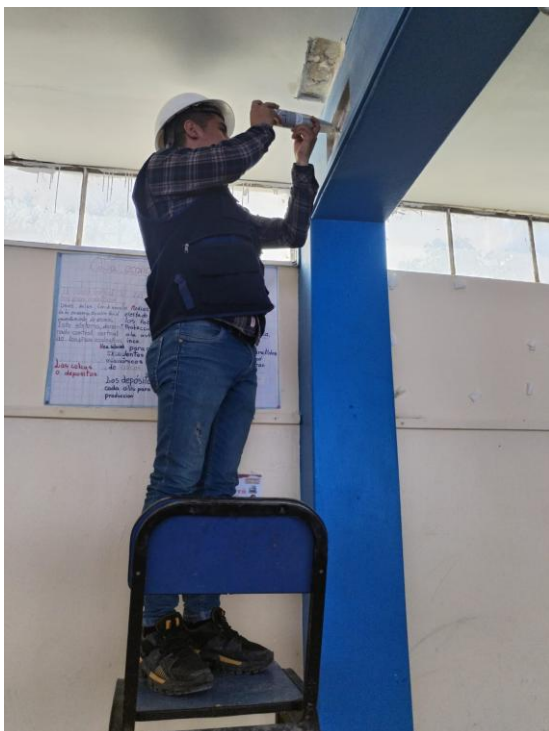
Fotografía 9: Realización del ensayo de esclerometría en las columnas y vigas de los módulos de la I.E.S. Comercio
