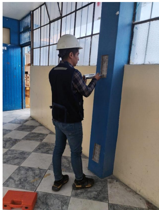
Fotografía 9: Realización del ensayo de esclerometría en las columnas y vigas de los módulos de la I.E.S. Comercio
