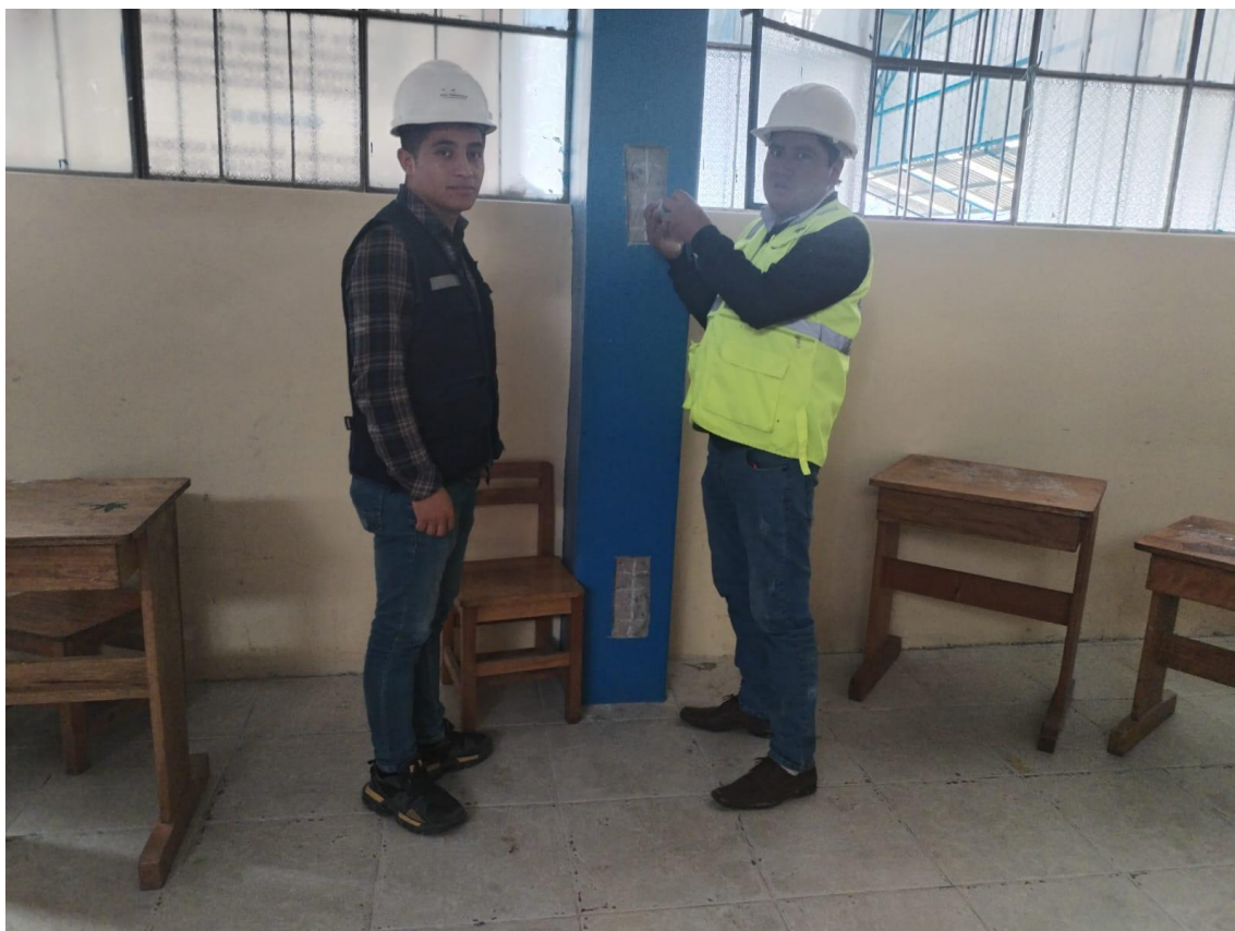
Fotografía 7: Realización del ensayo de esclerometría en la I.E.S. Comercio
