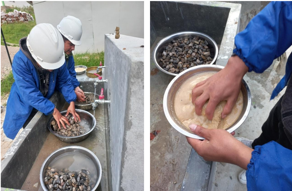
Fotografía 16. Tamizado para el análisis granulométrico
