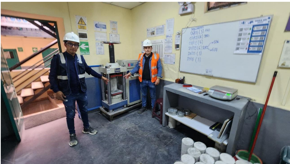
Fotografía 38. Ensayo de resistencia a compresión de probetas a los 28 días
