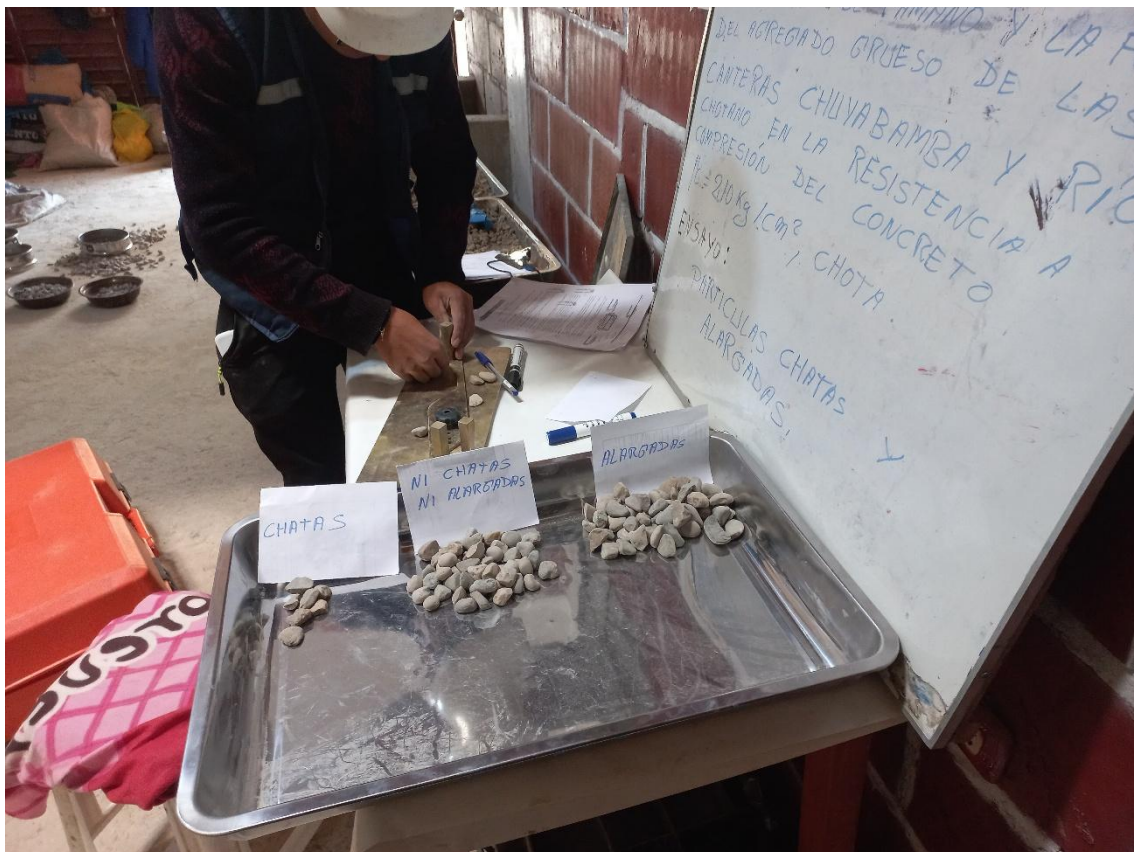
Fotografía 24. Separación de partículas chatas, alargadas y ni chatas ni alargadas en el agregado grueso
