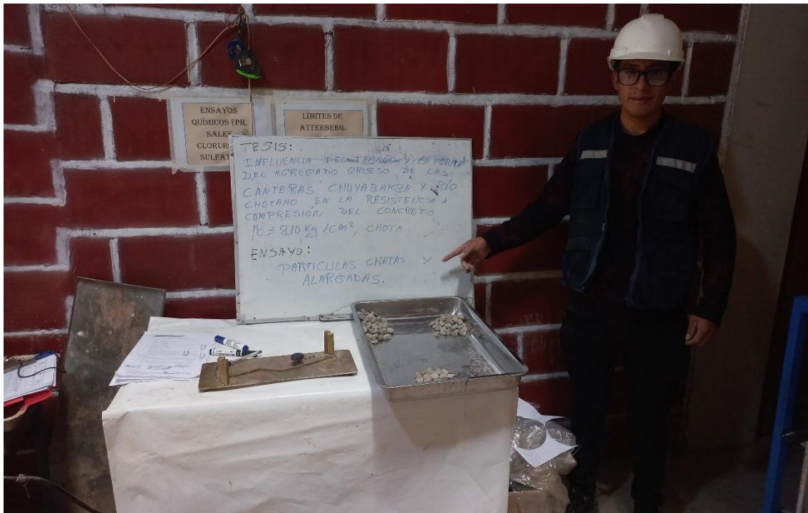
Fotografía 24. Separación de partículas chatas, alargadas y ni chatas ni alargadas en el agregado grueso
