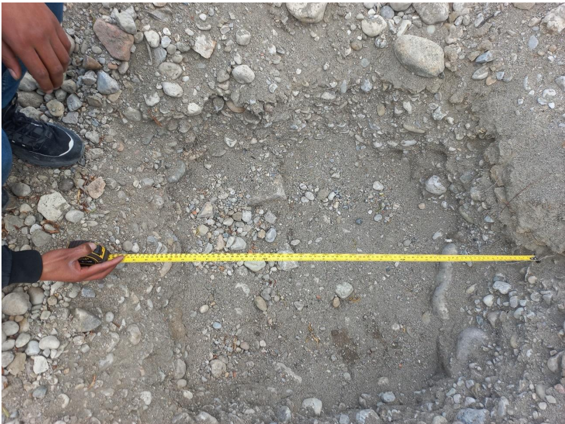
Fotografía 8. Calicata realizada en la cantera para extracción de muestras
