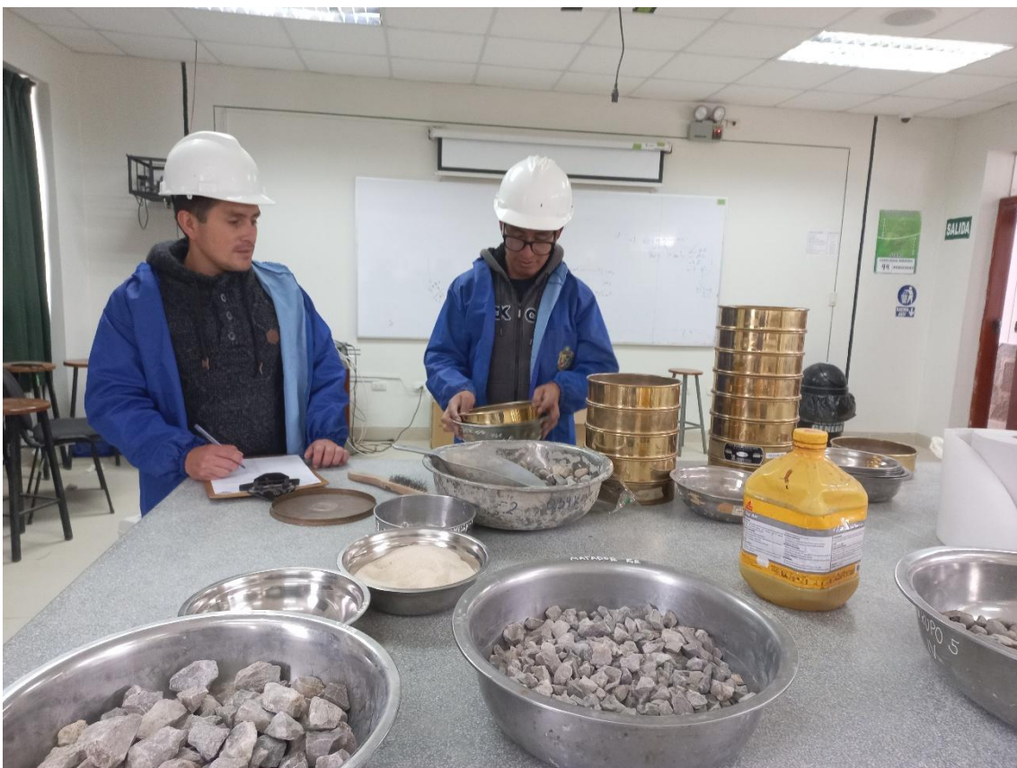
Fotografía 16. Tamizado para el análisis granulométrico
