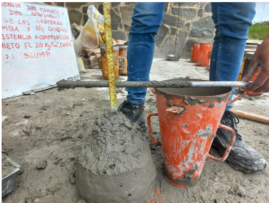
Fotografía 28. Ensayo de asentamiento a la mezcla de concreto
