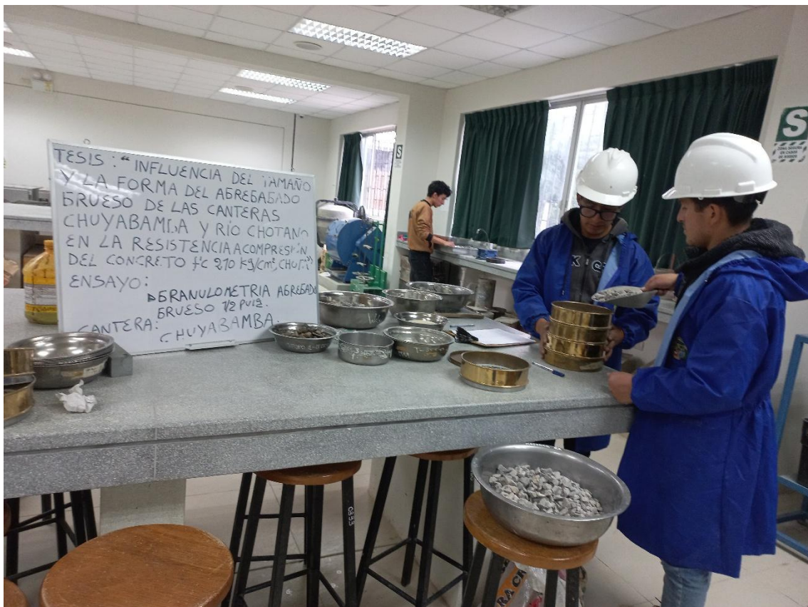
Fotografía 18. Ensayo de granulometría con el agregado grueso de la cantera Chuyabamba
