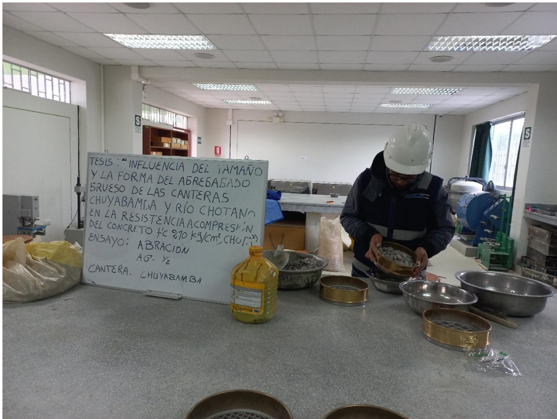
Fotografía 20. Pesado de la muestra para el ensayo de abrasión
