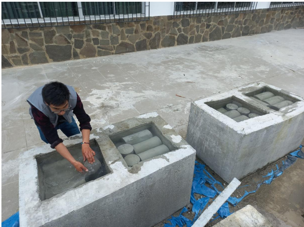
Curado de Probetas de Concreto em el Laboratorio de la EPIC UNACH
