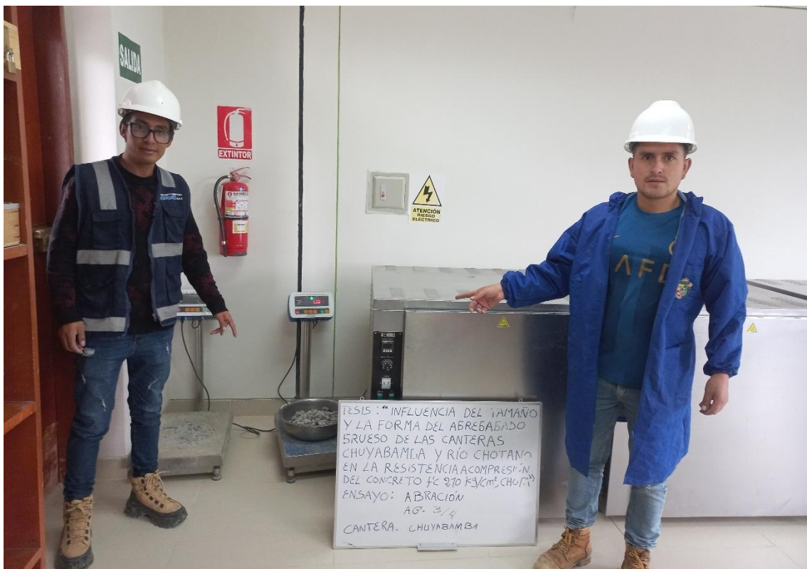
Fotografía 20. Pesado de la muestra para el ensayo de abrasión
