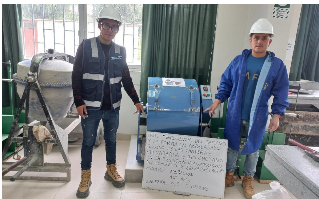
Realización del Ensayo de Abrasión en el Agregado Grueso
