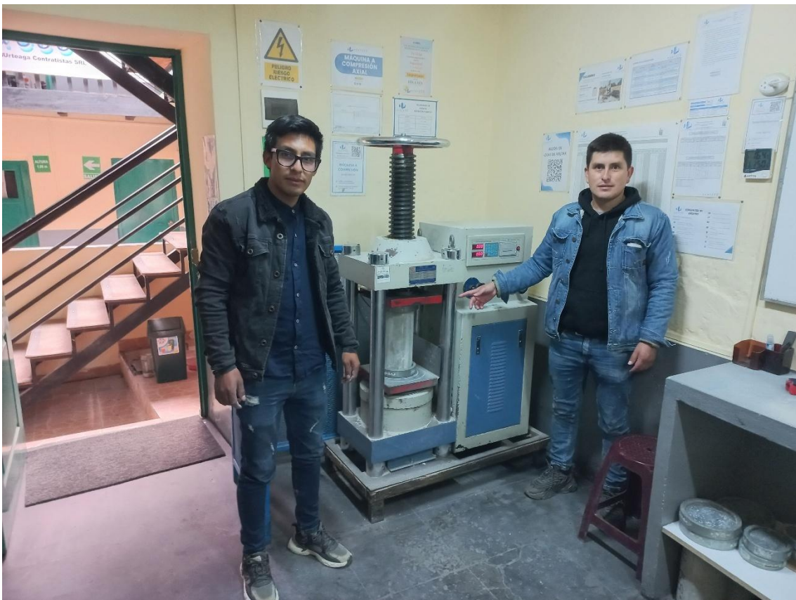
Fotografía 36. Ensayo de resistencia a compresión de probetas de concreto a los 7 días
