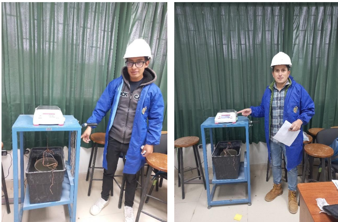
Fotografía 14. Ensayo de peso específico al agregado grueso
