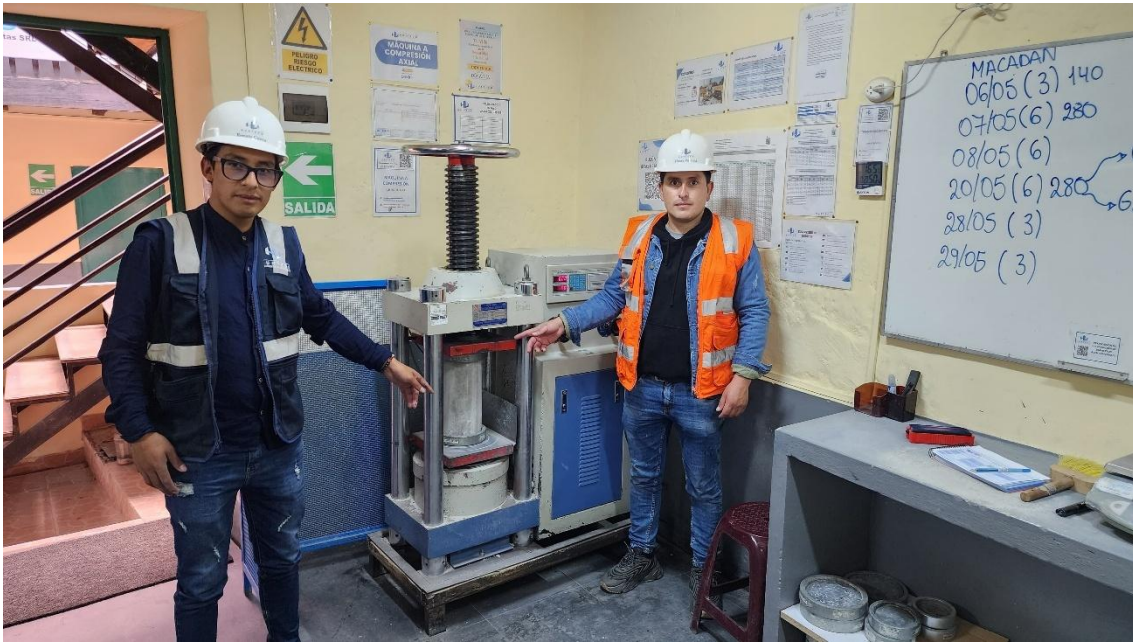
Fotografía 37. Ensayo de resistencia a compresión de probetas a los 14 días
