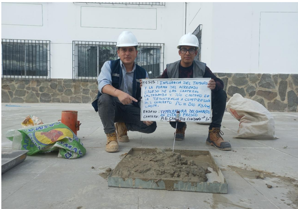
Fotografía 26. Determinación de la temperatura de la mezcla del concreto
