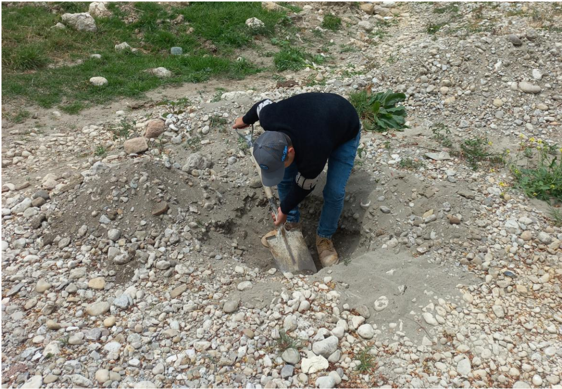
Fotografía 8. Calicata realizada en la cantera para extracción de muestras
