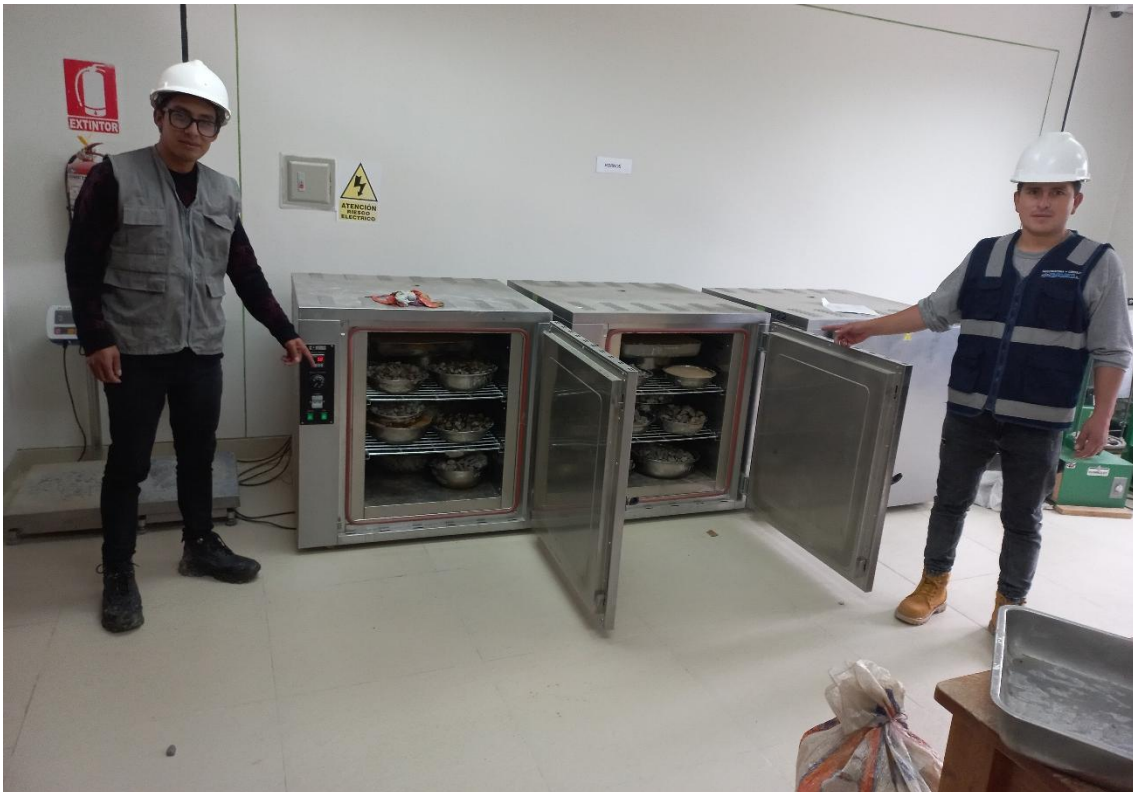
Fotografía 10. Ensayo de contenido de humedad a los agregados
