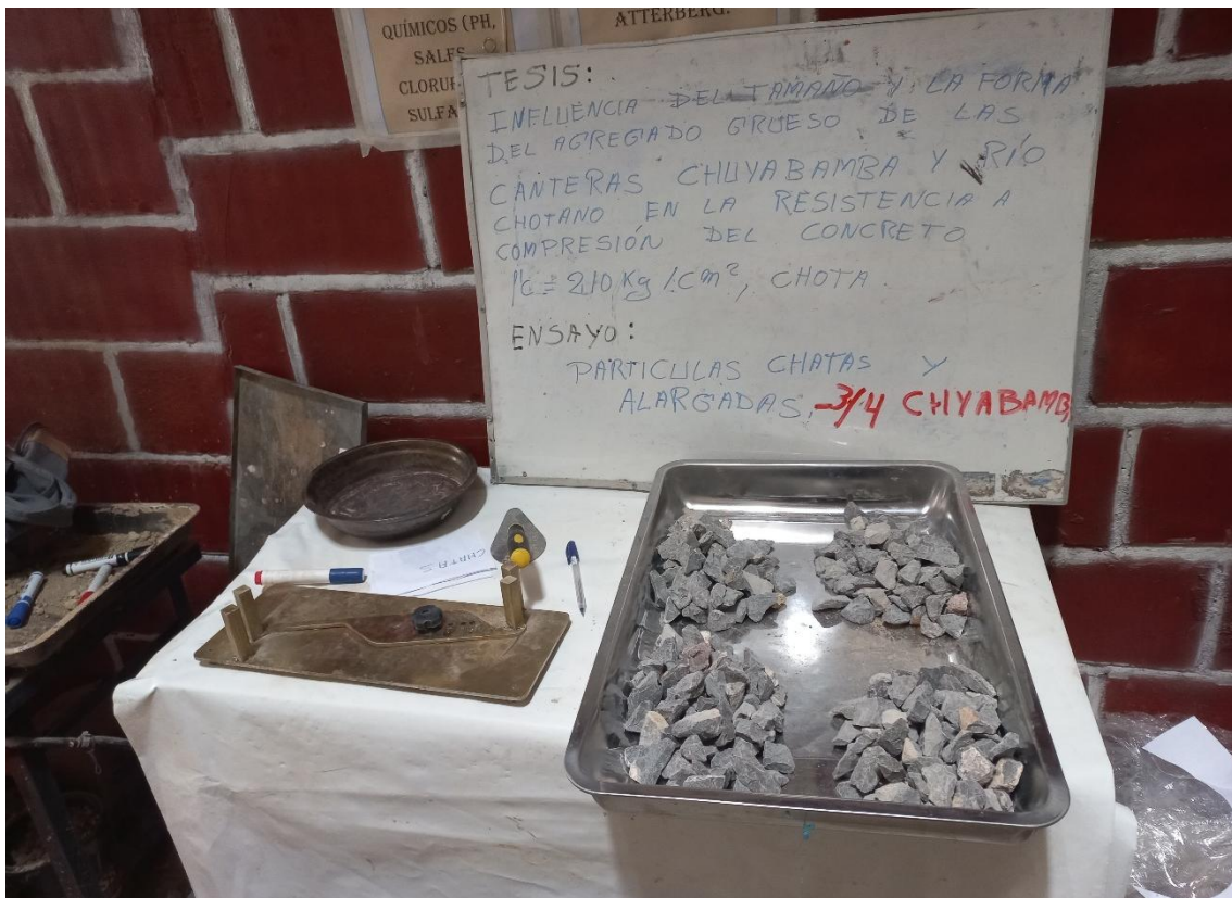
Fotografía 22. Equipos y materiales utilizados en el ensayo de partículas chatas y alargadas
