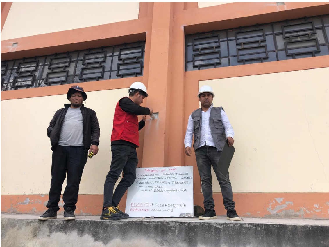
Fotografía 6. Proceso de realización del ensayo de esclerometría
