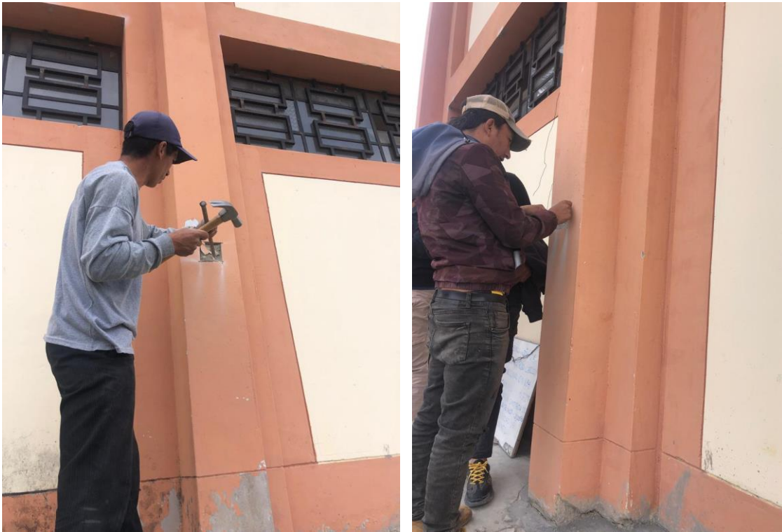
Fotografía 6. Proceso de realización del ensayo de esclerometría
