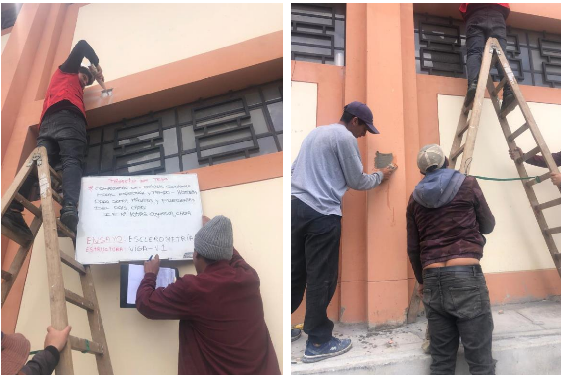
Fotografía 8. Proceso de realización del ensayo de esclerometría y cubierta del tarrajeo que fue retirado
