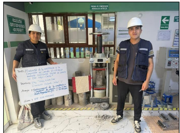
Fotografía 28. Ensayo de resistencia a la compresión a los 14 días del concreto con 4 % de sustitución de cemento por filler calizo pasante por el tamiz N.º 200 (TP < 75 \mu\text{m} ).
