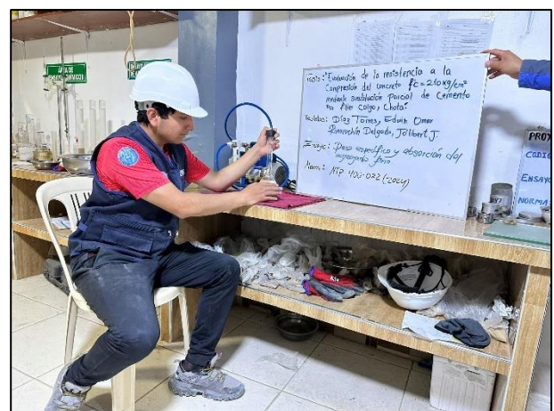
Fotografía 8. Eliminación del aire atrapado durante el ensayo de peso específico del agregado fino.
