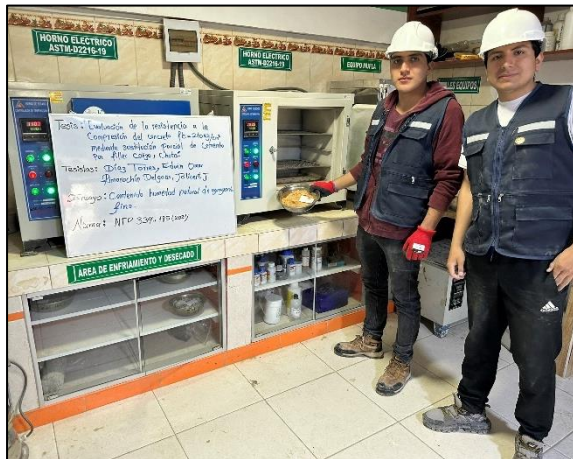
Fotografía 5. Ensayo para la determinación del contenido de humedad del agregado fino.
