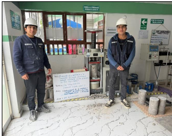
Fotografía 30. Ensayo de resistencia a la compresión a los 14 días del concreto con 12 % de sustitución de cemento por filler calizo pasante por el tamiz N.º 200 (TP < 75 \mu\text{m} ).
