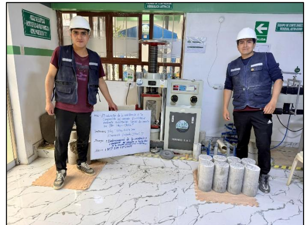
Fotografía 32. Ensayo de resistencia a la compresión a los 28 días del concreto con 4 % de sustitución de cemento por filler calizo pasante por el tamiz N.º 140 y retenido en el N.º 200 (intervalo nominal de 75–106 \mu\text{m} ).
