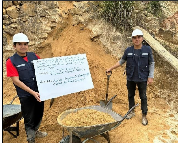
Fotografía 1. Muestreo de agregado fino (arena natural) en la cantera El Arenal, Conchán.
