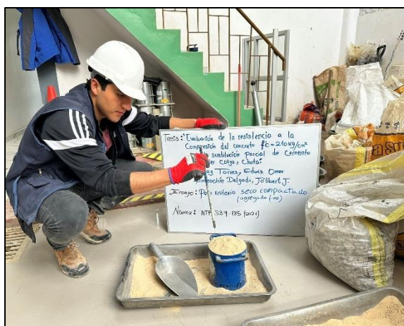
Fotografía 6. Ensayo para la determinación del peso unitario suelto y compactado del agregado fino.
