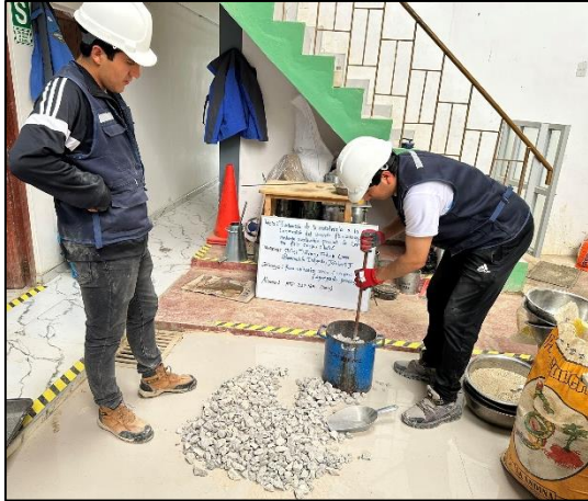
Fotografía 13. Ensayo para la determinación del peso unitario compactado del agregado grueso.
