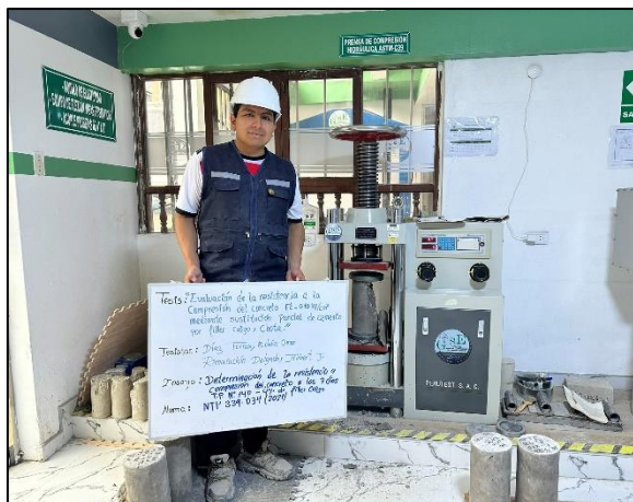
Fotografía 26. Ensayo de resistencia a la compresión a los 7 días del concreto con 4 % de sustitución de cemento por filler calizo pasante por el tamiz N.º 140 y retenido en el N.º 200 (intervalo nominal de 75–106 \mu\text{m} ).
