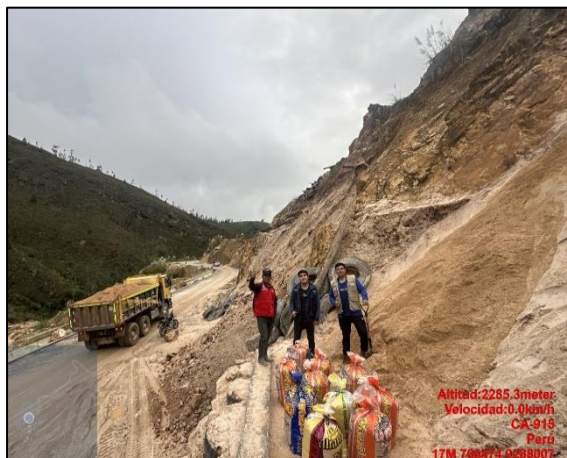
Fotografía 2. Recolección de la muestra de agregado fino en la cantera El Arenal, Conchán.
