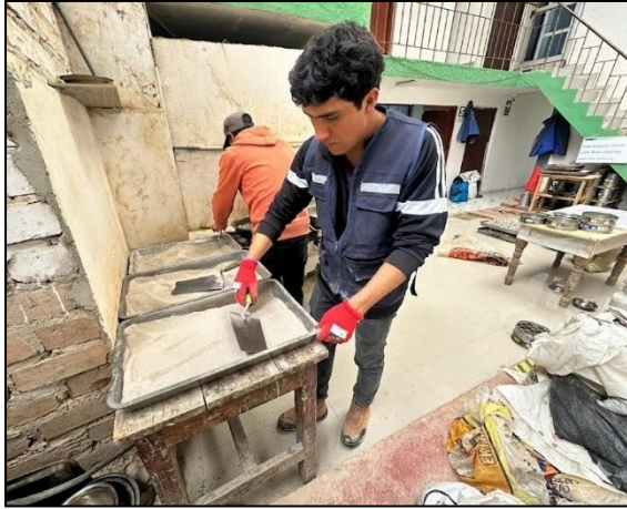
Fotografía 17. Enfriamiento del filler calizo a temperatura ambiente después del secado en estufa.
