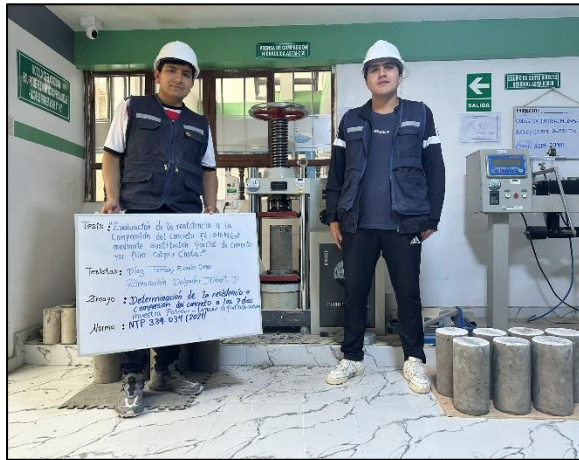
Fotografía 26. Ensayo de resistencia a la compresión a los 7 días del concreto con 4 % de sustitución de cemento por filler calizo pasante por el tamiz N.º 140 y retenido en el N.º 200 (intervalo nominal de 75–106 \mu\text{m} ).
