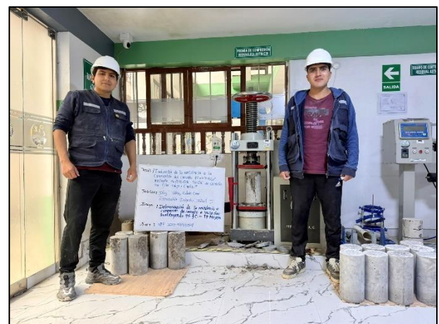
Fotografía 32. Ensayo de resistencia a la compresión a los 28 días del concreto con 4 % de sustitución de cemento por filler calizo pasante por el tamiz N.º 140 y retenido en el N.º 200 (intervalo nominal de 75–106 \mu\text{m} ).
