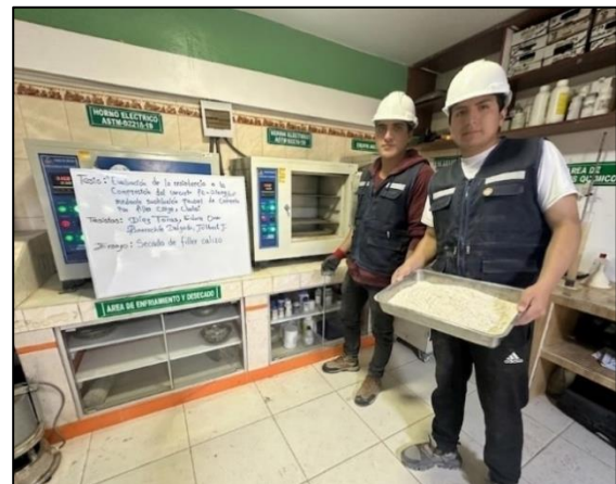
Fotografía 16. Secado de la muestra de filler calizo en estufa.
