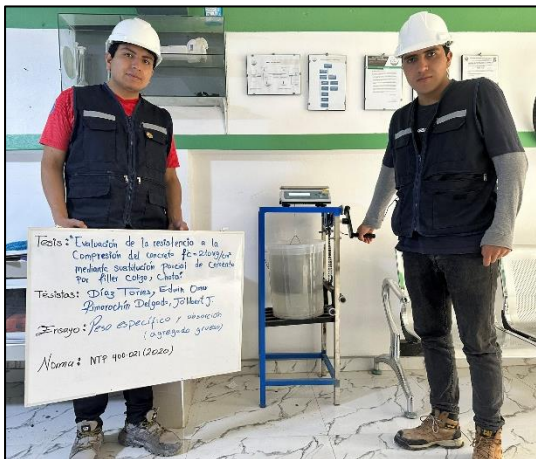
Fotografía 14. Ensayo para la determinación del peso específico y absorción del agregado grueso.
