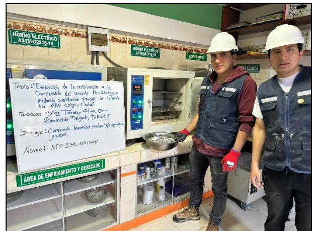
Fotografía 12. Ensayo para la determinación del contenido de humedad del agregado grueso.
