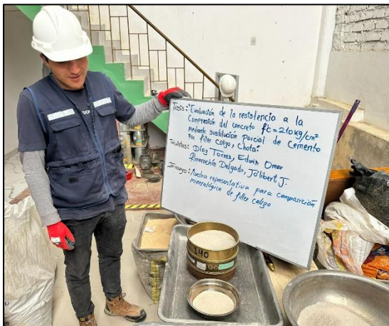
Fotografía 18. Tamizado del filler calizo para la obtención de las fracciones granulométricas evaluadas.
