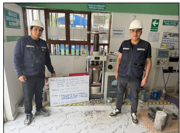
Fotografía 28. Ensayo de resistencia a la compresión a los 14 días del concreto con 4 % de sustitución de cemento por filler calizo pasante por el tamiz N.º 200 (TP < 75 \mu\text{m} ).
