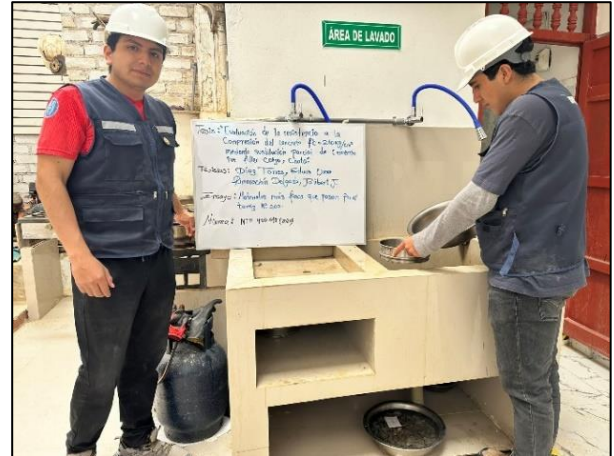
Fotografía 3. Determinación del material más fino que pasa por el tamiz N.º 200 (75 \mu m) mediante lavado.
