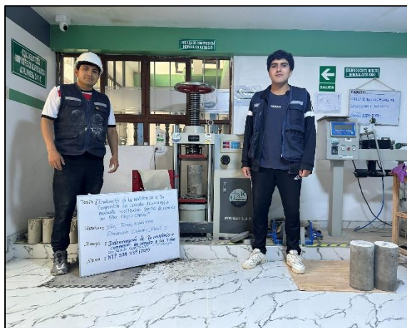
Fotografía 30. Ensayo de resistencia a la compresión a los 14 días del concreto con 12 % de sustitución de cemento por filler calizo pasante por el tamiz N.º 200 (TP < 75 \mu\text{m} ).
