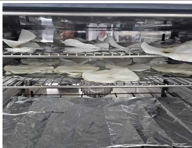
Secado de sedimento húmedo en estufa a 105 °C/3 h
