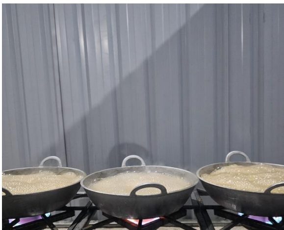
Evaporación y concentración del jugo de caña clarificado
