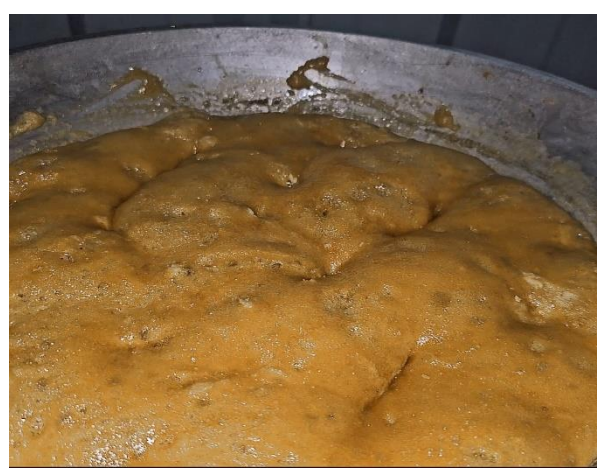
Inicio de cristalización de la sacarosa (sobresaturación)
