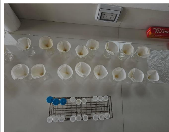
Filtración de sedimento húmedo
