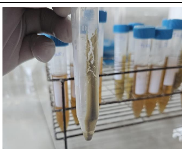
Determinación de sólidos insolubles – centrifugación – sedimento húmedo
