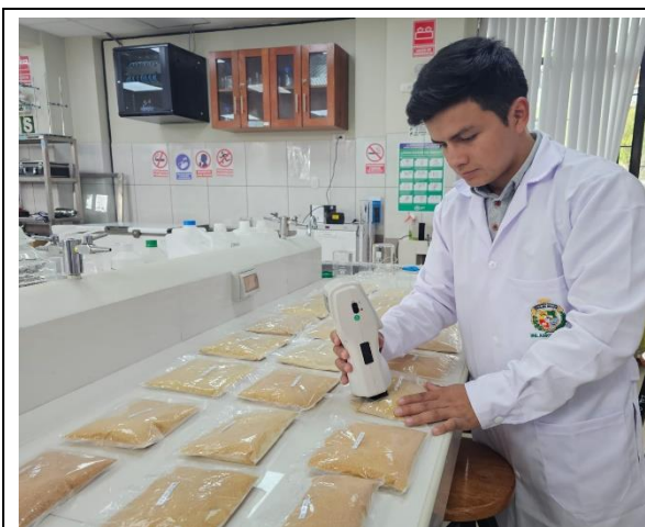
Determinación de parámetros de color ( L^* , a^* , b^* ) mediante colorímetro.
