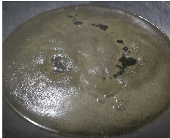
Mecanismo de la floculación y formación de cachaza (clarificación)
