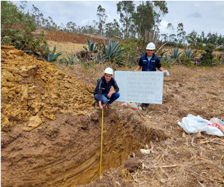
Fotografía 21: Medida de profundidad y extracción de muestras calicata N° 7.
