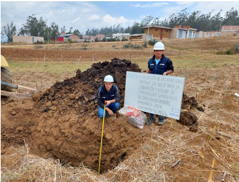
Fotografía 33: Medida de profundidad y extracción de muestras calicata N° 11.
