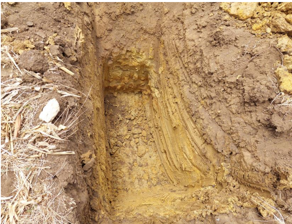
Fotografía 20: Perfil estratigráfico de la calicata N° 7.
