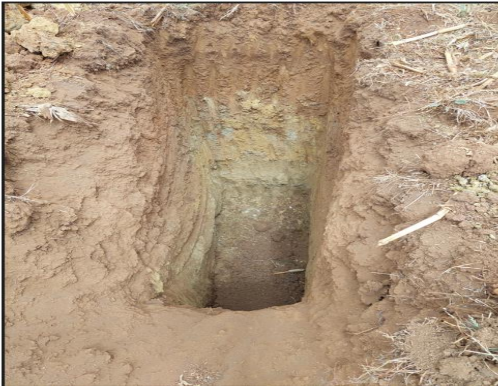
Fotografía 11: Perfil estratigráfico de la calicata N° 4.
