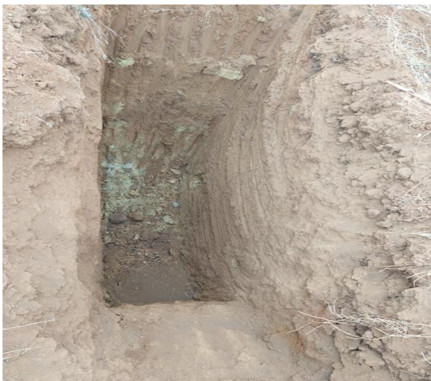
Fotografía 14: Perfil estratigráfico de la calicata N° 5.
