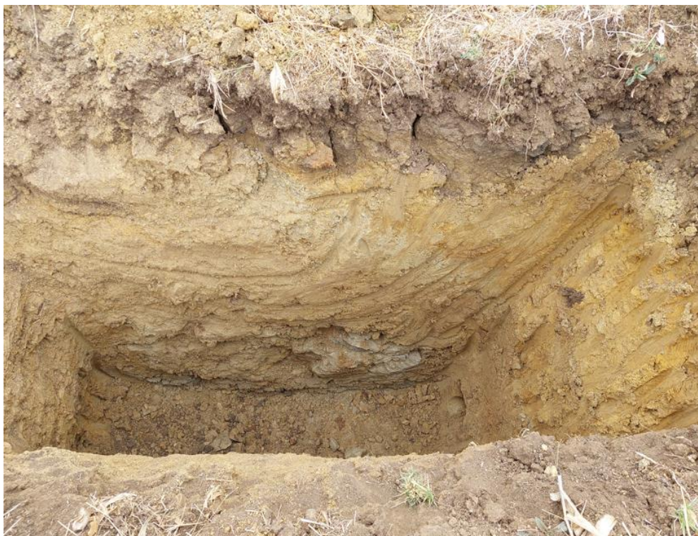
Fotografía 17: Perfil estratigráfico de la calicata N° 6.
