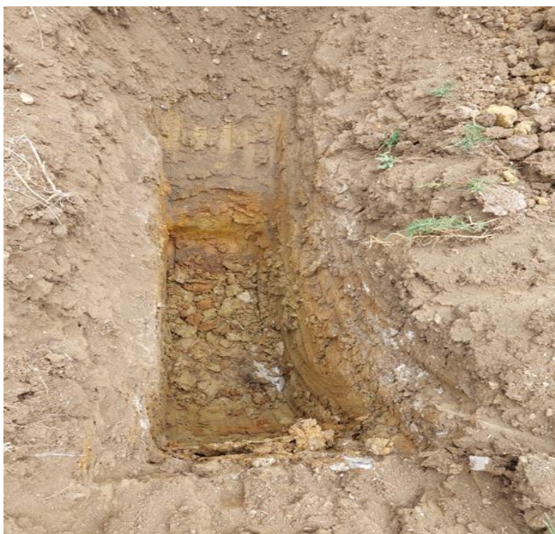
Fotografía 35: Perfil estratigráfico de la calicata N° 12.
