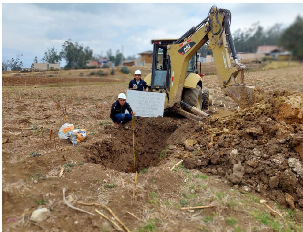
Fotografía 36: Medida de profundidad y extracción de muestras calicata N° 12.
