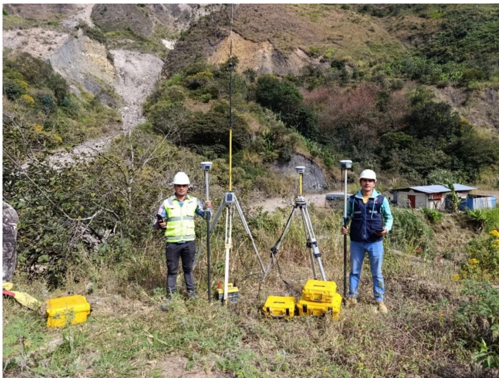
Fotografía 6. Levantamiento topográfico con GPS Diferencial del puente Chontabamba
