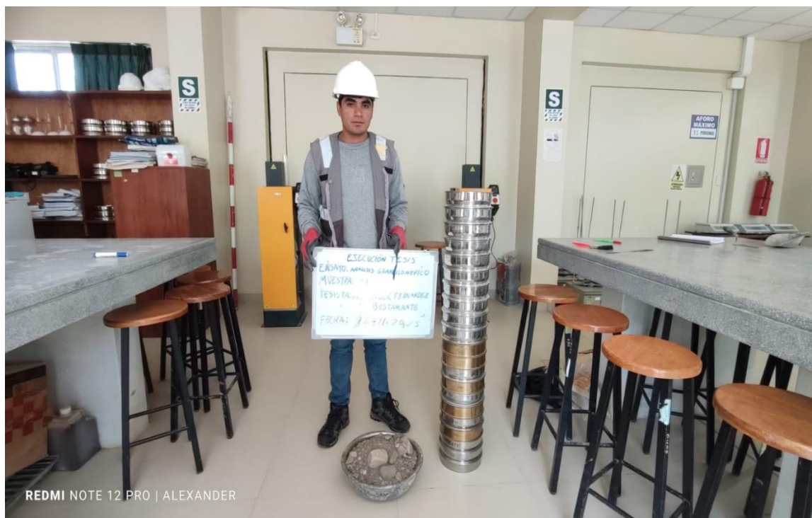
Fotografía 14. Tamizaje de las muestras del ensayo de análisis granulométrico
