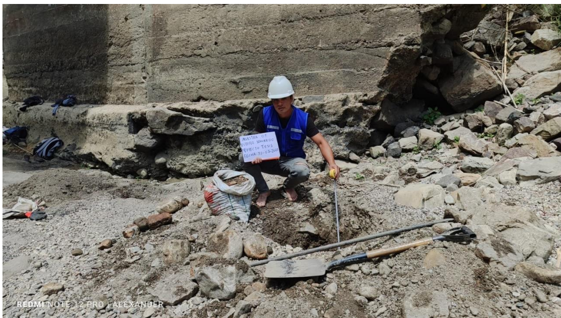
Fotografía 8. Calicata 1 - ubicada en estribo izquierdo del puente Chontabamba
