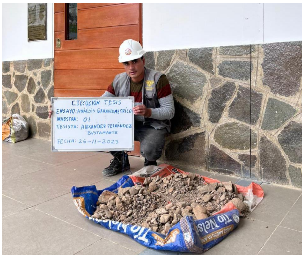
Fotografía 12. Toma de muestras para ensayo de análisis granulométrico
