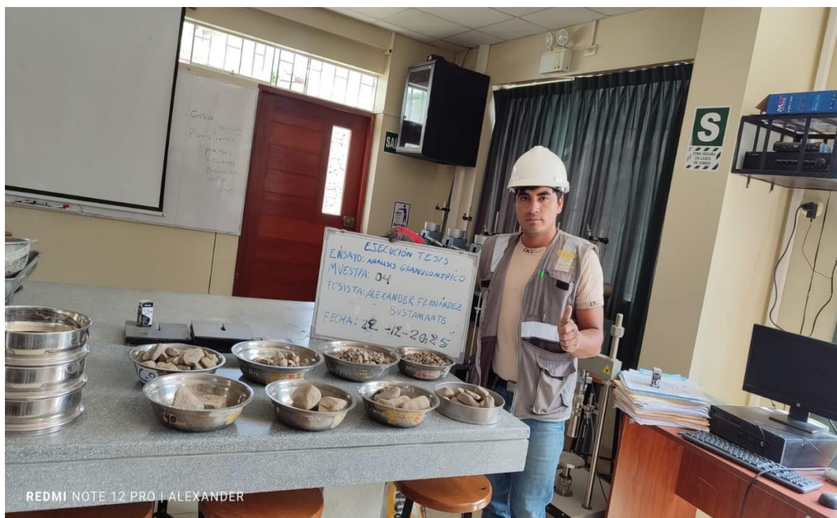
Fotografía 14. Tamizaje de las muestras del ensayo de análisis granulométrico
