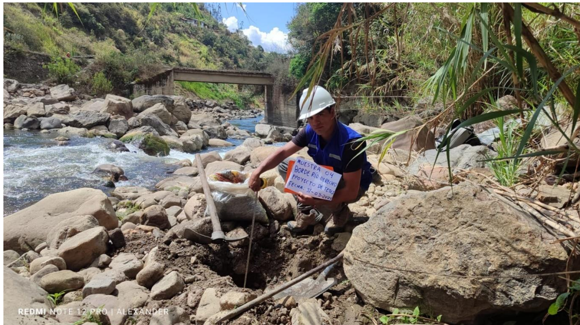
Fotografía 12. Toma de muestras para ensayo de análisis granulométrico
