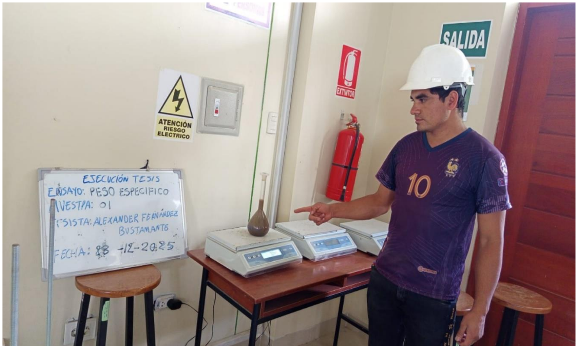
Fotografía 17. Pesado de la fiola y la muestra de suelo utilizada para el peso específico
