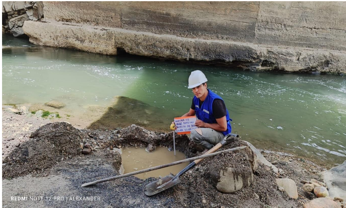
Fotografía 10. Calicata 3 - ubicada a 30 m aguas arriba del puente Chontabamba
