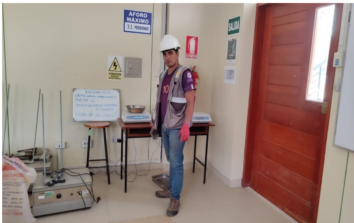
Fotografía 15. Peso del material retenido de las muestras del ensayo de análisis granulométrico
