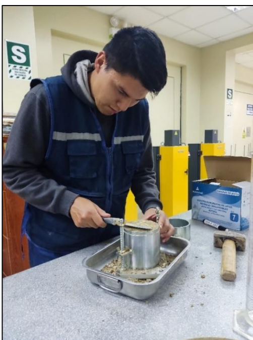
Fotografía 18: Proctor modificado, muestra después de la compactación
