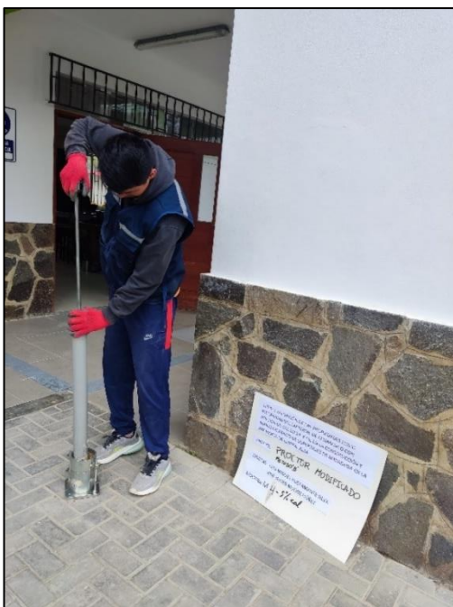
Fotografía 18: Proctor modificado, muestra después de la compactación
