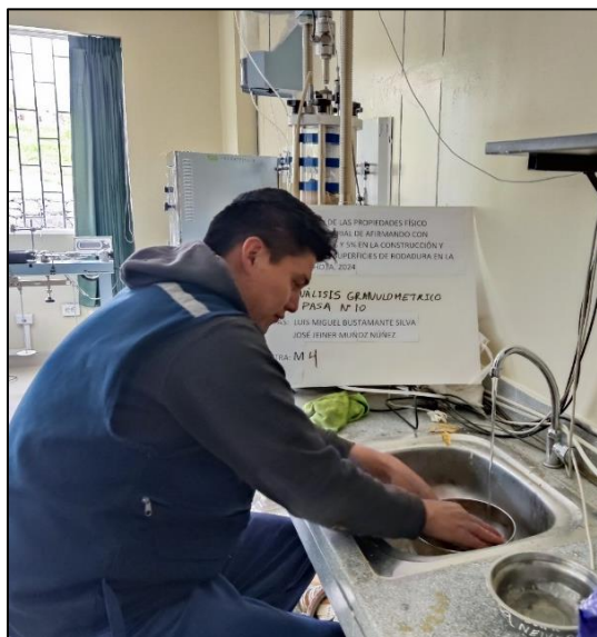
Fotografía 10: Análisis granulométrico, Proceso de lavado
