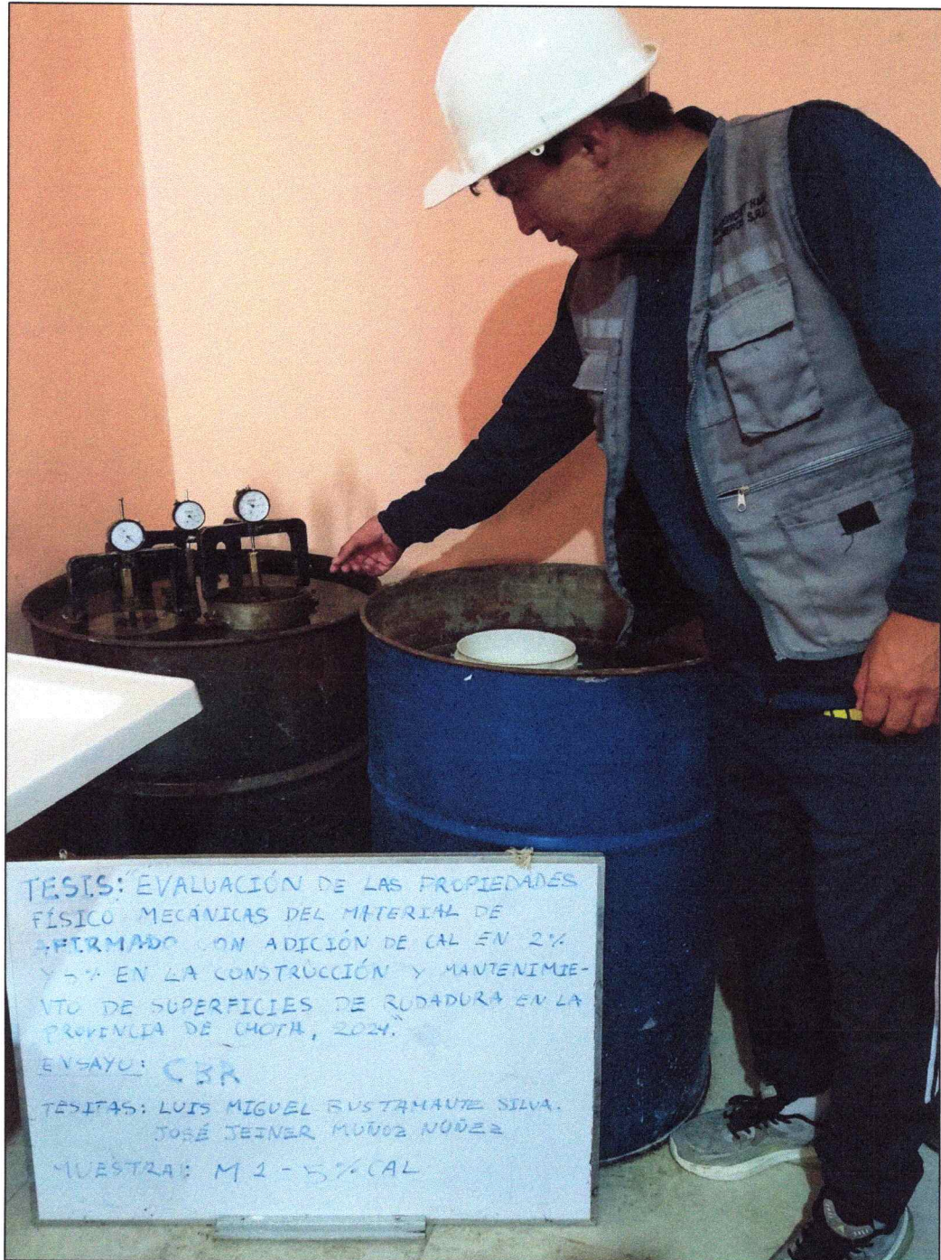
FOTOGRAFIA 3: Evaluación de hinchamiento en ensayo de C.B.R.
