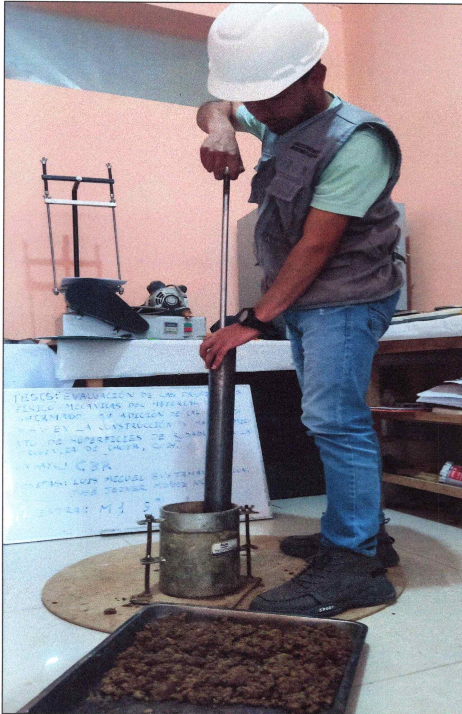
FOTOGRAFIA 1: Ensayo de C.B.R. según A.S.T.M. D 1883
