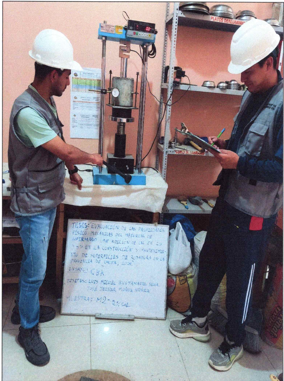
FOTOGRAFIA 2: Ensayo de C.B.R. según A.S.T.M. D 1883
