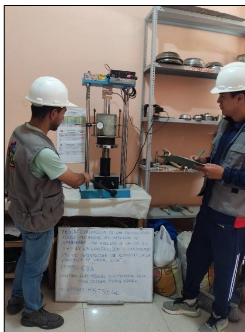
Fotografía 20: Ensayo de CBR, lecturas de la curva presión-penetración
