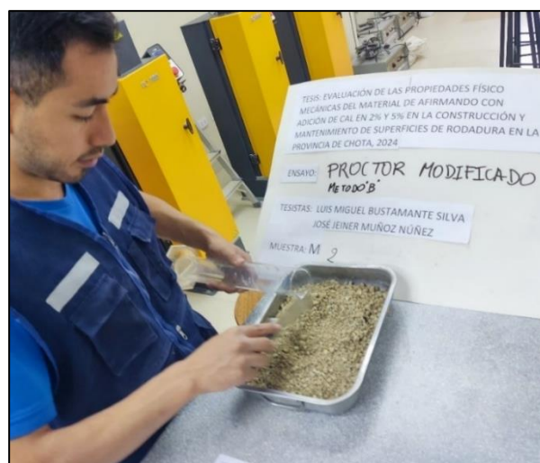
Fotografía 16: Proctor modificado, mezclado de la muestra
