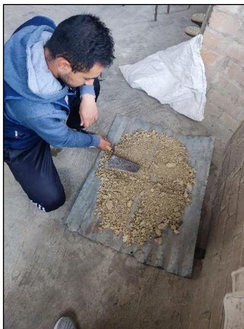
Fotografía 08: Detalle del proceso de cuarteo de la muestra
