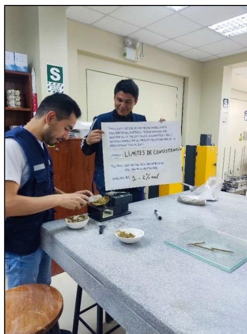
Fotografía 12: Límites de consistencia, Límite líquido
