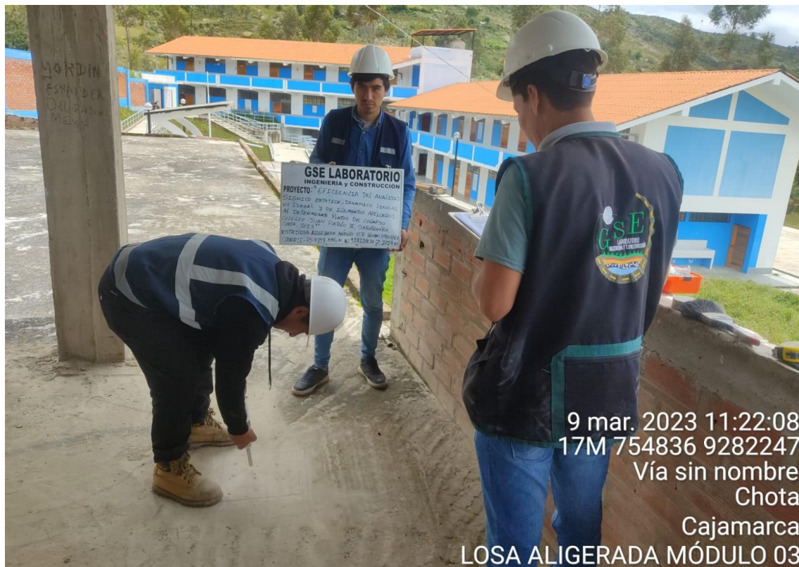
Fotografía 21 Cuadro que se realiza después de retirar el tarrajeo en los elementos estructurales para realizar el ensayo de resistencia a la compresión con esclerómetro
