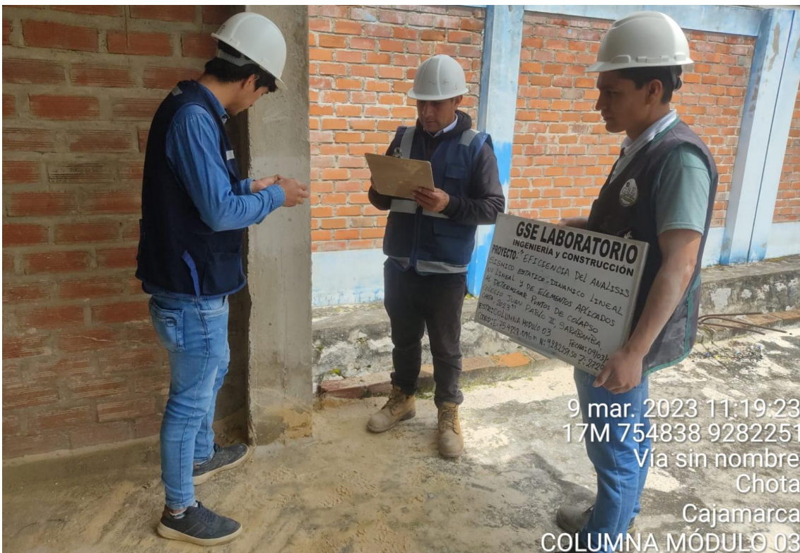
Fotografía 19 Ensayo de resistencia a la compresión del concreto con esclerometría en columnas del módulo N° 3 del colegio Juan Pablo II de Sarabamba
