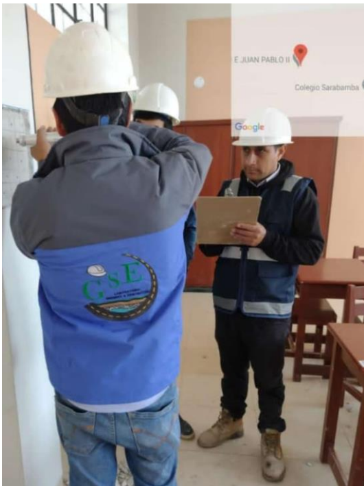
Fotografía 19 Ensayo de resistencia a la compresión del concreto con esclerometría en columnas del módulo N° 3 del colegio Juan Pablo II de Sarabamba
