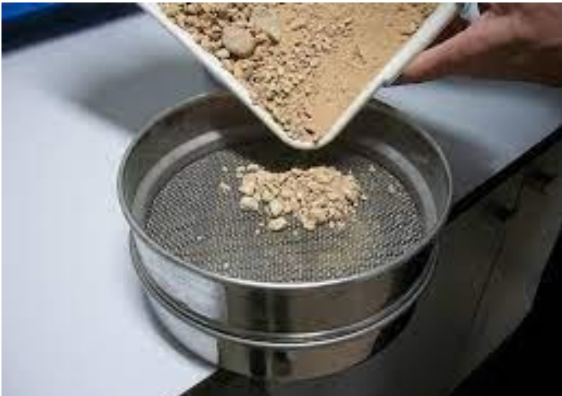
Fotografía 13 Estudio de Mecánica de Suelos: Pasando la muestra de suelo por tamices para el ensayo granulométrico para el ensayo granulométrico
