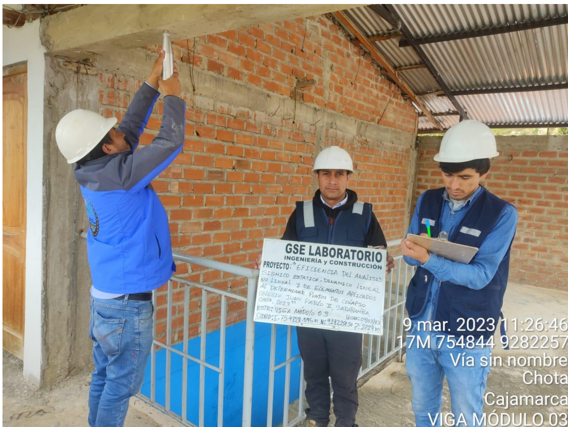
Fotografía 17 Ensayo de esclerometría en las vigas del módulo N° 3 del colegio Juan Pablo II
