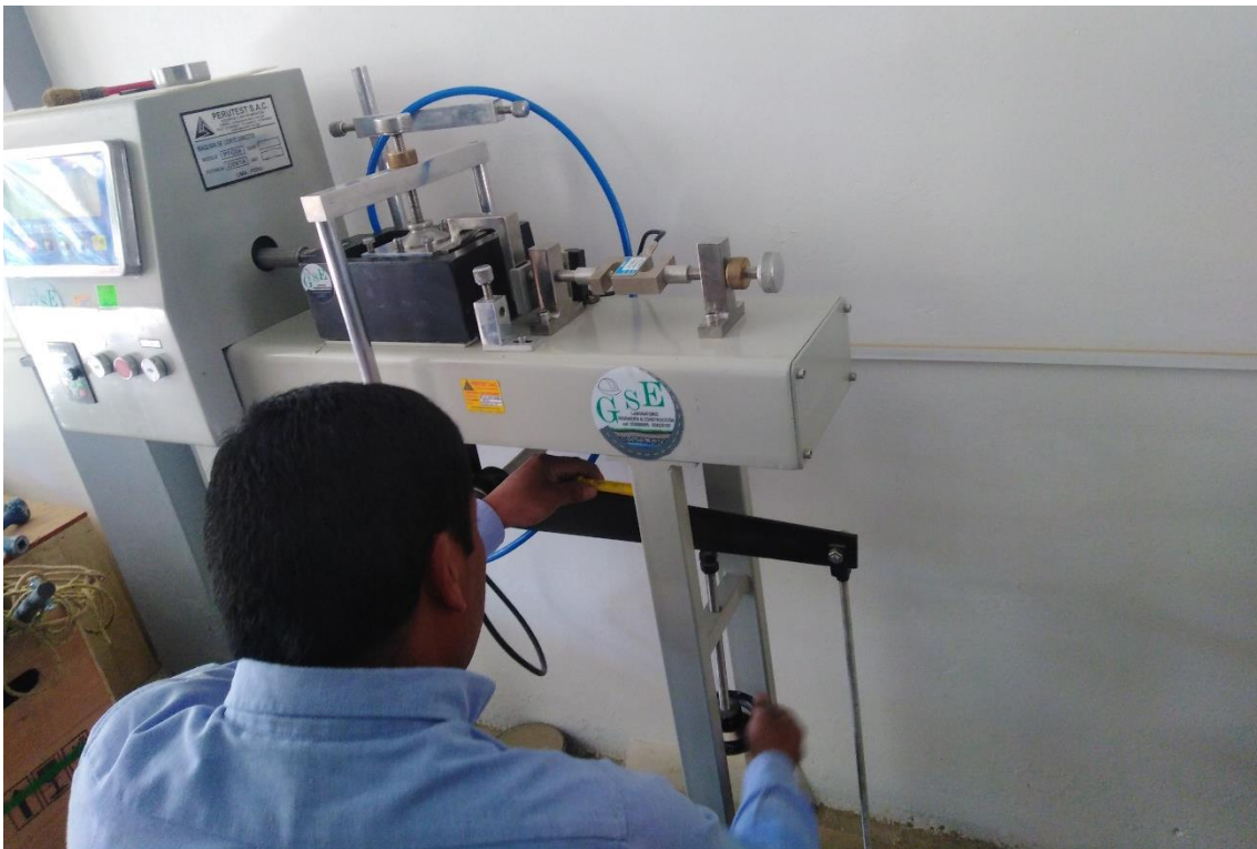
Fotografía 15 Muestra de suelo sometida al ensayo de corte directo en el laboratorio GSE de la ciudad de Chota para determinar su cohesión, ángulo de fricción y capacidad portante
