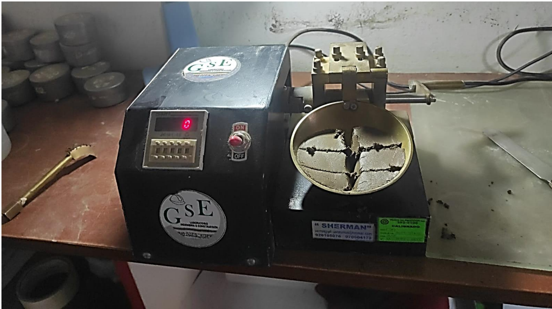
Fotografía 13 Estudio de Mecánica de Suelos: Pasando la muestra de suelo por tamices para el ensayo granulométrico para el ensayo granulométrico
