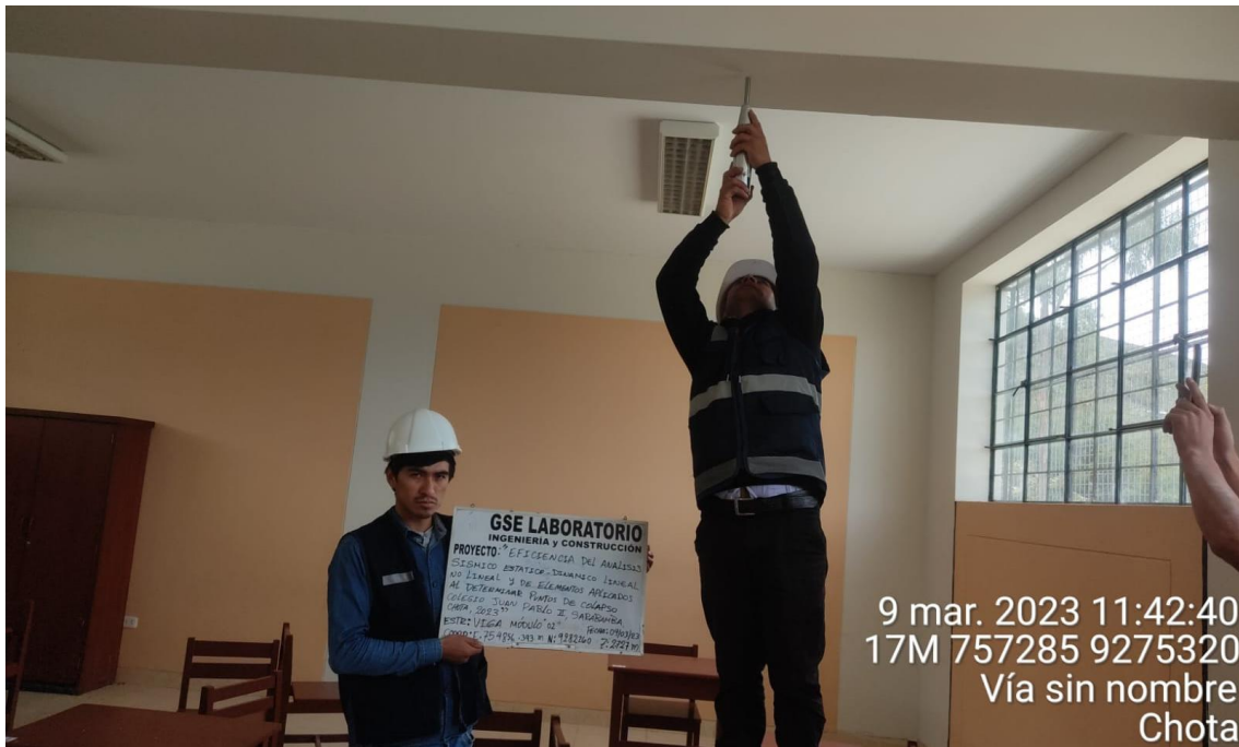
Fotografía 17 Ensayo de esclerometría en las vigas del módulo N° 3 del colegio Juan Pablo II
