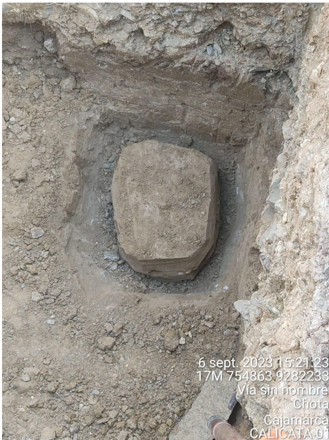
Fotografía 11 Toma de muestras de suelo de una cubica en la calicata de estudio
