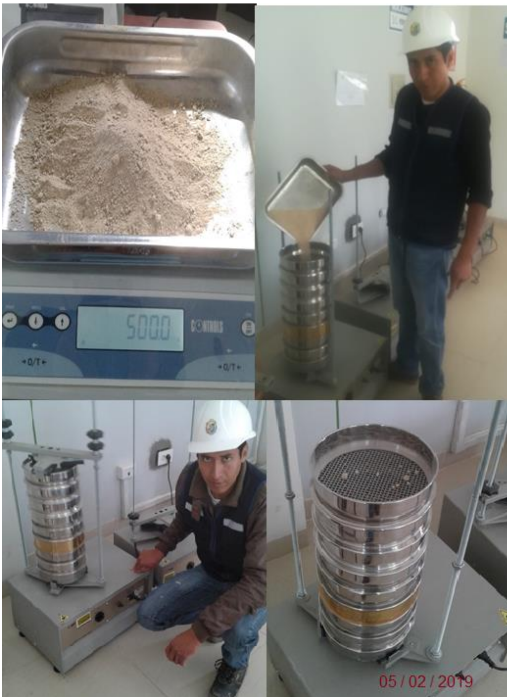
Fotografía N°12: En esta fotografía se observa la realización del ensayo del análisis granulométrico de la materia prima.
