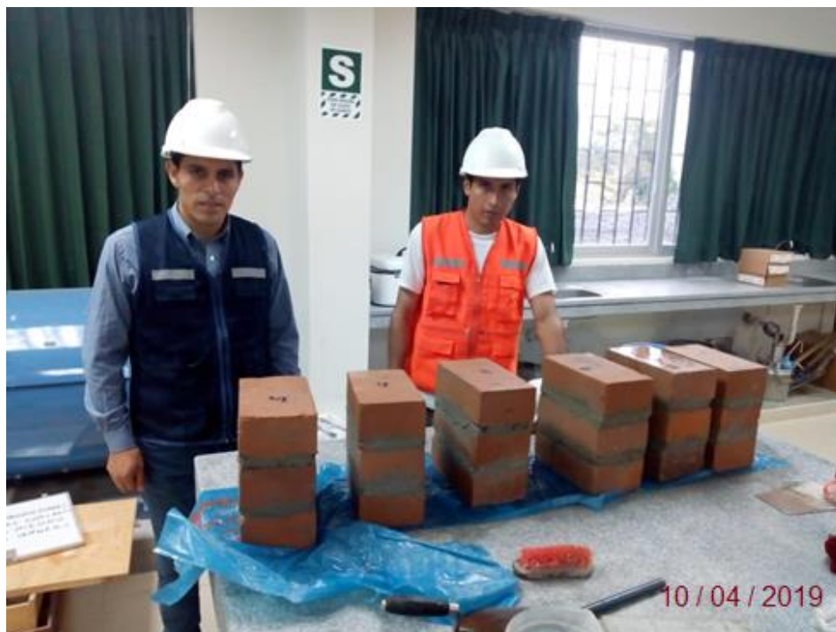
Fotografía N°23: Se observa las pilas elaboradas de unidades de albañilería y la realización del ensayo de resistencia a compresión de pilas.
