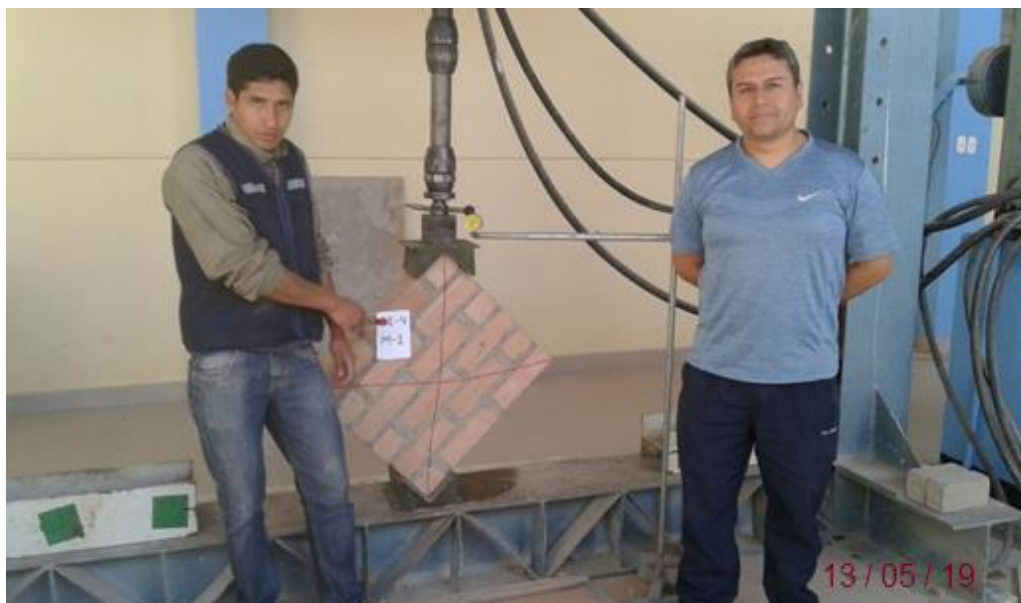
Fotografía N°23: Se observa la realización del ensayo de corte diagonal en muretes.
