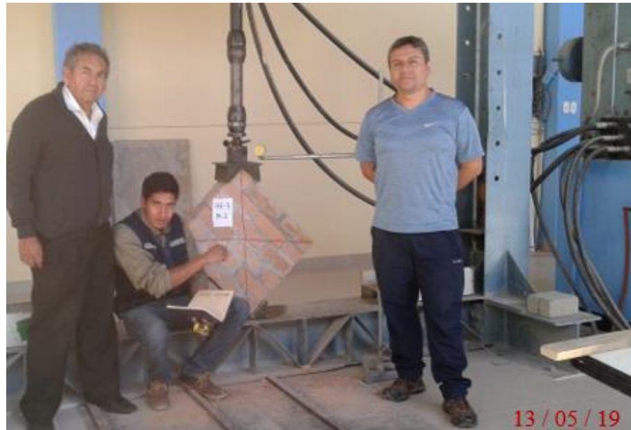
Ruptura de muretes
