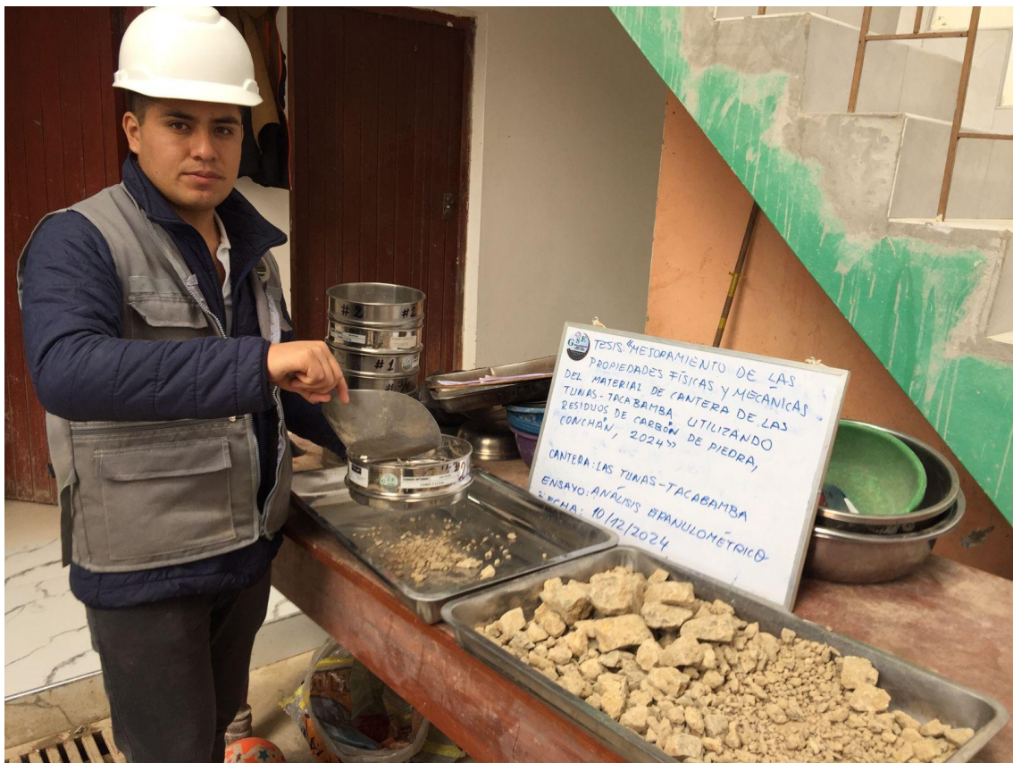
Fotografía 10 Análisis granulométrico del suelo natural
