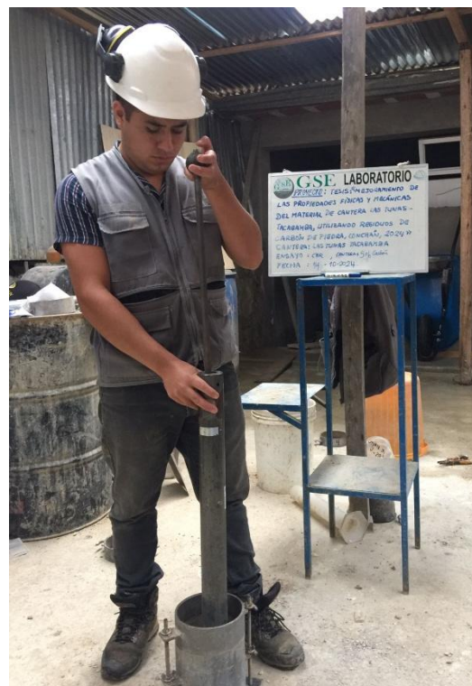
Fotografía 17 Ensayo Proctor modificado al suelo con carbón
