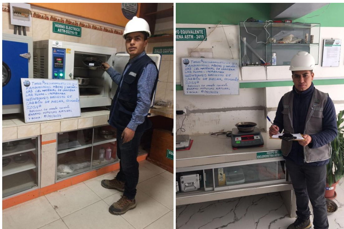
Fotografía 6 Ensayo de humedad natural de los residuos de carbón de piedra
