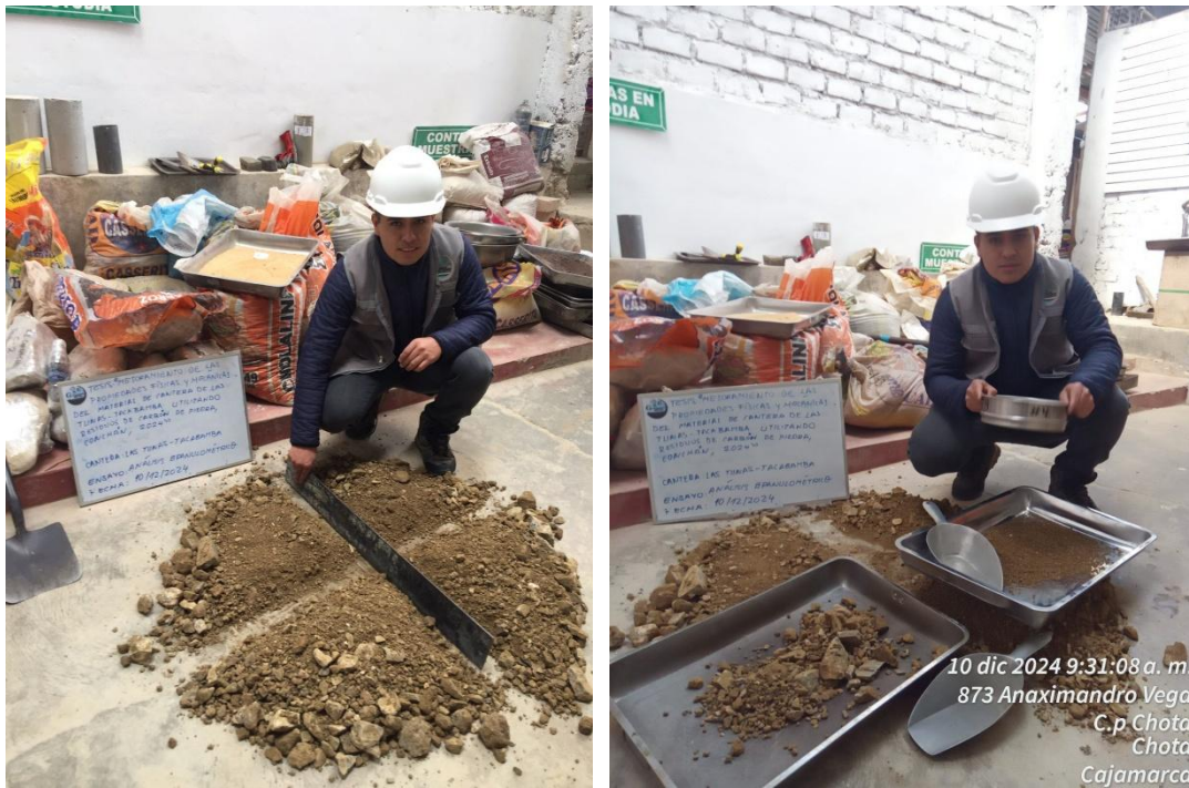
Fotografía 10 Análisis granulométrico del suelo natural
