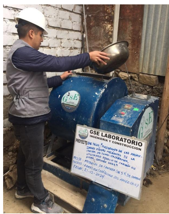
Fotografía 14 Ensayo de abrasión de los ángeles al suelo con carbón
