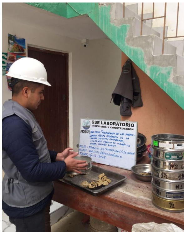
Fotografía 16 Análisis granulométrico al suelo con carbón
