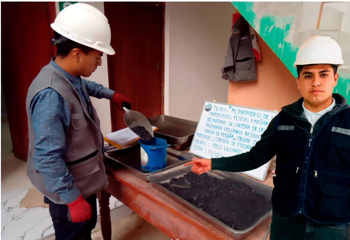
Fotografía 8 Ensayo de peso específico de los residuos de carbón
