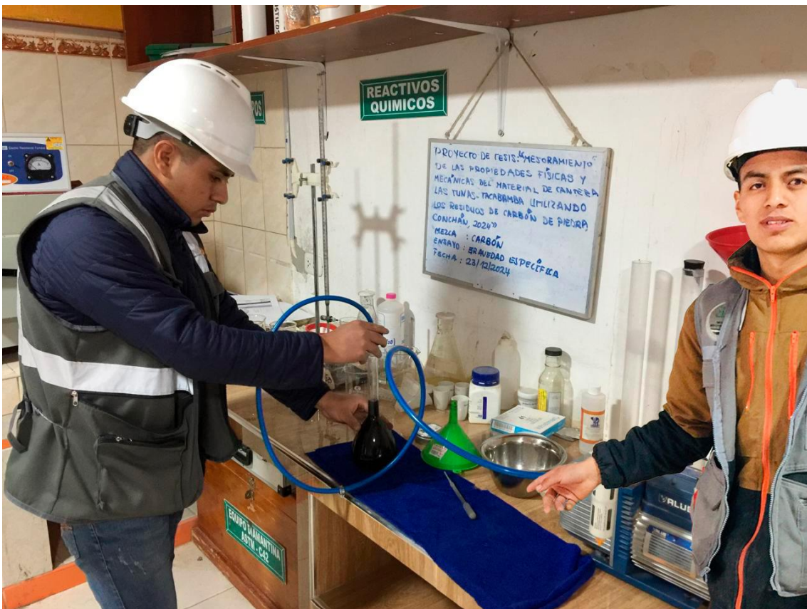
Fotografía 8 Ensayo de peso específico de los residuos de carbón
