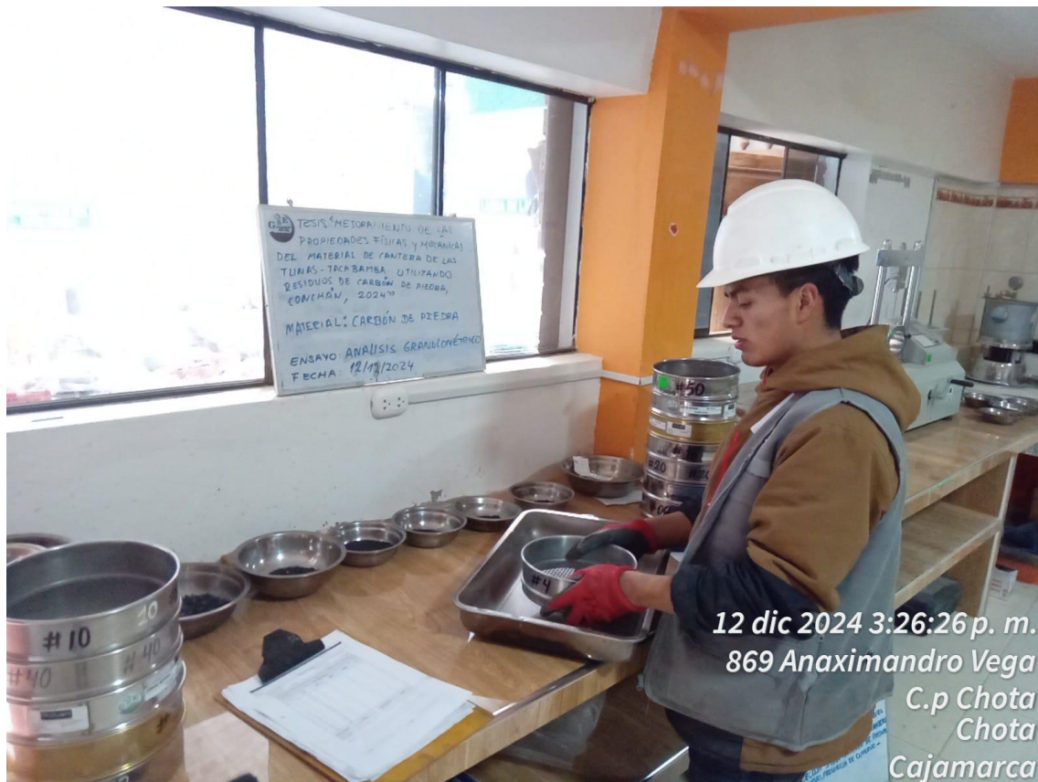
Fotografía 6 Ensayo de humedad natural de los residuos de carbón de piedra
