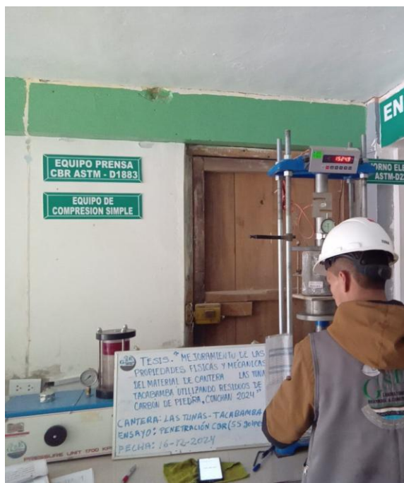
Fotografía 13 Ensayo de penetración CBR al suelo natural
