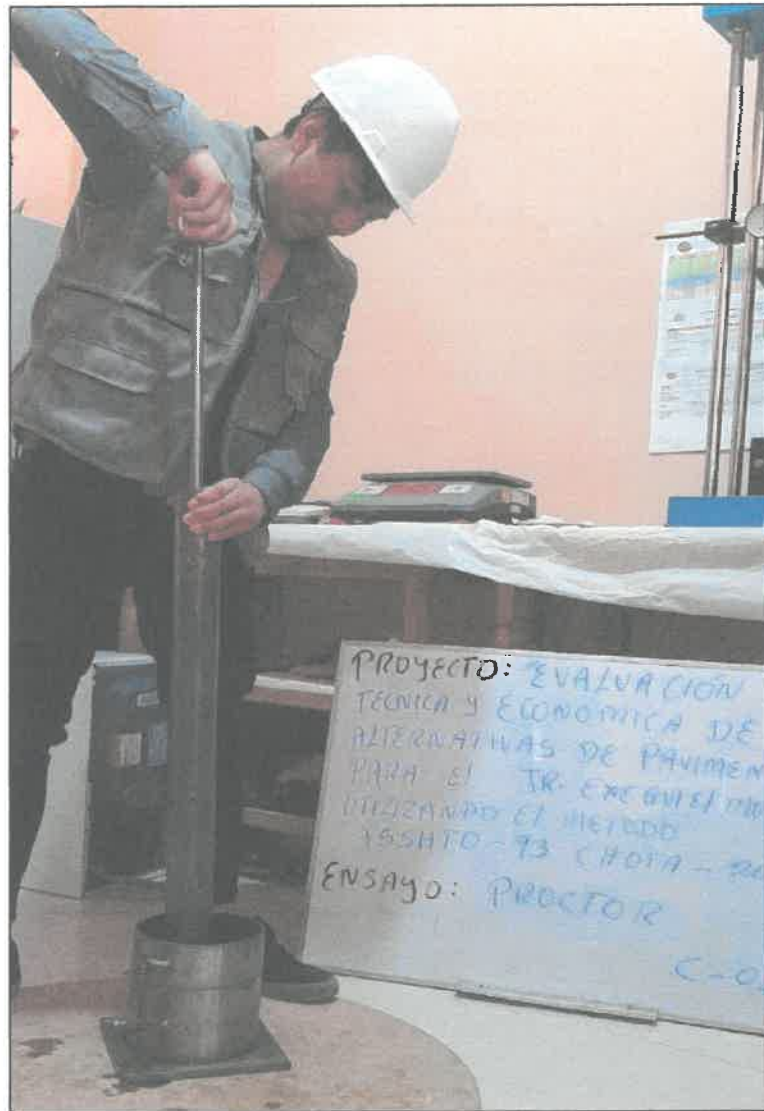
FOTOGRAFIA 07: Muestra el ensayo de proctor de la C - 1, según la Norma (A.A.S.T.H.O. T 180)
