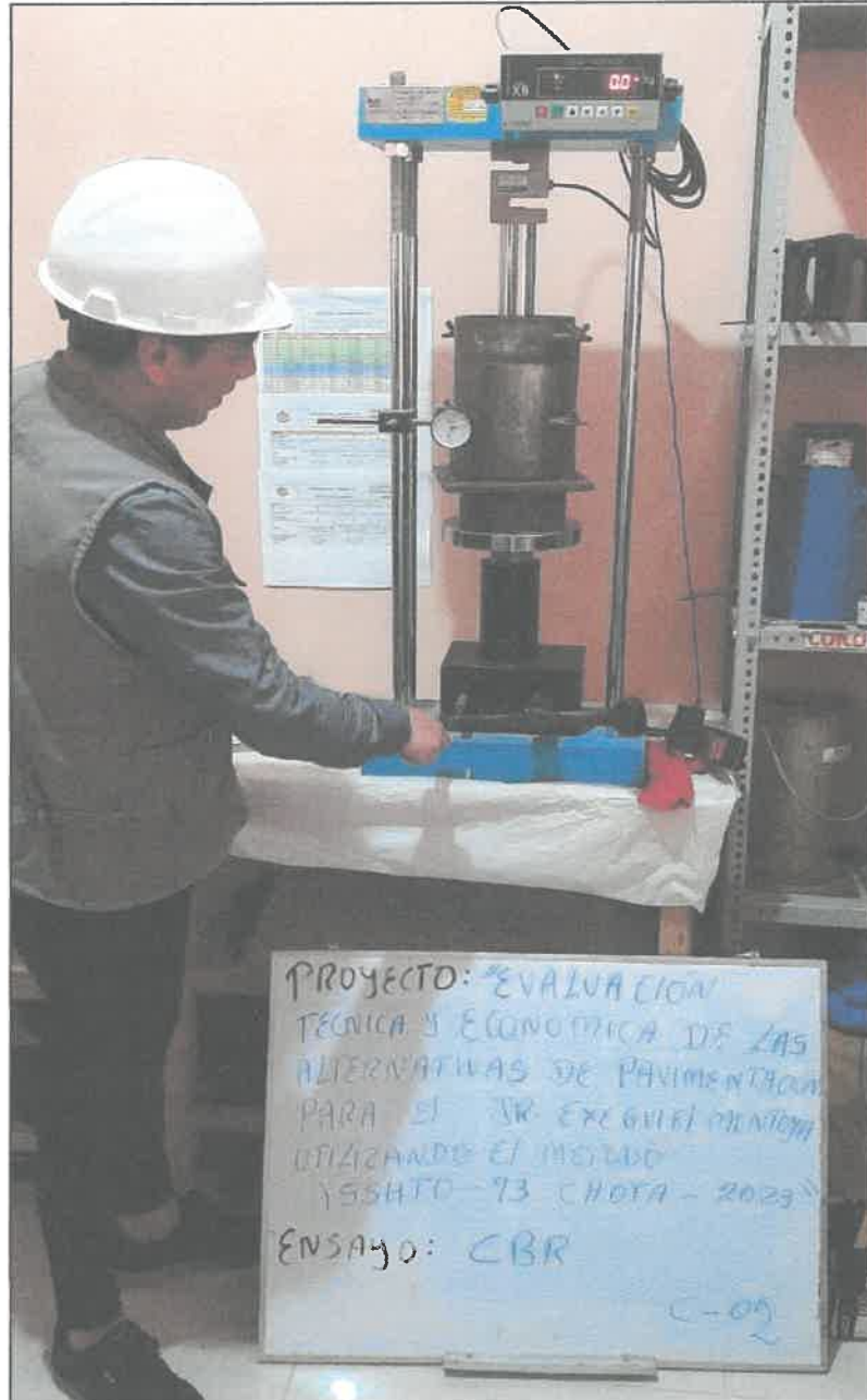
FOTOGRAFIA 10: Muestra el ensayo de CBR de la C - 2, según la Norma (A.S.T.M. D 1883)
