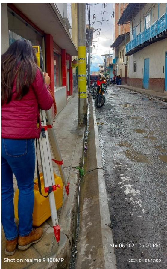
Fotografía 3. Toma de Puntos Topográficos en los Bordes de la Vía, Cunetas Existentes, Postes y Demás Puntos de Interés en el Jr. Exequiel Montoya
