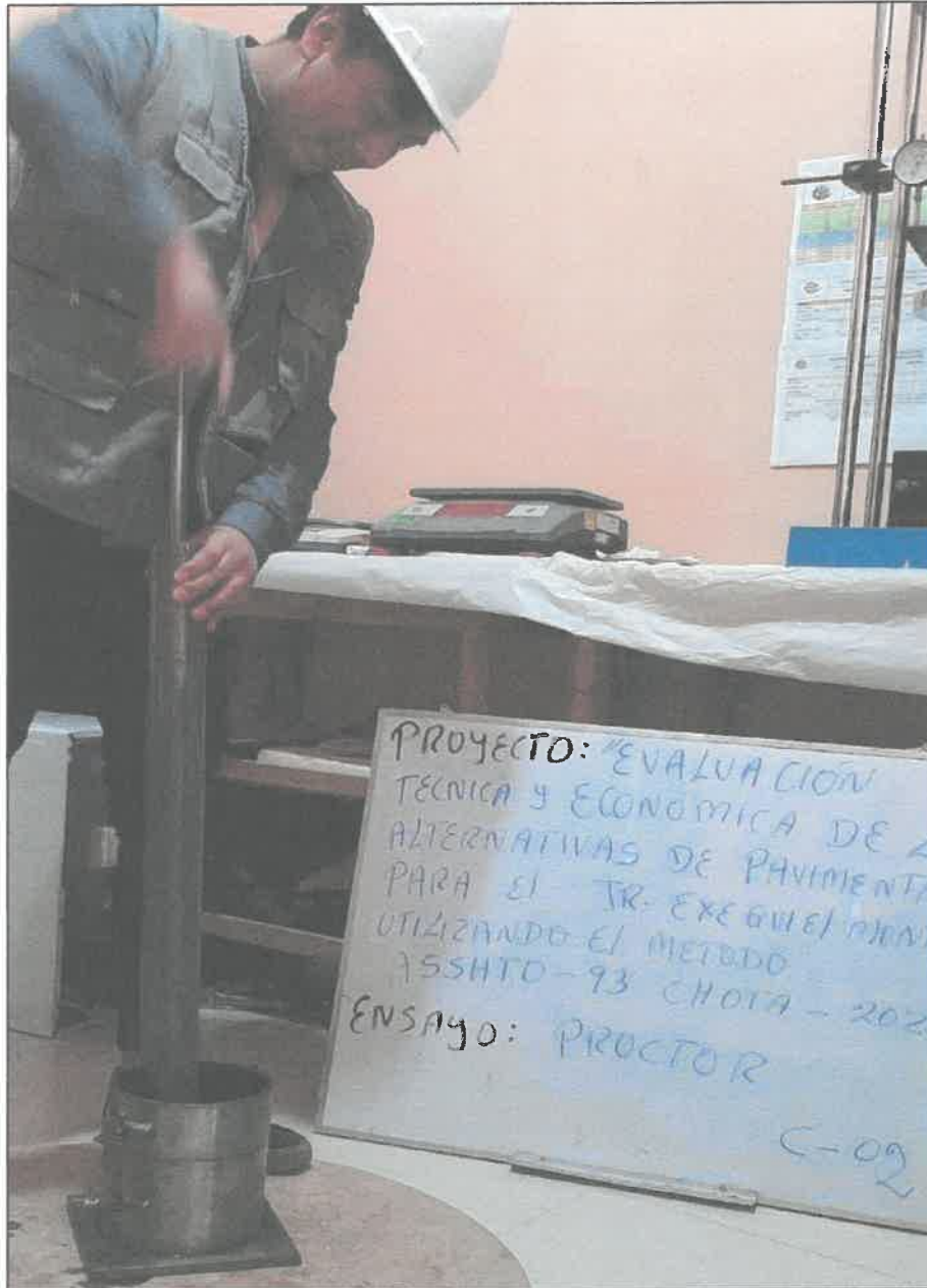
FOTOGRAFIA 08: Muestra el ensayo de proctor de la C - 2, según la Norma (A.A.S.T.H.O. T 180)
