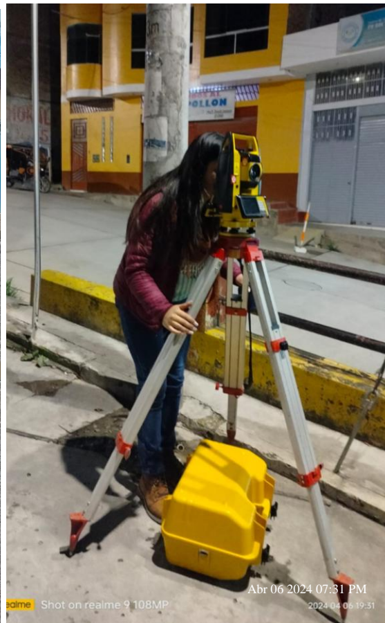
Fotografía 3. Toma de Puntos Topográficos en los Bordes de la Vía, Cunetas Existentes, Postes y Demás Puntos de Interés en el Jr. Exequiel Montoya
