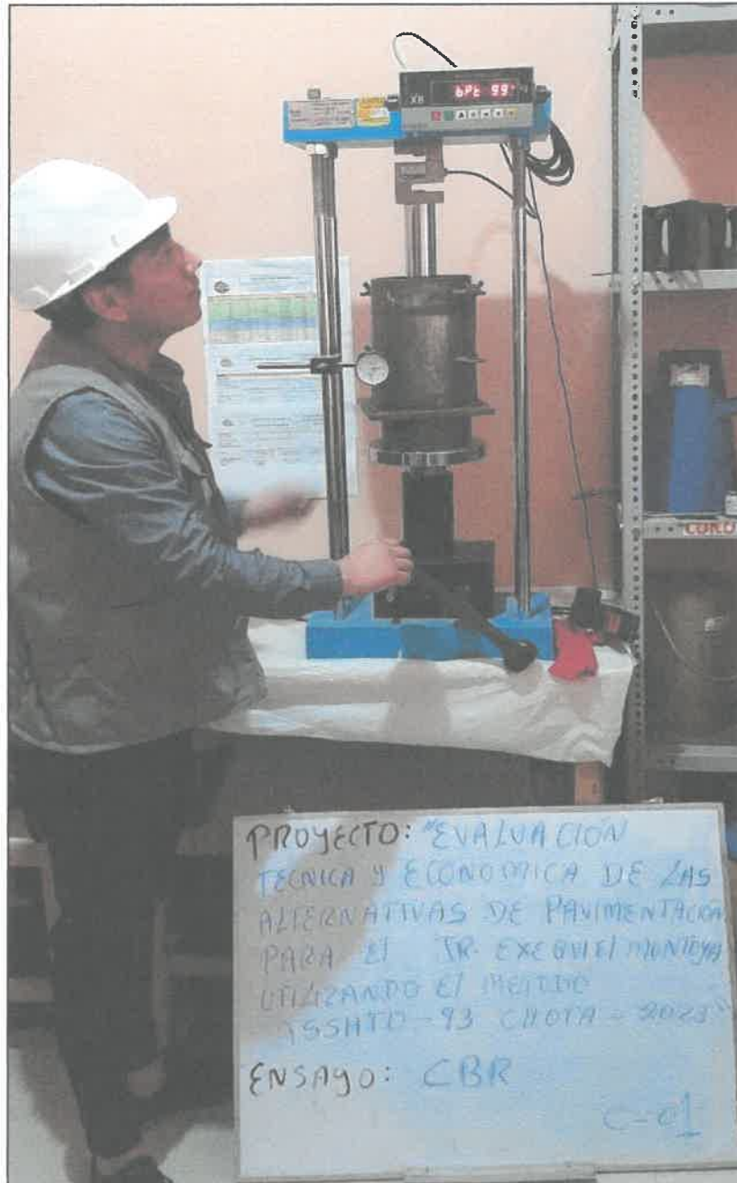
FOTOGRAFIA 09: Muestra el ensayo de CBR de la C - 1, según la Norma (A.S.T.M. D 1883)
