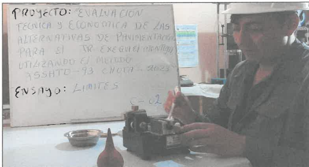
FOTOGRAFIA 06: Muestra el ensayo de Límite Líquido de la C - 2, según la Norma (A.S.T.M. D 4318)
