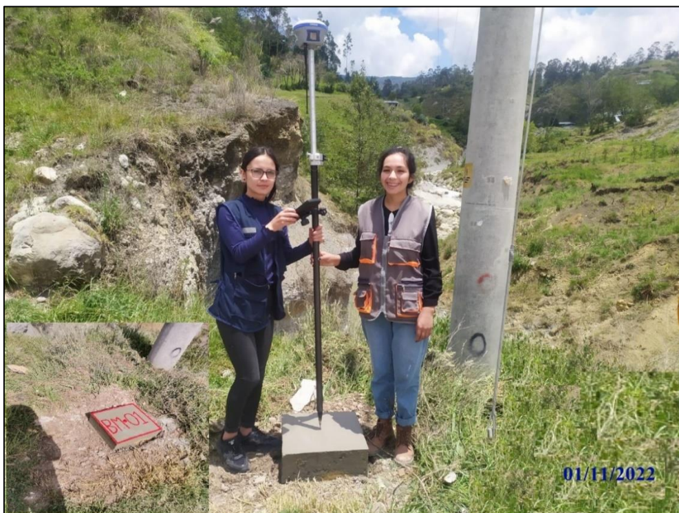
Fotografía 2. Colocación y toma de datos del BM-01 en el punto de inicio (puente de la Laguna del Amor) de la Quebrada Colpamayo.
