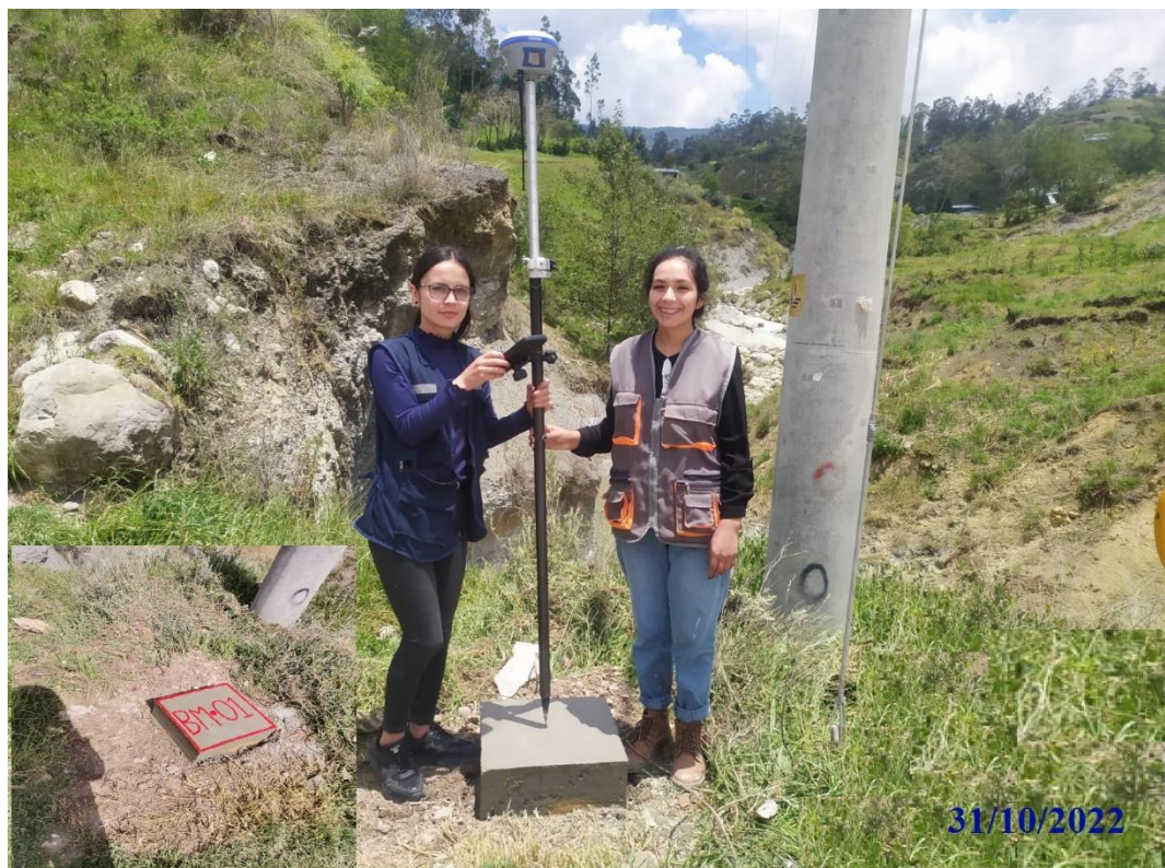
Figura 27 Toma de Coordenadas del BM en la Quebrada Colpamayo Durante el Levantamiento Topográfico
