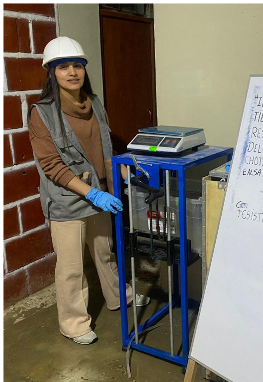
Fotografía 7. Ensayo de peso específico para el agregado grueso de la cantera Chuyabamba
