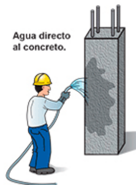
Curado por aspersión (tipo obra)
