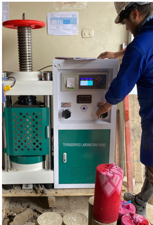
Fotografía 20. Rotura de probetas a compresión que fueron sometidas a curado por aspersión (tipo obra) a los 56 días
