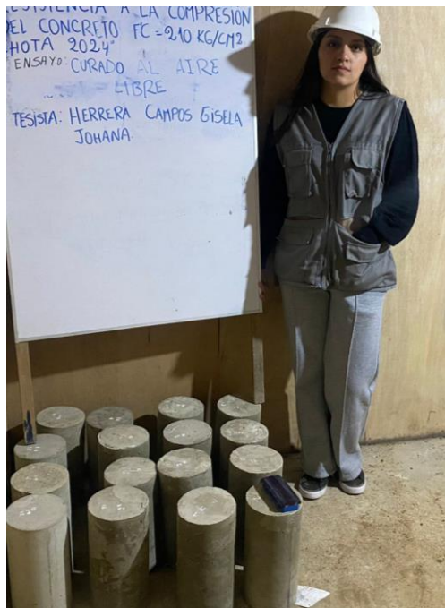
Fotografía 15. Proceso en el que se retira las probetas del método de curado en el que se encontraban para ser sometidas a rotura
