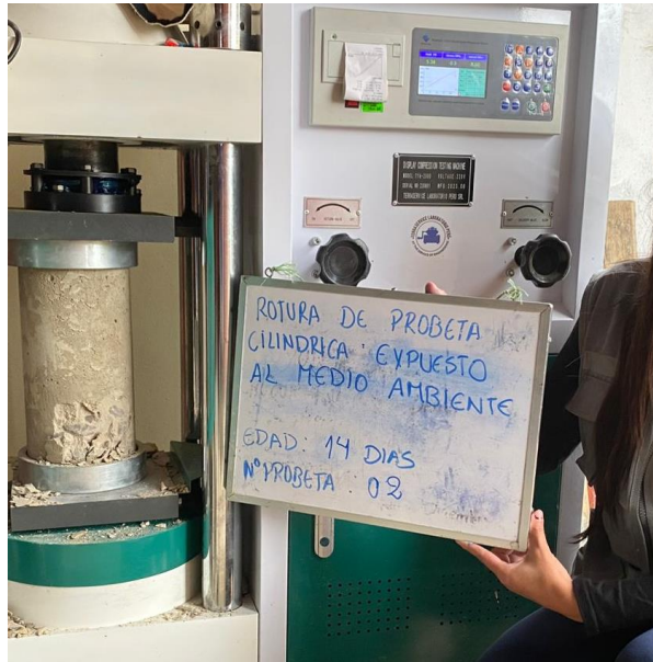
Fotografía 18. Ensayo de resistencia a compresión en las probetas expuestas al medio ambiente a los 14 días
