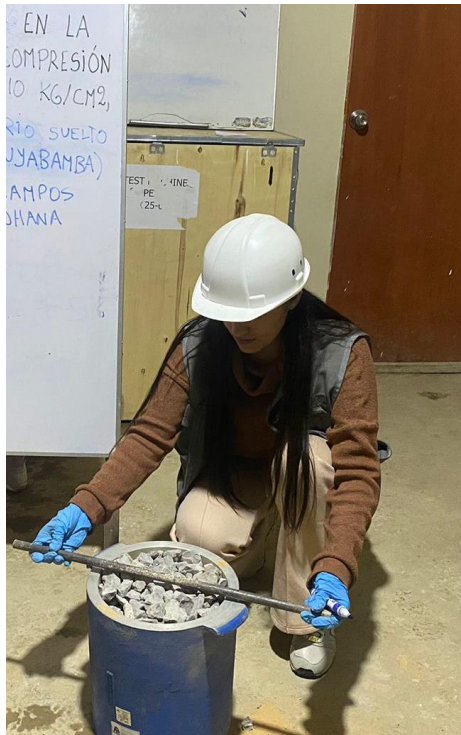
Fotografía 3. Ensayo de peso unitario suelto del agregado grueso de la cantera Chuyabamba
