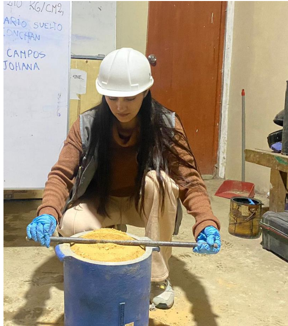
Fotografía 4. Ensayo de peso unitario compactado del agregado grueso de la cantera Chuyabamba
