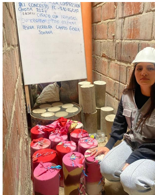
Fotografía 16. Resistencia a compresión en probetas sumergidas por inmersión continua, a los 3 días
