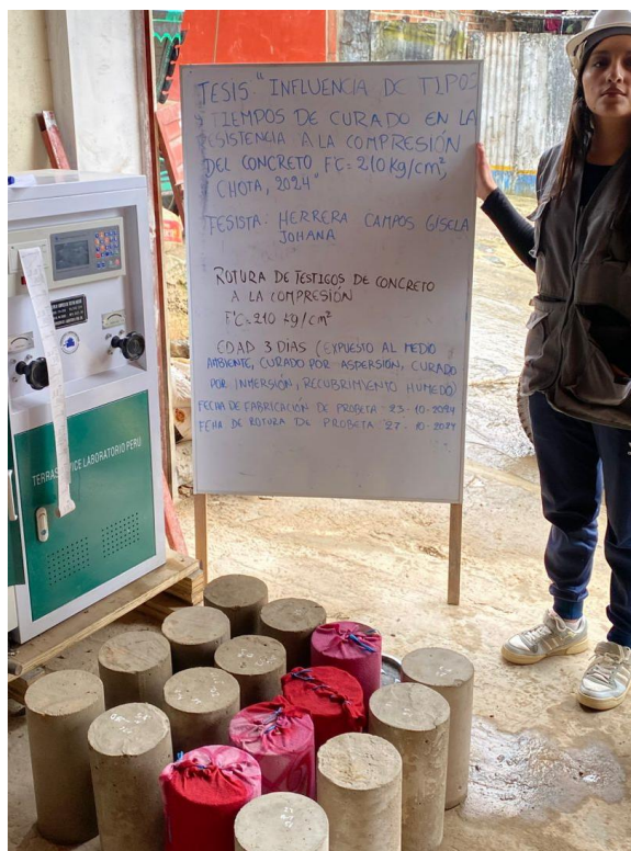
Fotografía 15. Proceso en el que se retira las probetas del método de curado en el que se encontraban para ser sometidas a rotura
