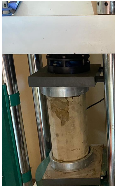
Fotografía 19. Rotura de probetas que fueron sometidas a curado por aspersión (tipo obra) a los 28 días
