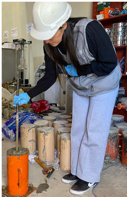
Fotografía 11. Proceso de elaboración de las probetas de concreto
