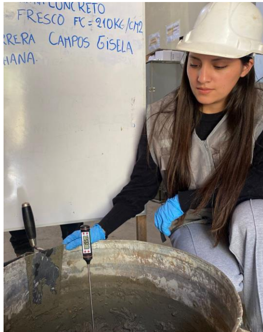
Fotografía 11. Proceso de elaboración de las probetas de concreto
