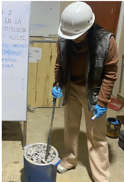
Fotografía 4. Ensayo de peso unitario compactado del agregado grueso de la cantera Chuyabamba
