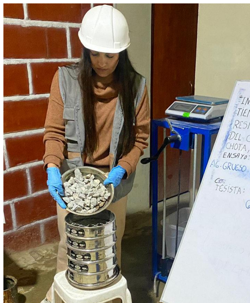
Fotografía 7. Ensayo de peso específico para el agregado grueso de la cantera Chuyabamba
