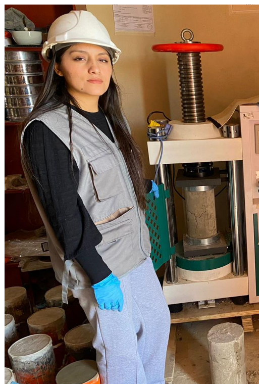
Fotografía 16. Resistencia a compresión en probetas sumergidas por inmersión continua, a los 3 días
