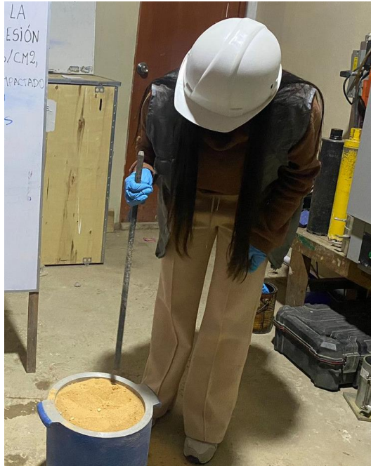
Fotografía 3. Ensayo de peso unitario suelto del agregado grueso de la cantera Chuyabamba
