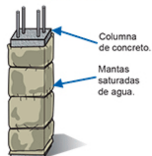
Recubrimiento húmedo (curado con mantos de hilo o frazadas)
