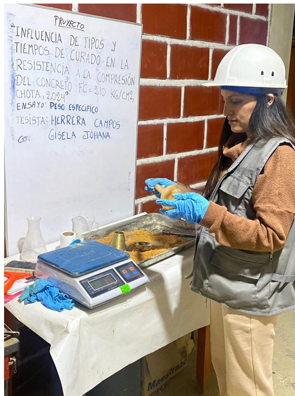
Fotografía 8. Ensayo de peso específico para el agregado fino de la cantera Conchán
