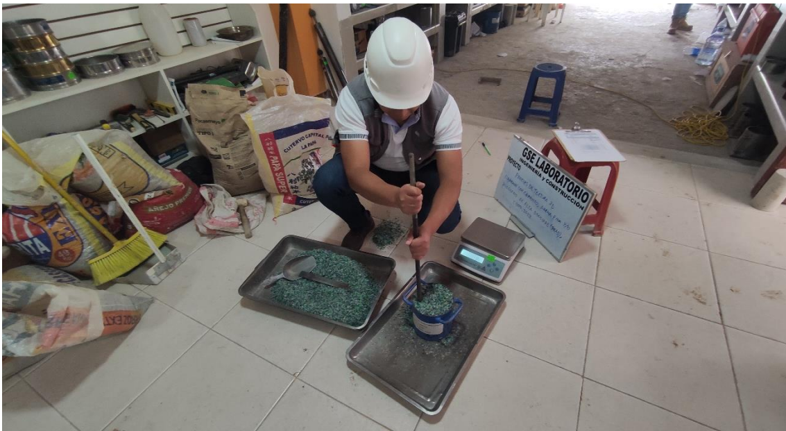
Fotografía 7. Determinación del peso unitario del PEAD
