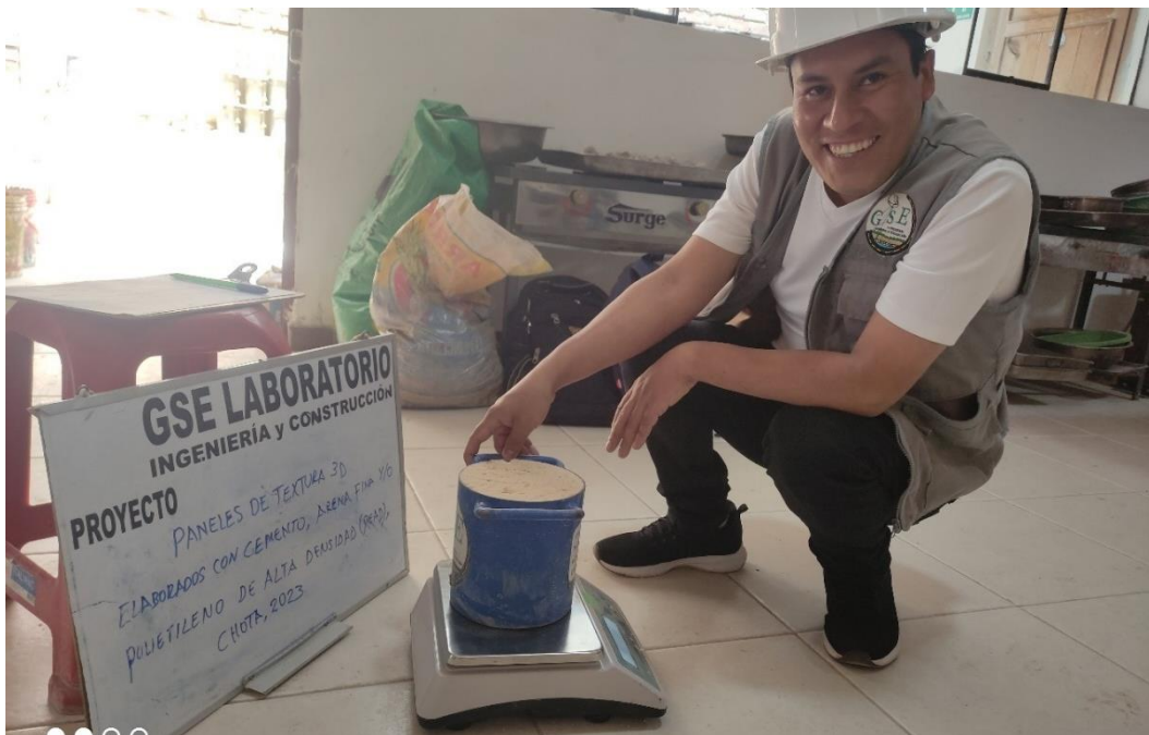
Fotografía 5. Determinación del Peso Unitario Suelto
