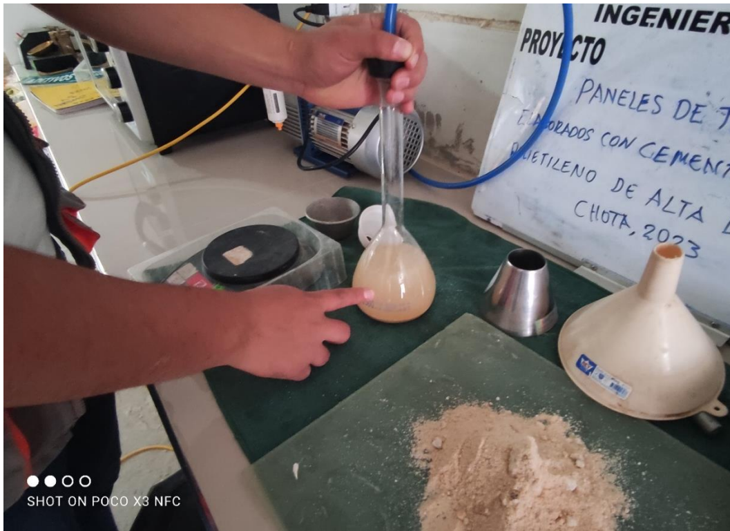
Fotografía 3. Ensayo de Peso Específico y absorción del agregado fino
