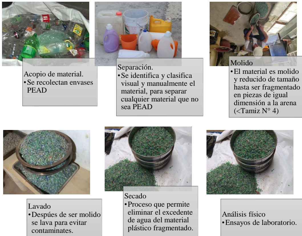
Figura 20 Procesamiento para la Obtención de PEAD triturado
