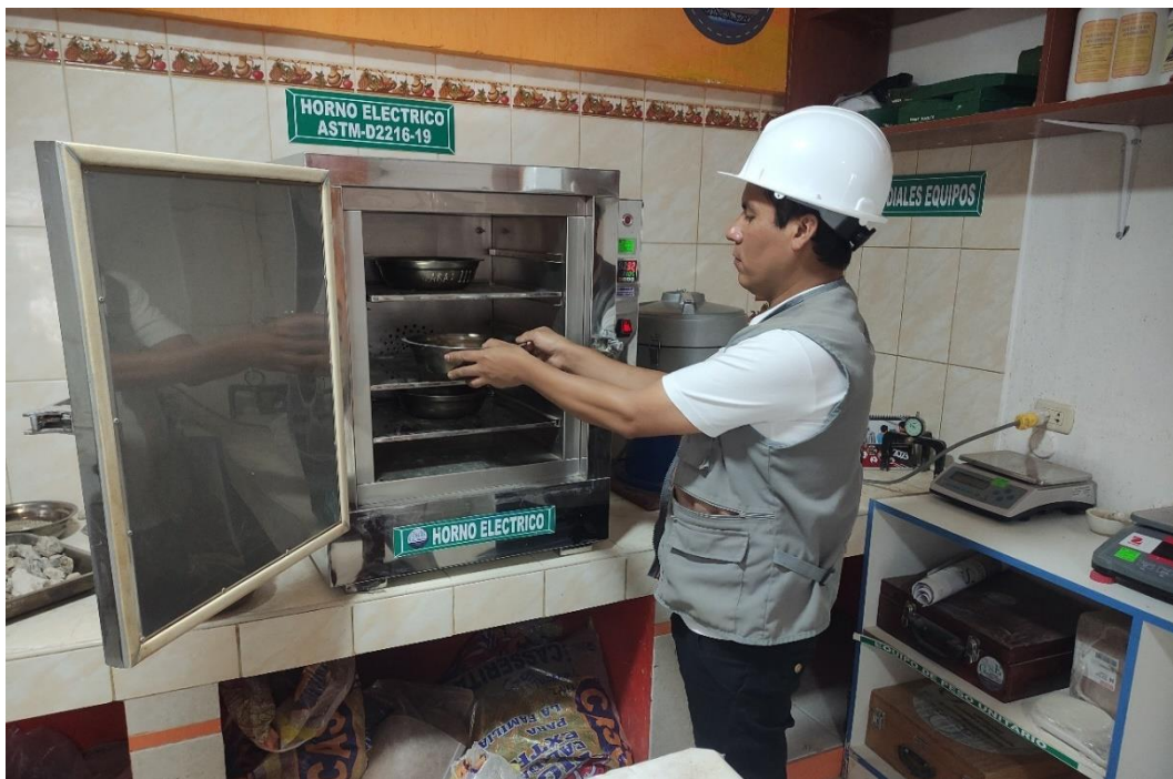
Fotografía 4. Ensayo de Peso Específico y absorción del agregado fino
