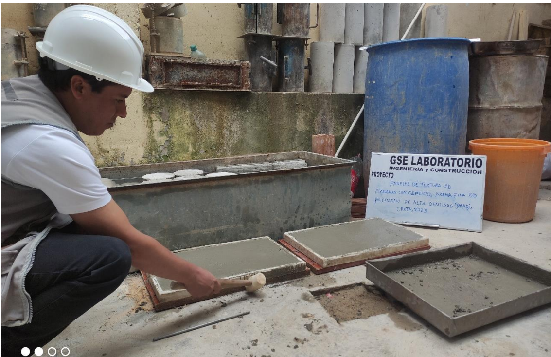
Fotografía 8. Elaboración de paneles
