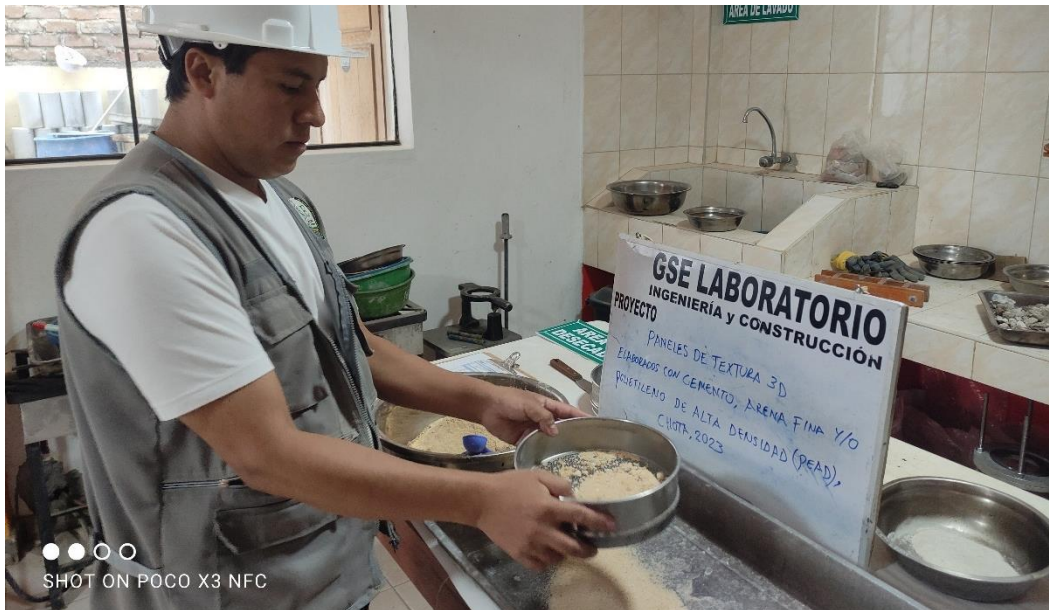
Fotografía 1. Análisis granulométrico del agregado fino
