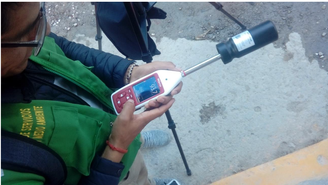
Fotografía N° 2. Calibración del sonómetro
