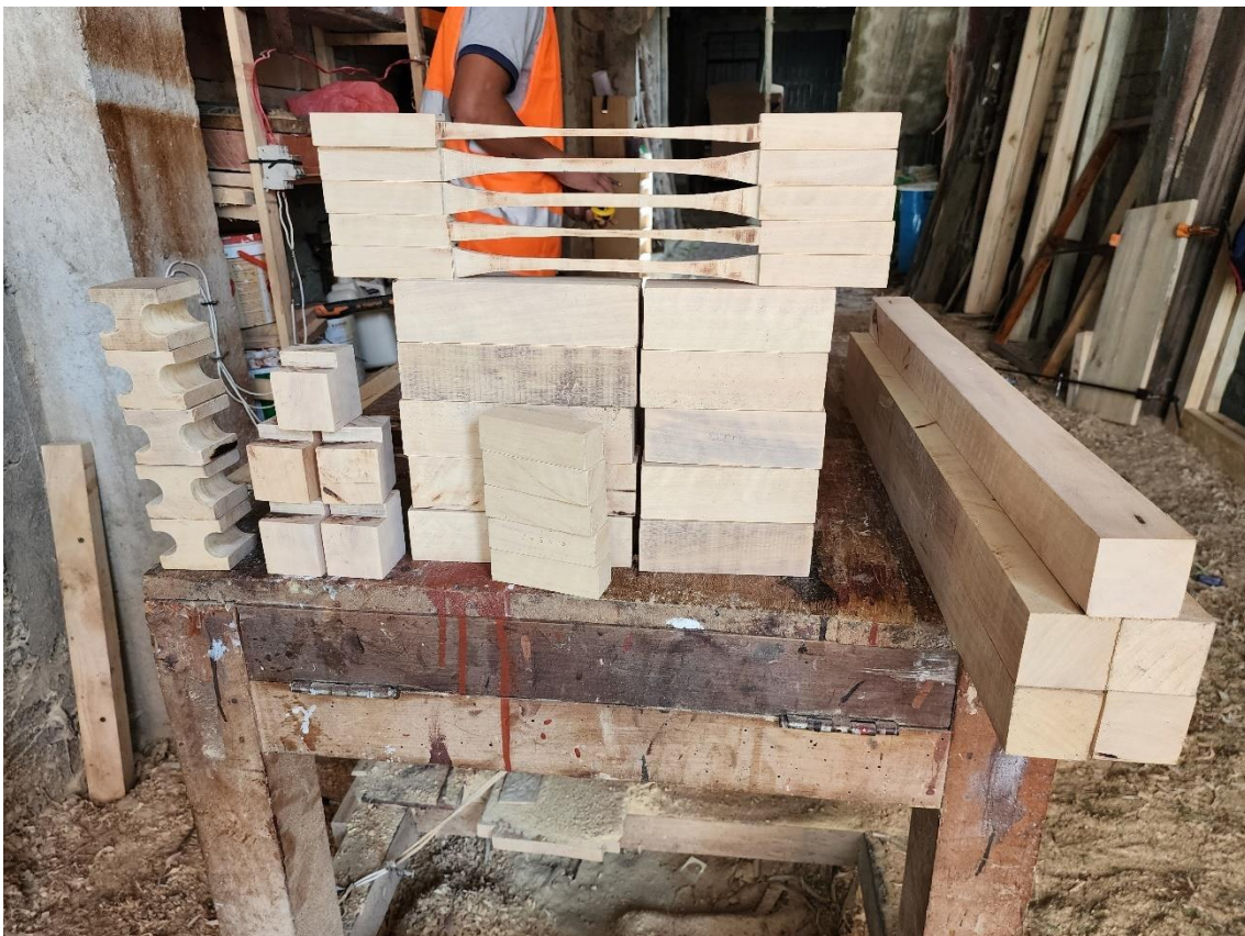
Fotografía 24. Probetas de madera cortadas para ser trasladadas a los respectivos laboratorios
