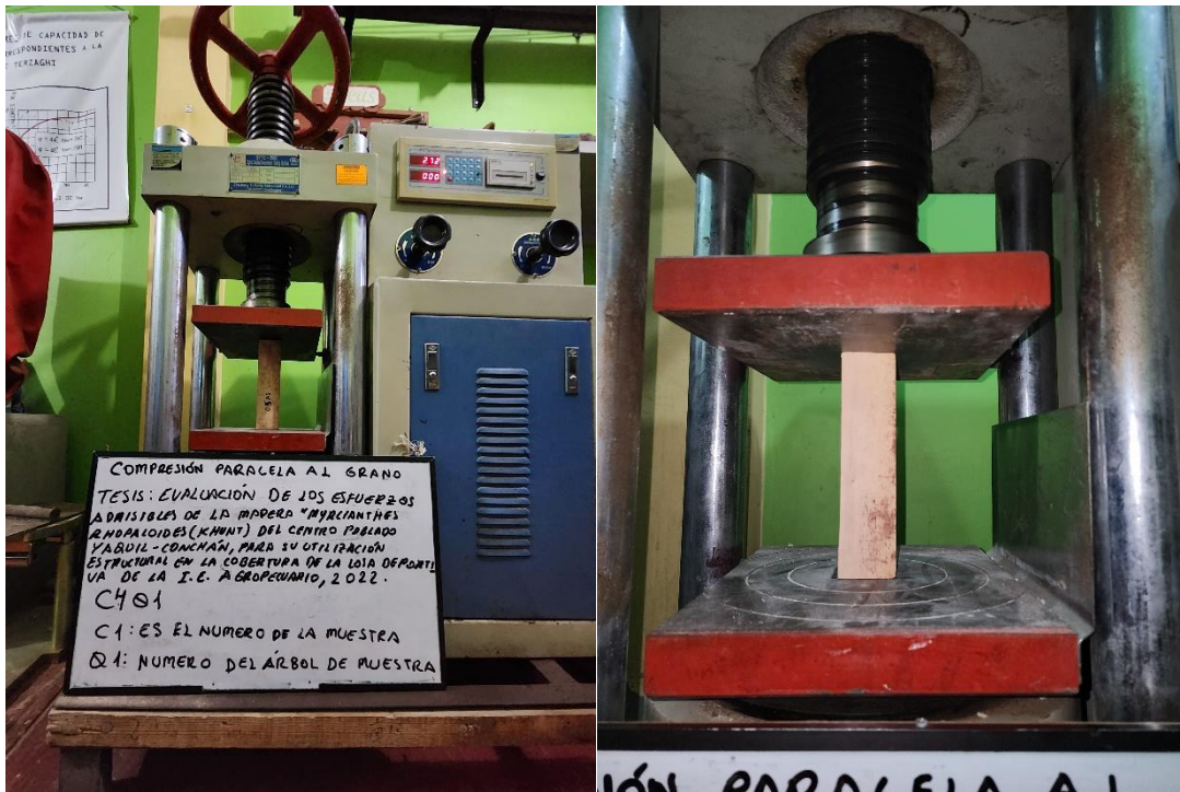
Fotografía 29. Probetas sometidas al ensayo de compresión paralela
