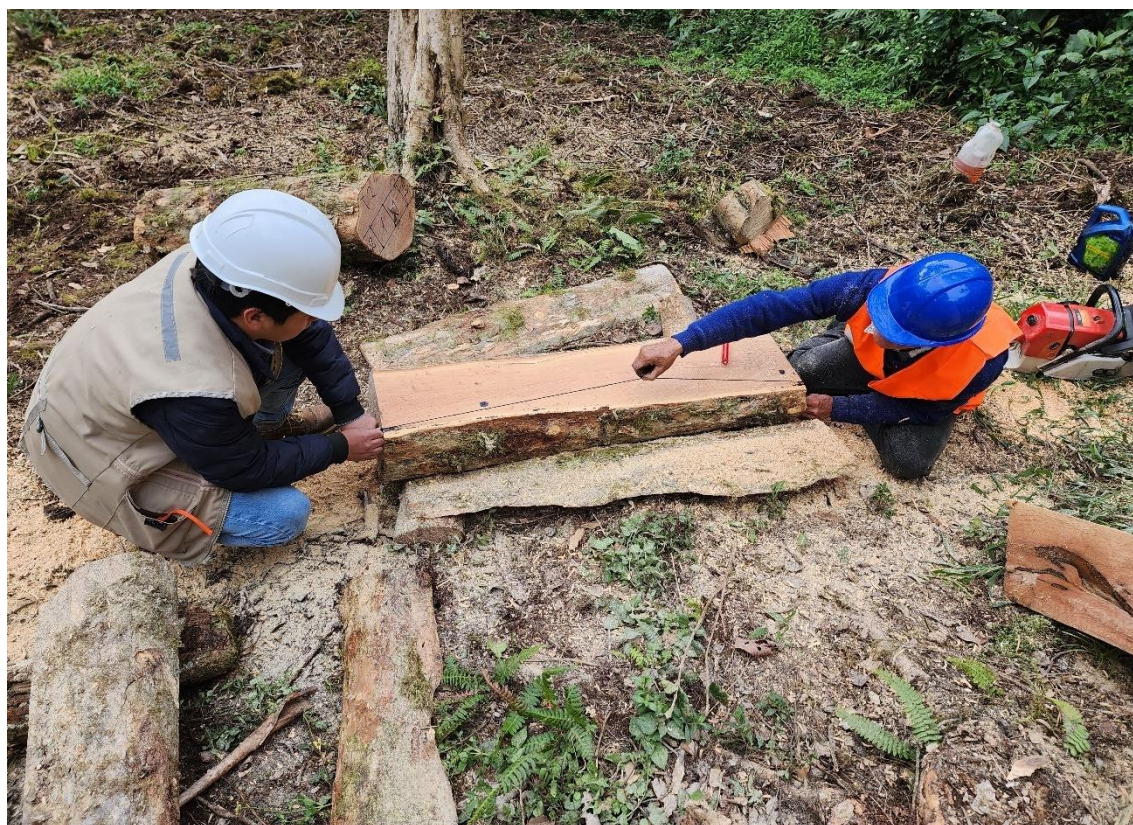
Fotografía 18. Demarcación para el corte de viguetas a partir de las trozas
