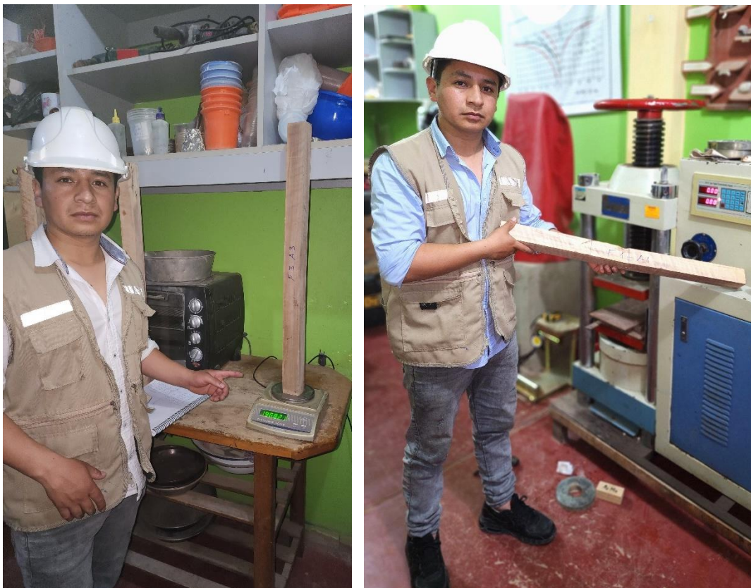
Fotografía 32. Pesado de las probetas para la realización del ensayo de flexión estática
