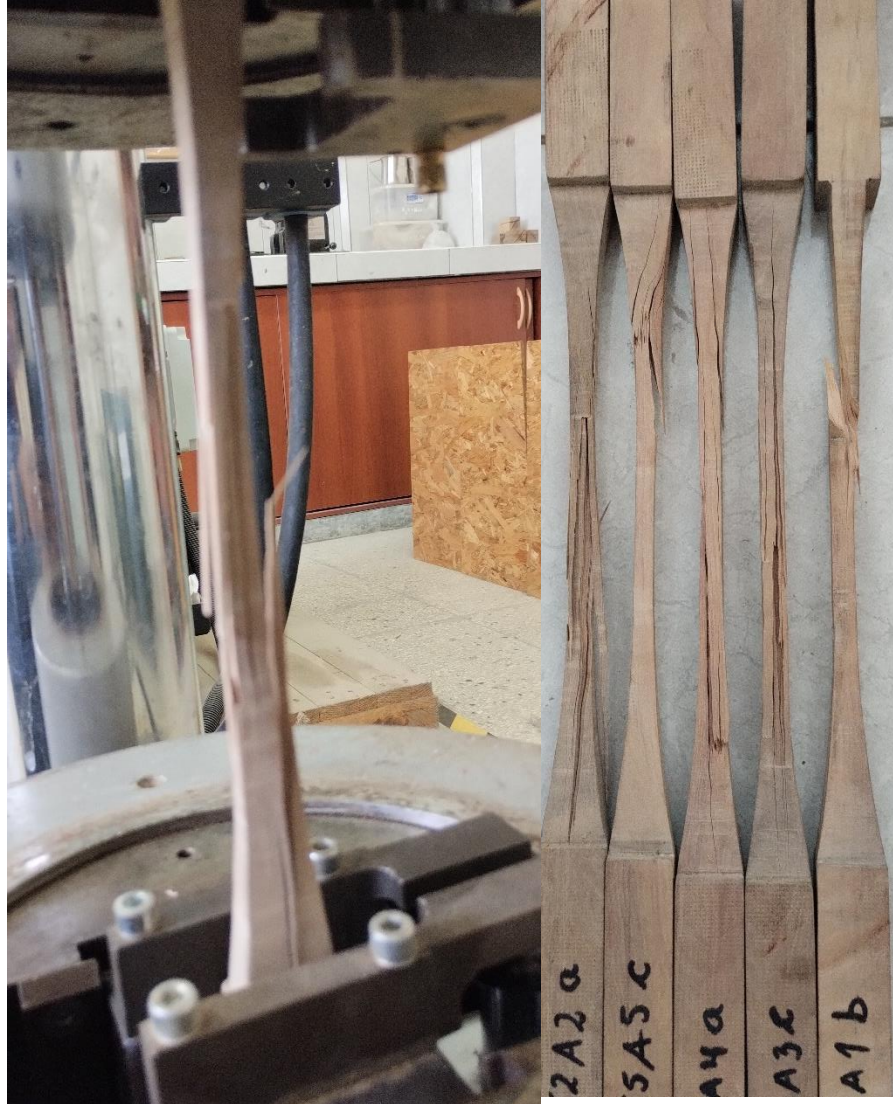
Fig. N°2. Muestras de madera, ensayo de tensión paralela a la fibra Vista frontal
