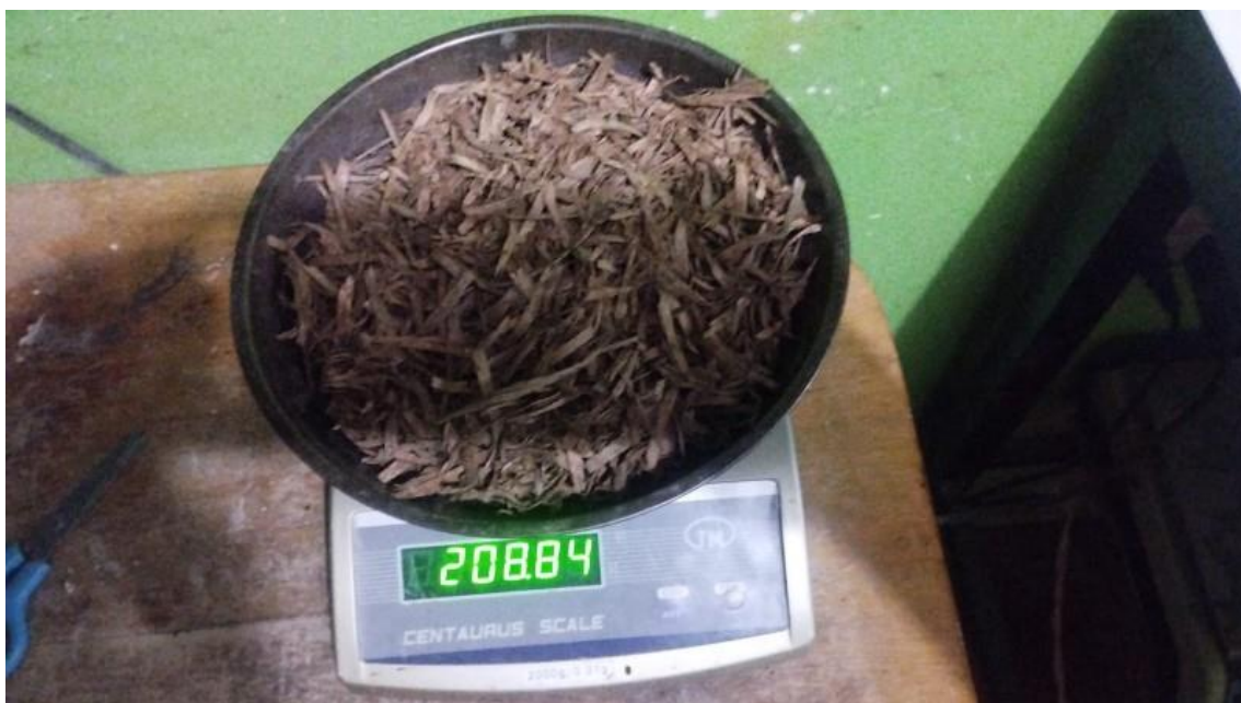
Fotografía 25. Prueba del contenido de humedad en el serrín de la madera
