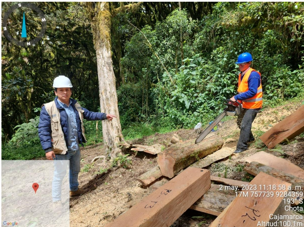
Figura 31 Corte de las Viguetas Obtenidas a Partir de la Troza
