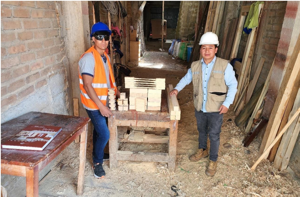
Fotografía 24. Probetas de madera cortadas para ser trasladadas a los respectivos laboratorios
