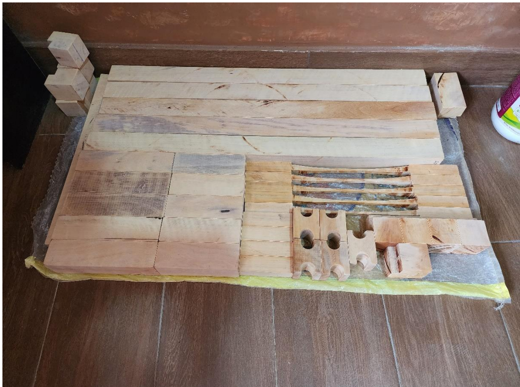
Figura 33 Probetas de la Madera Myrcianthes rhopaloides (Khunt) para los Ensayos Mecánicos
