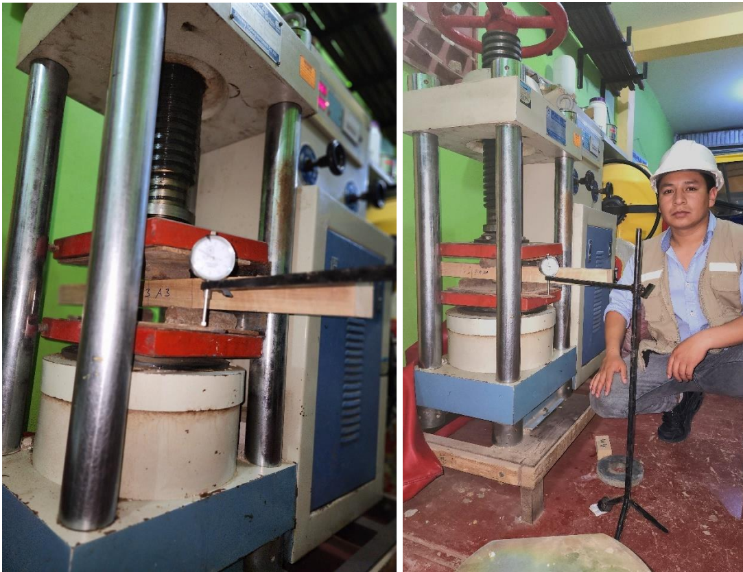
Fotografía 34. Probetas en el laboratorio de la Universidad Nacional de Trujillo previo a la realización de los ensayos mecánicos
