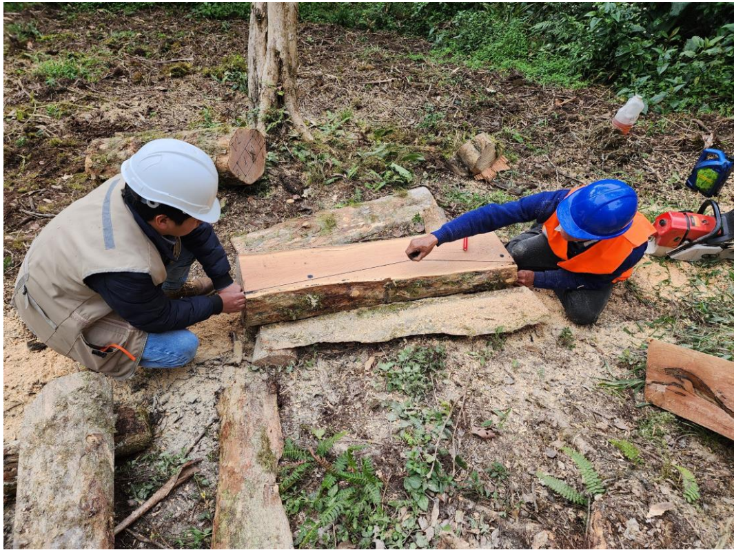
Figura 31 Corte de las Viguetas Obtenidas a Partir de la Troza
