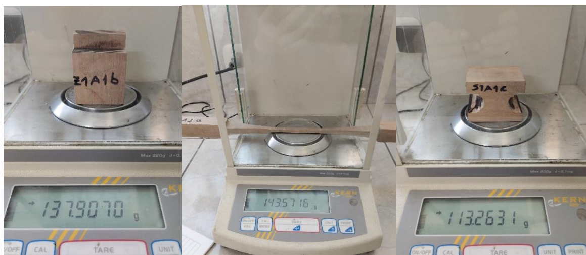
Fig. N°6. Ejemplos de toma de masa de muestras de madera.
