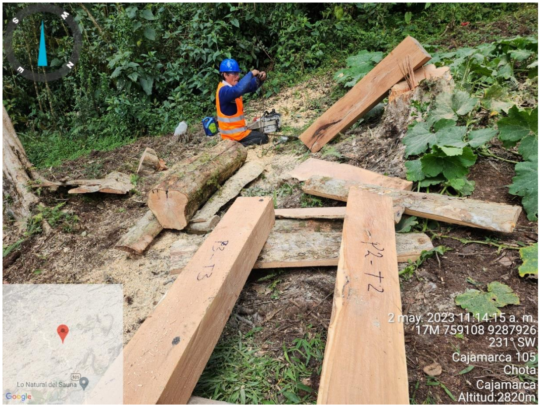
Fotografía 21. Codificación de las viguetas obtenidas de la madera
