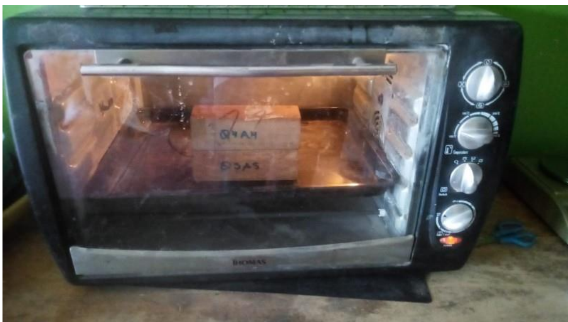
Fotografía 26. Prueba del contenido de humedad en las probetas de madera
