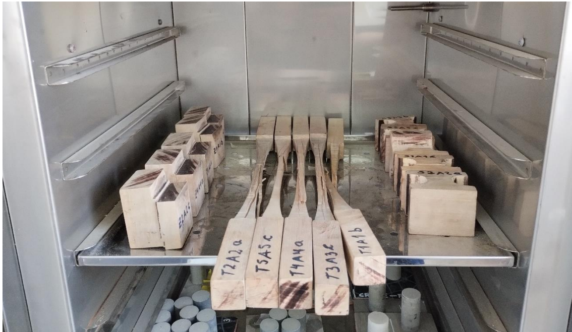
Fig. N°5. Muestras de madera, secado de muestras después de ensayos.
