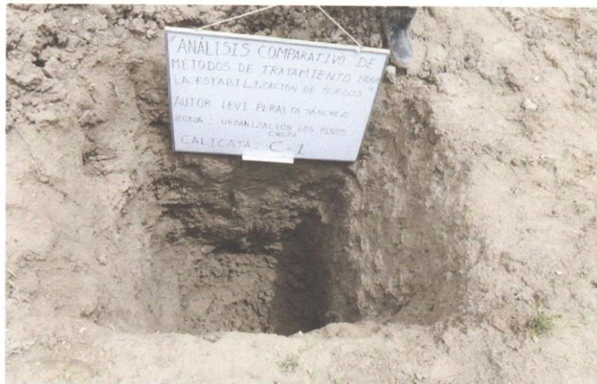
Fotografía N° 02: Perfil Estratigráfico - Calicata N° 01
