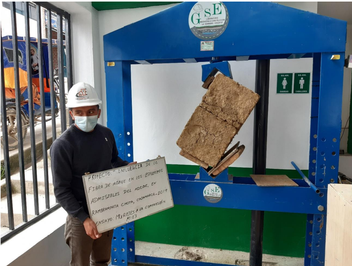
Fotografía 15. Ensayo de compresión diagonal en muretes
