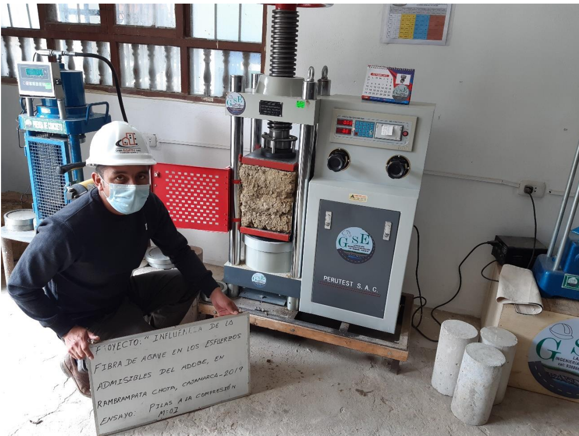
Fotografía 14. Ensayo de compresión axial en pilas de adobe
