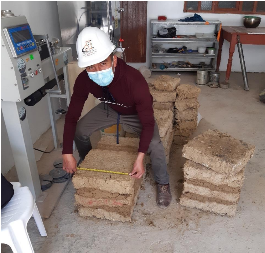
Fotografía 14. Ensayo de compresión axial en pilas de adobe
