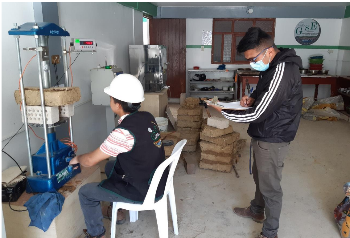
Fotografía 12. Ensayo de resistencia a flexión en adobes
