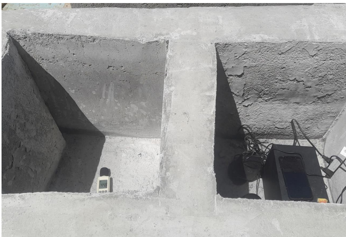
Fotografía 34 Vista de los equipos de sonido utilizados para el ensayo de aislamiento acústico
