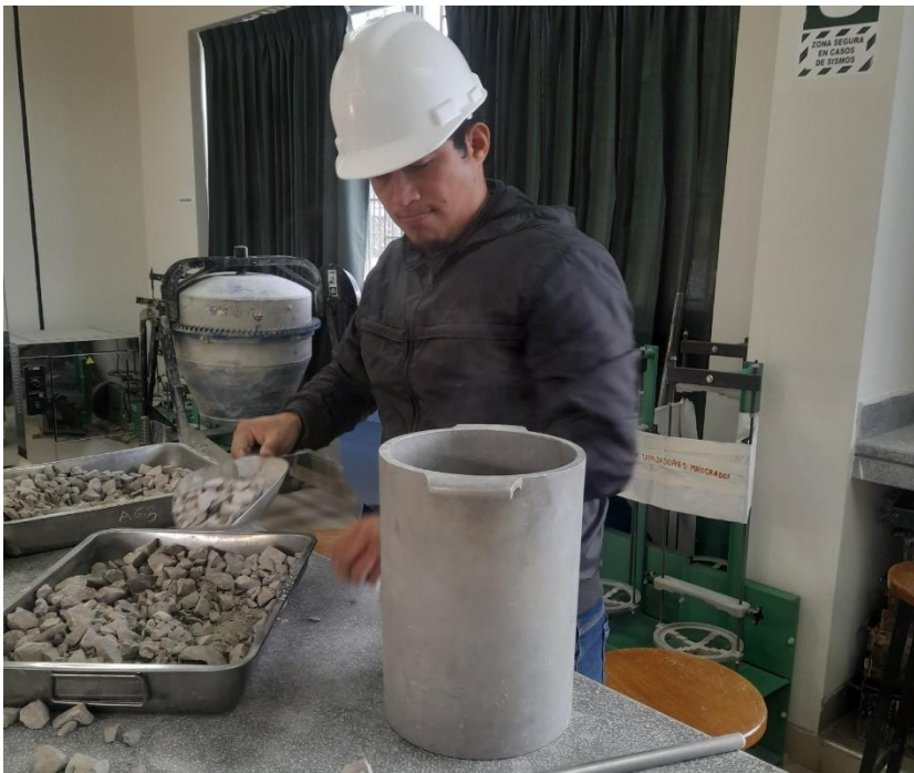
Fotografía 10 Ensayo de peso unitario en el caucho granular
