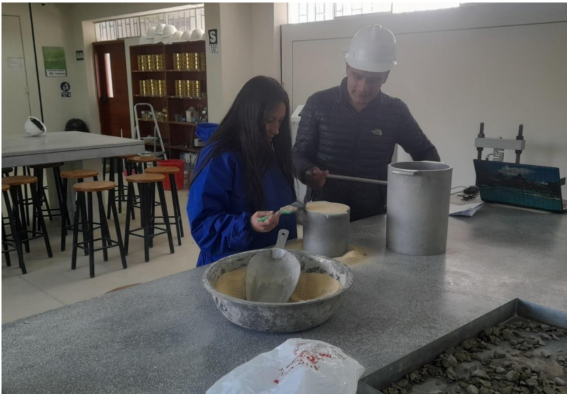
Fotografía 8 Ensayo del peso unitario compactado del agregado fino en presencia de la encargada de laboratorio
