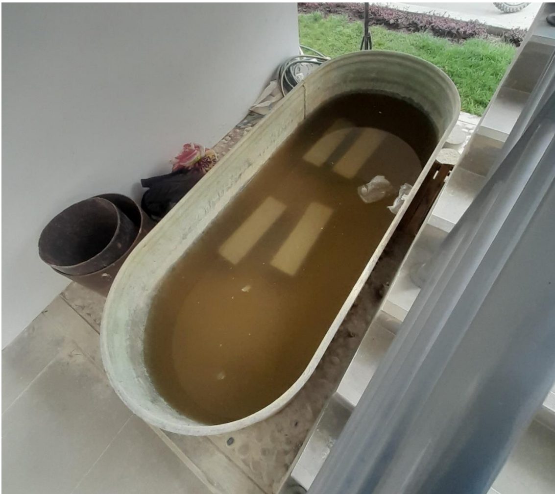
Fotografía 16 Curado de especímenes prismáticos para ensayos a flexión en concreto
