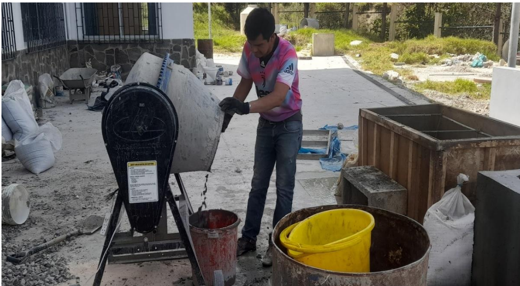
Fotografía 28 Colocación de la mezcla de concreto con caucho granular para la elaboración de modelos a escala
