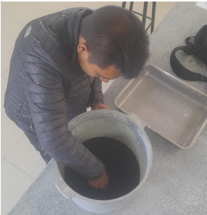
Fotografía 10 Ensayo de peso unitario en el caucho granular
