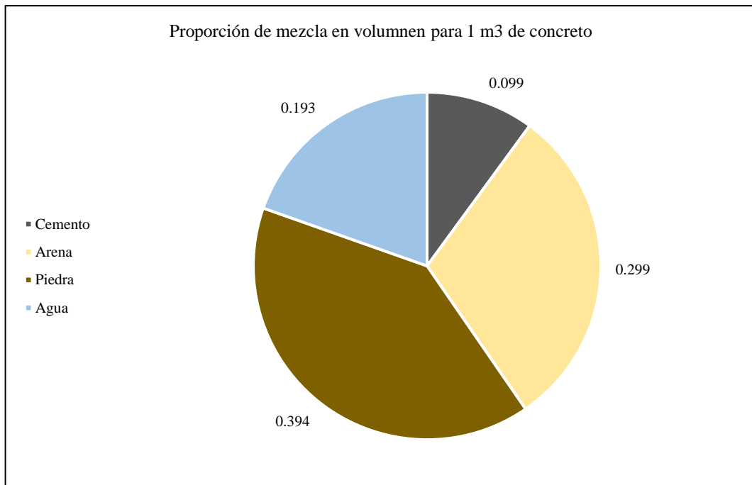
Proporción de Mezcla en Volumen para 1 m 3 de Concreto F'c 175 kg/cm 2
