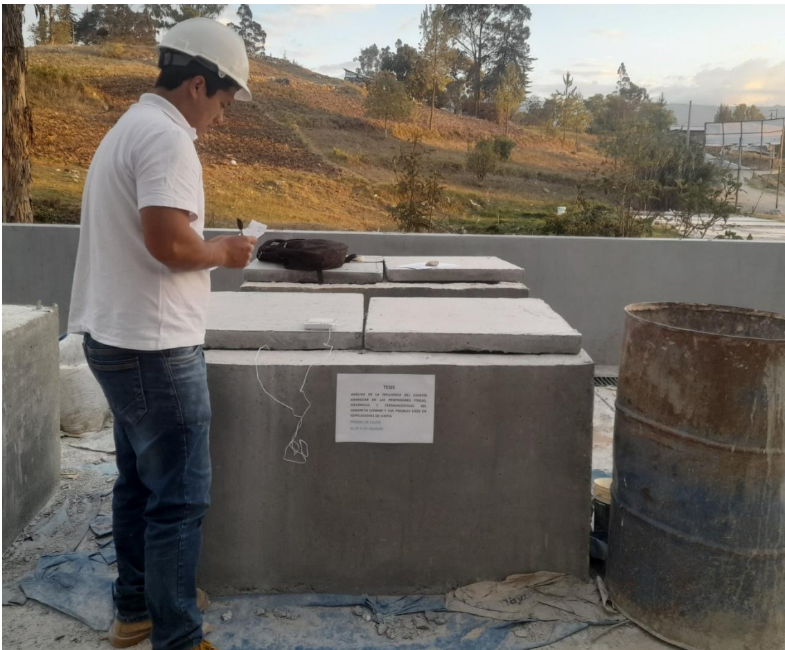
Fotografía 32 Realización del ensayo de aislamiento acústico en los modelos a escala de concreto con caucho granular
