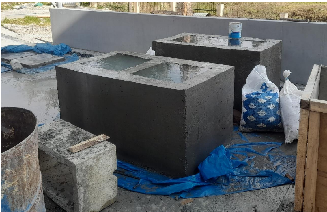
Fotografía 30 Modelos a escala de concreto con caucho granular pasando por proceso de curado
