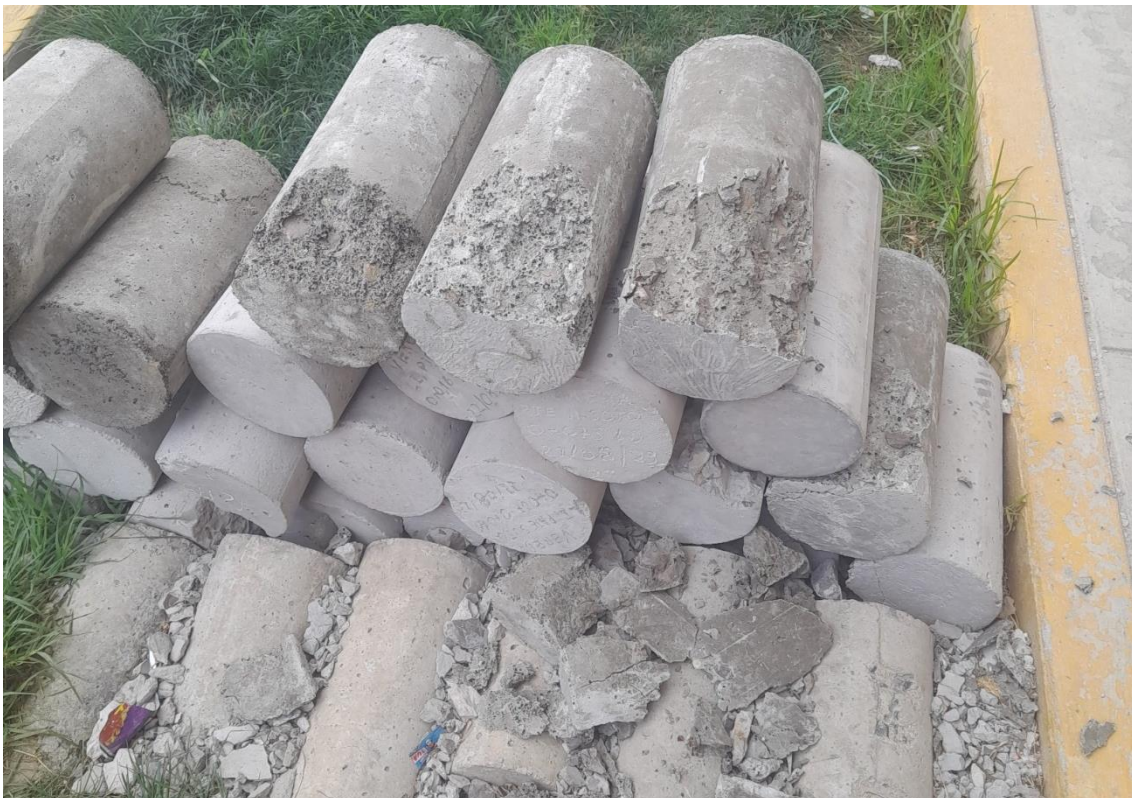
Fotografía 24 Probetas luego de ser sometidas a la máquina de rotura para el ensayo de compresión a los 28 días
