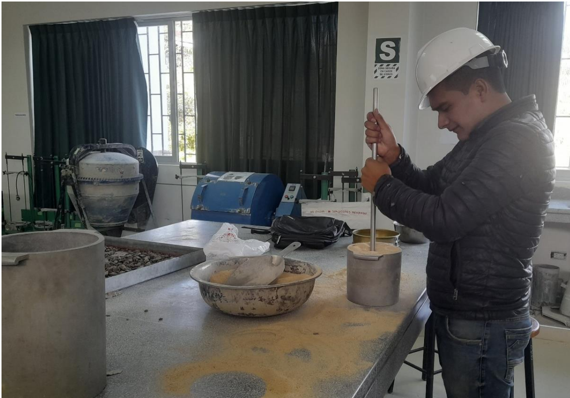
Fotografía 8 Ensayo del peso unitario compactado del agregado fino en presencia de la encargada de laboratorio
