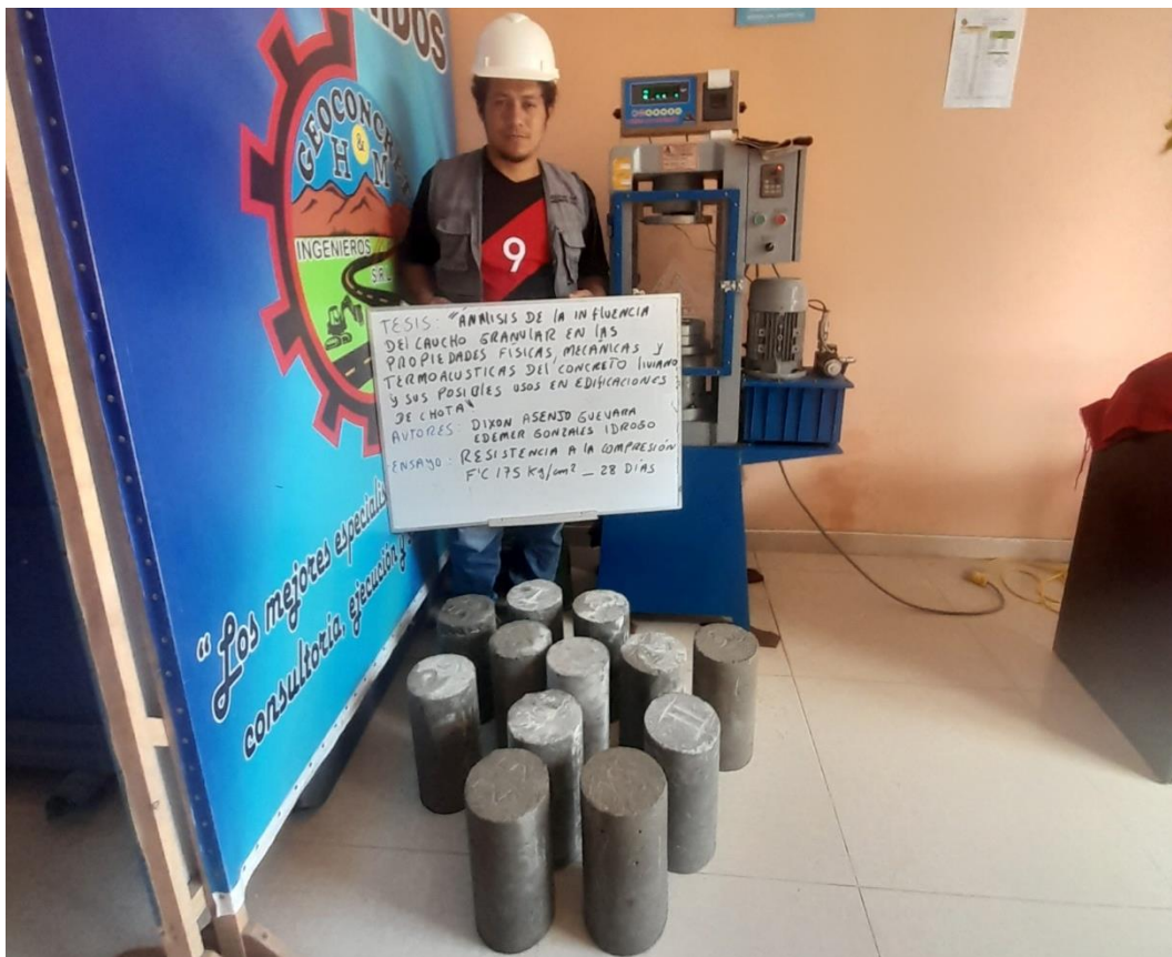
Fotografía 22 Probeta sometida al ensayo de resistencia a la compresión a los 28 días
