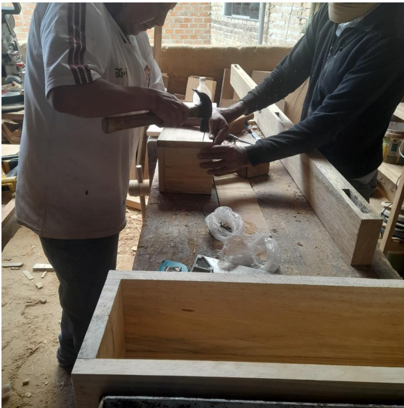
Fotografía 26 Encofrados de madera armados para la elaboración de los modelos: Estructuras a escala
