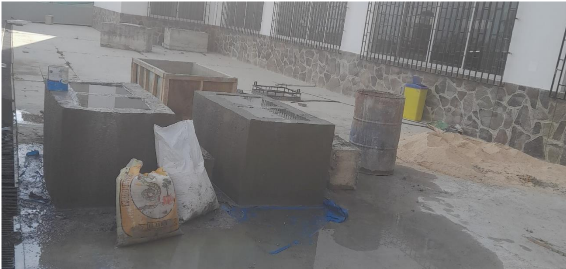
Fotografía 32 Realización del ensayo de aislamiento acústico en los modelos a escala de concreto con caucho granular
