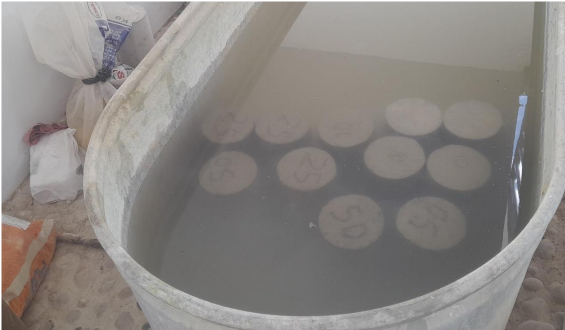
Fotografía 18 Verificación del proceso de curado de los especímenes por el co - asesor de la investigación
