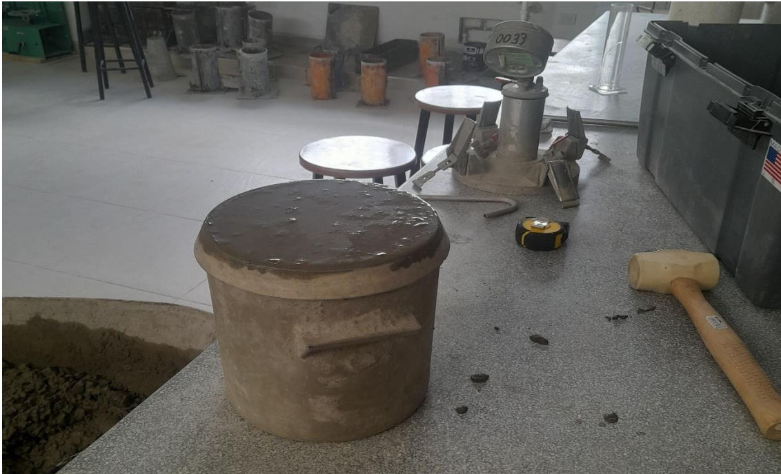
Fotografía 12 Ensayo de temperatura del concreto en estado fresco
