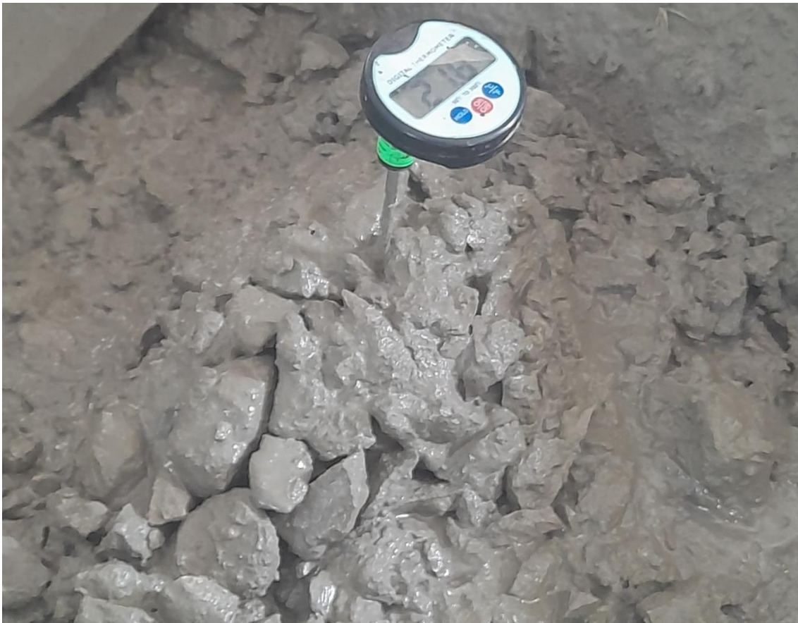
Fotografía 12 Ensayo de temperatura del concreto en estado fresco
