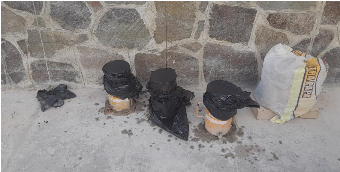
Fotografía 16 Curado de especímenes prismáticos para ensayos a flexión en concreto
