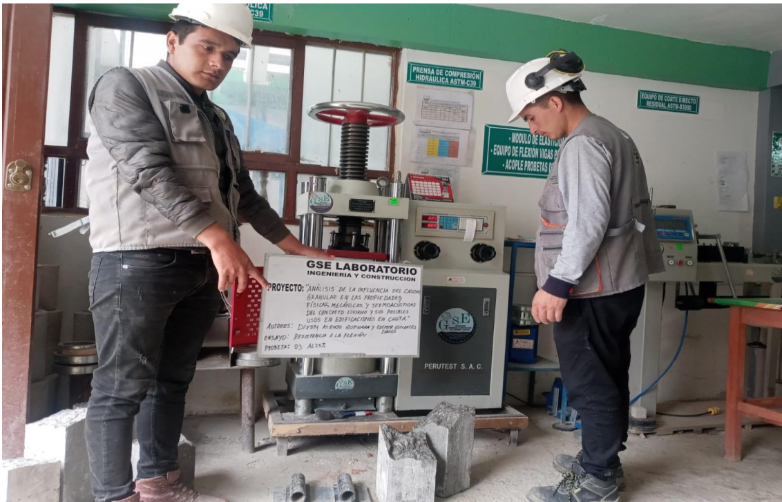
Fotografía 24 Probetas luego de ser sometidas a la máquina de rotura para el ensayo de compresión a los 28 días
