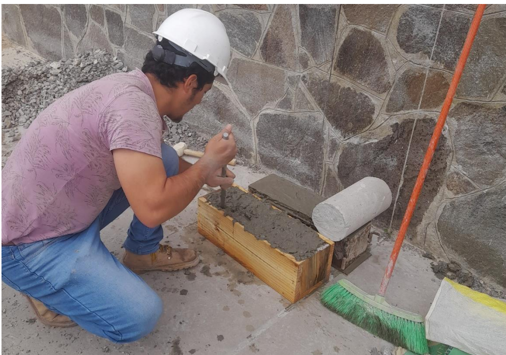
Fotografía 14 Colocación de la mezcla en los moldes de madera para la formación de especímenes prismáticos de concreto
