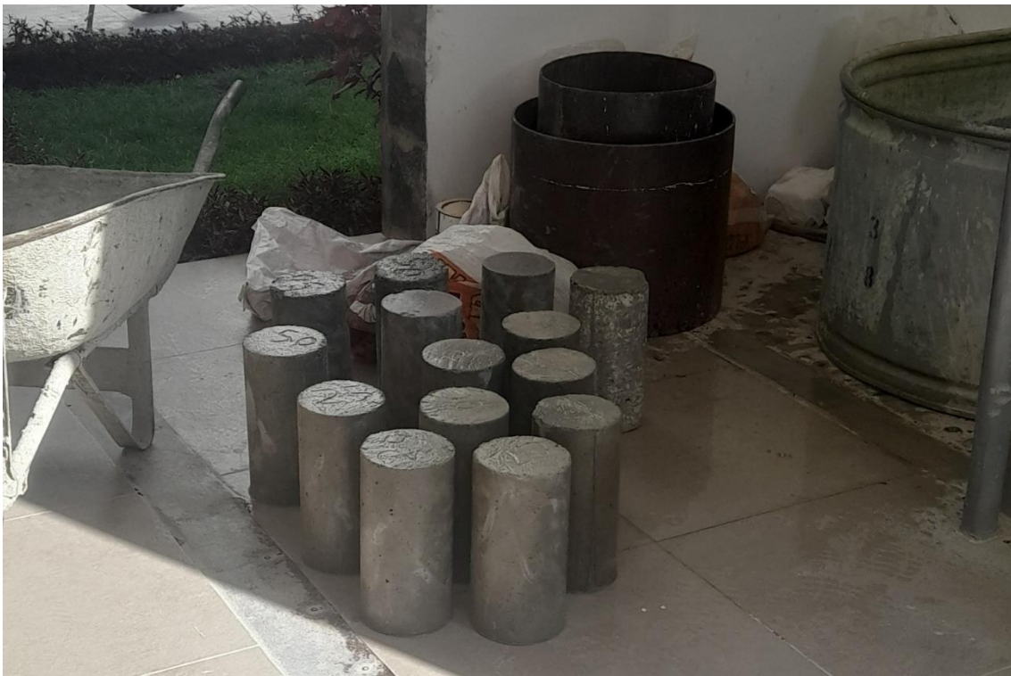
Fotografía 20 Traslado de las probetas de concreto hacia los respectivos laboratorios donde se han realizado los ensayos de compresión y flexión
