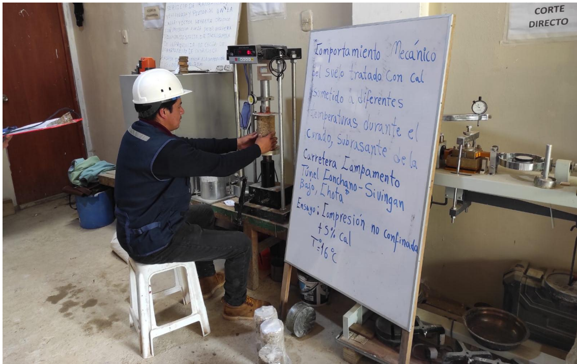
Fotografía 24. Realización de ensayo a compresión no confinada al suelo cal a temperatura de 4 °C
