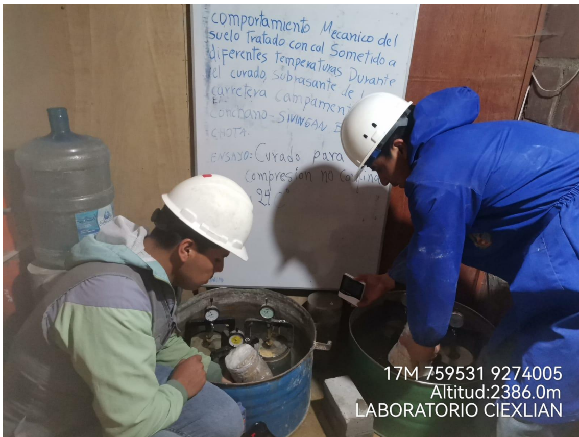
Fotografía 26. Curado y control de temperatura de las probetas de suelo – cal
