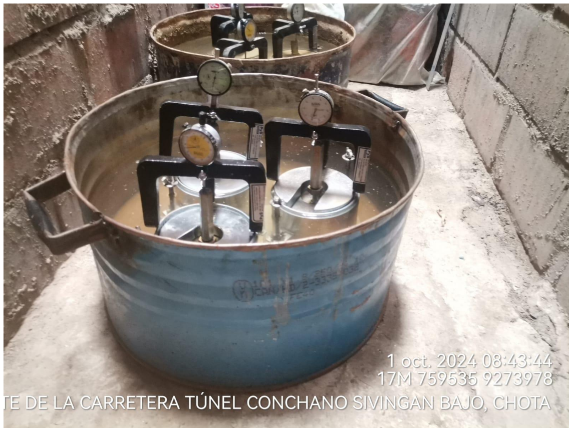
Fotografía 18. Preparación de muestras para ensayo de compresión no confinada
