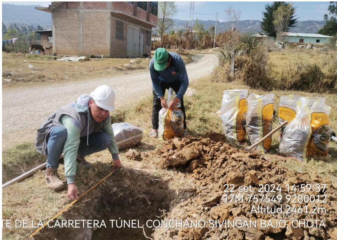
Fotografía 10. Toma de muestra en la calicata 2 (C2) en la carretera Campamento Túnel Conchano – Sivingan Bajo
