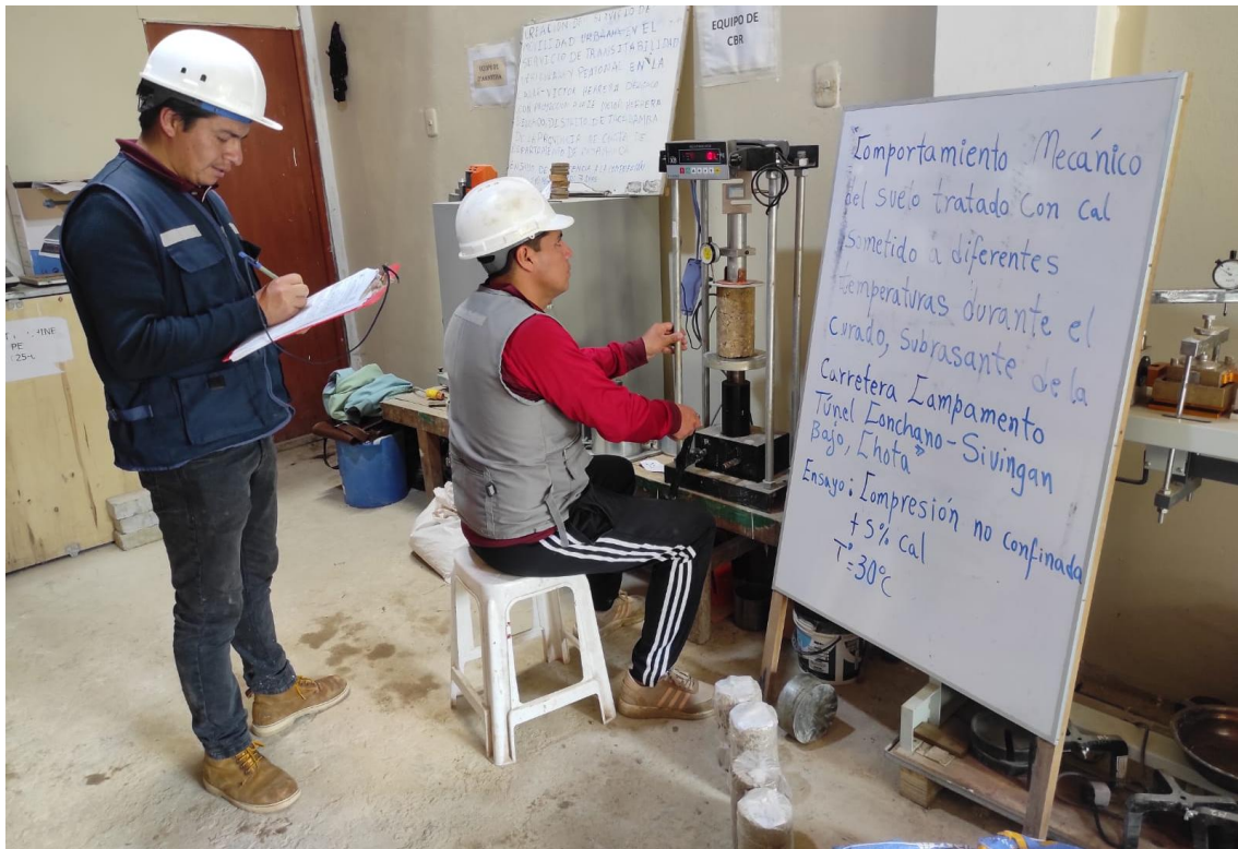
Fotografía 22. Realización de ensayo a compresión no confinada al suelo cal a temperatura de 24 °C
