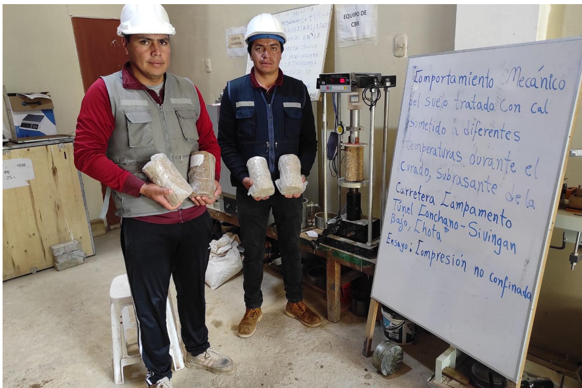
Fotografía 20. Muestras para ensayo a compresión no confinada: Suelo cal sometido a diferentes temperaturas
