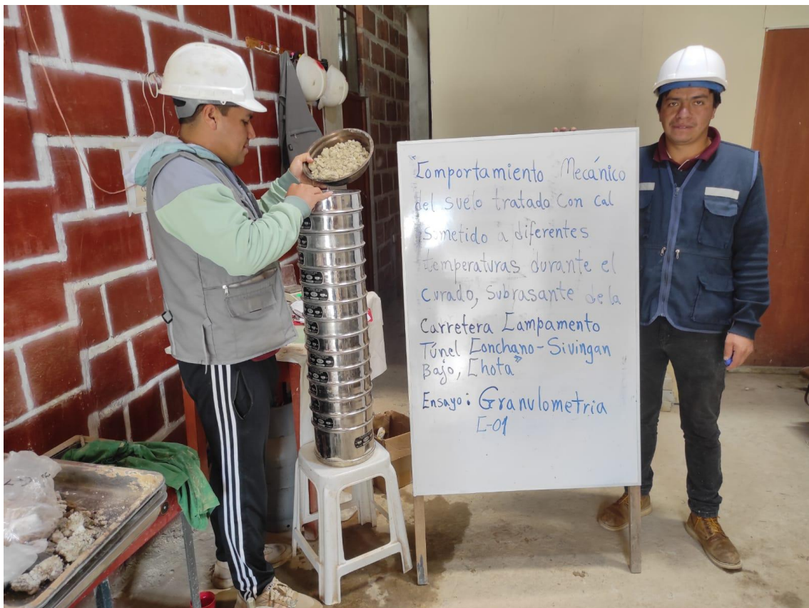
Fotografía 12. Realización del ensayo de granulometría del suelo
