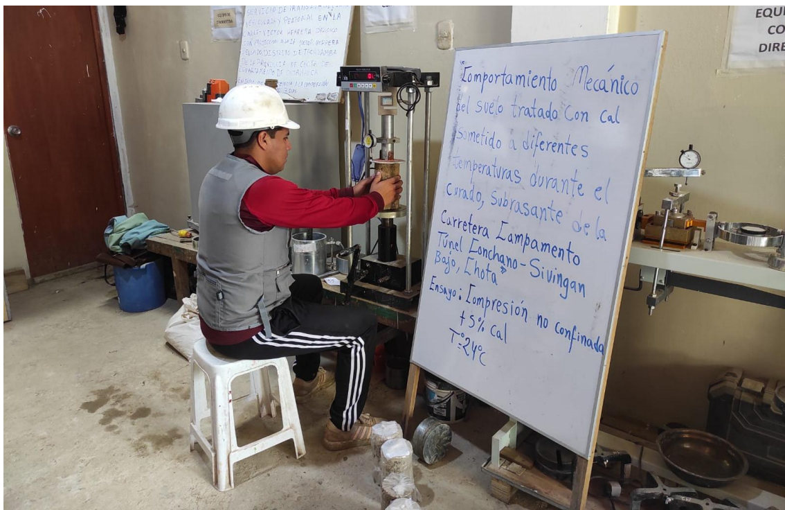
Fotografía 22. Realización de ensayo a compresión no confinada al suelo cal a temperatura de 24 °C
