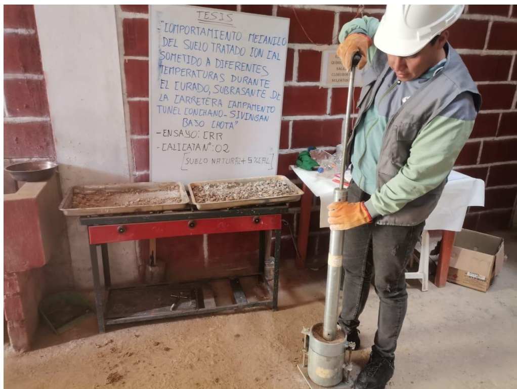
Ensayo de CBR al Suelo con Cal
