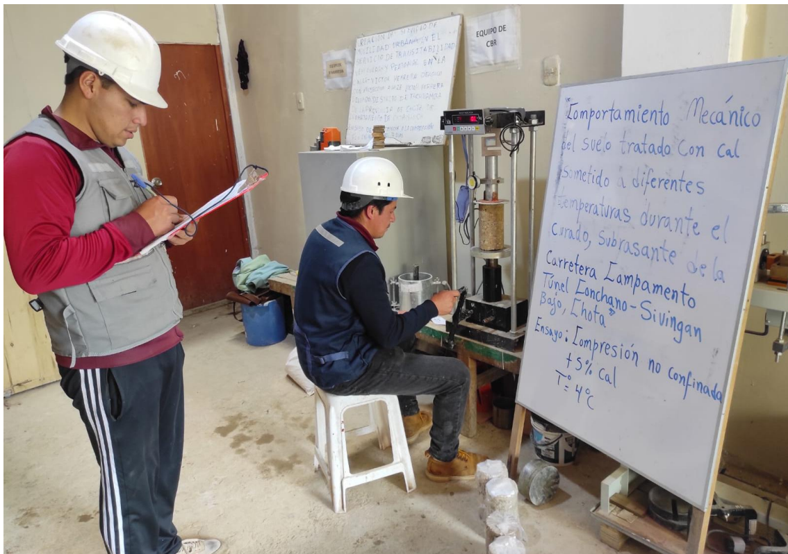
Fotografía 24. Realización de ensayo a compresión no confinada al suelo cal a temperatura de 4 °C
