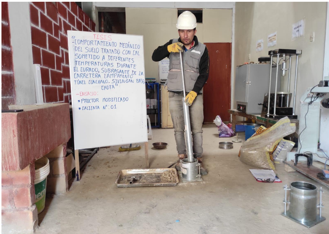
Fotografía 14. Realización del ensayo de Proctor modificado del suelo
