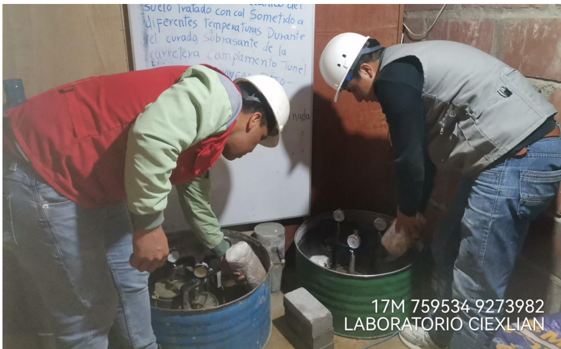
Fotografía 26. Curado y control de temperatura de las probetas de suelo – cal
