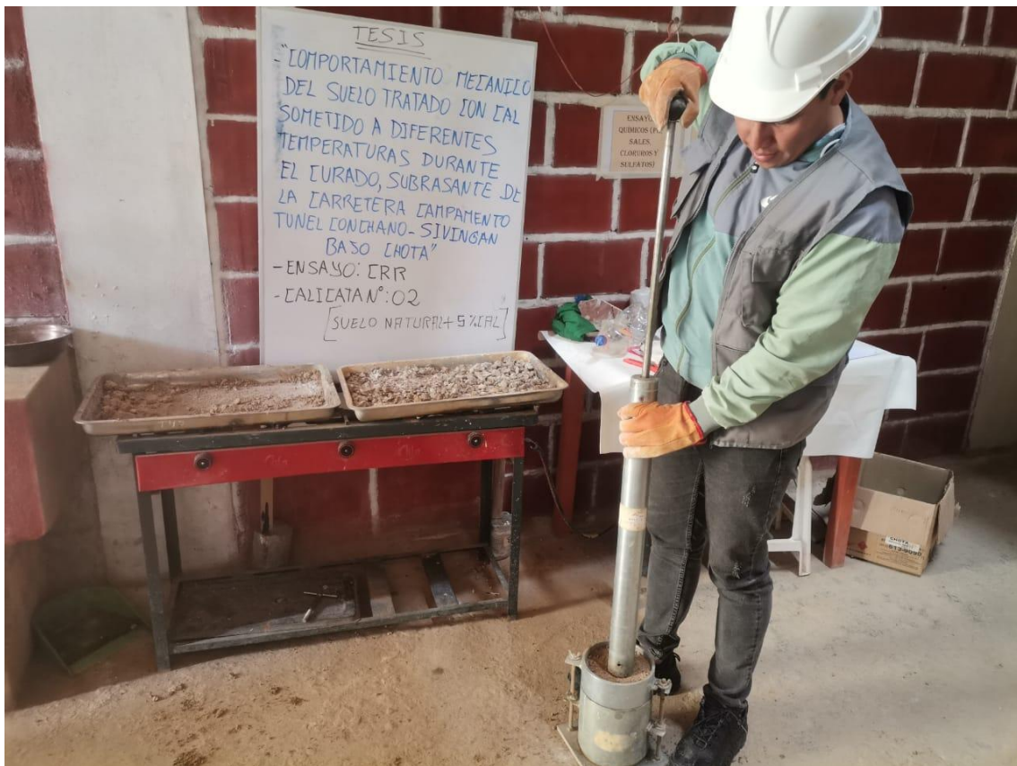
Fotografía 16. Realización del ensayo de CBR del suelo: Compactación del suelo
