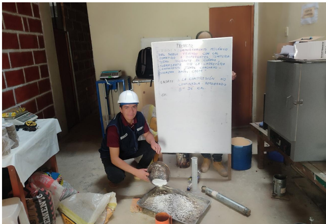
Fotografía 18. Preparación de muestras para ensayo de compresión no confinada
