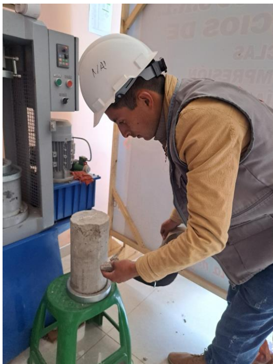
Fotografía 37. Probeta de concreto luego del ensayo de compresión
