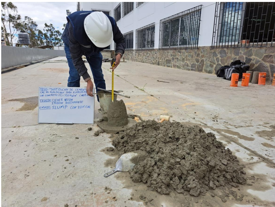
Fotografía 19. Slump de la mezcla de concreto con 20% de cal
