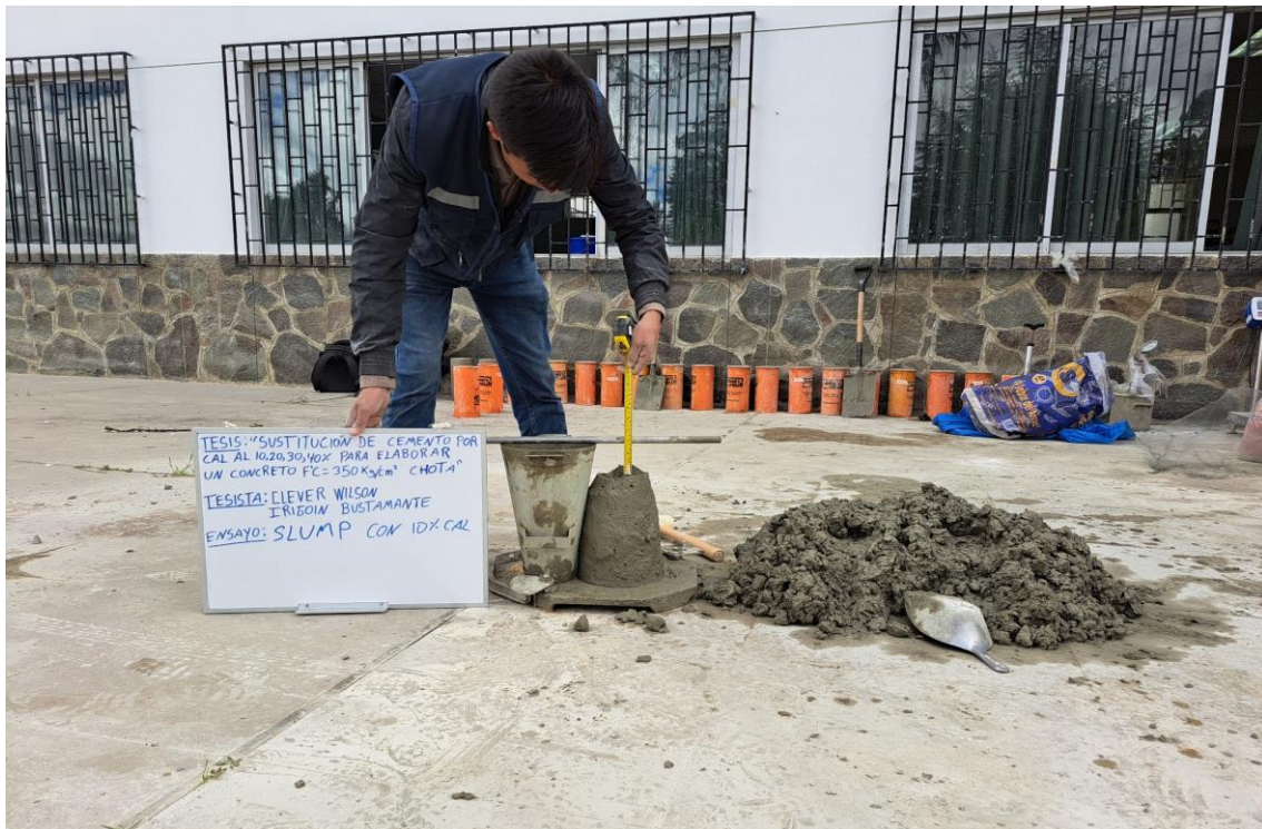
Fotografía 19. Slump de la mezcla de concreto con 20% de cal
