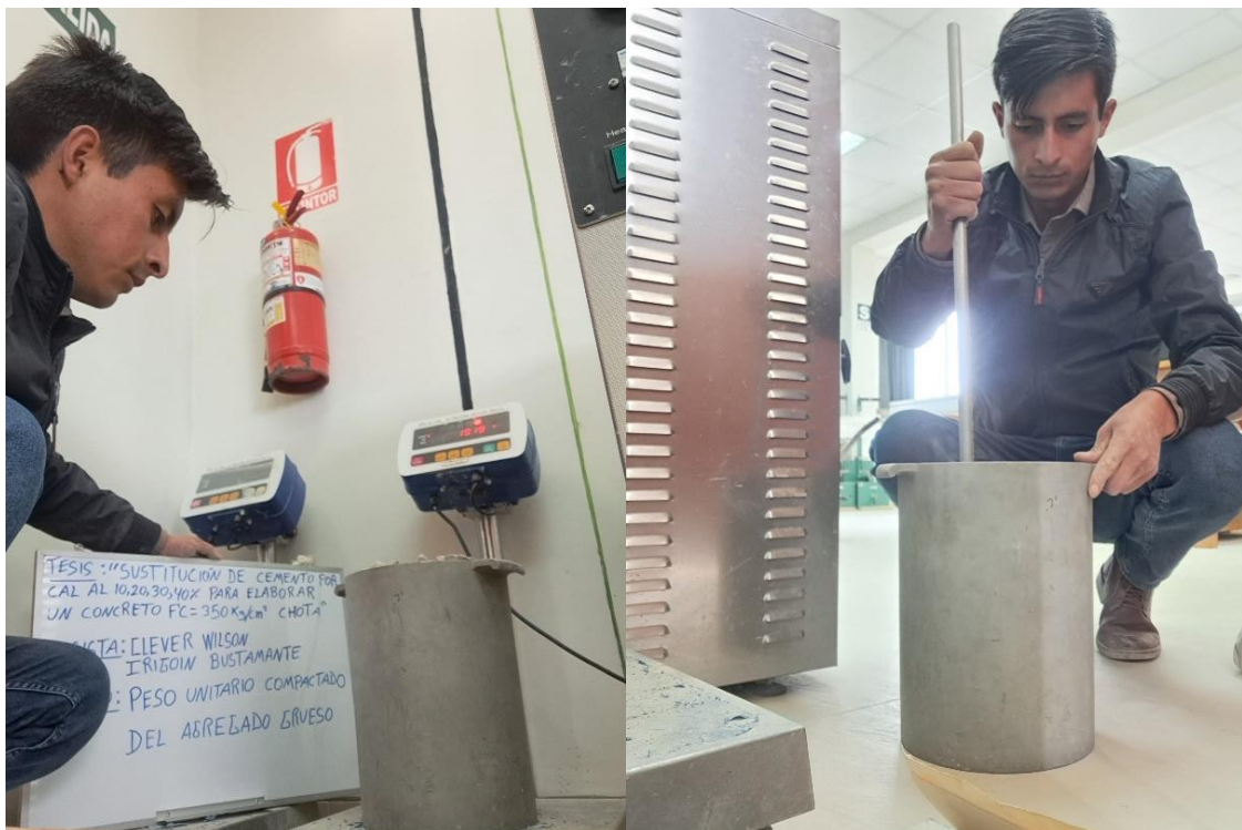
Fotografía 9. Peso unitario compactado del agregado grueso
