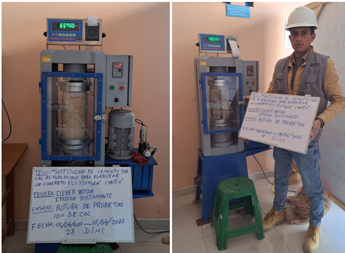
Fotografía 33. Rotura de probetas de concreto con 10% de cal
