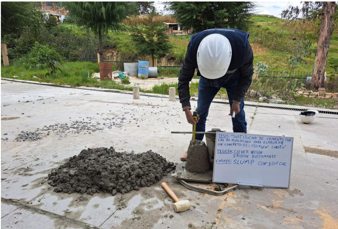
Fotografía 21. Slump de la mezcla de concreto con 40% de cal
