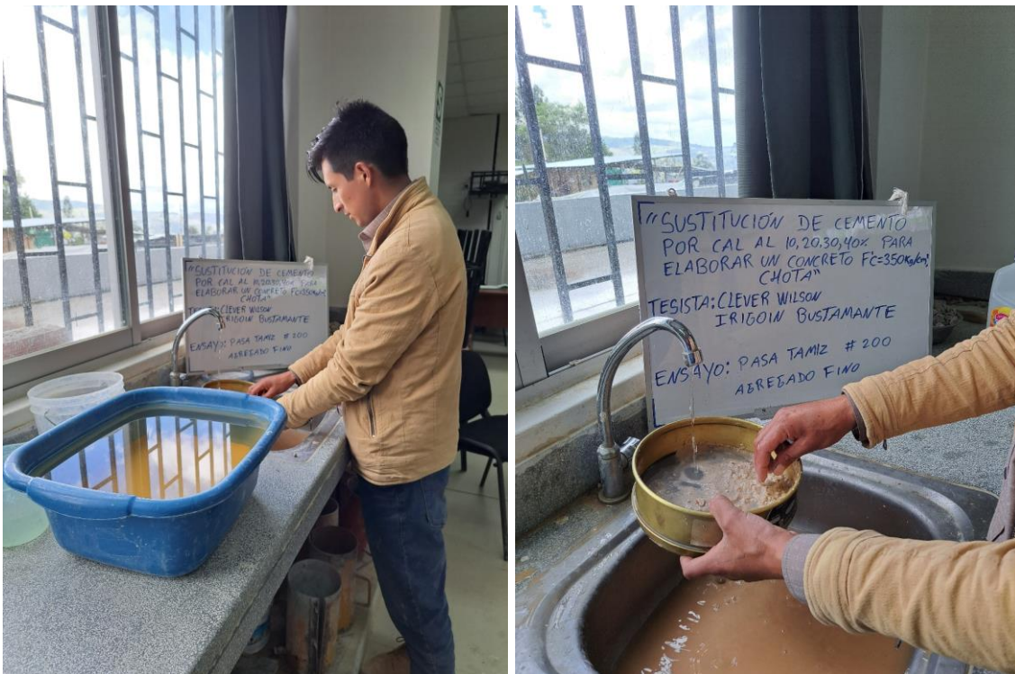
Fotografía 7. Ensayo material que pasa el tamiz N° 200
