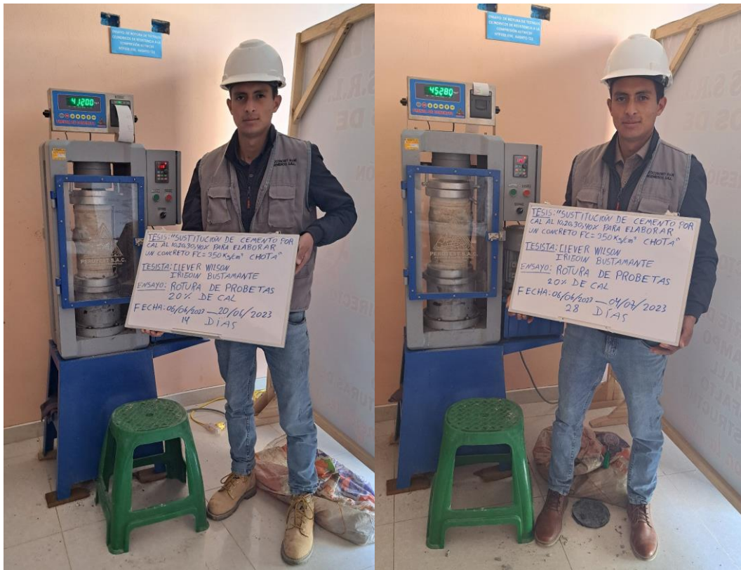
Fotografía 35. Rotura de probetas de concreto con 30% de cal
