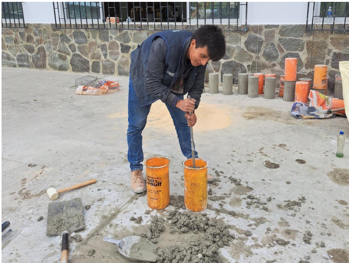
Fotografía 25. Elaboración de probetas de concreto
