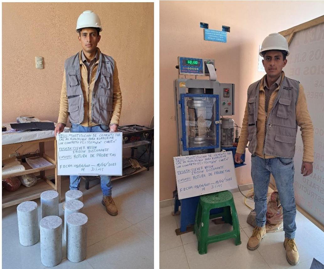
Figura 32 Prueba a Compresión en Probetas de Concreto con Cal
