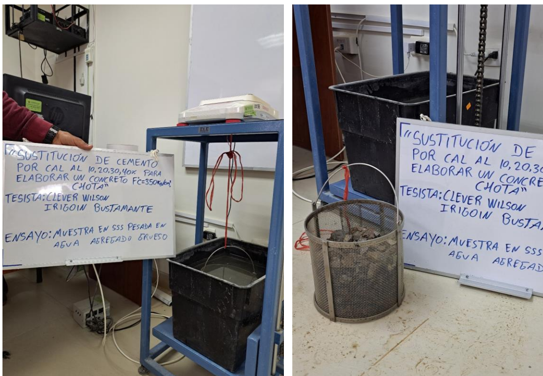
Fotografía 11. Peso específico del agregado grueso
