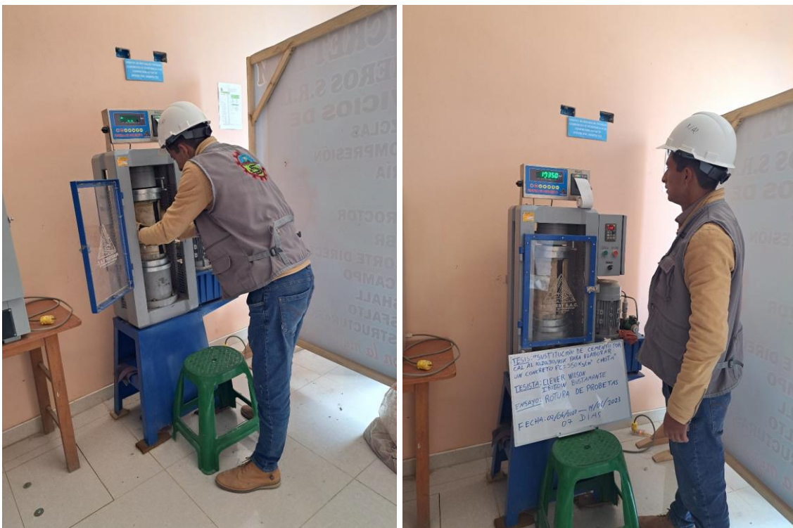
Fotografía 31. Colocación de las probetas en el equipo de compresión
