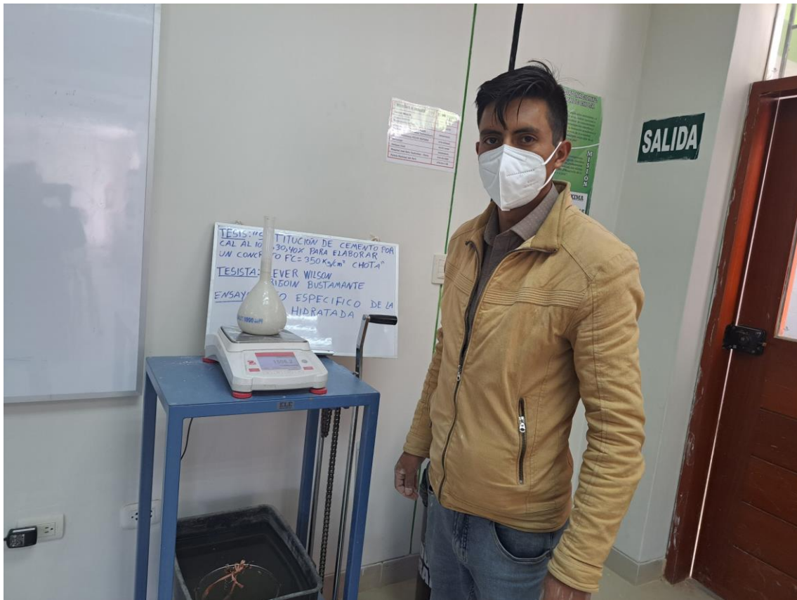
Fotografía 1. Ensayo de peso específico de la cal hidratada
