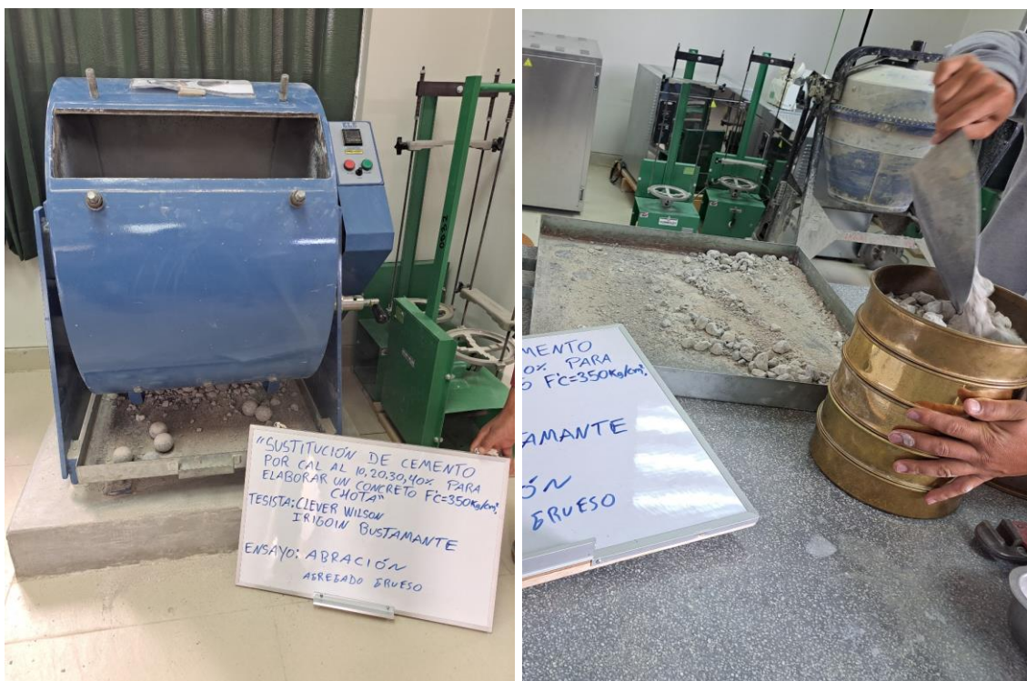
Fotografía 13. Ensayo de abrasión del agregado grueso
