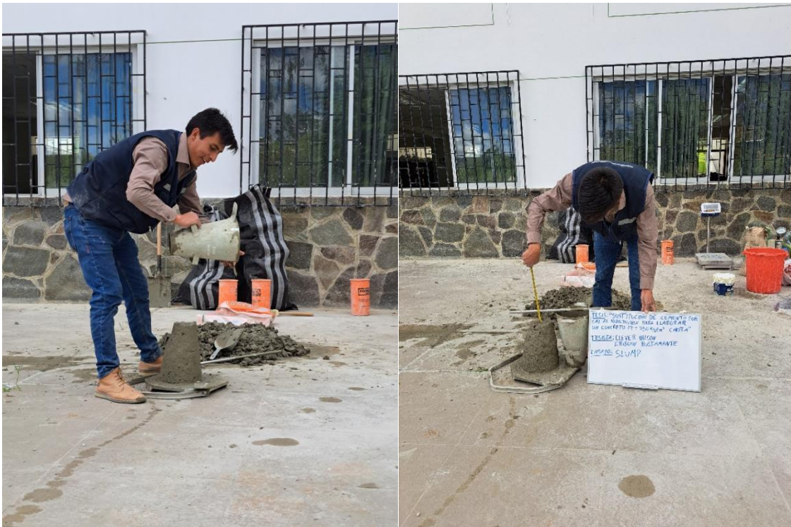
Fotografía 17. Slump de la mezcla de concreto base
