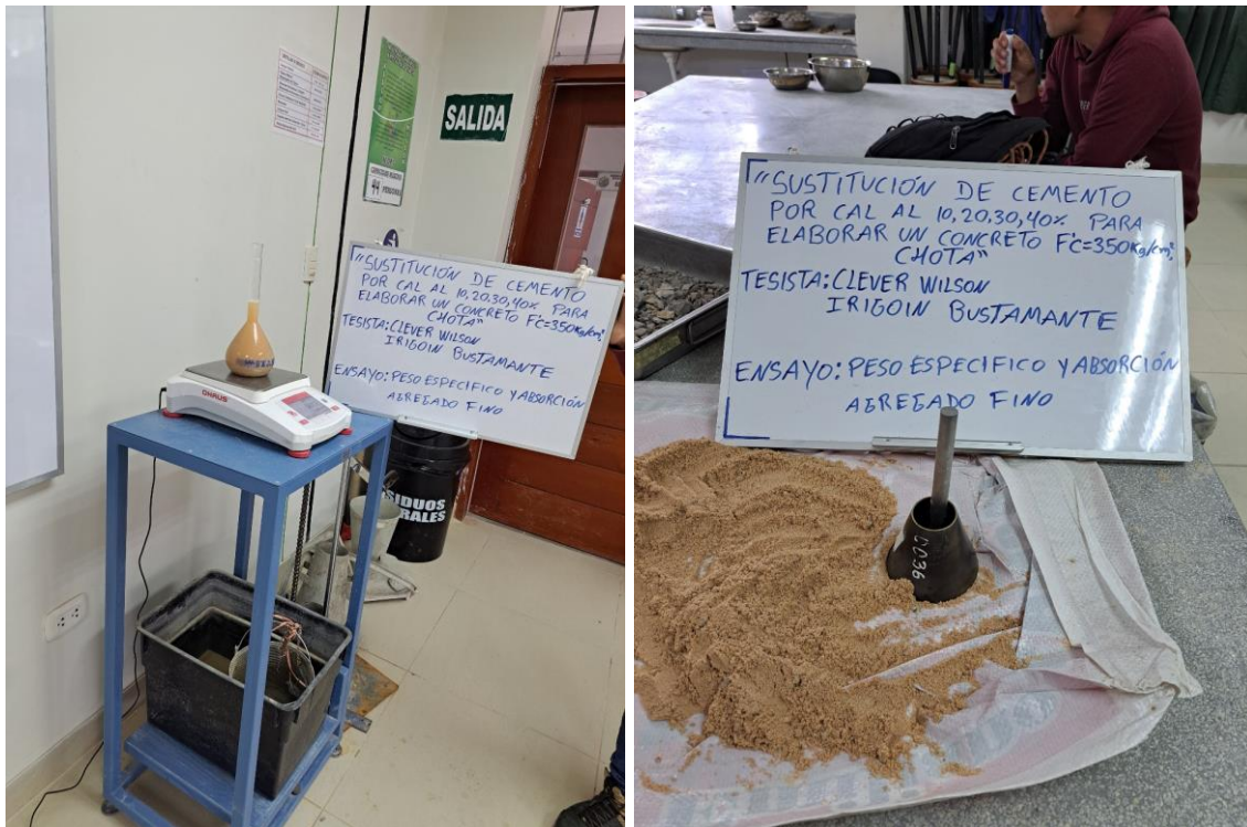
Fotografía 12. Ensayo de peso específico y absorción del agregado fino
