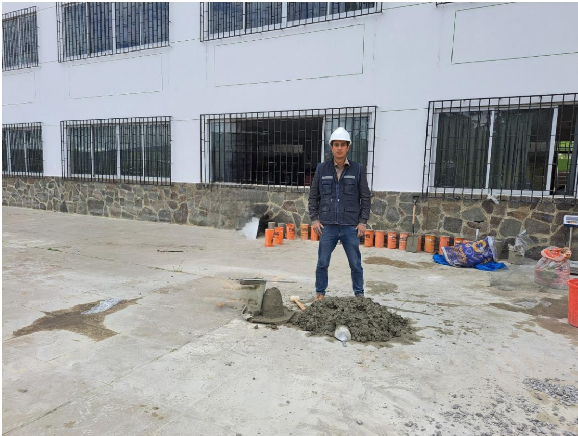
Fotografía 17. Slump de la mezcla de concreto base
