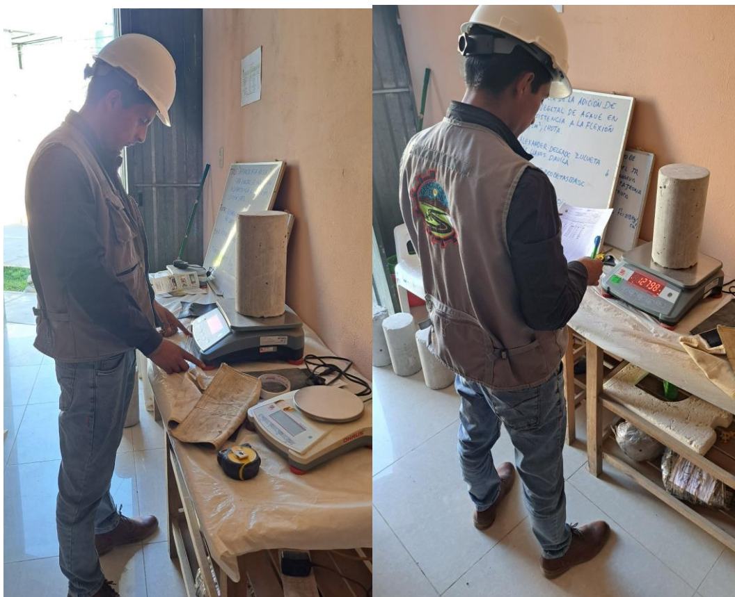
Fotografía 29. Pesaje de probetas de concreto
