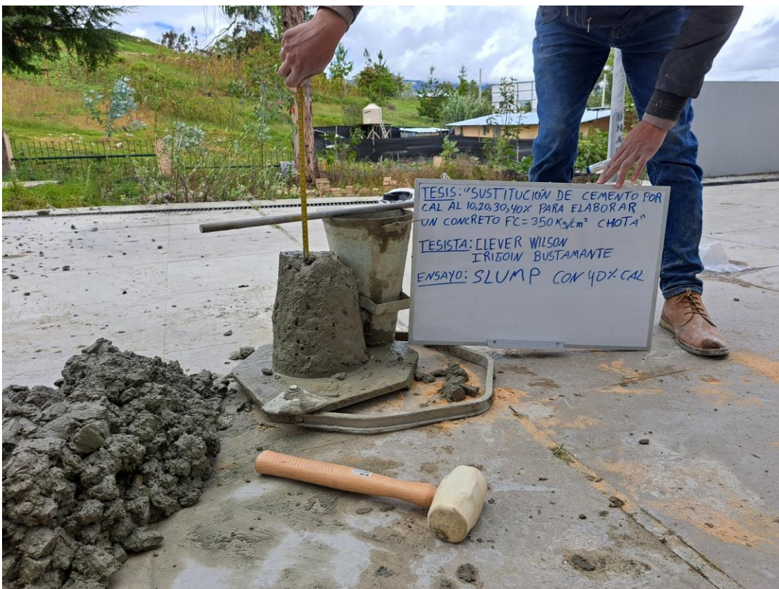
Fotografía 21. Slump de la mezcla de concreto con 40% de cal
