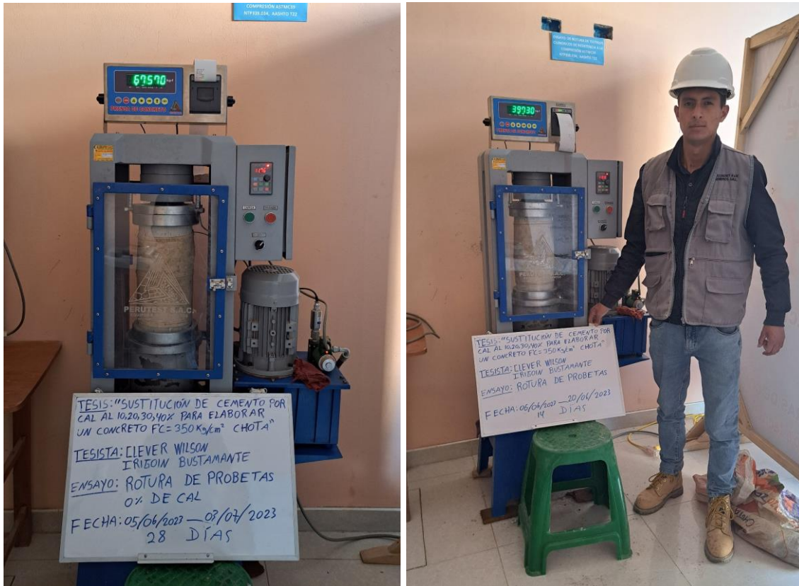
Fotografía 33. Rotura de probetas de concreto con 10% de cal
