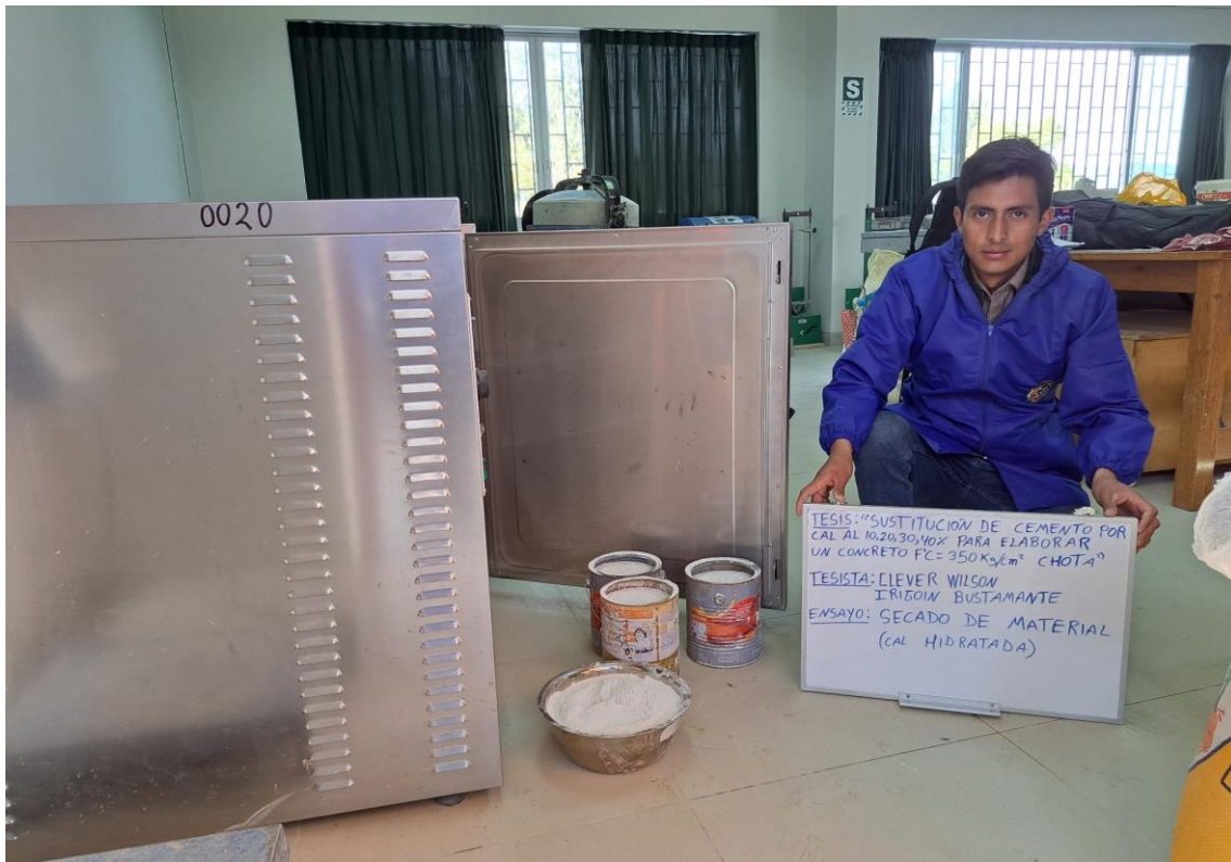
Fotografía 5. Secado de los agregados para determinar el contenido de humedad
