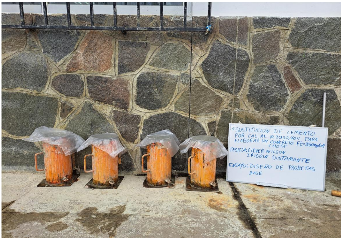
Fotografía 15. Probetas realizadas inicialmente para verificar el diseño base del estudio
