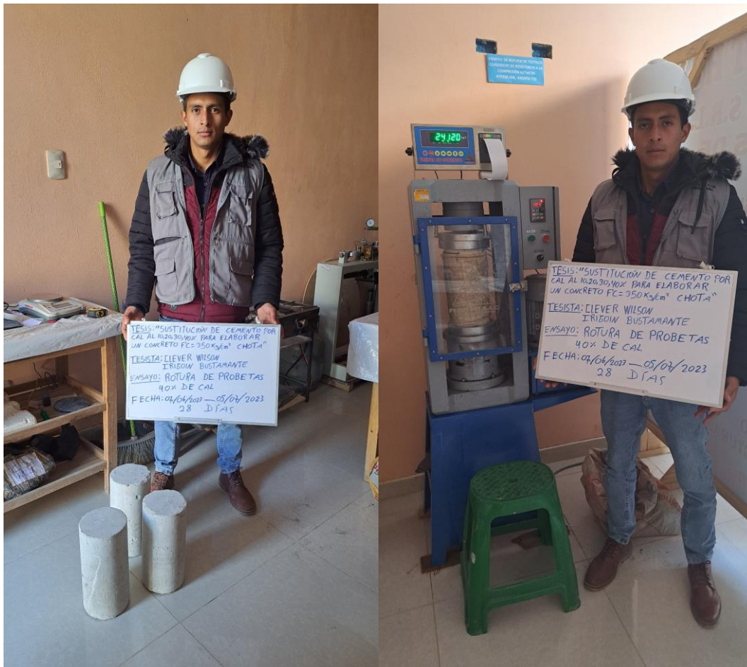
Fotografía 37. Probeta de concreto luego del ensayo de compresión
