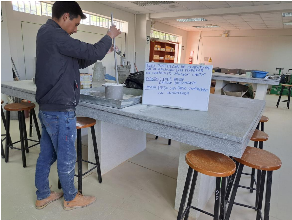
Fotografía 3. Peso unitario suelto de la cal hidratada
