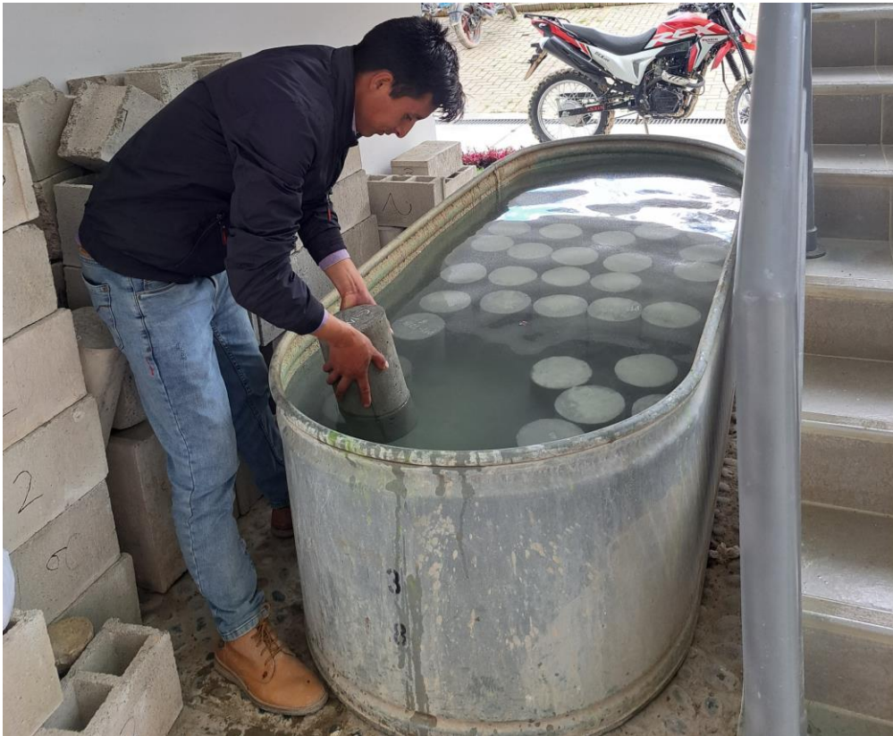
Fotografía 27. Muestras para ensayo de eflorescencia
