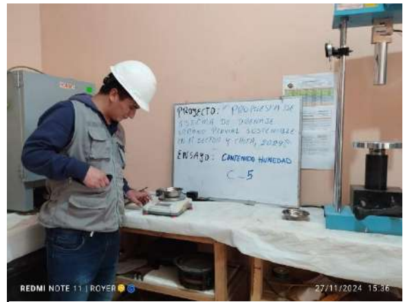
Foto N ° 22. Ensayo contenido de humedad.
