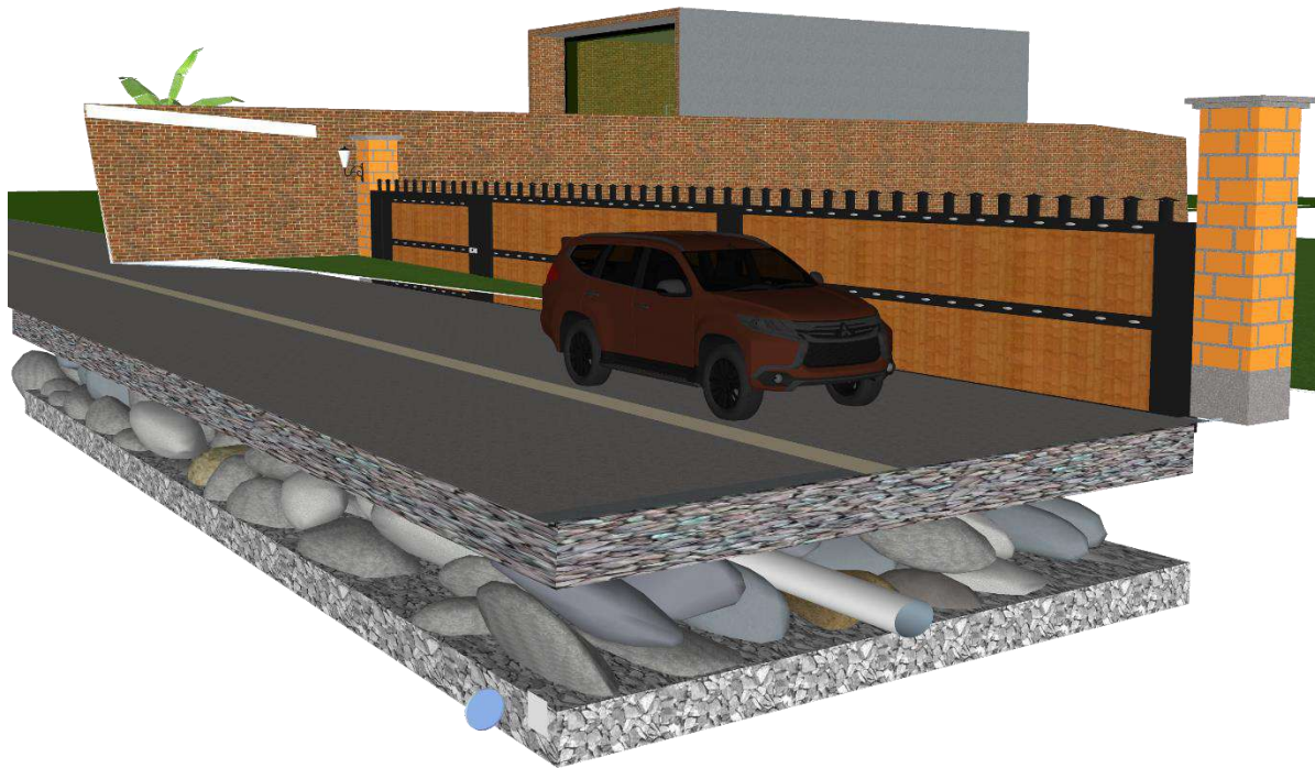
Foto N° 26. Modelamiento de Pavimento Permeable en SketchUp Pro 2021.
