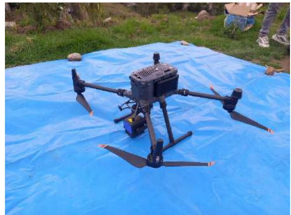
Foto N ° 10. Dron Maticce 350 RTK estacionado para inicial el vuelo topográfico.
