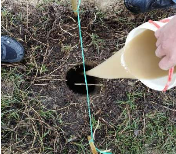
Foto N ° 25. Saturación del suelo para el Método del Porchet.
