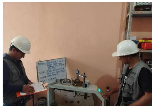
Foto N ° 30. Toma de datos ensayo de corte directo.
