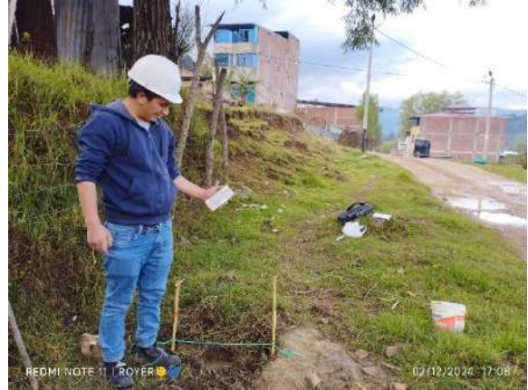
Foto N ° 26. Toma de tiempos para calcular la infiltración del suelo.
