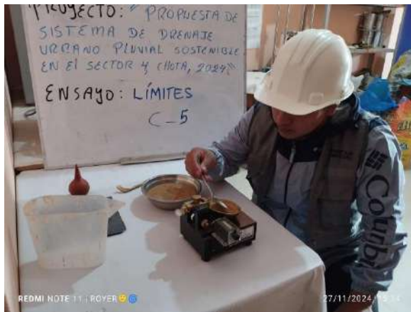
Foto N ° 21. Ensayos de limites Liquido y Plástico.
