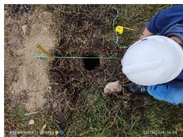
Foto N ° 24. Colocación de materiales para el Método de Porchet.
