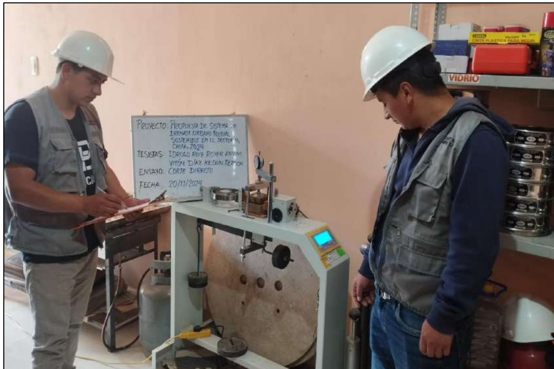
FOTOGRAFIA 02: Ensayo de corte directo, según la Norma (A.S.T.M. D 3080)
