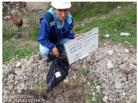
Foto N ° 18. Muestra tomada de la calicata 03 Sector 4 - Chota.
