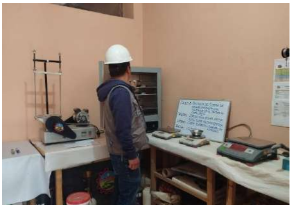
Foto N ° 29. Ensayo de corte directo, contenido de humedad.
