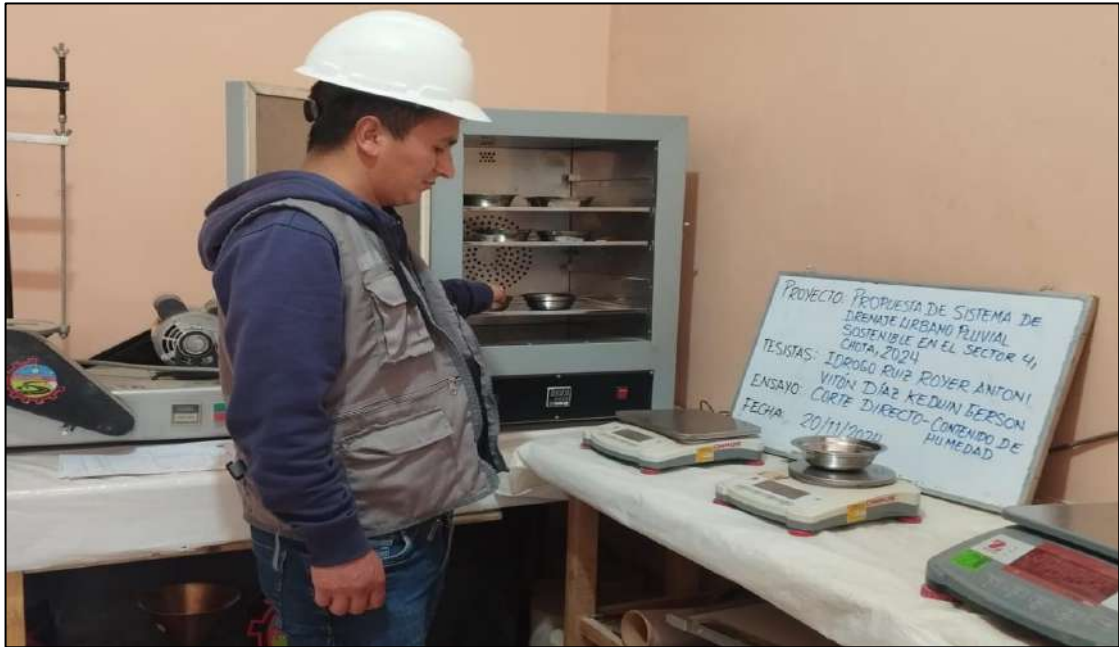
FOTOGRAFIA 01: Ensayo de corte directo (contenido de humedad), según la Norma (A.S.T.M. D 3080)
