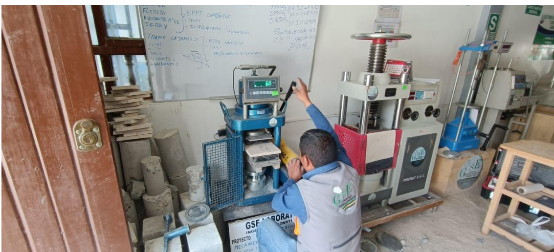
Fotografía 22 Ensayo de rotura de los paneles elaborados
