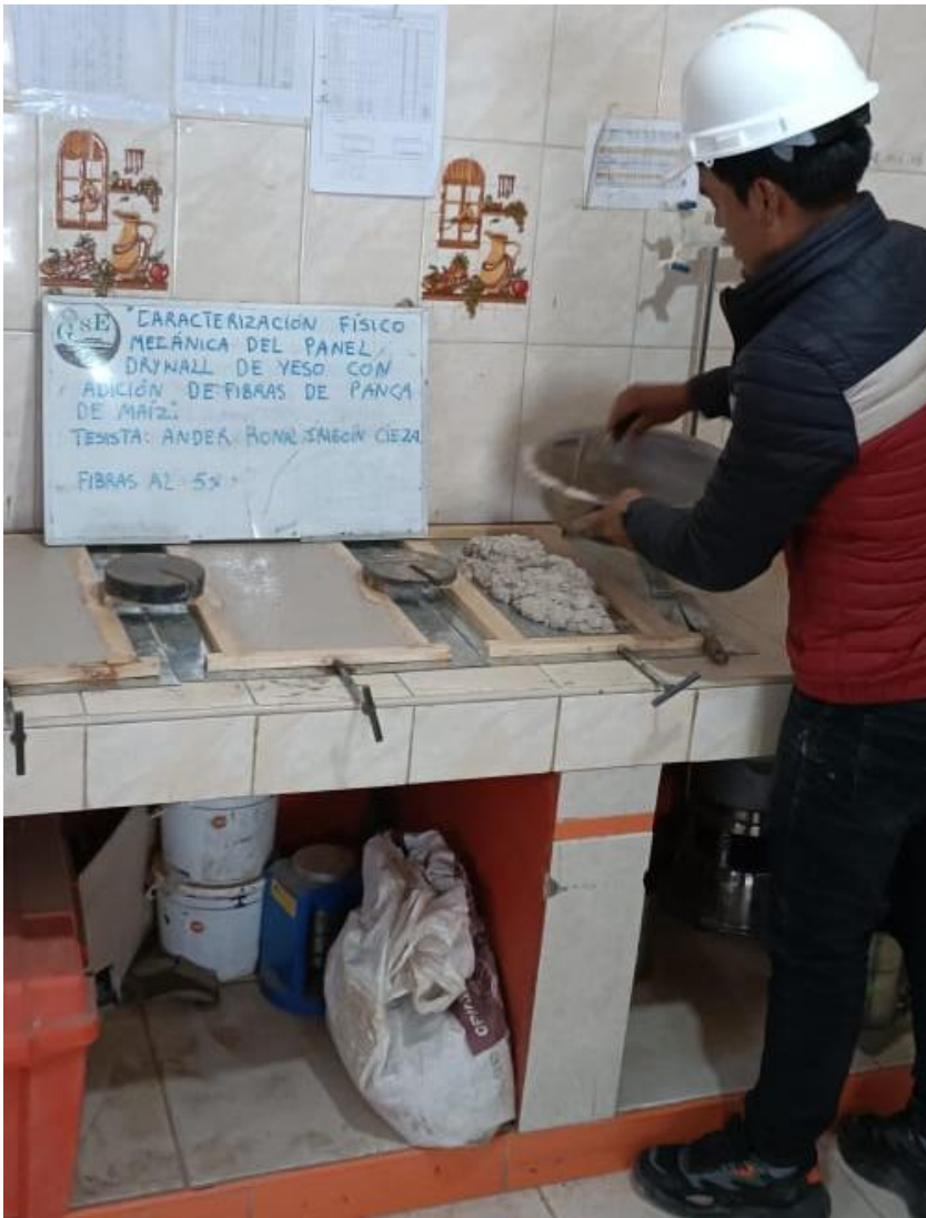
Fotografía 10 Colocación de mezcla en los moldes para la formación de los paneles
