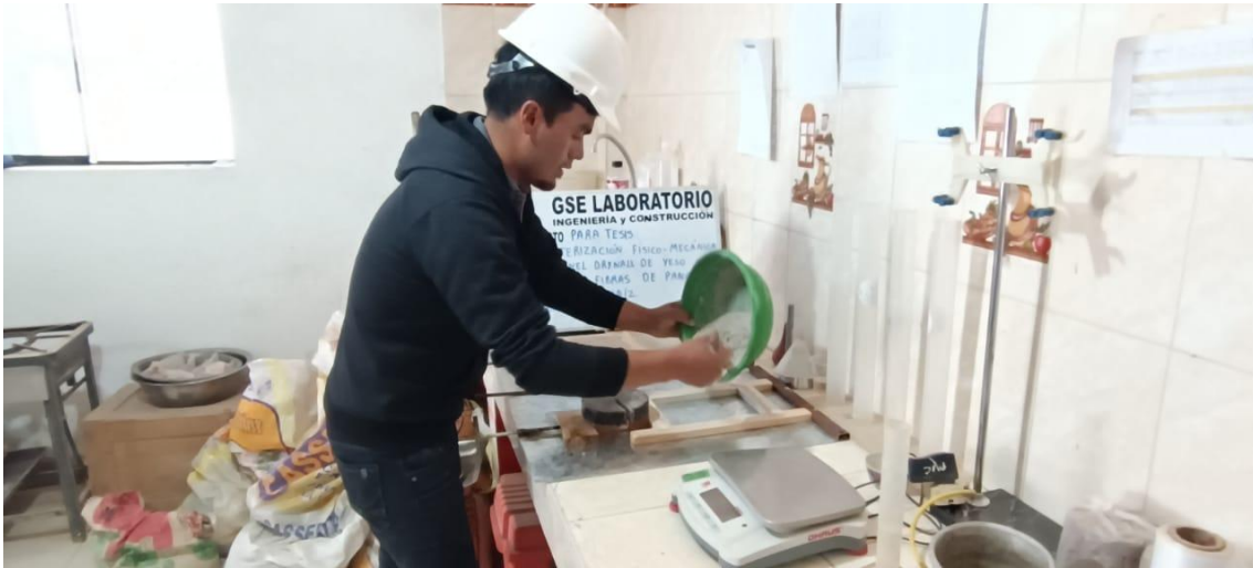
Fotografía 10 Colocación de mezcla en los moldes para la formación de los paneles
