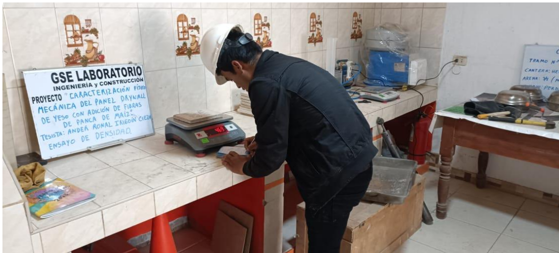
Fotografía 18 Ensayo de densidad de los paneles elaborados
