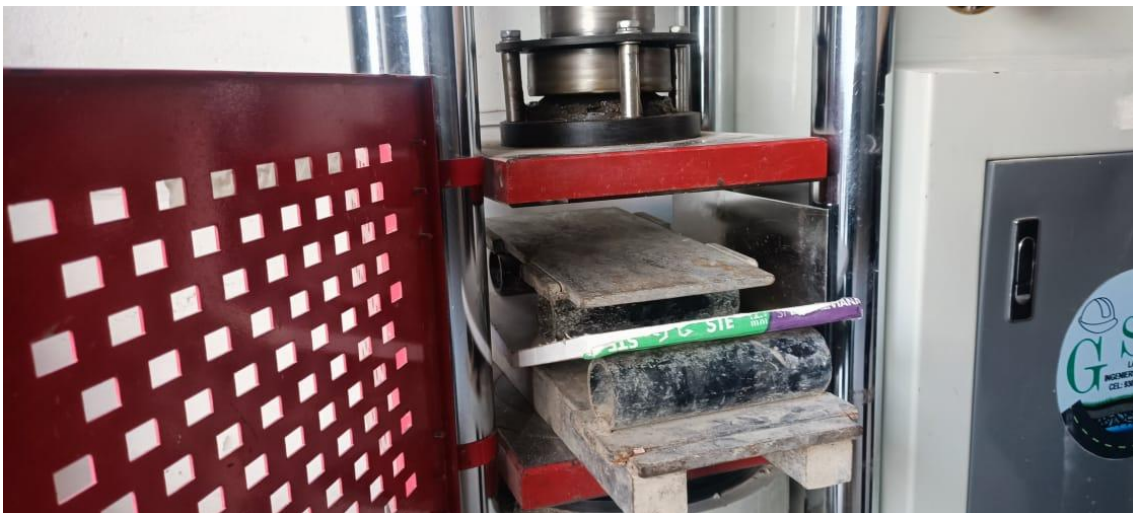
Fotografía 28 Vista de la carga máxima que soporta el panel comercial
