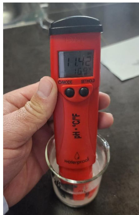
(b). Medición del pH de la suspensión agua–concreto utilizando un medidor digital HANNA HI98103, procedimiento empleado para evaluar la alcalinidad del material y su relación con el proceso de carbonatación.
