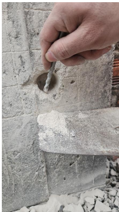
(a). Extracción del polvo de concreto generado durante la perforación, el cual fue recolectado y almacenado para su posterior análisis en laboratorio.
