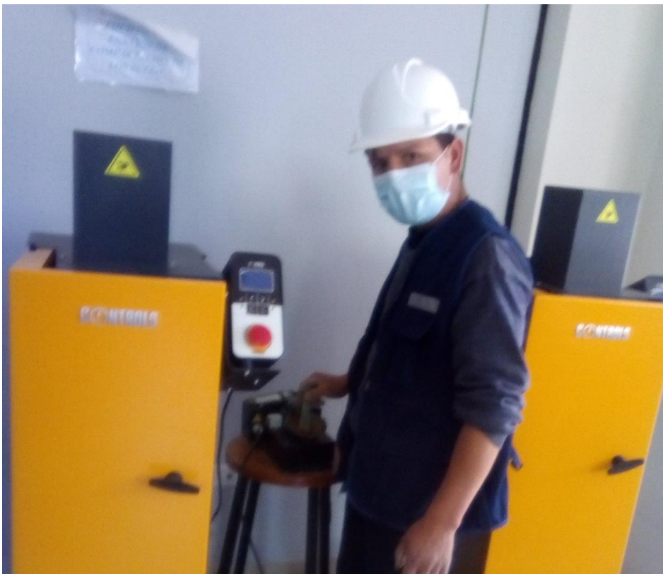
Fotografía 10. Ensayo de limite líquido y limite plástico, se realizó en la copa de Casagrande electrónica
