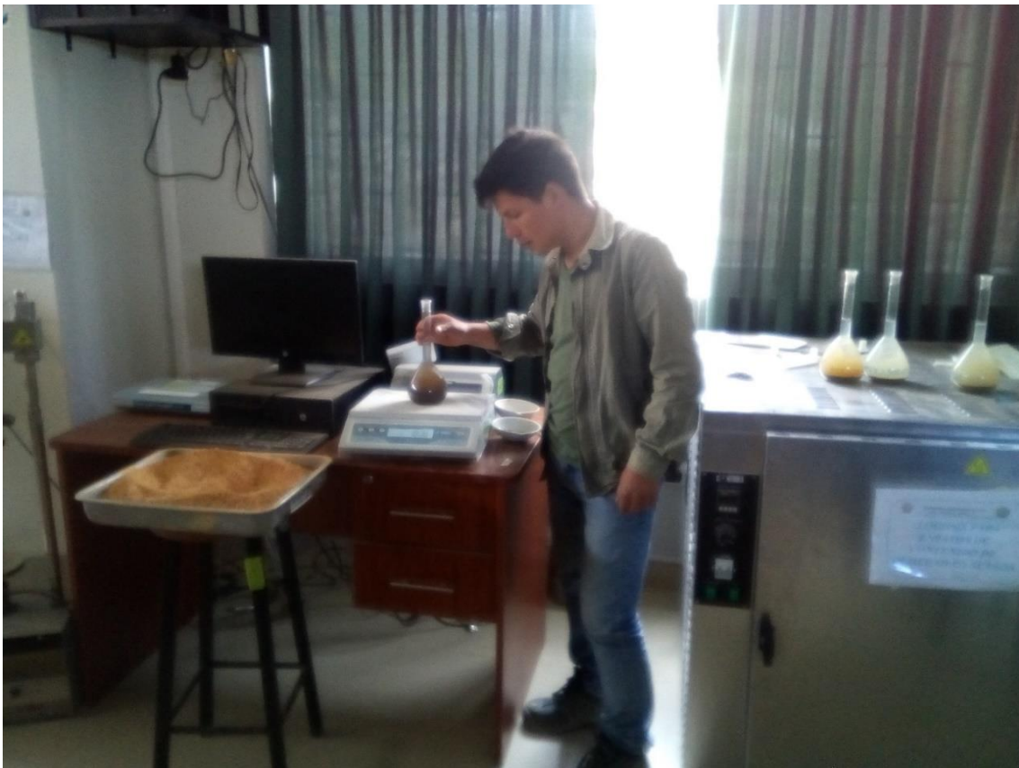
Fotografía 11. Ensayo de peso específico, se realizó con un picnómetro de capacidad de 500 ml
