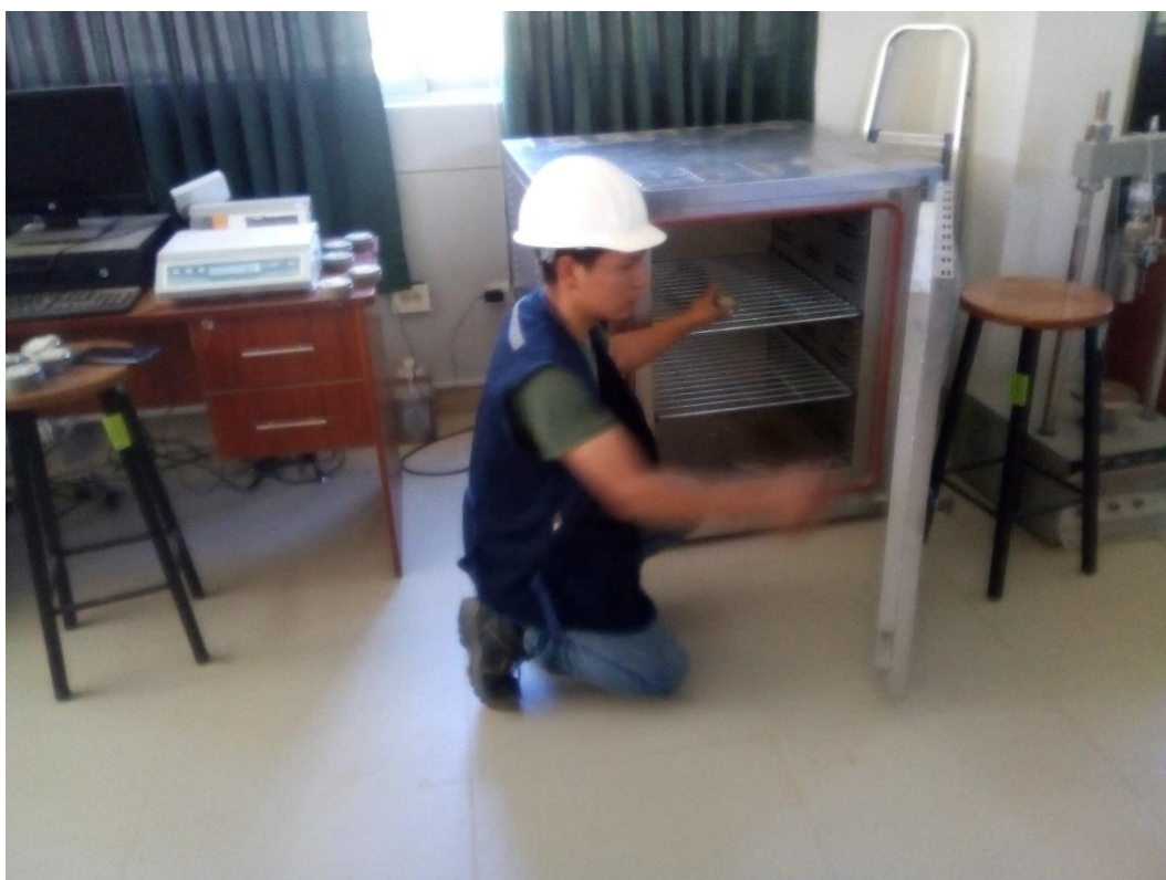
Fotografía 8. Colocación de muestras al horno para el ensayo de contenido de humedad
