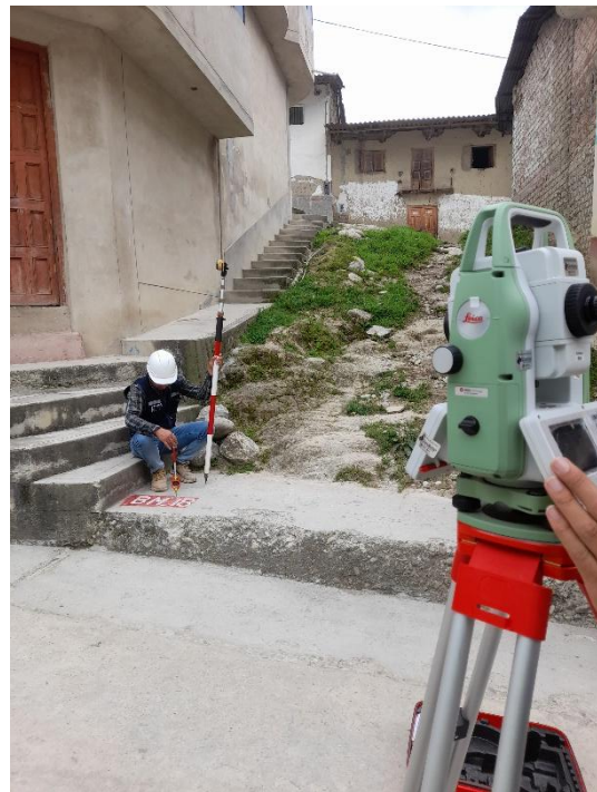
Fotografía 16. Proceso de levantamiento topográfico: toma de puntos en BMS y puntos fijos registrados con esmalte color rojo
