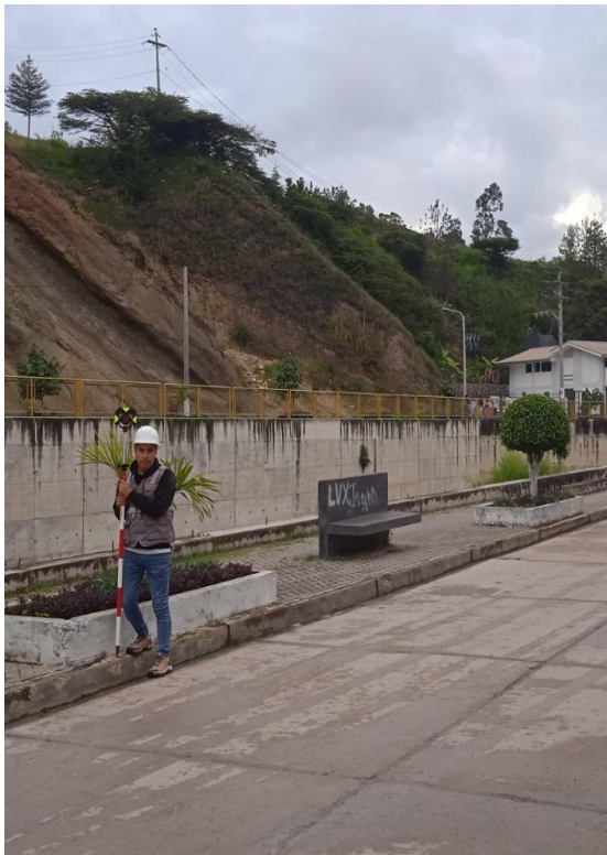
Fotografía 11. Proceso de levantamiento topográfico: toma de puntos topográficos en el Malecón Grau a orillas del río Chotano
