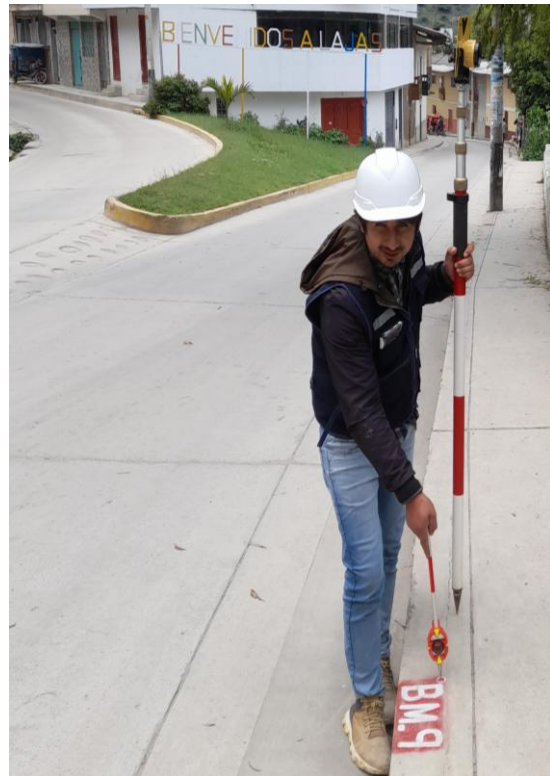
Fotografía 12. Proceso de levantamiento topográfico: toma de puntos topográficos en la entrada a la Ciudad de Lajas
