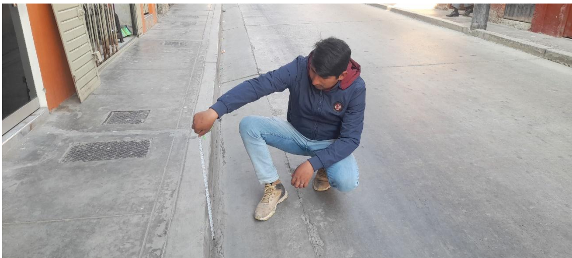
Recolección de medidas del sistema de drenaje pluvial urbano del Jr. Rosendo Mendivel Cuadra 6
