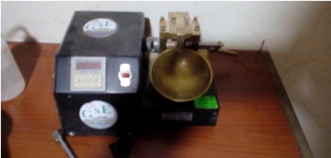
Fotografía 3. Realización del ensayo de límite líquido en la copa Casagrande con una muestra de suelo que pasa el tamiz N° 40
