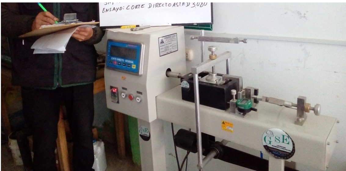
Fotografía 3. Realización del ensayo de corte directo en las muestras inalteradas de suelo del estadio municipal de Chota. En la fotográfica se nota el proceso de registro de los datos obtenidos en la aplicación de la carga tangencial.
