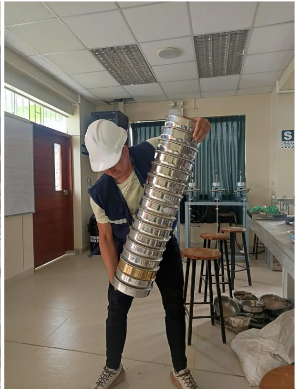
Fotografía 15. Realizando el ensayo de la granulometría de las calicatas.
