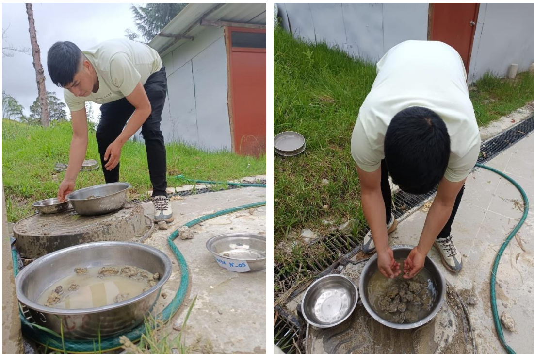
Fotografía 14. Lavado de suelo cohesivo antes de análisis granulométrico.
