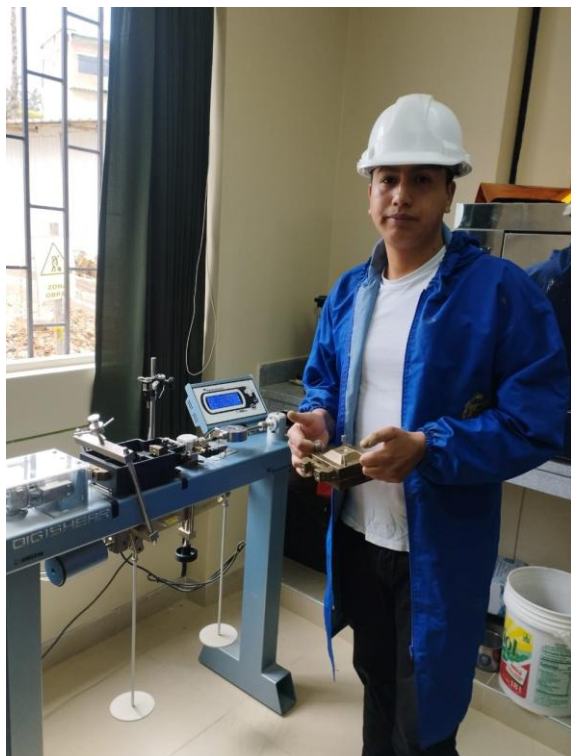
Fotografía 20. Pesando la muestra de suelo y colocándolo a la máquina del ensayo de corte directo.
