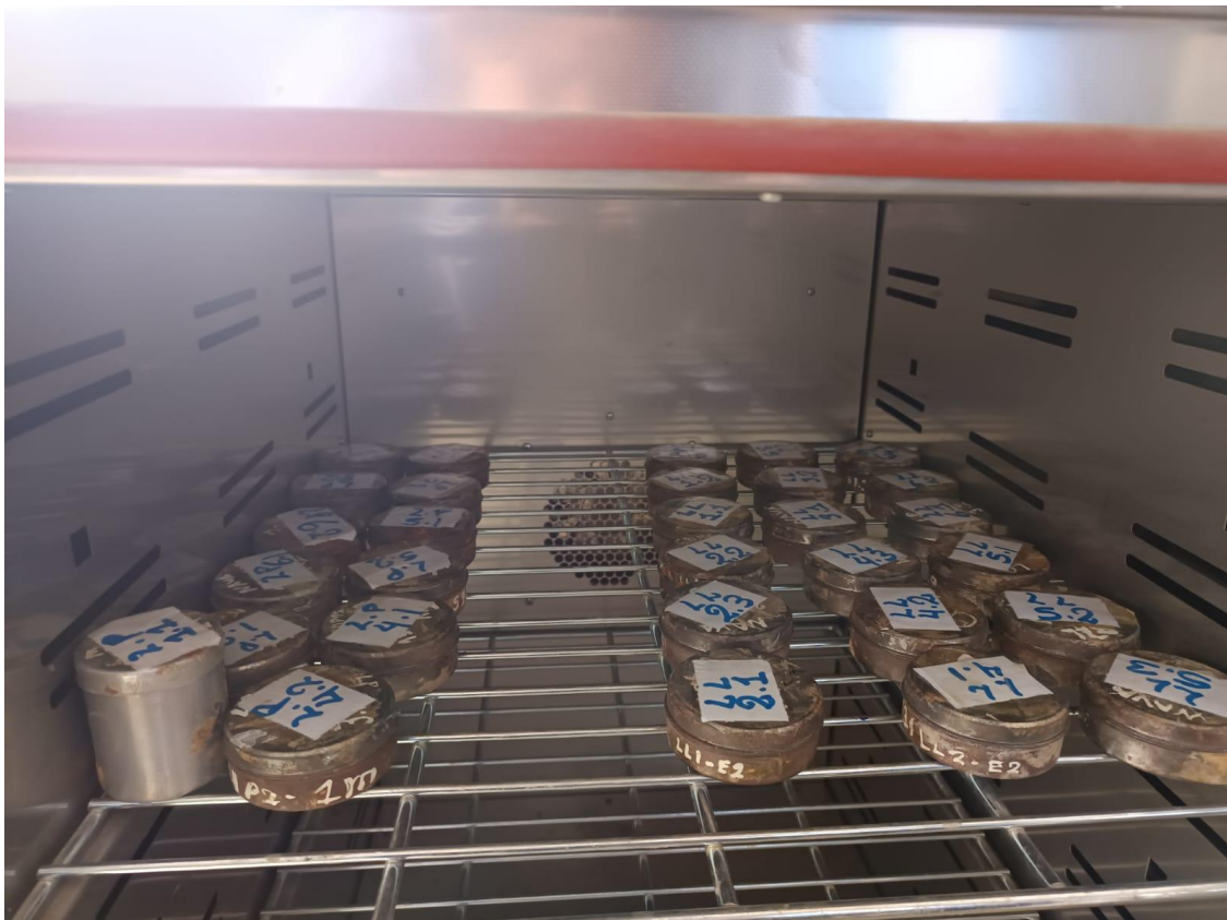
Fotografía 18. Colocación de las muestras de suelo del ensayo de límite líquido y límite plástico al horno.
