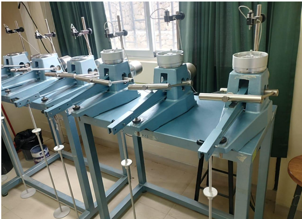
Fotografía 22. Instrumentación del ensayo de consolidación unidimensional.
