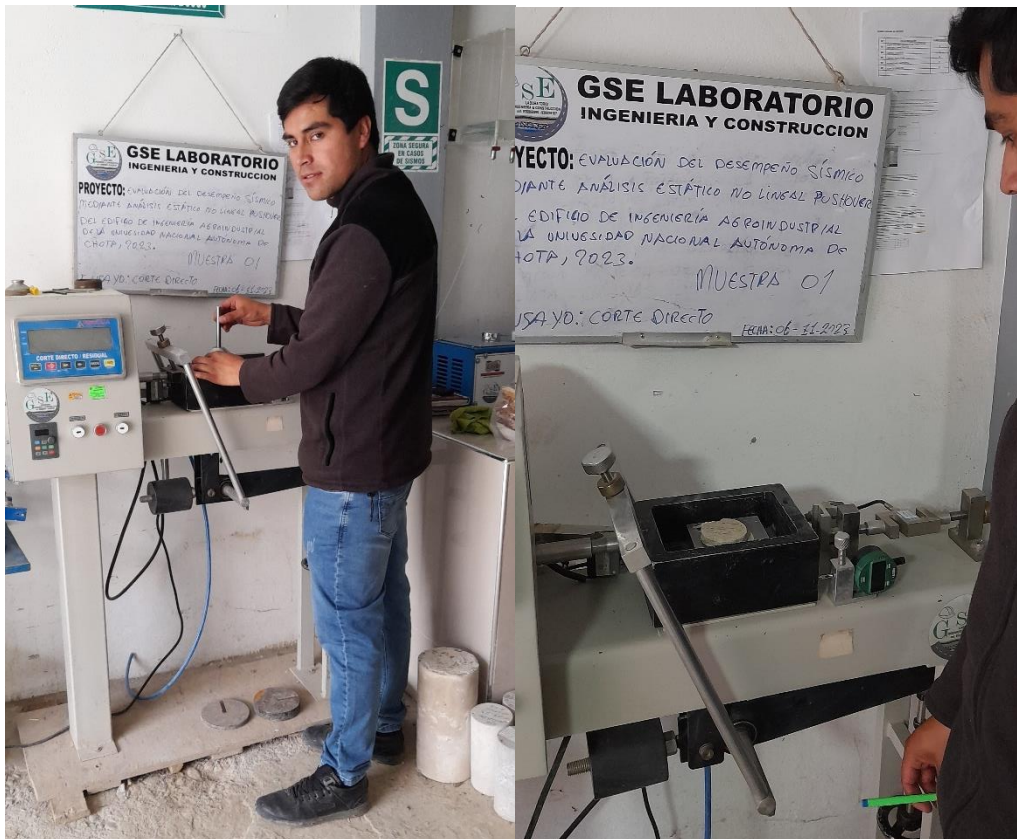
Fotografía 10. Realización del ensayo de corte directo en la muestra 2
