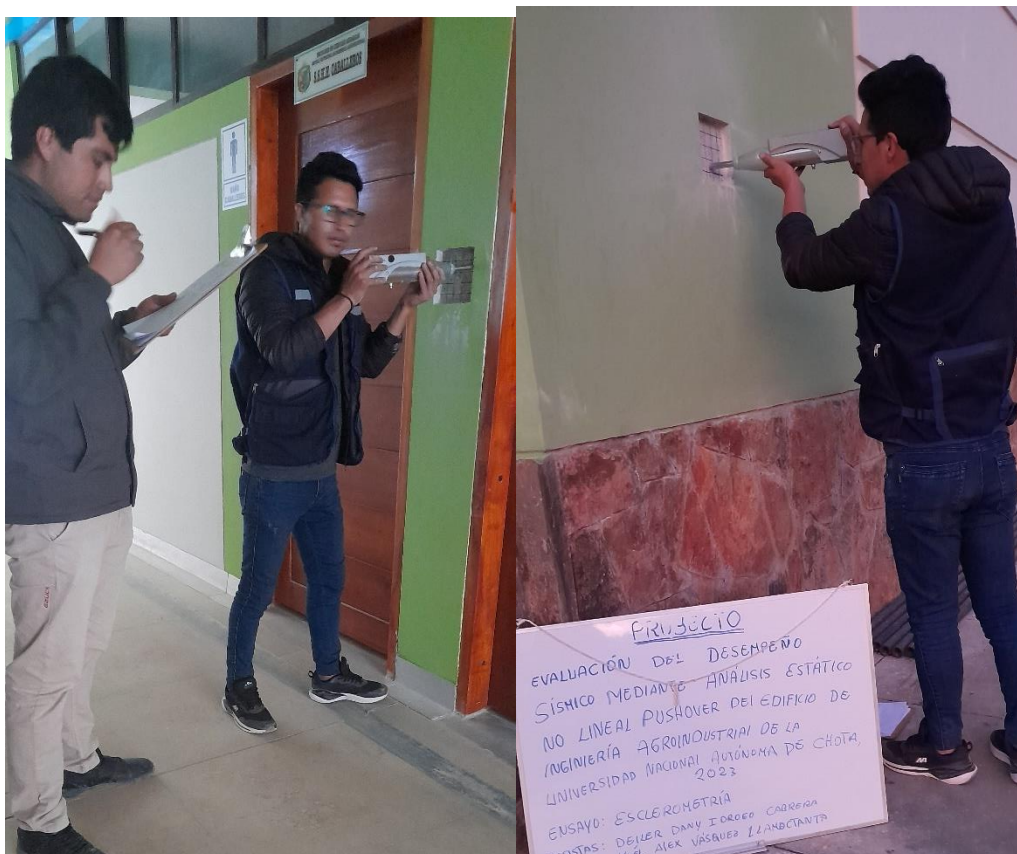
Fotografía 20. Realización de ensayos de esclerometría en columnas y placas
