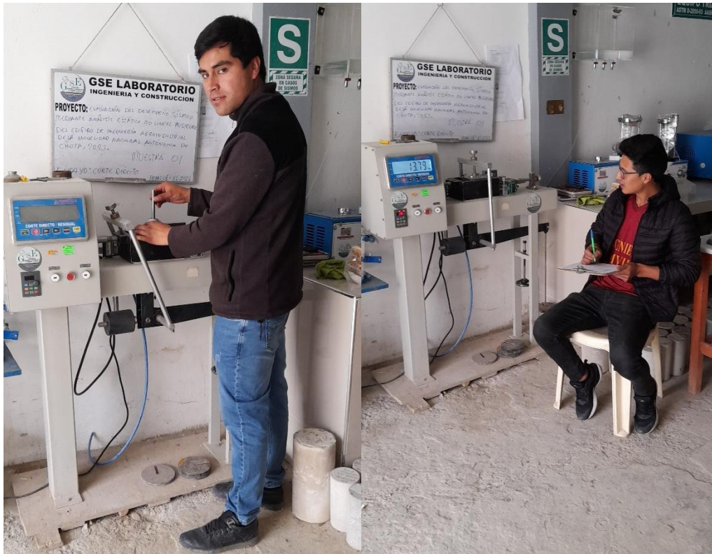
Fotografía 10. Realización del ensayo de corte directo en la muestra 2
