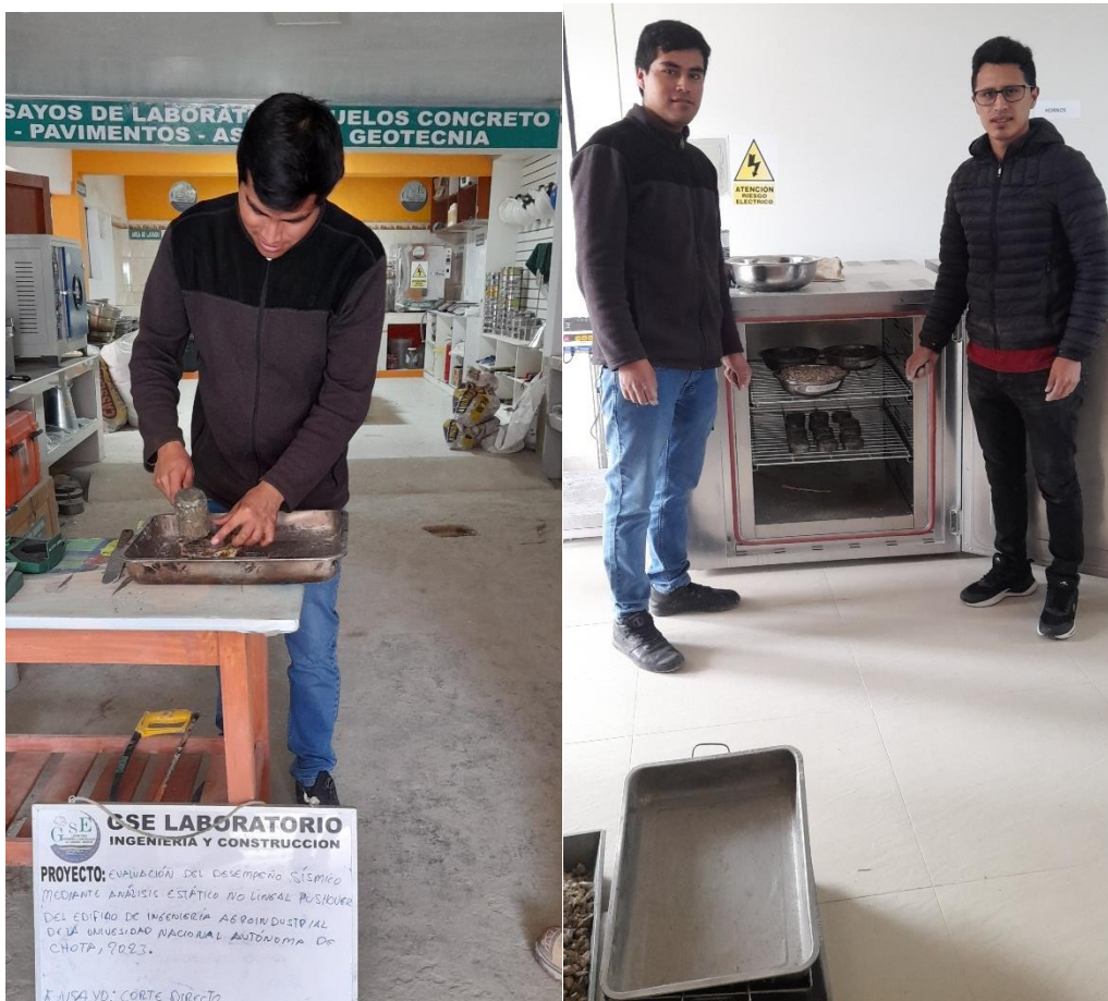
Fotografía 6. Moldeado de la muestra de suelo para ensayo de corte directo
