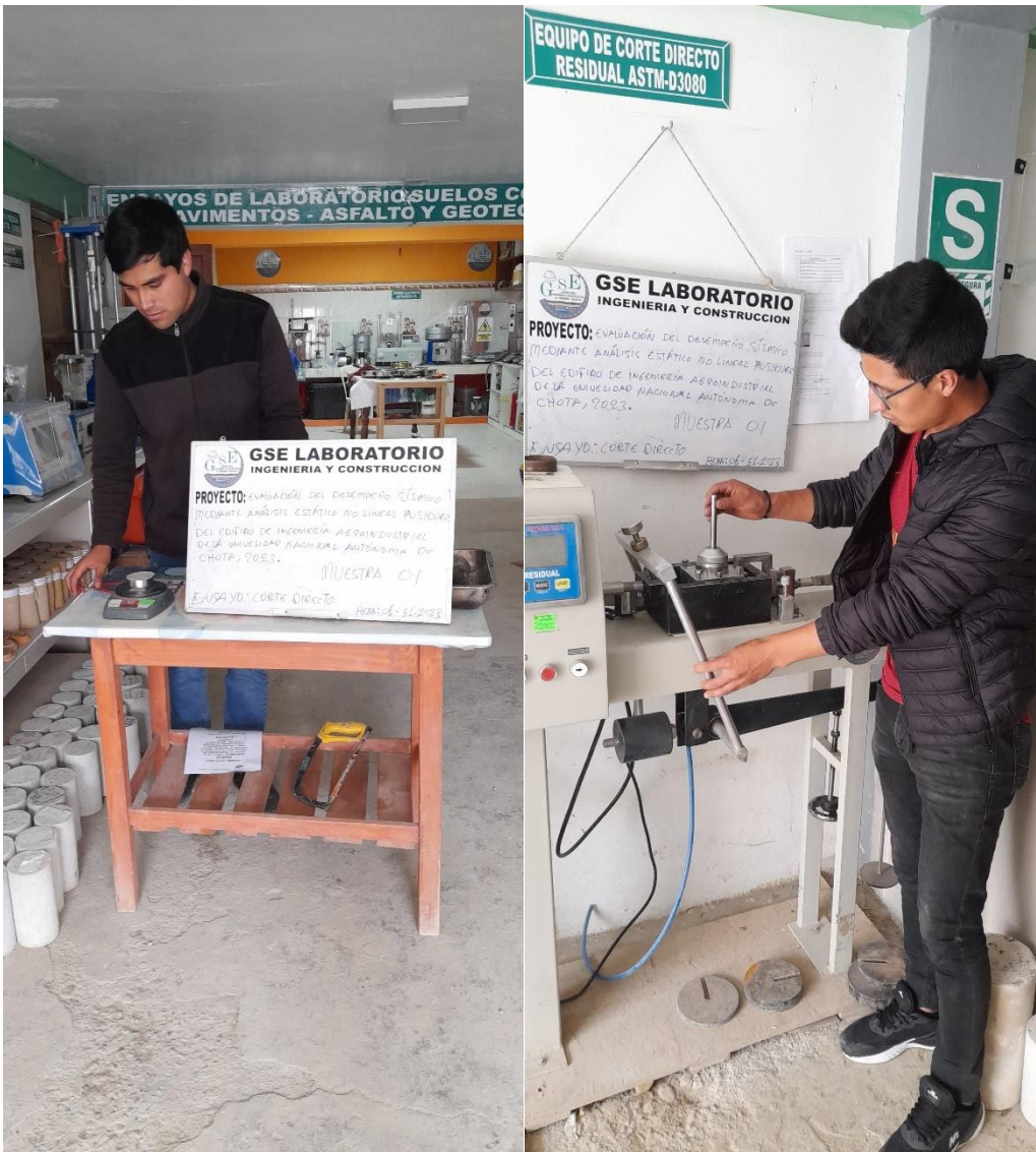
Fotografía 8. Preparación del equipo de corte directo para el ensayo
