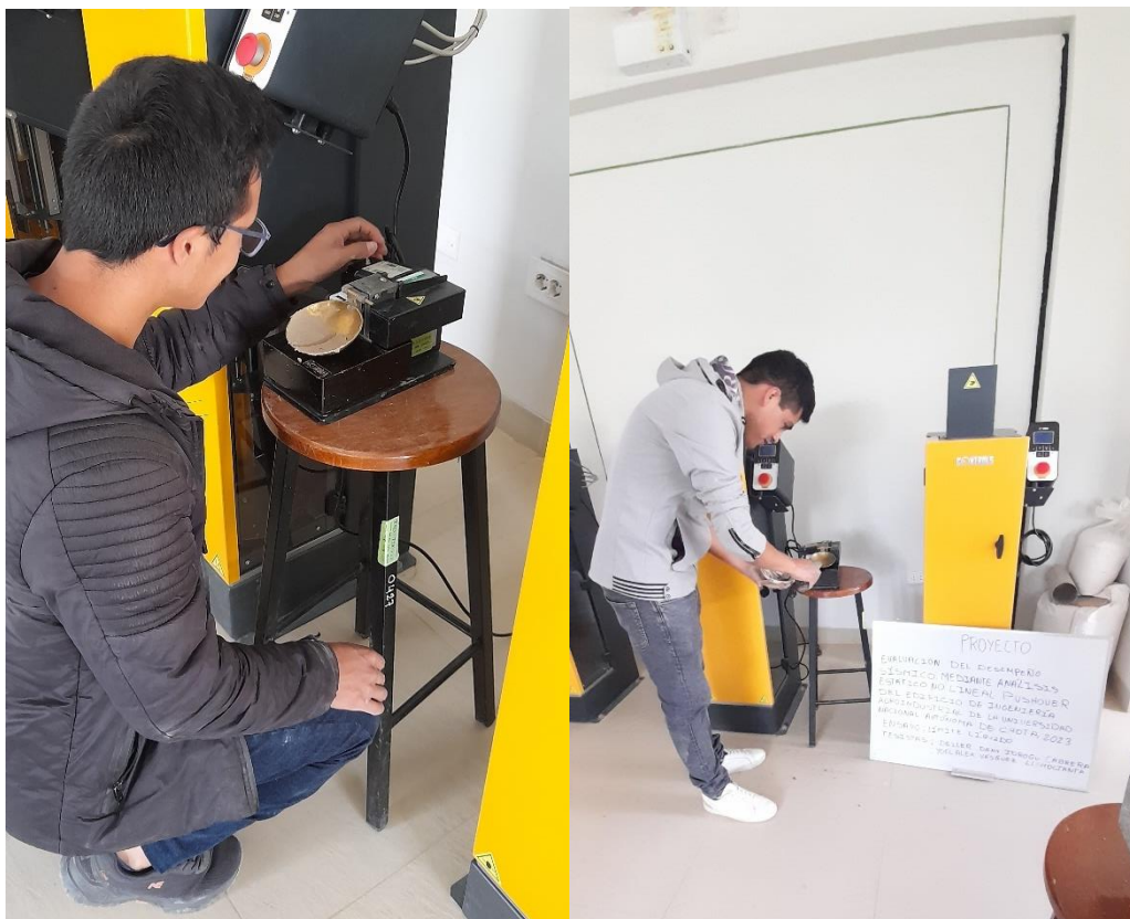
Fotografía 14. Ensayo de límite líquido en la copa Casagrande
