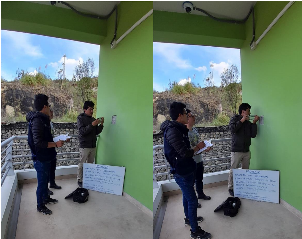
Fotografía 18. Realización de ensayos de esclerometría en placas
