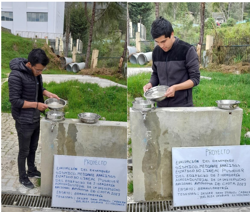
Fotografía 12. Lavado de la muestra de suelo para análisis granulométrico
