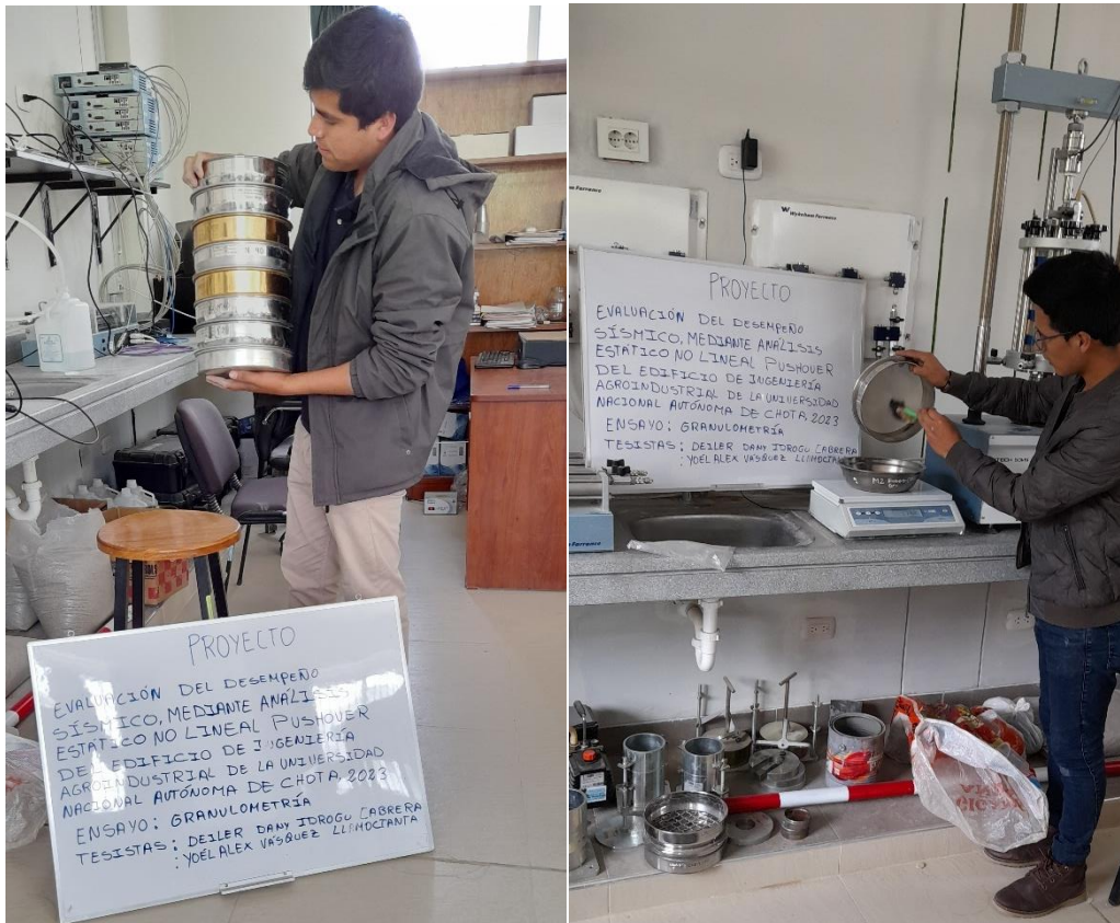
Fotografía 14. Ensayo de límite líquido en la copa Casagrande
